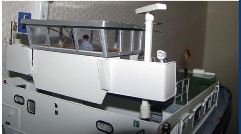
Senkrecht versenkbarer Radarmast am Steuerhaus
