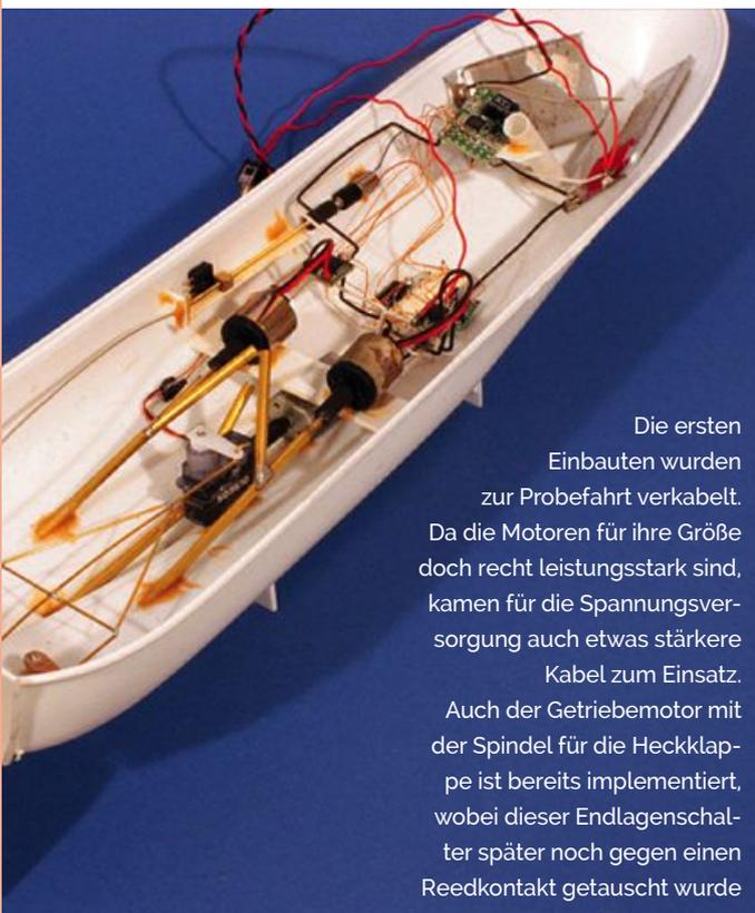
Die ersten Einbauten wurden zur Probefahrt verkabelt. Da die Motoren für ihre Größe doch recht leistungsstark sind, kamen für die Spannungsversorgung auch etwas stärkere Kabel zum Einsatz. Auch der Getriebemotor mit der Spindel für die Heckklappe ist bereits implementiert, wobei dieser Endlagenschalter später noch gegen einen Reedkontakt getauscht wurde
