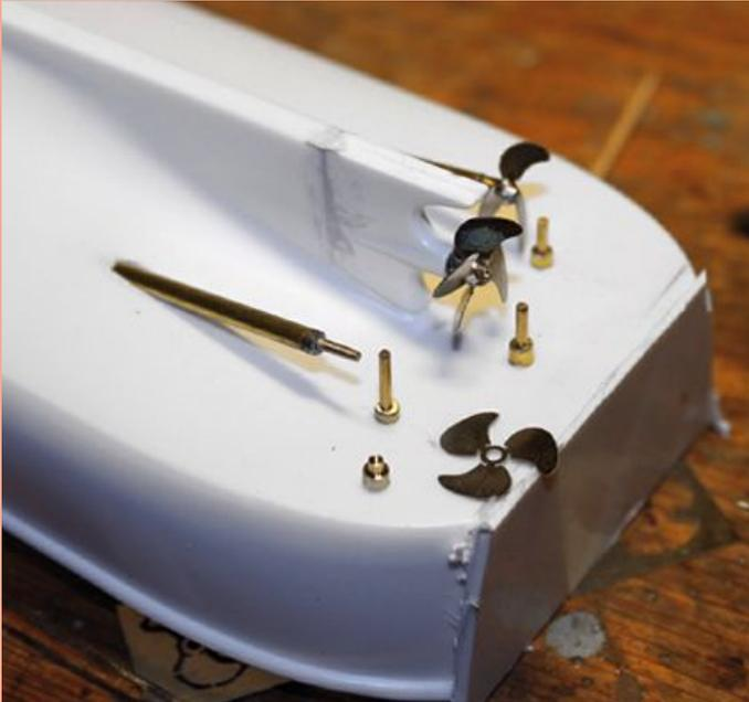
In meiner Berlin kommen geätzte Schrauben zum Einsatz, welche mir ein Freund überlassen hat. Mit der im Text beschriebenen Variante lassen sich aber ebenfalls gute Propeller herstellen. Wird das Blech auf ein Stückchen Messingrohr gelötet, sieht die Schraube recht ansprechend aus und es wird eine gute Zentrierung des Bleches gewährleistet
