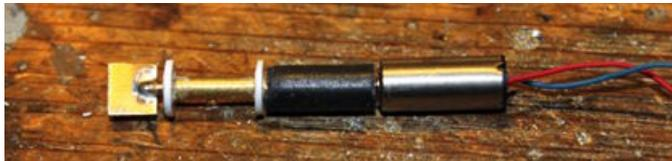
Nach dem Zusammenstecken wird der Antrieb in das senkrechte Rohr eingelassen. Da die beiden Scheiben maßhaltig gedreht wurden, wird hierrüber der Antrieb im Rohr fixiert
