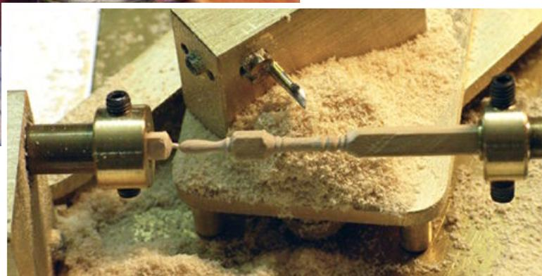
Drechselanlage mit Pantograph
