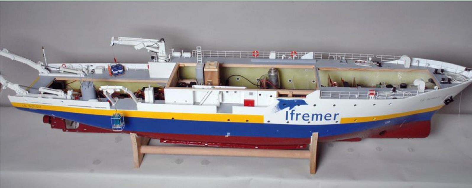
Die Einbauten sind auf diese Weise auch am fertig gestellten Modell optimal zugänglich
