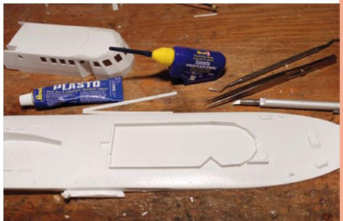
Innerhalb des Deckshauses wird das Süllbord aus Polystyrolstreifen angebracht
