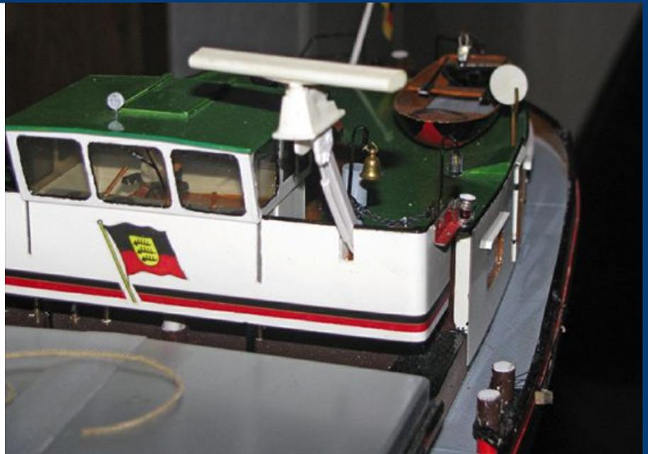
Umklappbarer Radarmast in der Steuerhausnock
