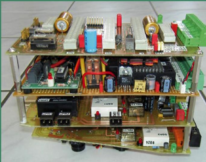
Platinensandwich, links ohne, rechts mit RC-Steckmodulen (Empfänger, Sound- und Nautikmodule). Rechts auf der Unterseite der unteren Platine die Kamera und der LED-Scheinwerfer
