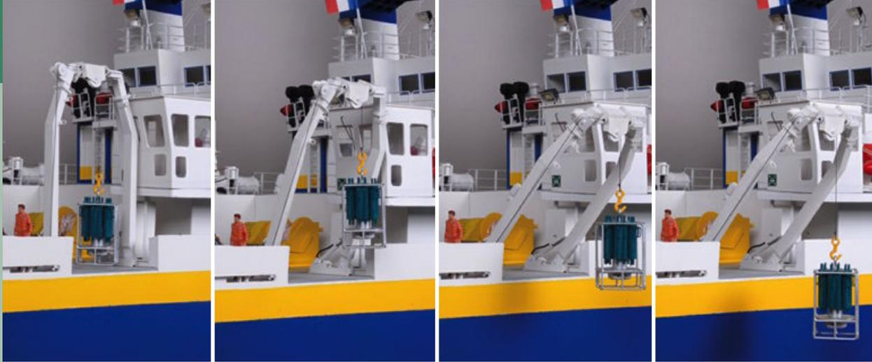
Aussetzen eines Probensammlers mit dem Seitenausleger
