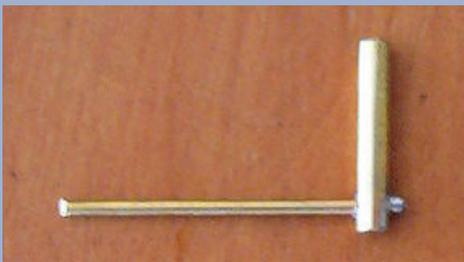
Die Ansteuerung erfolgt bei allen Anlagen über einen Einfach- oder Doppelanlenkhebel und das Ruderservo.
