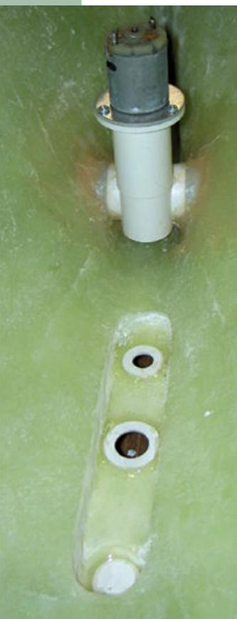
Bugstrahlrudder und Öffnungen für die Unterwasserkamera und Scheinwerfer
