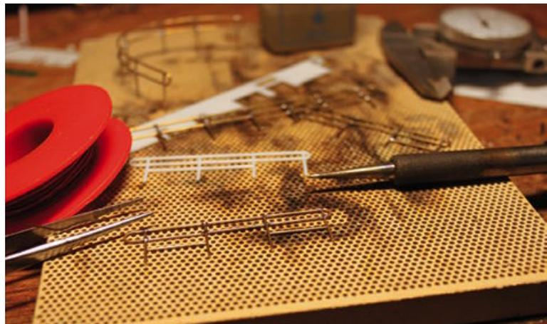
Besonders filigrane Teile neigen bei den Plastikmodellen zum Brechen. Daher wurde die Reling aus Messing nachgebaut und dabei auch gleich dem Vorbild angepasst
