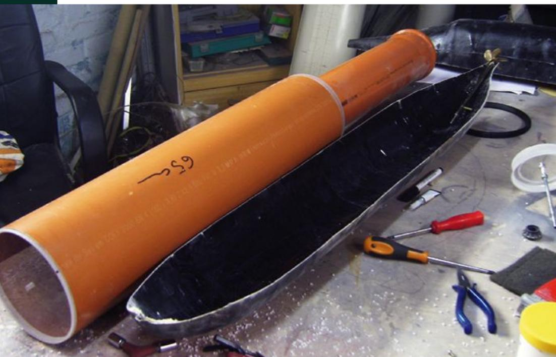
Der innere Druckkörper besteht aus zwei Rohren unterschiedlichen Durchmessers
