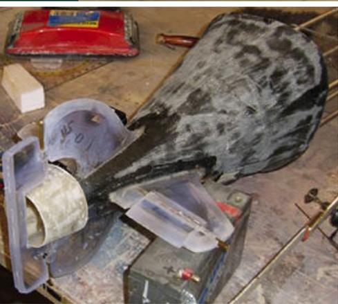
Montage des Hecks mit der Kortdüse
