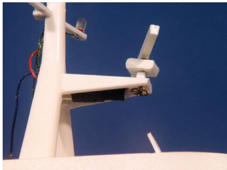
Der Antrieb des Radars ist aus dieser Perspektive zu erkennen. Ein kleiner 1:125-Getriebemotor mit 4 mm Durchmesser findet unter dem Ausleger Platz. Die Achse der Radarantenne wurde unten mit einem Uhrzahnrad versehen und liegt auf der Achse des Getriebemotors auf
