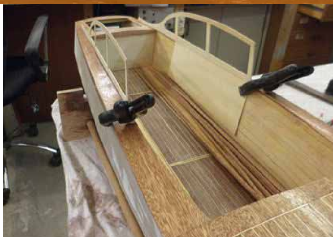
Einpassen der seitlichen Kajütenwände.
