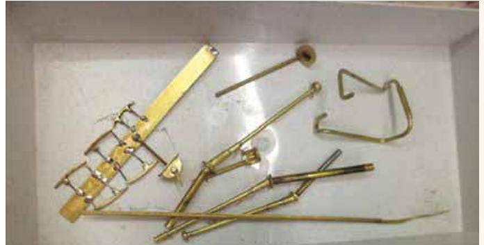
▲ Die Messingteile vorbereitet zum Galvanisieren
