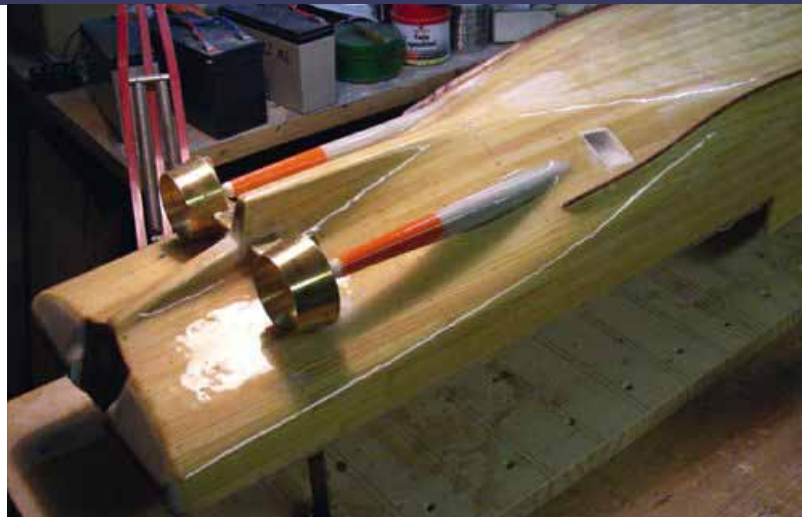
▲▼ Nach dem zweiten Anstrich mit Harz ist der Rumpf fast fertig
