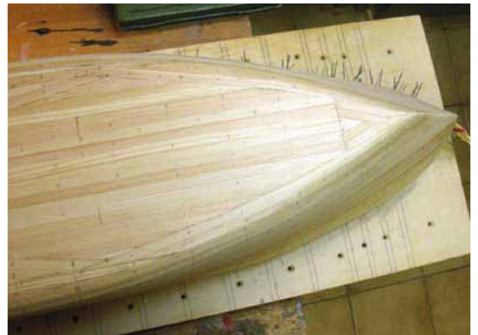
Hier ist zu sehen, wie immer wieder Leisten passend geschnitten werden müssen
