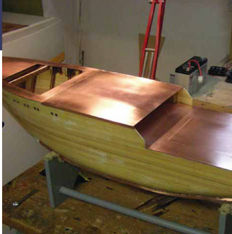
Das Deck aus Platinenmaterial, die Decksöffnungen sind schon vorhanden
