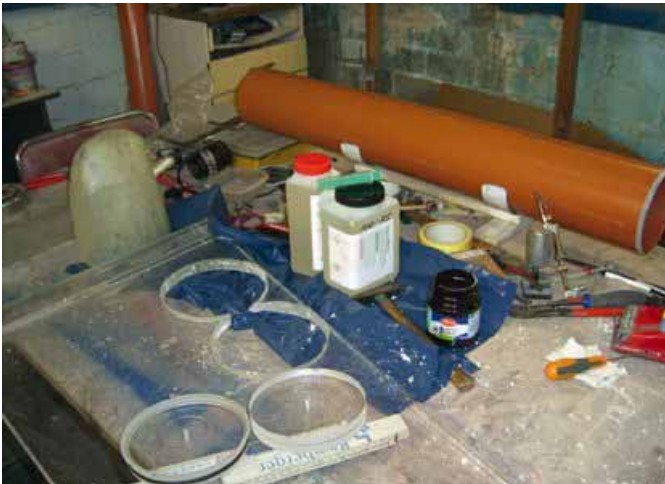
Die beiden gedrehten Deckel liegen bereit, im Hintergrund das KG-Rohr als Basis für den Rumpf
