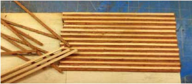
Das Leistenpaket zur Erstellung der verschiedenfarbigen Trittbretter
