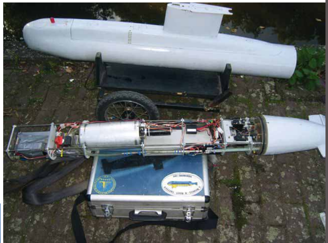
Das Technikgerüst kann komplett aus dem Rumpf herausgezogen werden
