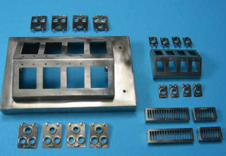
Oberlichter aus Ätzteilen gefertigt
