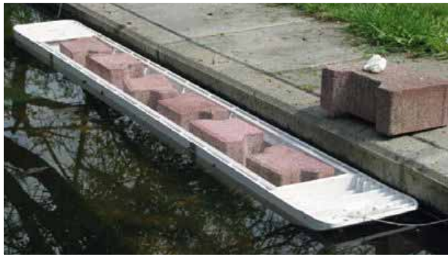
Dichtigkeitsprüfung von Eiltank 58
