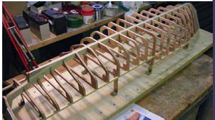
Das Rumpfskelett ist mit Winkeln auf dem Hellingbrett befestigt
