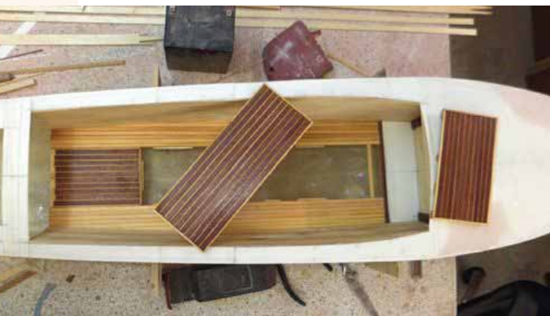
Der verkleidete Innenraum, mit herausnehmbaren Bodenplatten
