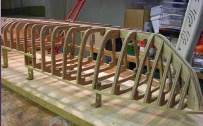
Die Spanten und der Kiel sind passend gefeilt, das Beplanken kann beginnen
