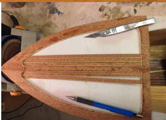
Das Furnier der Decksbeplankung, bereits mit der hellen Lindenleiste umrahmt
