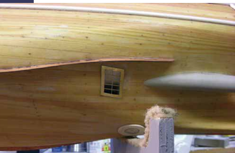
Die Schutzgitter an den Auslassöffnungen der Querstrahler dürfen nicht fehlen
