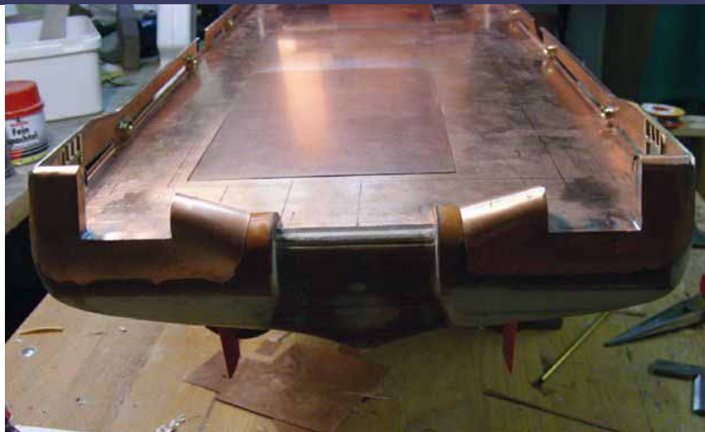
Das Schanzkleid und die Heckpartie sind mit dem Deck verlötet
