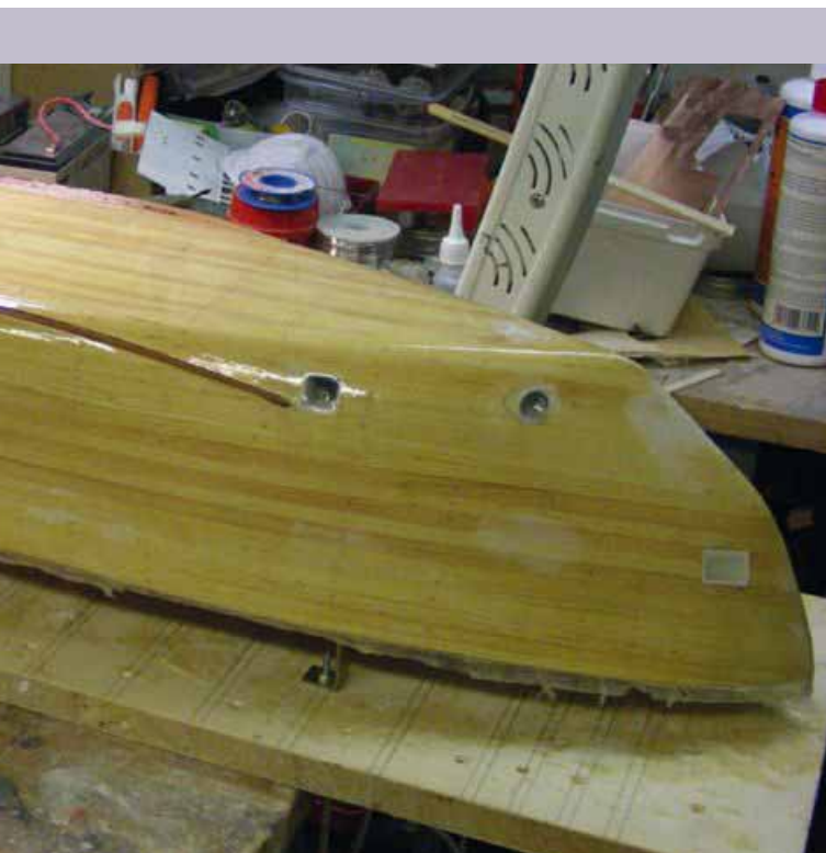
Auch innen muss das Holz mit Harz geschützt werden
