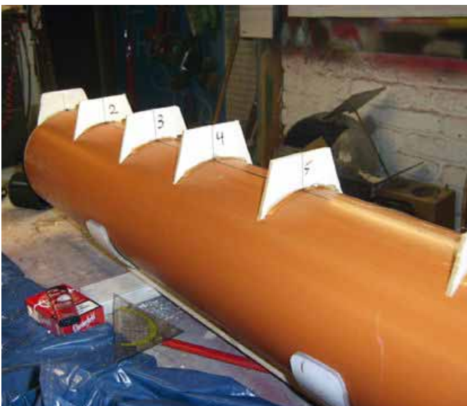
Die Spanten für den Rumpfbuckel sind fixiert ...
