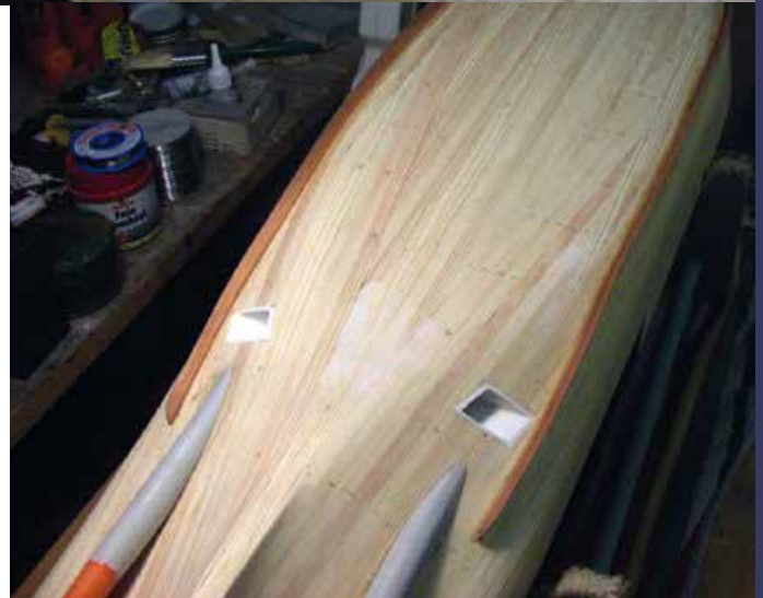
Die eingeklebten Schlingerkiel und die Auslasskanäle des hinteren Querstrahlers sind zu sehen
