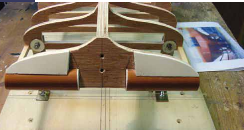
Der Heckspiegel ist aufgefüttert
