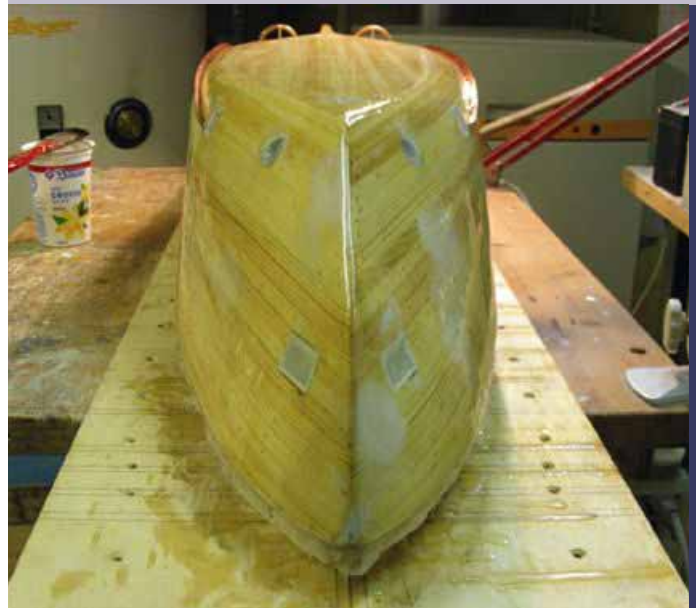
▲▼ Nach dem zweiten Anstrich mit Harz ist der Rumpf fast fertig
