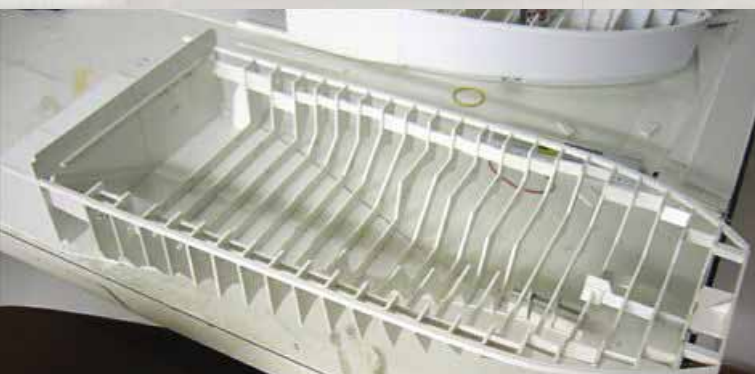
Das Spantgerüst des Hinterschiffs von Eiltank 21
