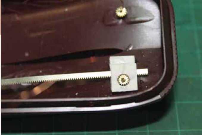
Aufgrund des geringen Platzangebotes werden die Antriebe mittels Zahnstangen gedreht. Diese werden durch Führungen aus Polystyrol an ihrem Platz gehalten
