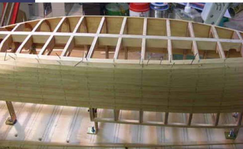
Bei der Beplankung müssen die Leisten mit Nadeln auf den Spanten fixiert werden
