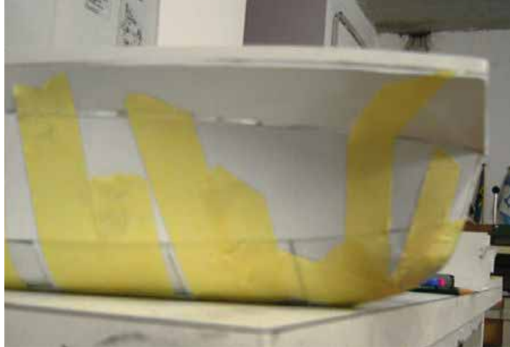
Beplanken des Vorschiffs von Eiltank 21
