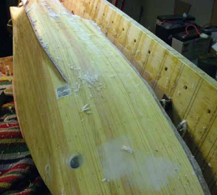
Das Abziehen des Rumpfes und Schleifen ist eine staubige Angelegenheit
