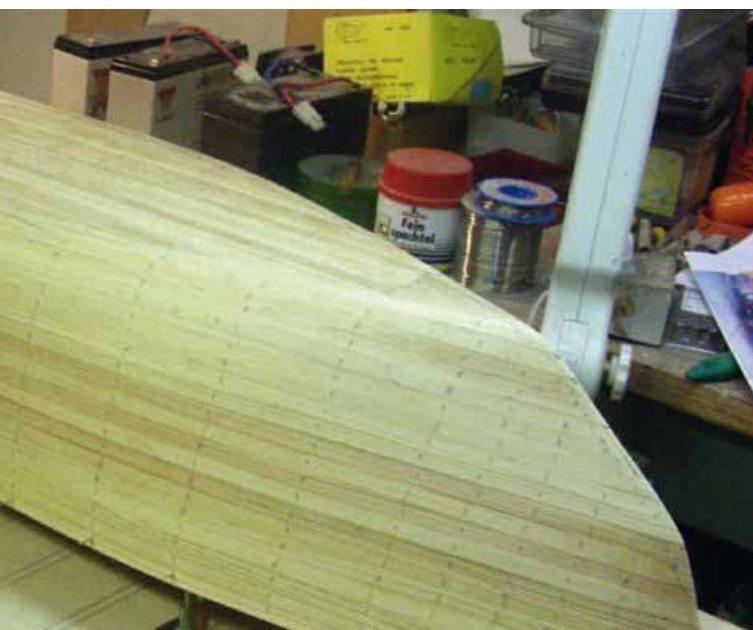
Das Kortdüsensegment ist angepasst, die Querverbindung geht durch den Kiel
