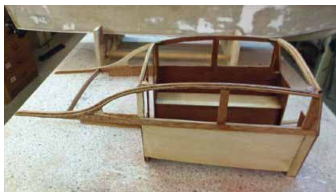
Rohbau der Kajüte: Als optisches Detail wurde wieder eine 1×2-mm-Lindenleiste mit eingebaut
