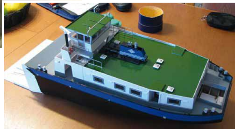
Das fertige Hinterschiff von Eiltank 21
