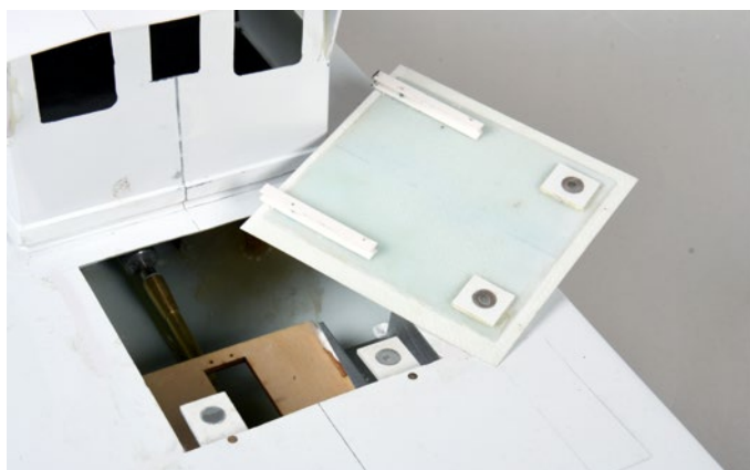
Mit Kunststoffprofilen und Magneten sind die Decksluken vor Spritzwasser geschützt
