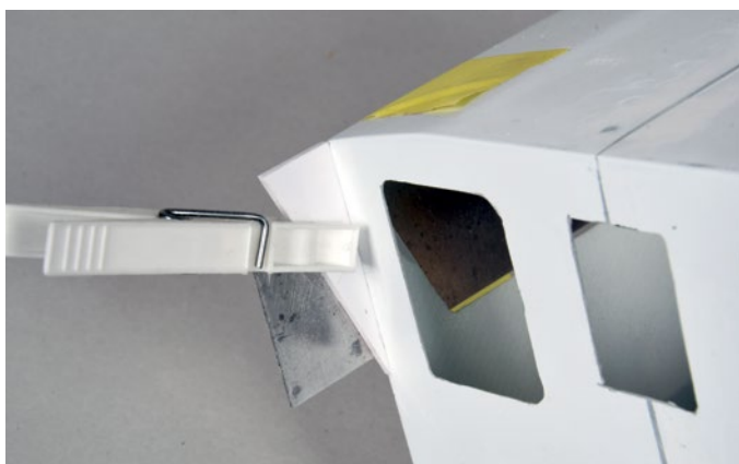
Mit einer Aluplatte als Montagehilfe wird der Abschluss der Brücke angeklebt
