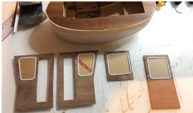
Die Modellteile aus ABS dienten als Vorlage für die Anbauteile aus Mahagoni
