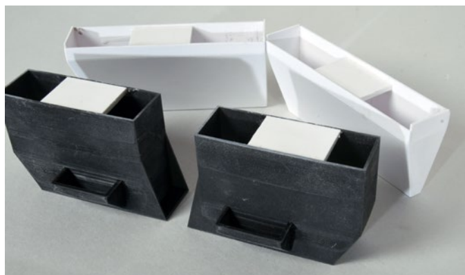
Aus Reststücken werden Bodenplatten zur besseren Stabilität und Montage eingeklebt
