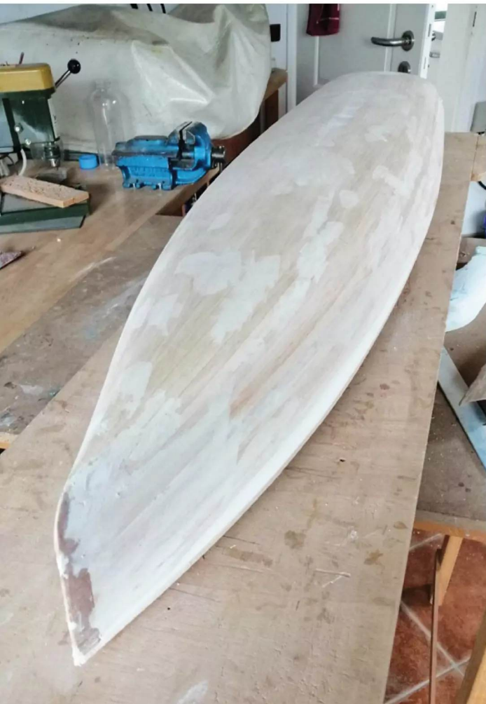
Das Urmodell wird sauber gespachtelt, geschliffen und lackiert
