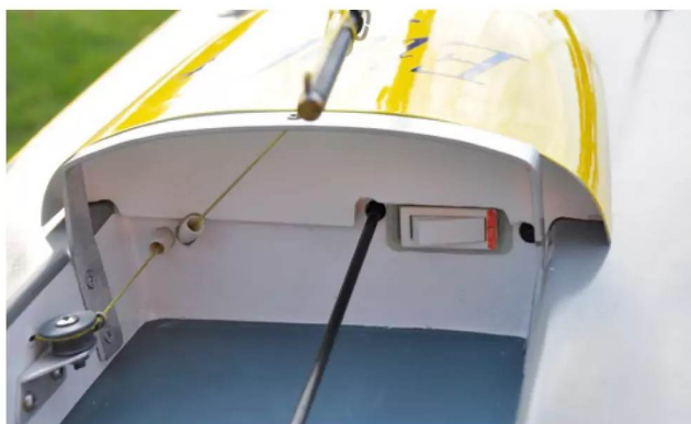
Geschützt unter dem Aufbau ist der Schalter angebracht. Gut zu sehen ist auch die einfache und funktionale Schotführung
