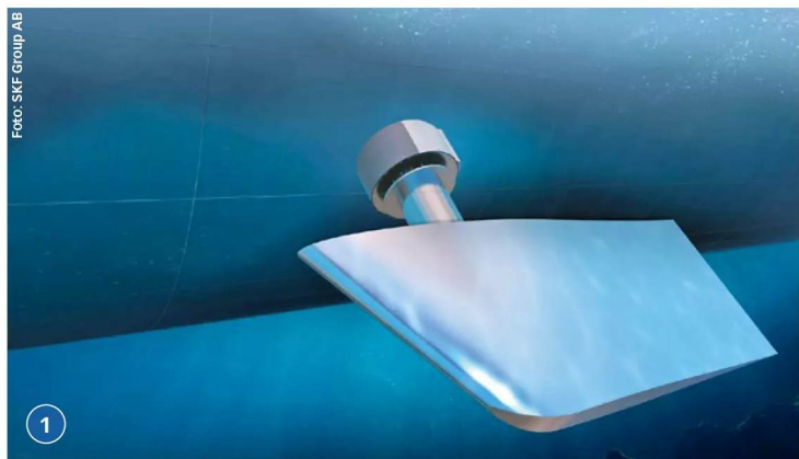
1) Die elektrischen Yacht-Stabilizer der Firma SKF. 2) Das neue Unterwasser-Leuchten Element Discover 3 mit 700 Lumen von OceanLed
