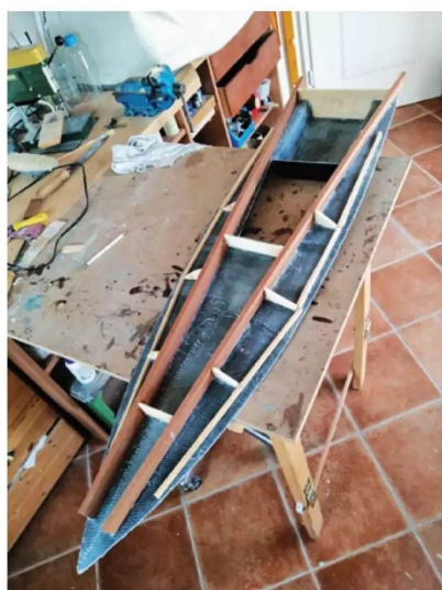
Auch für das Deck wurde eine Negativform angefertigt ...
