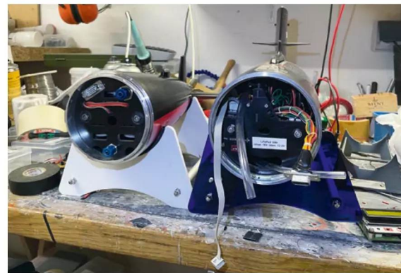
Bug- und Hecksection haben komplett ausbaubare Technischeinschübe
