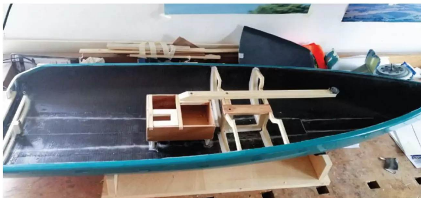
Alle Kräfte werden über ein Holzgestell aufgenommen, in dem auch die RC-Anlage ihren Platz findet
