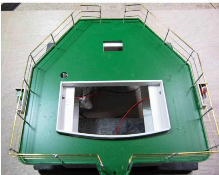
Das Verlöten der Reling muss schnell gehen
