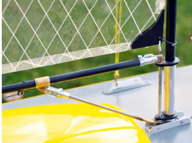
Der Großbaumbeschlag ist robust und der Baumniederholer feinfühlig einstellbar
