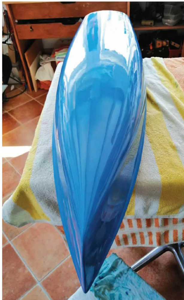
Aus der Urform entsteht die Negativform
