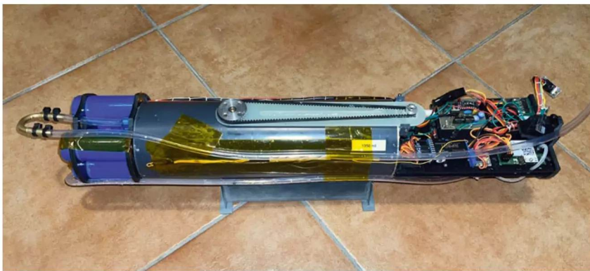
Am Bug sind die Akkus, der Tank und die Fernsteuerung untergebracht
