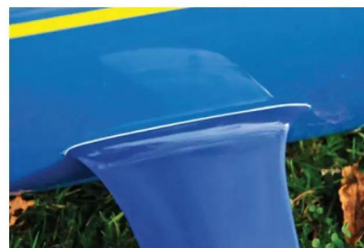
Bemerkenswert ist die aufwändige und vorbildliche Ausgestaltung des Übergangs zwischen Kielflosse und Rumpf
