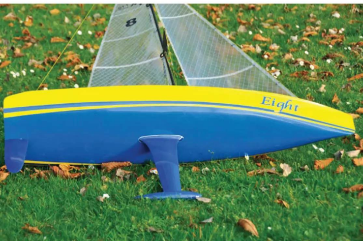
Aus der Perspektive von unten ist am besten zu sehen, wie breit der Rumpf ist – dadurch entstehen optimale Gleiteigenschaften
