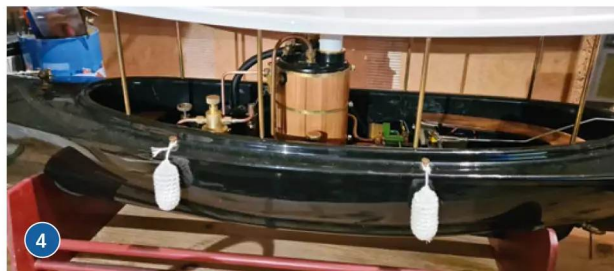
3) Der Kessel ist neu verkleidet und mit der Maschine auf dem Fundament montiert. 4) Die gesamte Dampfmaschine ist eingebaut
