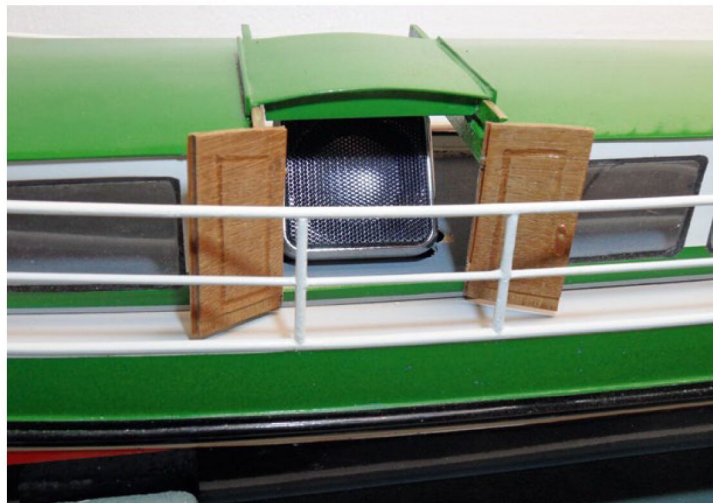
Der Lautsprecher für Schiffshorn und Durchsagen wurde so angebracht, dass die Optik möglichst wenig gestört wird, die Klangqualität jedoch akzeptabel bleibt
