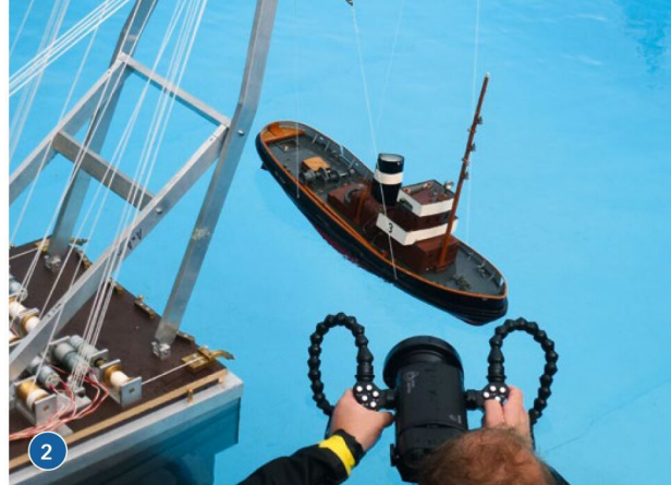
1) Das Modell 2009 beim ersten Schwimmversuch in einem extra dafür errichteten Schwimmbecken. 2) Der Kran ist im Maßstab 1:50 umgesetzt. Damit die Ausmaße des Auslegers nicht zu gewaltig werden und das Modell funktions- und vor allem schwimmfähig ist
