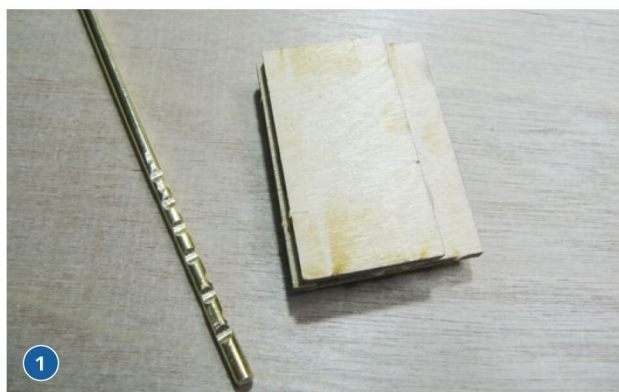
1) Aus Brettchen ist das Ruder zusammenzusetzen. Die nachträglich eingebrachten Vertiefungen in der Ruderwelle dienen nach dem Festkleben als Verdrehssicherung. 2) Einige Elemente sind stumpf auf Rumpf oder Deck zu kleben
