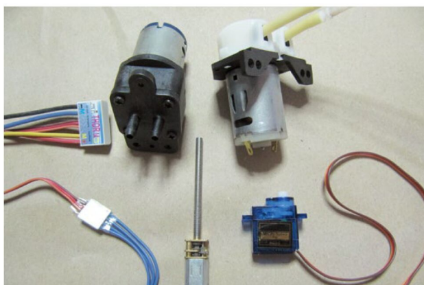
Zwei Pumpen sind in das Modell eingebaut worden. Eine dient als verstecktes Querstrahlruder und die andere imitiert die Bilgepumpe
