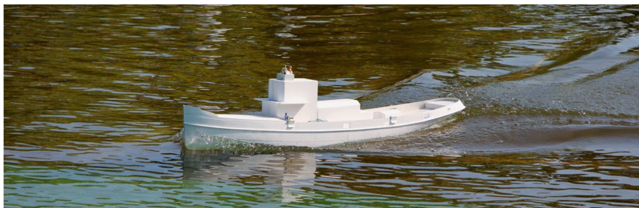
Die erste Probefahrt des rohbaufertigen Modells zeigte es bereits: Die schweren Aufbauten sorgen für ordentlich Krängung in Kurven
