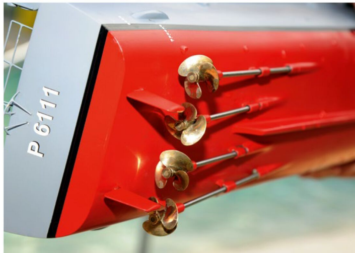
Die Propeller sind aus Messingguss und haben die typische Blattform der Sboot-Props mit den großen Blättern
