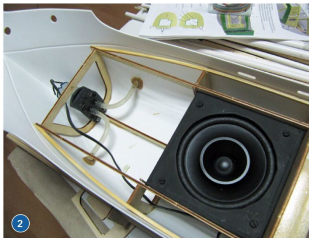
1) Im Heck sind Antriebsmotor, Bilgepumpe und Ruderservo eingebaut. 2) Statt eines deutlich sichtbaren Querstrahlruders, welches das Original nicht hat, ist im Modell ein Pumpstrahlruder eingebaut, um die Manövrierbarkeit zu steigern
