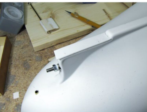
Unterfütterung der Ruderhacke zur Kompensation der Tiefziehradren
