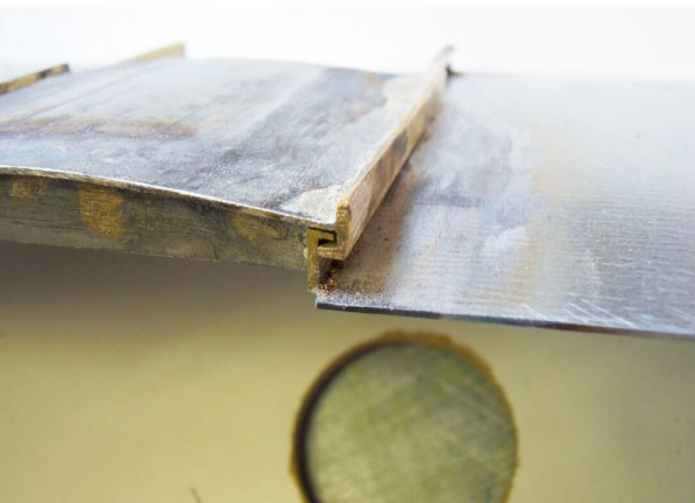
Das Dach wurde aus Blech gelötet und ist dank einer simplen aber effizienten Konstruktion wie im Original beweglich
