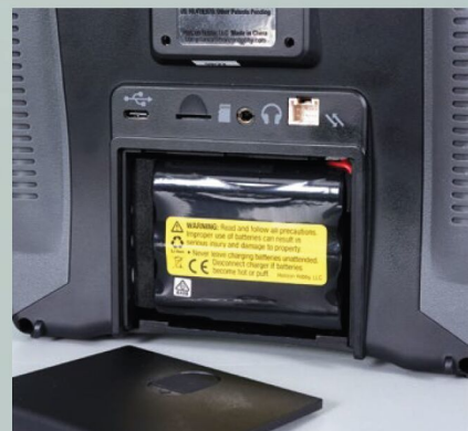
Ein 1s-Lilon-Akku mit 10.500 mAh Kapazität gestattet viele Stunden Betriebsbereitschaft
