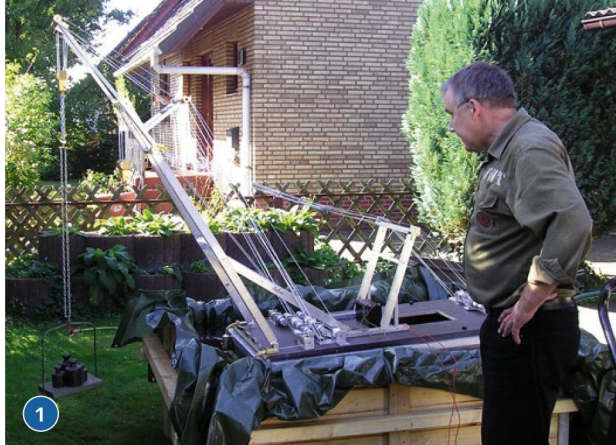
1) Das Modell 2009 beim ersten Schwimmversuch in einem extra dafür errichteten Schwimmbecken. 2) Der Kran ist im Maßstab 1:50 umgesetzt. Damit die Ausmaße des Auslegers nicht zu gewaltig werden und das Modell funktions- und vor allem schwimmfähig ist
