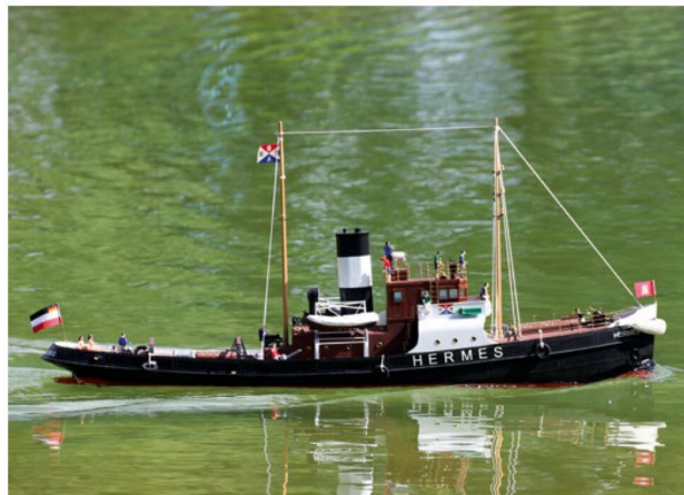
Die Verspannungen bestehen aus dünner Gummilitze, da die Masten beim Transport abgebaut werden
