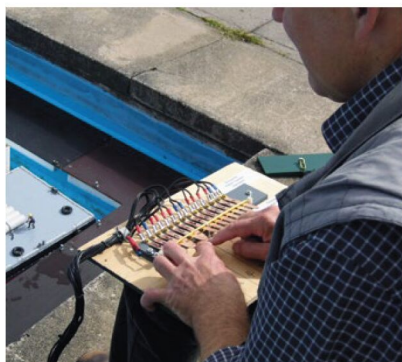
Zunächst war die Steuerung des Krans per Schalterklavier mit Lippenkontakten umgesetzt. Eine echte Fernsteuerung wurde später von den Modellbaukollegen realisiert
