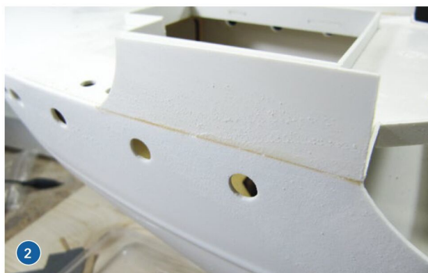
1) Aus Brettchen ist das Ruder zusammenzusetzen. Die nachträglich eingebrachten Vertiefungen in der Ruderwelle dienen nach dem Festkleben als Verdrehssicherung. 2) Einige Elemente sind stumpf auf Rumpf oder Deck zu kleben
