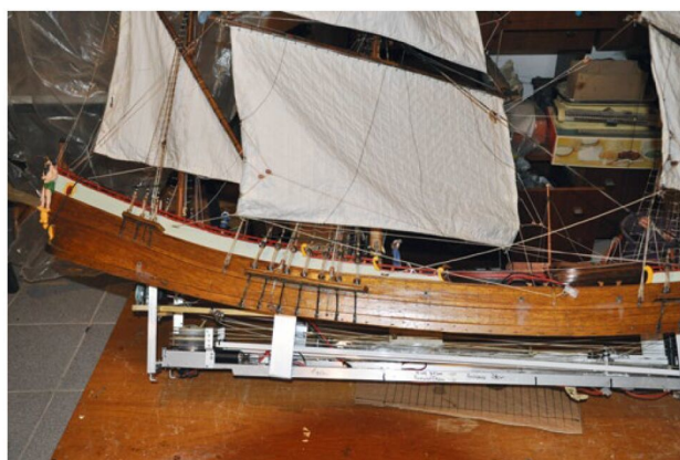
Blick auf das Rumpfbortteil mit der Segel-Technik. Diese ist wartungsfreundlich zugänglich
