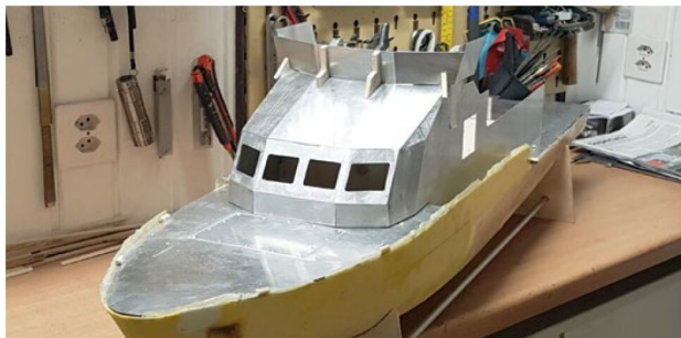
Das Deck und die Aufbauten sind aus Aluminiumblech hergestellt
