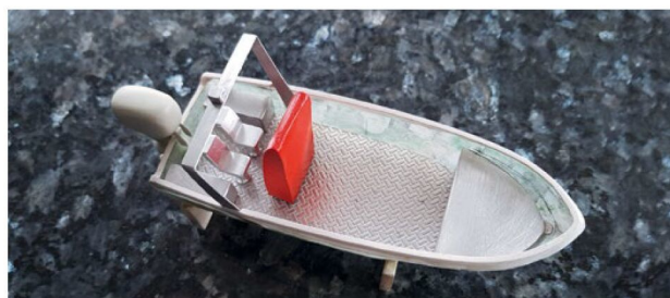
Für den Bau des Beiboots wurde extra eine Negativform erstellt
