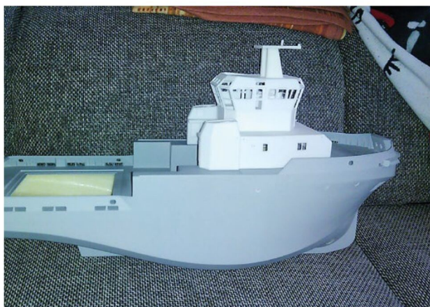
Der neudeutsch bekannte „first look“: Auf dem sauber gefertigten GFK-Rumpf thronen die Aufbauten aus Nylon-Druck
