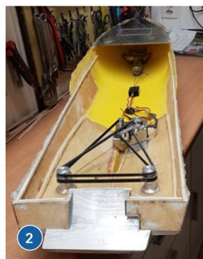
1) Der Fertigrumpf der HAPPY HUNTER erforderte vor allem am Heck einige Umbauten. 2) Die beiden Schottelpropeller werden von der Rumpfmittle aus mit Zahnriemen angetrieben. 3) Mit jeweils zwei Servos können die Löschkanonen gedreht und in der Höhe verstellt werden
