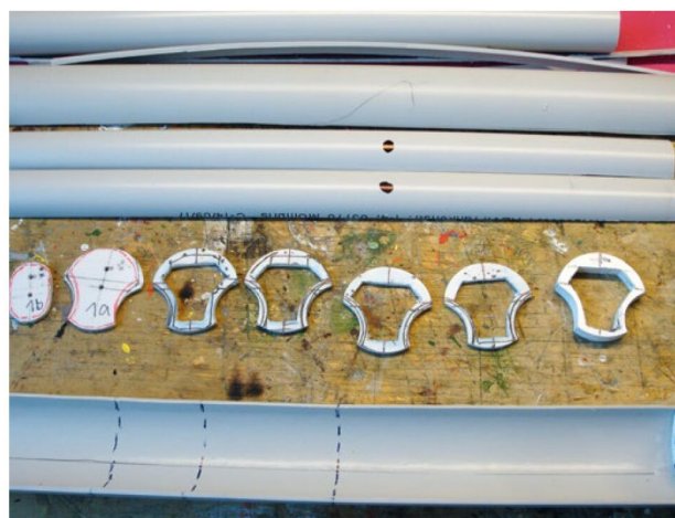
Die restlichen Spanten liegen zum Einbau bereit
