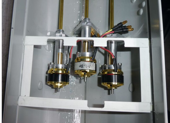
Über den Motoren sitzt der Rahmen für die Hauptplatine
