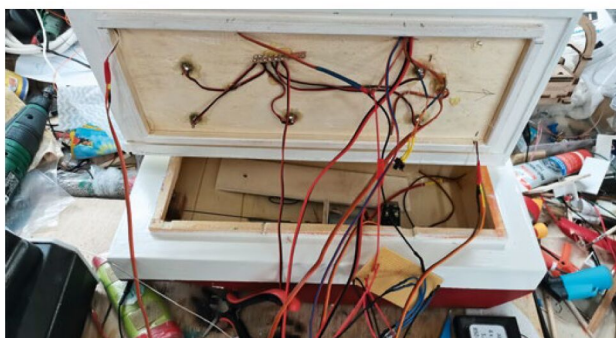
Die Verdrahtung der Beleuchtung sieht wild aus, dient aber nur dem Funktionstest
