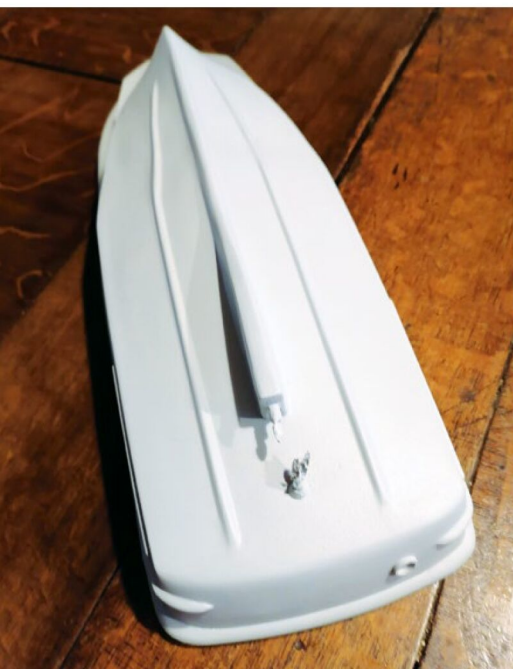
Die Rumpfhälften wurden mit Epoxidharz verbunden und mit Scheuerleisten versehen
