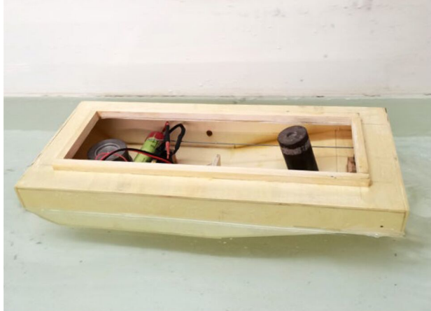
Erster Schwimmversuch des Rumpfs zur Ermittlung der Zuladung
