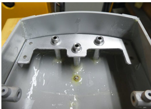
Zum Schluss wurden die Ruder mit einem Querspannt stabilisiert
