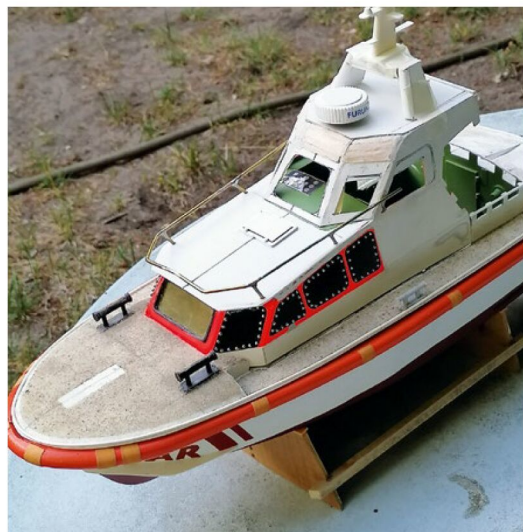
Endlich ist alles an seinem Platz. Auch das Deck ist inzwischen rutschfest besandet
