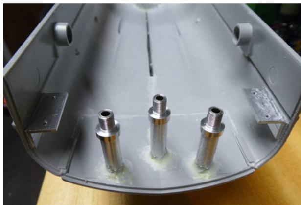
Die Ruderlager wurden vor dem Heckspiegel eingebaut
