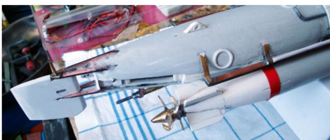
Die Halterungen für die Ruderanlage bestehen aus Platinenmaterial. Das Tiefenruder ist zwar beweglich, aber ohne Funktion
