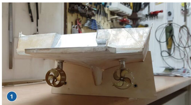
1) Der Fertigrumpf der HAPPY HUNTER erforderte vor allem am Heck einige Umbauten. 2) Die beiden Schottelpropeller werden von der Rumpfmittle aus mit Zahnriemen angetrieben. 3) Mit jeweils zwei Servos können die Löschkanonen gedreht und in der Höhe verstellt werden
