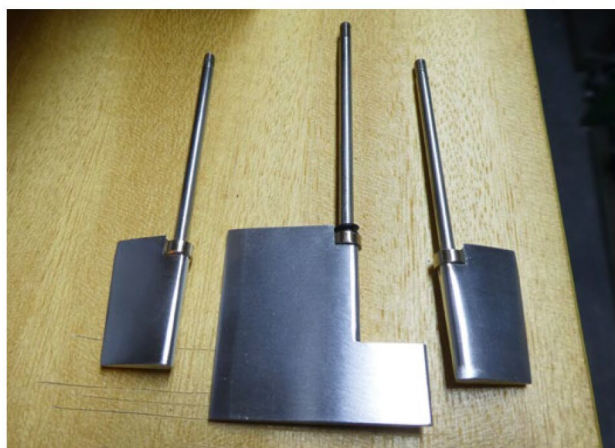
Ruderblätter mit Welle, Druckring und O-Ring
