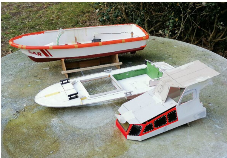
Jetzt konnten die Öffnungen für den Aufbau und die Plicht ins Deck geschnitten werden
