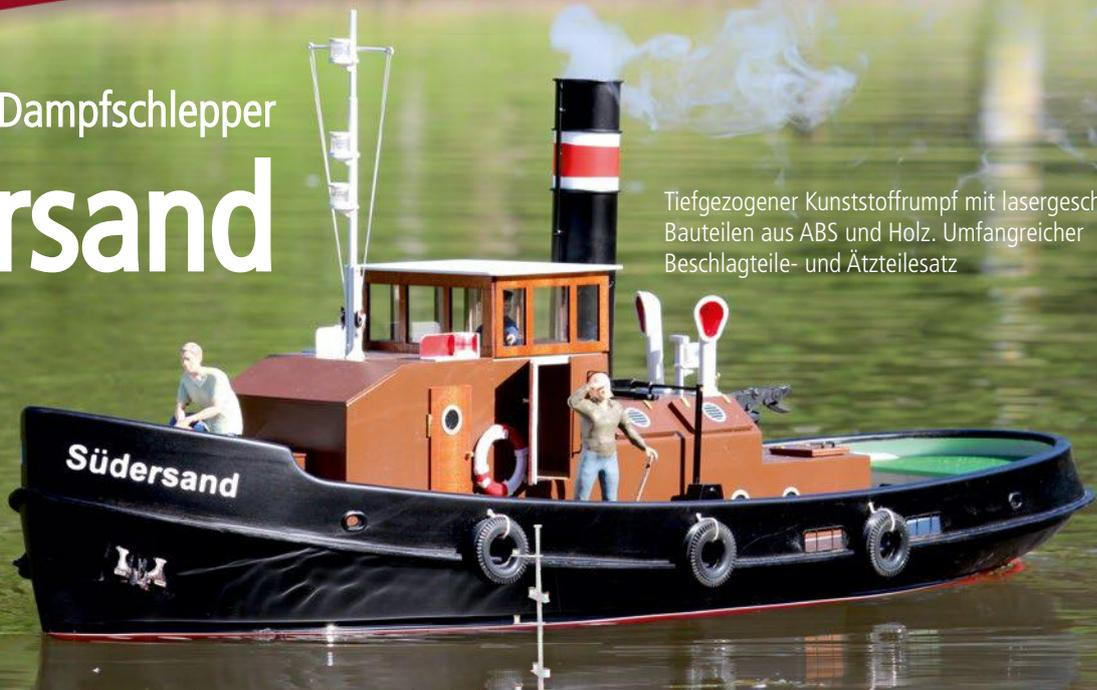
Tiefgezogener Kunststoffrumpf mit lasergeschnittenen Bauteilen aus ABS und Holz. Umfangreicher Beschlagteile- und Ätzteilesatz
