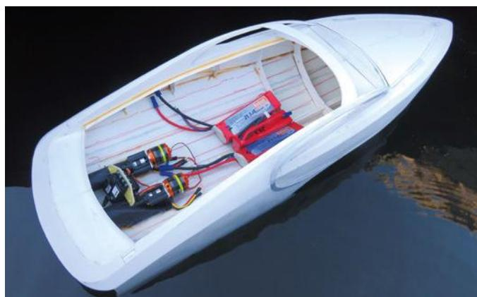
Zeit für eine erste Testwasserung und Dichtigkeitsprüfung
