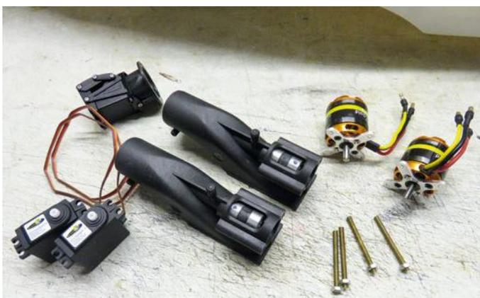
Die beiden Jet-Antriebe der Firma Kehrer sind bereit für den Einbau
