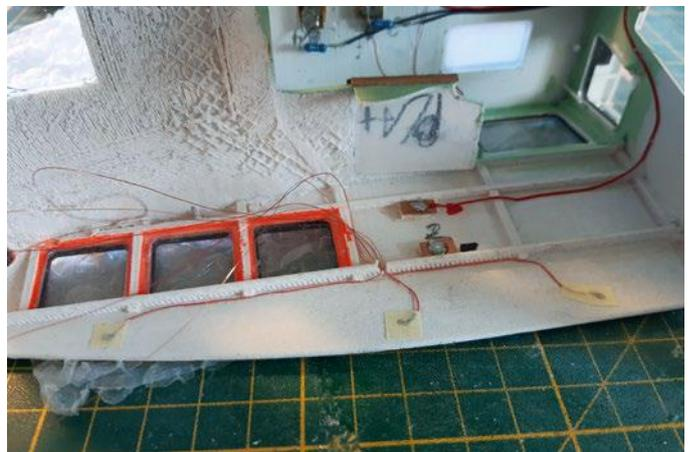
Für die Beleuchtung sind SMD mit Kupferlackdraht verbaut
