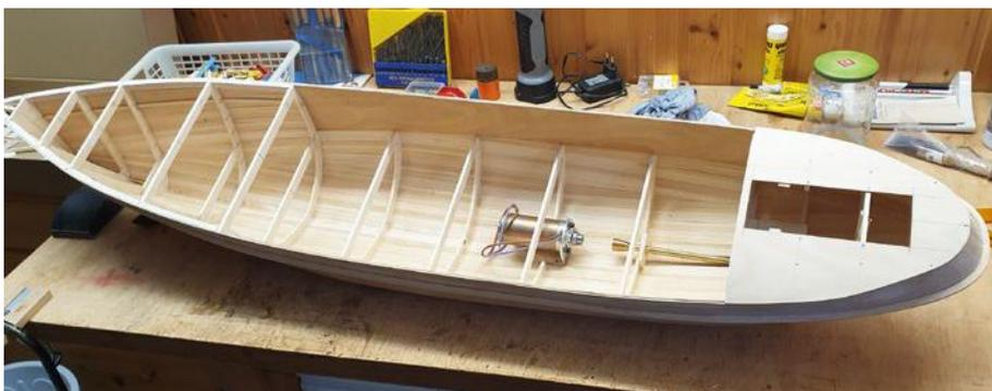
Der Rumpf ist außen und innen mit Ein-Komponenten-Epoxydharz behandelt und nun fertig für die Einbauten
