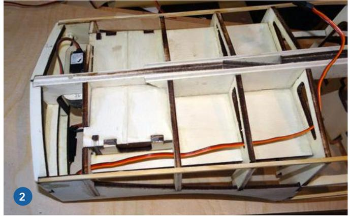
1) Die Stringer am Rumpfboden haben reichlich Spannung und müssen daher von einer resoluten Klammer gehalten werden, während der Kleber trocknet. 2) Das Spantengerüst im Heckbereich. Gut zu erkennen sind der Boden der Plicht und auch der Boden des Akkuraums. Vorsichtshalber wird jetzt schon das Verlängerungskabel zum Lenkservo eingezogen. Das Lenkservo ist ebenfalls schon installiert
