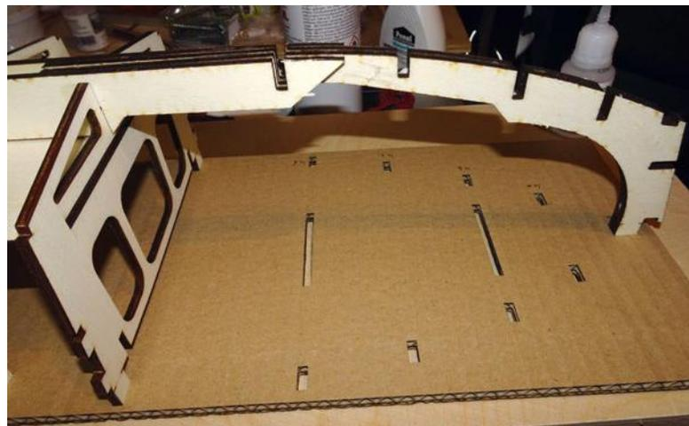
Der Kiel im Bugbereich. Die Helling besteht aus lasergeschnittener Pappe und sorgt für einen verzugsfreien Aufbau
