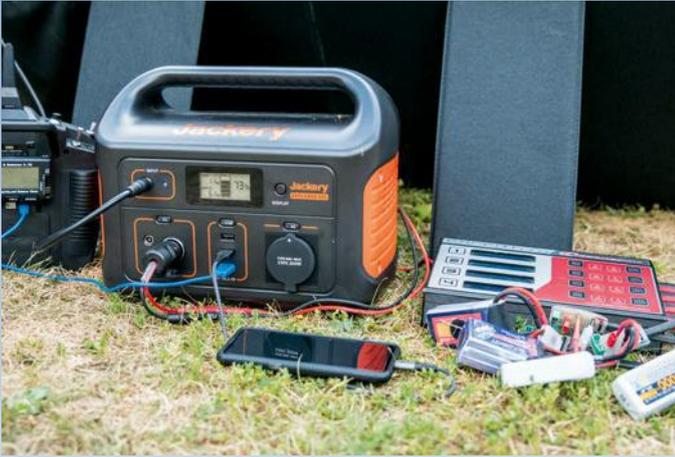
Bei diesem Bild zog eine hinterhältige Wolke vorbei, sodass die Solarzelle von den benötigten 61 W nur müde 11 W zurückspeist. Aber keine Panik: Der integrierte 500-Wh-Puffer hatte noch satte 73% übrig
