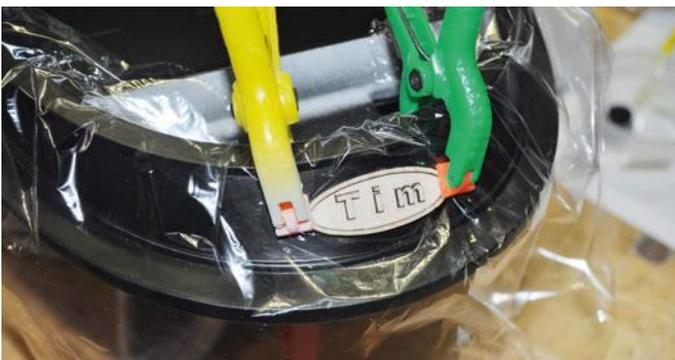
aero-naut hat sich viel Mühe bei Details gegeben, zum Beispiel bei der Namensplatte. Damit diese auch bündig auf der sphärischen Schanz aufliegt, wurde sie direkt darauf zusammengebaut und dabei in Form gepresst. Schutzfolie verhindert ungewolltes Festkleben
