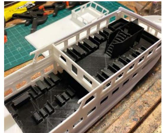
Die gedruckten Einzelteile werden am besten mit einem lösungsmittelhaltigen Klebstoff verbunden
