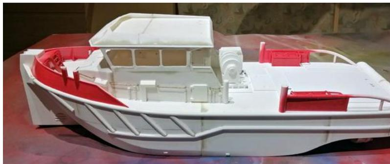
Die Modellbaufarben wurden per Airbrush-Technik aufgetragen. So nähert sich das Modell schnell der finalen Optik an
