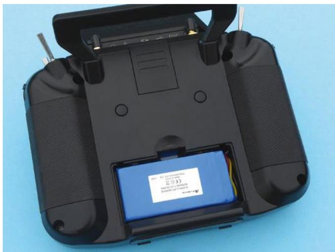
Rückseitig sind das Akkufach und ein Schacht für ein externes HF-Modul sowie zwei weitere Tasten untergebracht, zur Stromversorgung dient ein 2s-LiPo-Akku mit 4.000 mAh
