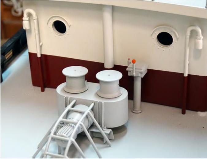
Winde nebst Bedienung und Schwanenhäse sind fertig
