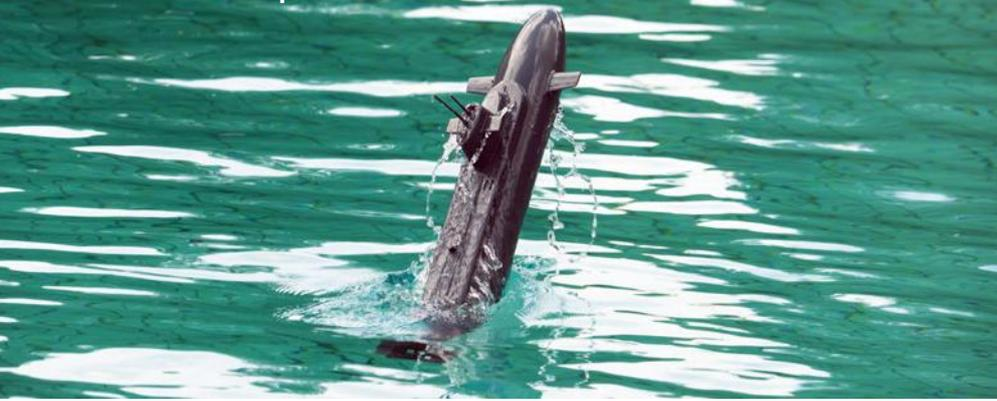
**Simuliertes Notauf-tauchen eines U-Boot-Modells**
