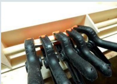
**Passt alles, Leim drauf, mit Klammern zusammenpressen und den Kleber sehr gut trocknen lassen. Fertig ist der geschäftete, gerade Mast**
