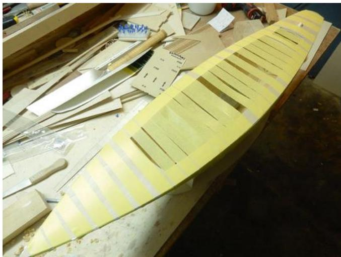
Mit viel Klebeband auf dem Rumpf gehalten, bis der Kleber ausgehärtet ist, kann man das Deck verkleben
