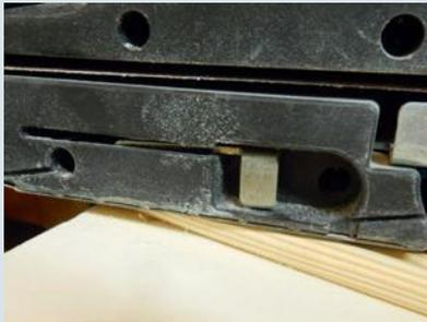
**Beide Rundhölzer werden mit einem Bandschleifer gleichzeitig spitz zugeschliffen. Dazu werden sie nebeneinander auf die Werkbank gespannt und mit dem Bandschleifer die Schräge geschliffen**
