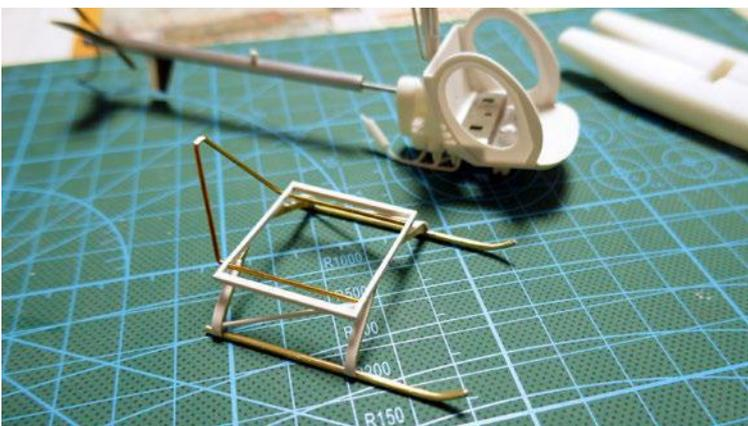
Im Baukasten waren kaum brauchbare Teile für den Heli enthalten, sodass er fast komplett im Eigenbau entstand
