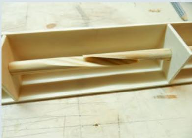
**Die Masthälften werden von beiden Seiten durch die Bohrungen gesteckt und zur Probe zusammengeschieben**
