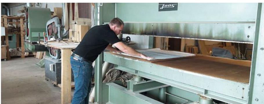
**Eine Spezialität von aero-naut sind mit Textil verleimte Furniere, die ideal für Oberflächenbeplankungen sind – die Fertigung erfolgt direkt in Reutlingen**
