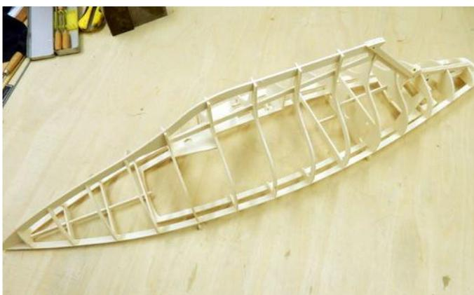
Das Rumpferippe wird mittels gefrästen Deckstringern ausgerichtet
