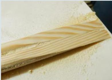
**Dadurch ist sichergestellt, dass beide Schrägen exakt gleich sind. So sieht das nach dem Schleifen aus**
