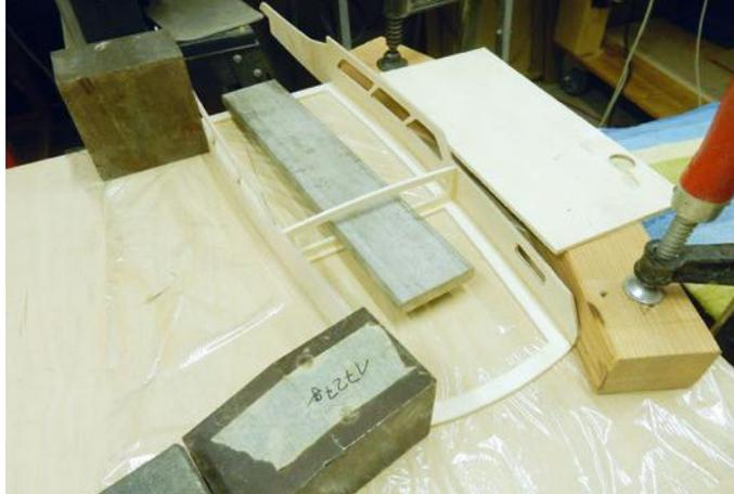
Am Rahmen werden zunächst die Seitenteile geklebt
