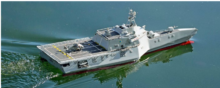
Das Fahrbild bei Einsatz eines 2s-LiPos konnte gar nicht überzeugen, aber der Wechsel auf 3s brachte eine Besserung
