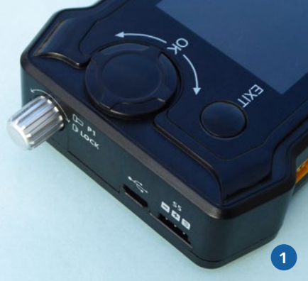
1) Rechtsseitig befindet sich – neben dem USB-Port und dem Eingang für externe Impulse – der versenkbare Drehknopf für die manuelle Servo-Betätigung. 2) Auf der Rückseite erfolgt die Spannungsversorgung über einen ST-60-Anschluss. 3) Über die linksseitig angebrachten Ausgänge können bis zu vier Servos einzeln oder kombiniert angesteuert werden
