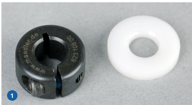
1) Stelling mit Inbusschraube und Loctite versehen sowie das zugehörige Drucklager. 2) Alle drei Wellentypen in der Übersicht. Bei I lässt sich die einfache Konzeption erkennen, mit II liegt ein gängiges Konzept vor und bei III kann man kraftvolle Antriebe sicher einsetzen
