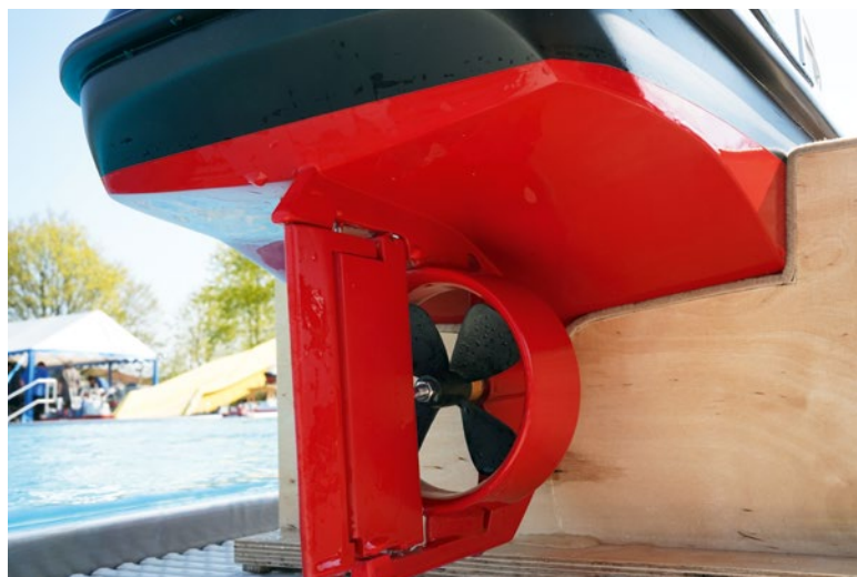
Mit Hilfe von Kortdüse und Beckerruder sind exakte Fahrmanöver möglich
