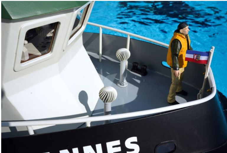
Elektromotoren versetzen die Kugellamellen-Lüfter in Rotation
