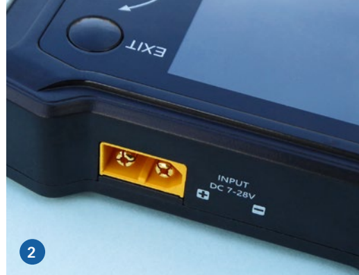
1) Rechtsseitig befindet sich – neben dem USB-Port und dem Eingang für externe Impulse – der versenkbare Drehknopf für die manuelle Servo-Betätigung. 2) Auf der Rückseite erfolgt die Spannungsversorgung über einen ST-60-Anschluss. 3) Über die linksseitig angebrachten Ausgänge können bis zu vier Servos einzeln oder kombiniert angesteuert werden
