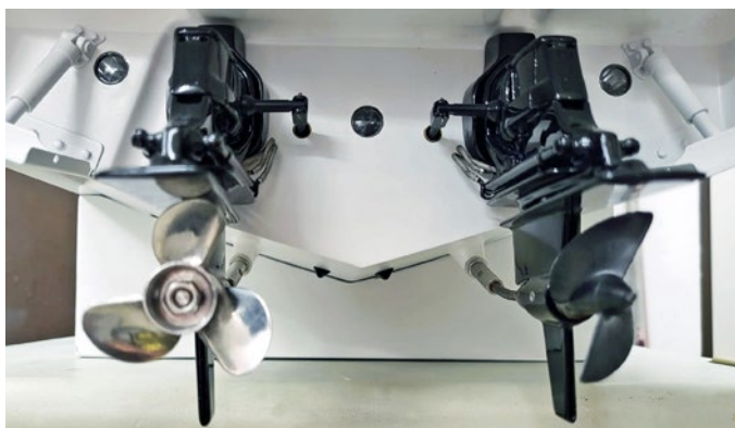
Die mit Druckluftschläuchen und Zylindern versehenen Z-Drives am Heck eines Targa-Modells
