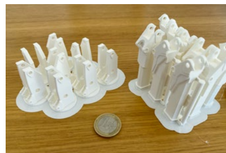
Massenproduktion für Teile eines Krans im Maßstab 1:25. Solches Zubehör ist nachgefragt
