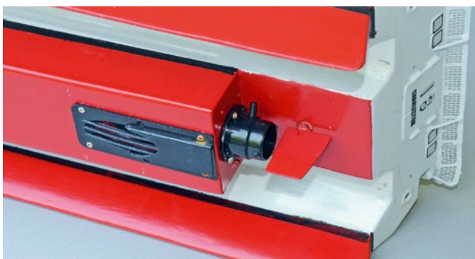
Um den Wendekreis zu reduzieren, erhielt das Modell mangels ungenügend schwenkbarer Düse ein Ruder
