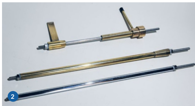
1) Stelling mit Inbusschraube und Loctite versehen sowie das zugehörige Drucklager. 2) Alle drei Wellentypen in der Übersicht. Bei I lässt sich die einfache Konzeption erkennen, mit II liegt ein gängiges Konzept vor und bei III kann man kraftvolle Antriebe sicher einsetzen
