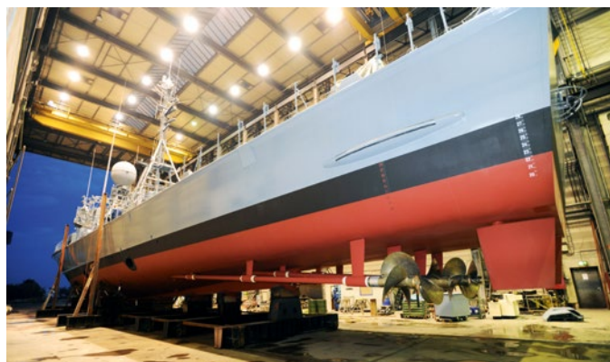
Freilaufende Wellenanlage beim Schnellboot PUMA, das hier im Trockendock liegt
