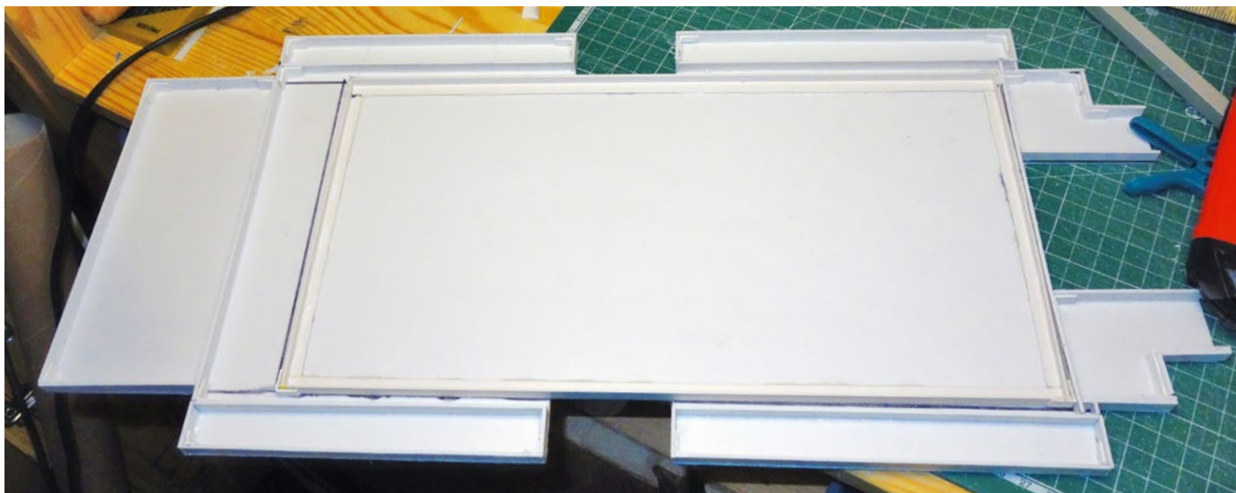
Auf den Süllrand wurde ein Rahmen aus Winkelprofil gelegt und zusammengeklebt. Darauf kam eine 1,5-mm-Polystyrol-Platte
