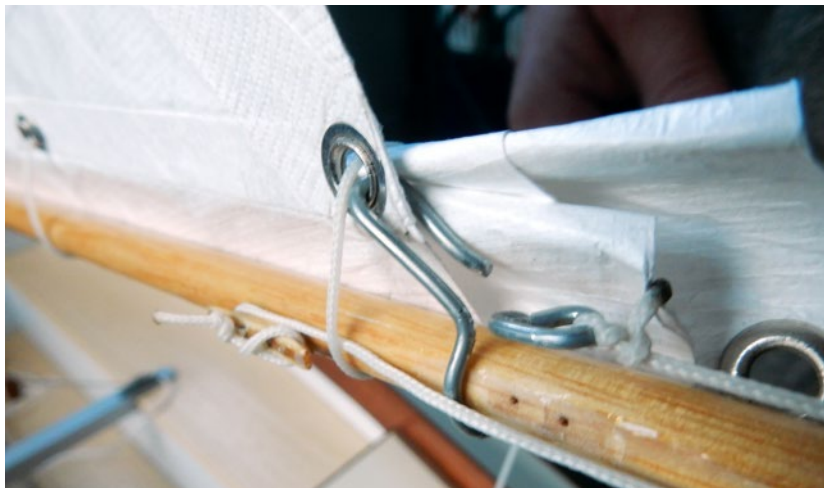
Auch das Schothorn wird an einem Haken eingehängt, nur muss dieser auf dem Baum rutschen können, damit das Unterliek eingestellt werden kann, ...
