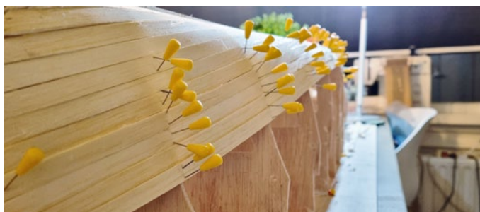
Der gesamte Rumpf wurde mit 3-mm-Balsaholz beplankt
