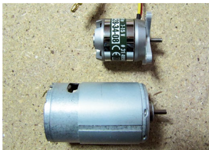
Statt der im Baukasten enthaltenen Bürstenmotoren kamen im Modell leistungsstarke Brushless-Außenläufer zum Einsatz
