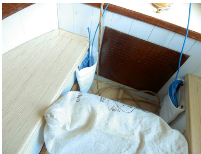
Die Fallen werden in kleinen Taschen verstaut, damit sie nicht im Cockpit für Unordnung sorgen
