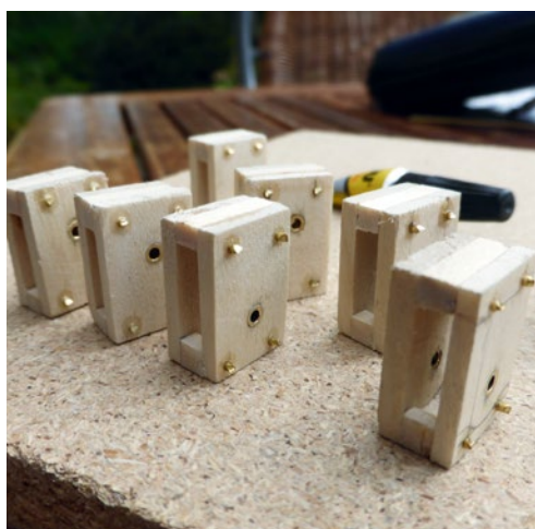
Die Blöcke entstanden aus Holz und Messing. Nachdem alles in Form gebracht war, gab es noch einen Anstrich im Holzlook
