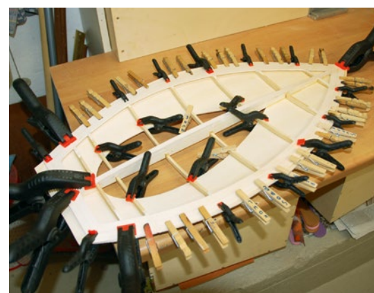
Das Deck entstand ebenfalls komplett in Holzbauweise
