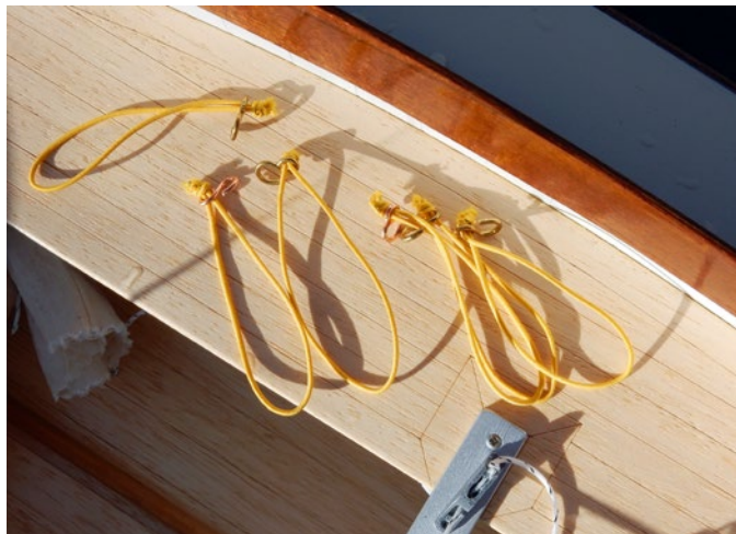
... sie entstehen aus Gummiband und selbst gebogenen Takelhaken
