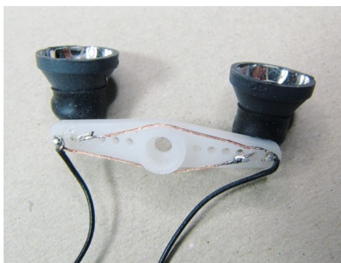
Die schwenkbaren Arbeitsscheinwerfer wurden auf einem Servohebel montiert
