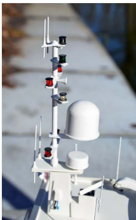
Der neue Signalmast mit den selbstgebauten Leuchtkörpern
