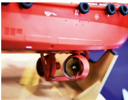
Die beiden Schottelantriebe der TEXELBANK können komplett unabhängig voneinander gesteuert werden
