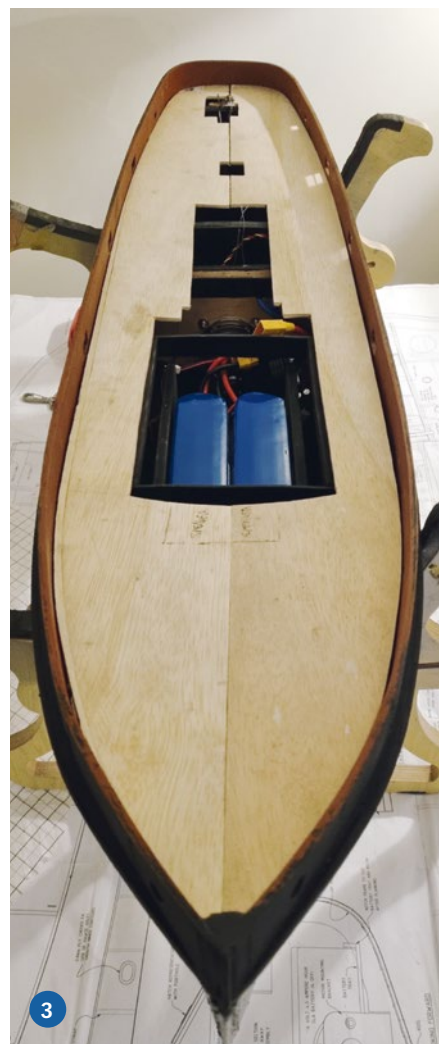
1) Das Modell im Rohbau ist fertig. 2) Der Rumpf wurde komplett mit Alublechen und kleinen Messingnägeln beplankt. So entstand genau der gleiche Look wie beim Original. 3) Das Deck entstand aus zwei einzelnen Teilen, um es besser und ohne Spannung montieren zu können
