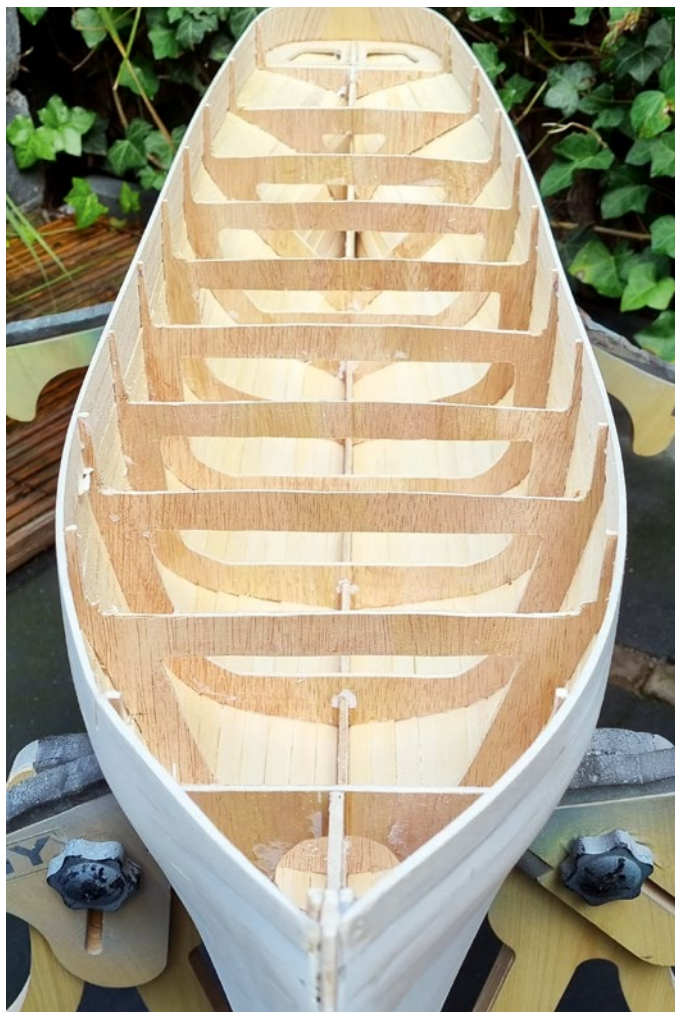
Nach vielen Stunden Beplankungsarbeiten war der Rumpf im Rohbau fertig
