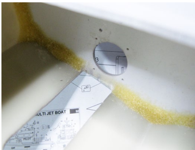
Die Ausschnitte für die Jet-Antriebe im Rumpf
