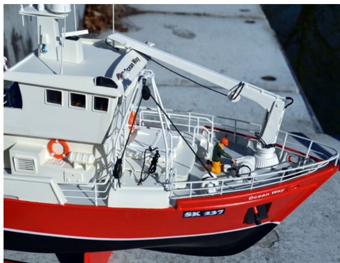
Das Schanzkleid wurde teilweise entfernt, dafür gab es eine vollumfängliche gelötete Reling
