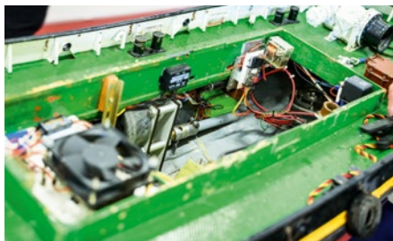
Zwei Industriemotoren treiben die DAVID an. Sie kommen auch zum Beispiel in Rasenmähern zum Einsatz
