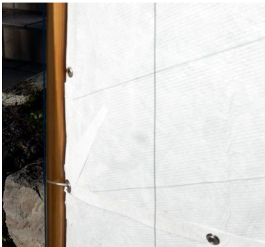
Das Segel muss am Hals verstärkt werden, damit die Kräfte gut ins Segel eingeleitet werden
