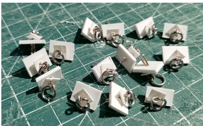
Die Laschhilfen werden später auf dem Boden verklebt und dienen zum Verzurren der Ladung
