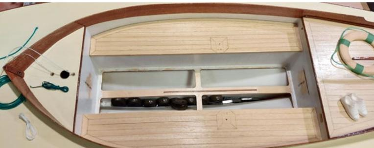
Das Gewicht im Kiel ist beim Testmodell entnehmbar. Darum waren kleine Anpassungen wie der Zugang zum Rumpfinnereen umzusetzen
