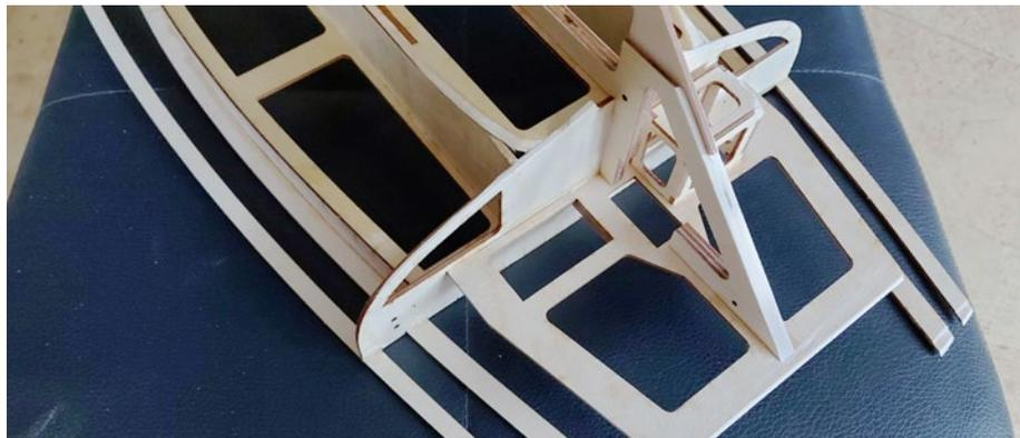
Etwas Schleifarbeit hilft beim optimalen Einpassen des Rumpfgerüsts
