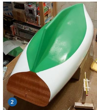
1) Lackieren des Süllrands. Eine Folie schützt das bereits mit Oracover-Folie bebügelte Deck. 2) Fertig lackierter Rumpf. Die exakte Position der Wasserlinie ließ sich zuvor mit Hilfe der selbst gebauten Zeichenhilfe sauber markieren
