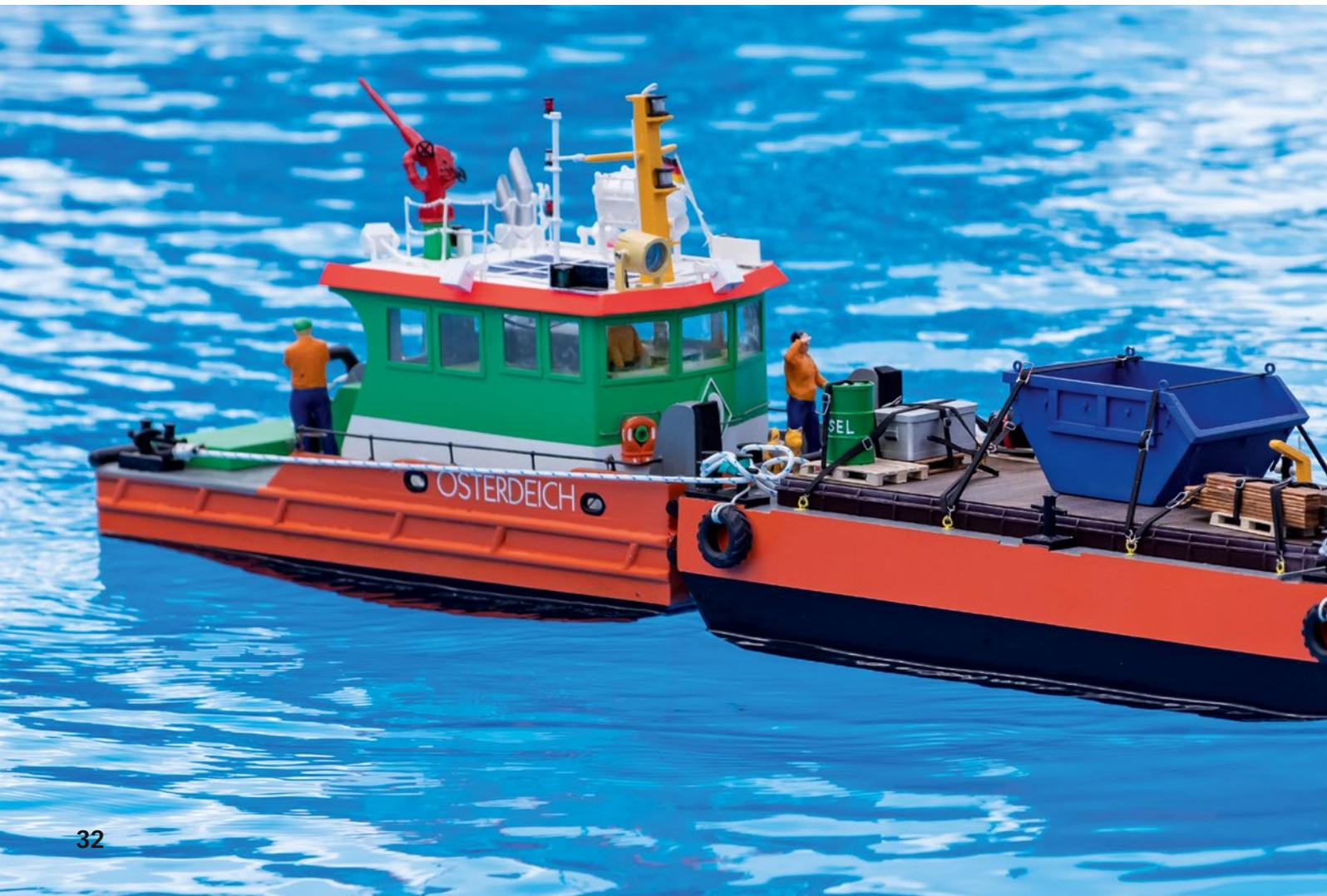
Der Schwimmkörper mit Deck und Süllrand dient dabei als Grundlage für die verschiedenen Auflagen/Aufbauten. Die erste Version bekam einen Schubleichter-Einsatz und einen Ponton-Aufbau. Beides wurde improvisiert gebaut. Der Wechsel funktionierte in nicht einmal 5 Minuten, aber es zeigte sich schnell, dass beide Nutzer lieber die ganze Fahrzeit mit ihrem Objekt verbringen möchten. So wurde kurzerhand auf Basis des Grundbauplans ein zweiter Schubleichter gebaut.
