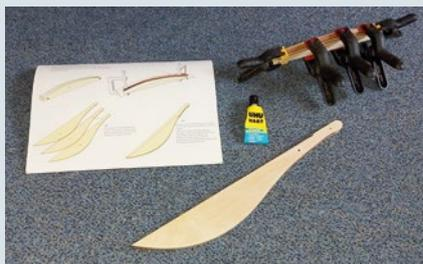
Dreidimensionale Zeichnungen in der Anleitung geben Orientierung. So entstehen das Ruderblatt und die Ruderpinne aus mehreren Holzschichten – letzteres wird sogar in Form gepresst
