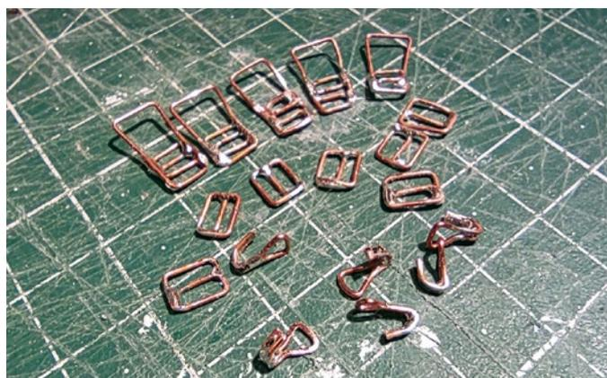
Spanner und Haken für die Laschgummis entstanden aus Büroklammerdraht und wurden verlötet
