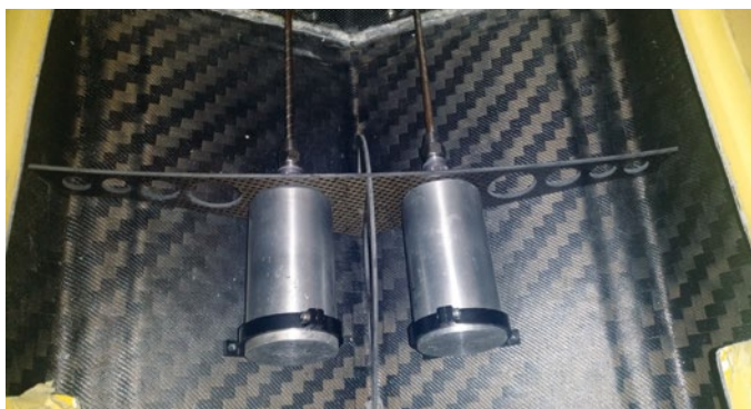
Genauere Ausrichtung und Positionierung der Motorspannen im Rumpf und Vorbereitung aller Klebeflächen
