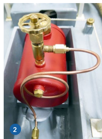
1) Kolben mit Rückplatte und Montagesockel. Damit alles reibungslos läuft, war Feinschliff erforderlich. 2) Der neue Gastank war nach dem missglückten Versuch, den alten zu vergrößern, nötig
