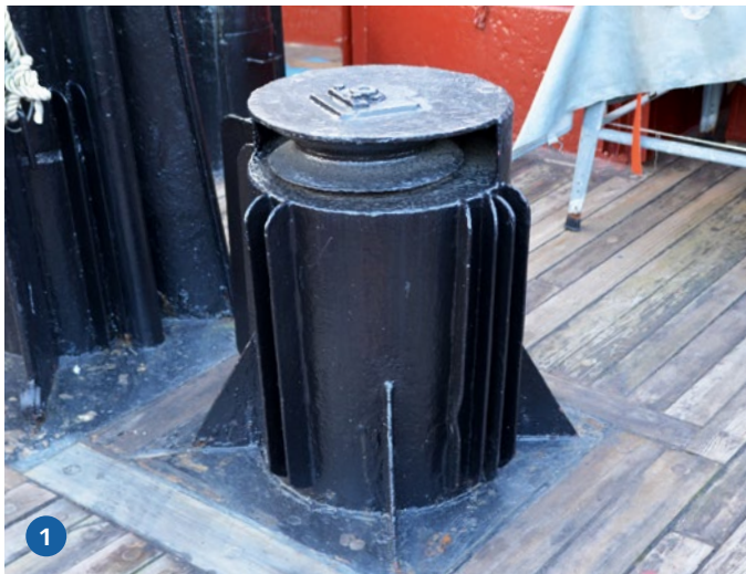
1) Eine Königsrolle am Originalschiff EISHAI. 2) Der Kettenkneifer und die Ankerkette am Original. 3) Der Propeller mit Düse und Ruder des Modells ist ebenfalls dem Original nachempfunden. Selbst die Opferanoden fehlen nicht. 4) Ein modernes Scherbrett ist komplexer als man annehmen mag. Das Bild kann als Vorlage für vorbildgetreue Nachbauten dienen
