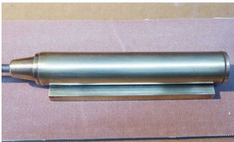
Einer von zwei neuen Kolben im einbaufertigen Zustand. Der Zylinder ist im passenden Durchmesser aus dem Vollen gedreht worden
