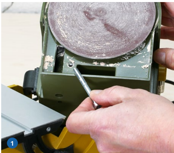
1) Zum Demontieren des Arbeitstischs ist eine Inbusschraube zu lösen. 2) Dank Silikonbeschichtung lassen sich Schleifscheiben einfach lösen und mehrfach verwenden. 3) Ohne Arbeitstisch und in Hochkant-Position ist möglich, aber eine Lösung für die Absaugung erforderlich
