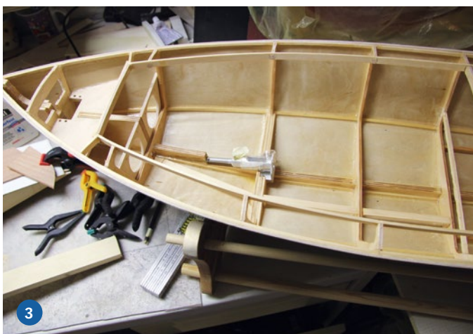
1) Der Rumpf entsteht über Kopf aus Sperrholzspanten. 2) Nachdem das Spantengerüst fertiggestellt war, konnte es ans Beplanken gehen. 3) Der Einbau der Wellenanlage erfolgt. 4) Der Bürstenmotor Power 755/40 von robbe hat ausreichend Leistung für das Modell
