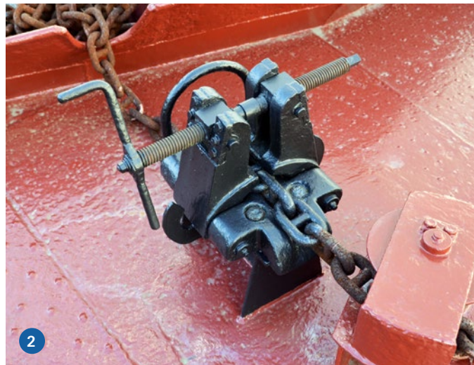
1) Eine Königsrolle am Originalschiff EISHAI. 2) Der Kettenkneifer und die Ankerkette am Original. 3) Der Propeller mit Düse und Ruder des Modells ist ebenfalls dem Original nachempfunden. Selbst die Opferanoden fehlen nicht. 4) Ein modernes Scherbrett ist komplexer als man annehmen mag. Das Bild kann als Vorlage für vorbildgetreue Nachbauten dienen
