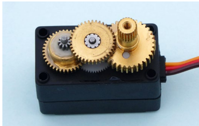
Auch das preiswerte analoge Servo ist mit einem Metallgetriebe ausgestattet
