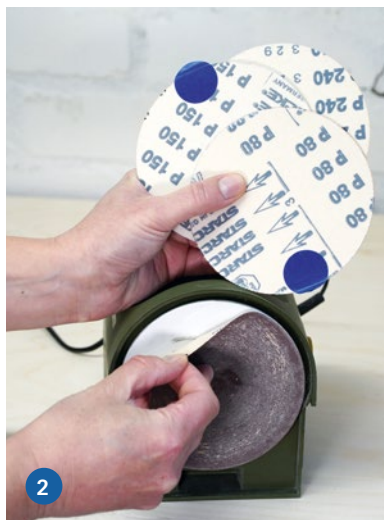
1) Zum Demontieren des Arbeitstischs ist eine Inbusschraube zu lösen. 2) Dank Silikonbeschichtung lassen sich Schleifscheiben einfach lösen und mehrfach verwenden. 3) Ohne Arbeitstisch und in Hochkant-Position ist möglich, aber eine Lösung für die Absaugung erforderlich
