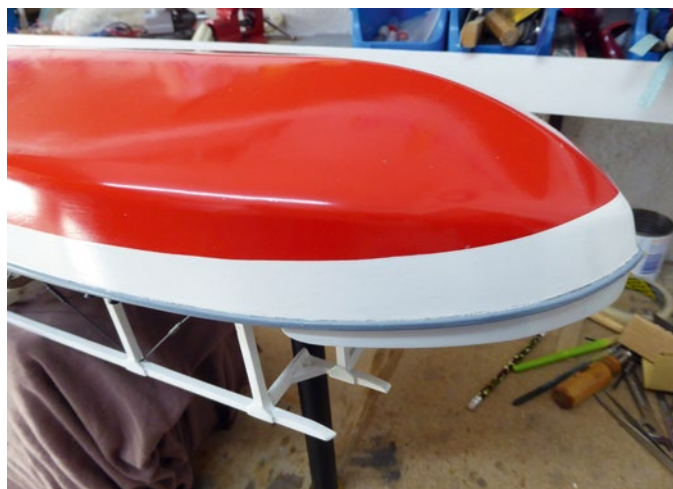
Das Original-Unterwasserschiff sollte eine Aufdoppelung erhalten, um den Auftrieb beziehungsweise Tiefgang zu erhöhen
