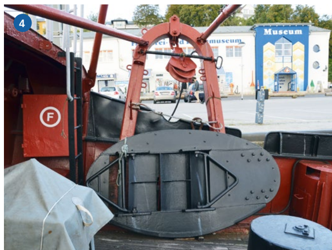
1) Eine Königsrolle am Originalschiff EISHAI. 2) Der Kettenkneifer und die Ankerkette am Original. 3) Der Propeller mit Düse und Ruder des Modells ist ebenfalls dem Original nachempfunden. Selbst die Opferanoden fehlen nicht. 4) Ein modernes Scherbrett ist komplexer als man annehmen mag. Das Bild kann als Vorlage für vorbildgetreue Nachbauten dienen
