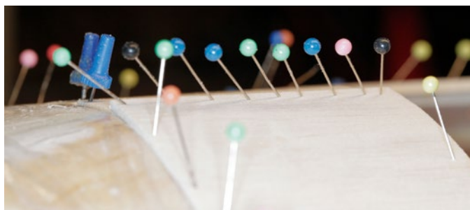
Scharf geschliffene Langstielier werden dicht zusammen schräg eingebracht und fixieren so im Verschränkungsprinzip die Planke
