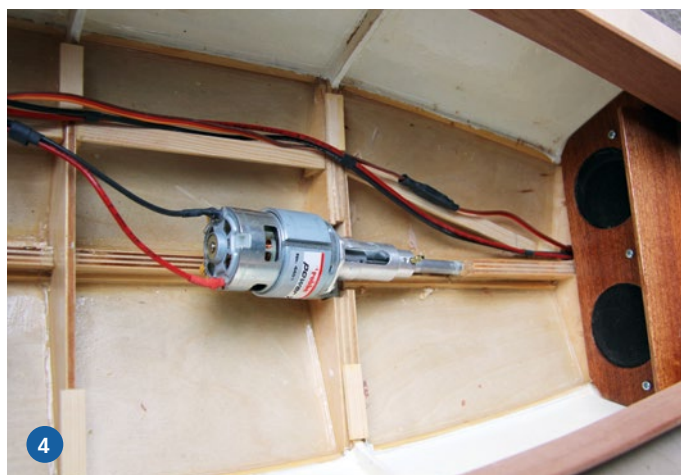
1) Der Rumpf entsteht über Kopf aus Sperrholzspanten. 2) Nachdem das Spantengerüst fertiggestellt war, konnte es ans Beplanken gehen. 3) Der Einbau der Wellenanlage erfolgt. 4) Der Bürstenmotor Power 755/40 von robbe hat ausreichend Leistung für das Modell
