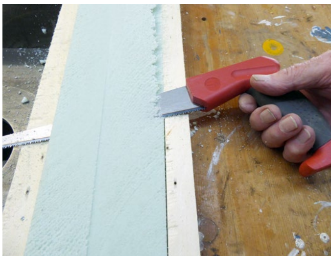
Zum Aufdoppeln eignet sich feinporiges Styrodur, das sich sehr gut verarbeiten lässt
