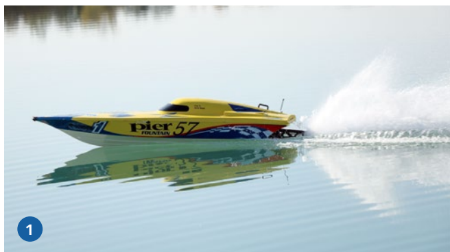
1) Mit dem gewählten 14s-Setup und einem Octura X470 als Propeller erreicht die HUNTER fast 110 km/h, wobei immer noch Potenzial für höhere Geschwindigkeiten gegeben ist. 2) Das MHZ-Ruder in XXL-Ausführung ist so groß, hier der Ausleger, das andere Ruderanlagen dagegen wie Spielzeug wirken
