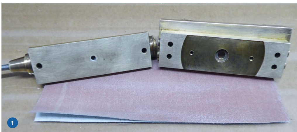
1) Kolben mit Rückplatte und Montagesockel. Damit alles reibungslos läuft, war Feinschliff erforderlich. 2) Der neue Gastank war nach dem missglückten Versuch, den alten zu vergrößern, nötig
