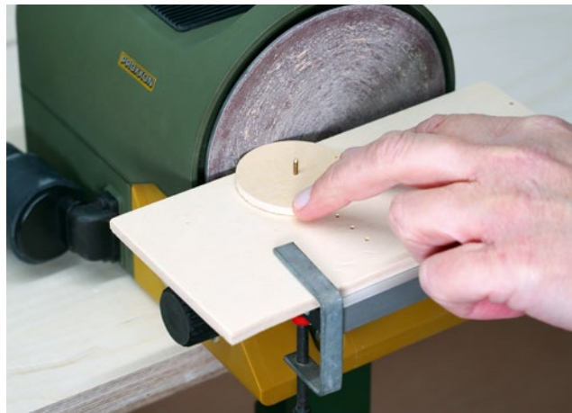
Absolut kreisrunde Scheiben gelingen unter Verwendung einer Hilfsvorrichtung
