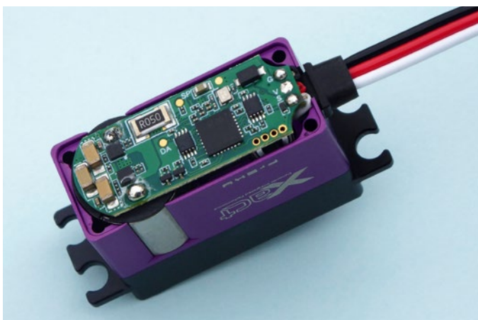
Das Digitalservo ist mit hochwertigen Bauteilen und direkt angelötetem Motor ausgestattet
