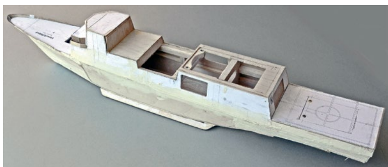
Das beplankte und rohgeschiffene Modell noch ohne die zusätzlichen Aufbauten. Es sind konstruktionsbedingt nur wenige Zugänge zum Modellinneren vorhanden
