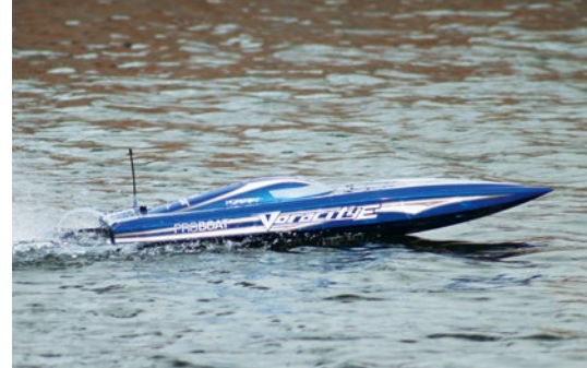
Bei Rennbooten könnten Digitalservos ihre Vorteile ausspielen, da hohe Stellkraft, -geschwindigkeit und -genauigkeit wichtig sind
