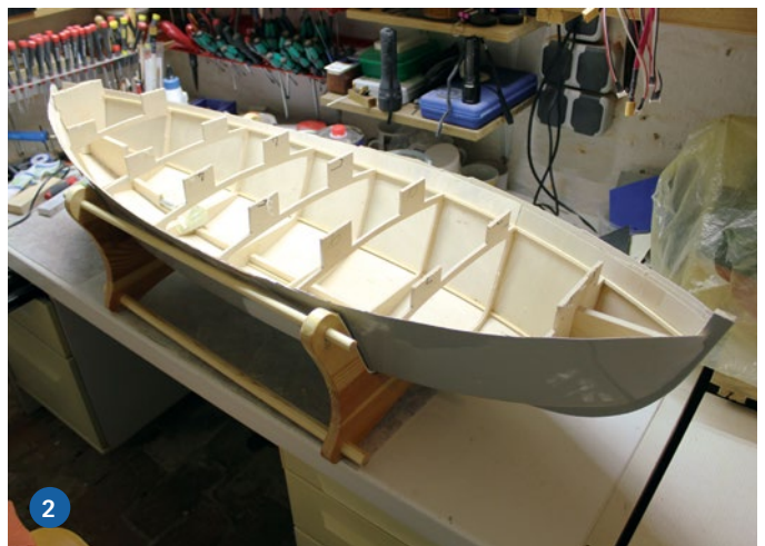
1) Der Rumpf entsteht über Kopf aus Sperrholzspanten. 2) Nachdem das Spantengerüst fertiggestellt war, konnte es ans Beplanken gehen. 3) Der Einbau der Wellenanlage erfolgt. 4) Der Bürstenmotor Power 755/40 von robbe hat ausreichend Leistung für das Modell
