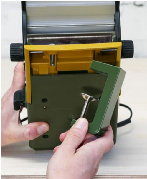
Um den TG 125/E sicher auf der Werkbank zu befestigen, liegt eine Schraubzwinge bei
