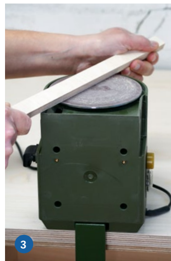
1) Zum Demontieren des Arbeitstischs ist eine Inbusschraube zu lösen. 2) Dank Silikonbeschichtung lassen sich Schleifscheiben einfach lösen und mehrfach verwenden. 3) Ohne Arbeitstisch und in Hochkant-Position ist möglich, aber eine Lösung für die Absaugung erforderlich
