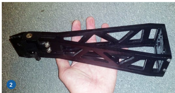
1) Mit dem gewählten 14s-Setup und einem Octura X470 als Propeller erreicht die HUNTER fast 110 km/h, wobei immer noch Potenzial für höhere Geschwindigkeiten gegeben ist. 2) Das MHZ-Ruder in XXL-Ausführung ist so groß, hier der Ausleger, das andere Ruderanlagen dagegen wie Spielzeug wirken
