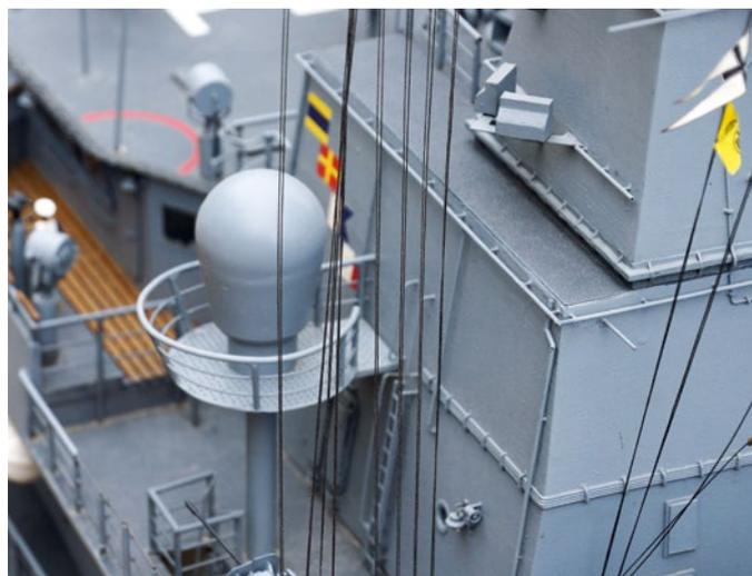
Eines von mehreren Radomen. Bemerkenswert ist die Umsetzung von Kabelkanälen, Handläufen oder Knotenblechen
