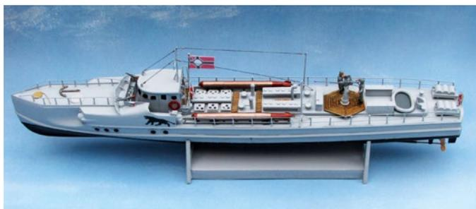
Bei Schnellboot S30 sind die vorderen Torpedorohrbereiche umschlossen, aber noch nicht voll in den Rumpfaufbau integriert
