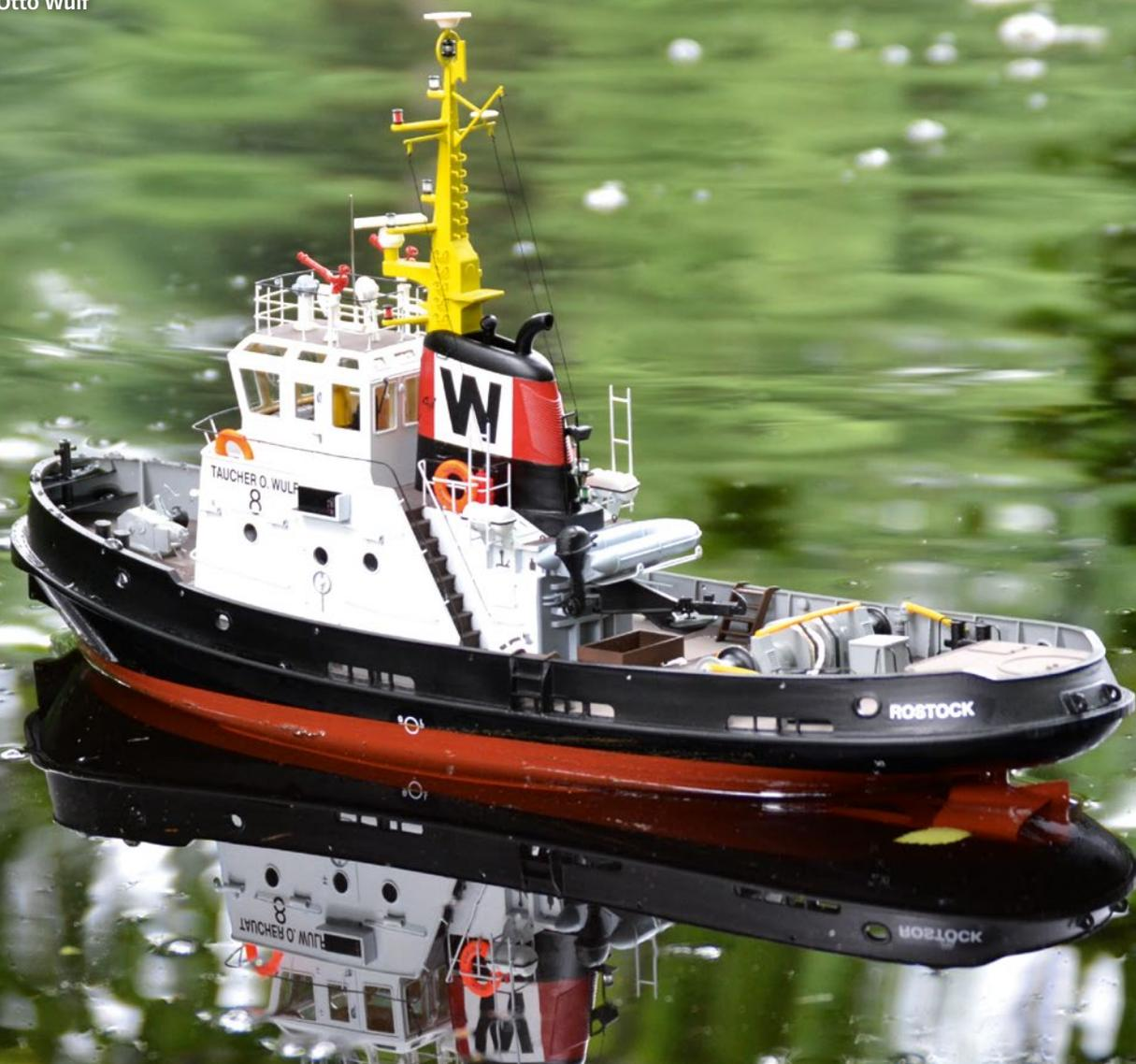
auf 1.020 PS und der Pfahlzug beträgt 18 t. Der Antrieb besteht aus einer Welle mit einer in einem Kort-Düsenruder laufenden Schraube. Seit 1994 ist das Cuxhavener Unternehmen Otto Wulf Eigentümer des Schleppers.
