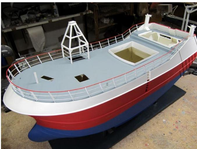
Der Rumpf ist fertig lackiert, die Reling gesetzt, als Nächstes steht das Einsetzen des Masts an
