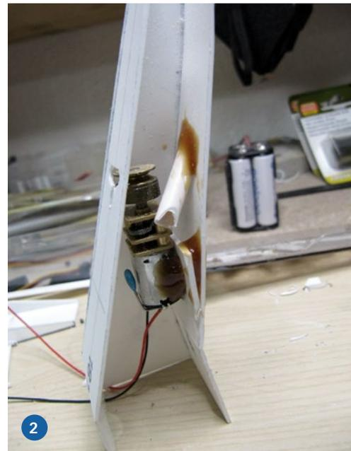
1) Ansteuerung des Matrosen mit Wasserspritze zum Drehen der Figur, von unten. 2) Im Mast ist der Antrieb fürs Radar eingebaut – leider funktioniert dieser allerdings aktuell nicht und muss nochmals überarbeitet werden
