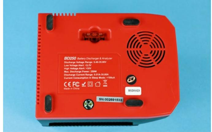
Die Geräte-Unterseite verfügt über ein Fach für eine Flachstecksicherung aus dem KFZ-Bereich
