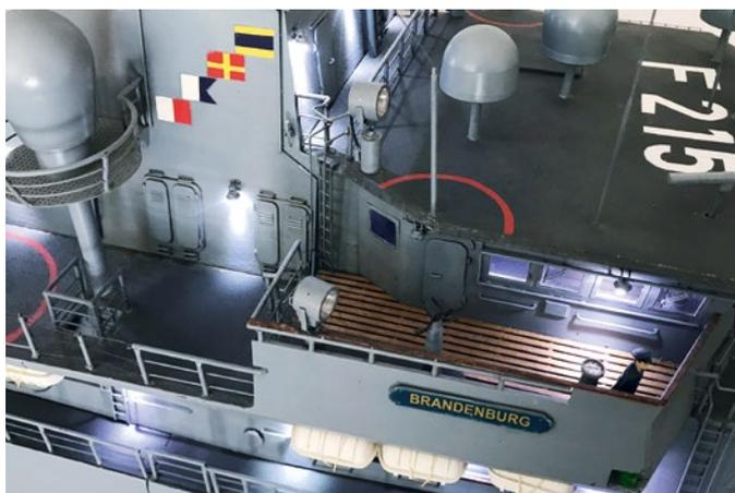
Die LED am Schiff sind oft über IC-Sockel gesteckt, was die Wartung bei Ausfall erleichtert
