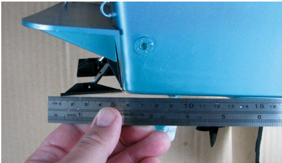
Die rechte Trimmklappe wurde etwas stärker heruntergestellt, um das Motordrehmoment auszugleichen
