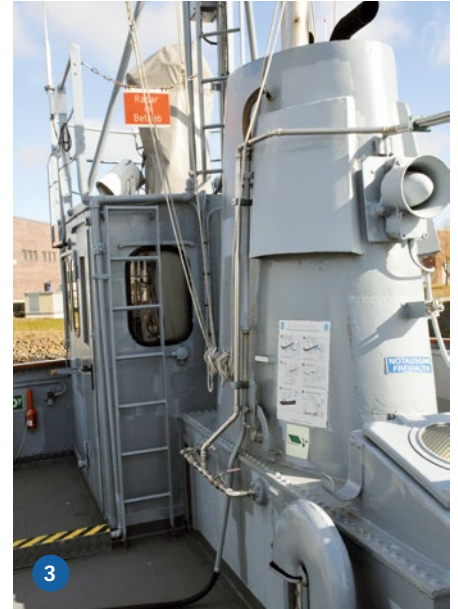
1) Wie sich das gehört, ist an Bord natürlich eine entsprechend signierte Glocke. 2) Blick auf einen Teil der Druckluft-Steuerelemente. 3) Aufbau B-Deck mit Schornstein und Dieseltanks. Dass sich letztere oberhalb befinden, ist schon sehr speziell
