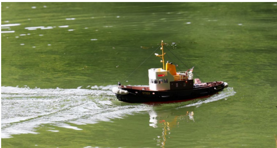
Der Vorteil der KBPs ist, dass die Antriebe ihre volle Leistung in jede beliebige Richtung zur Verfügung stellen können. Also auch für Rückwärtsfahrt
