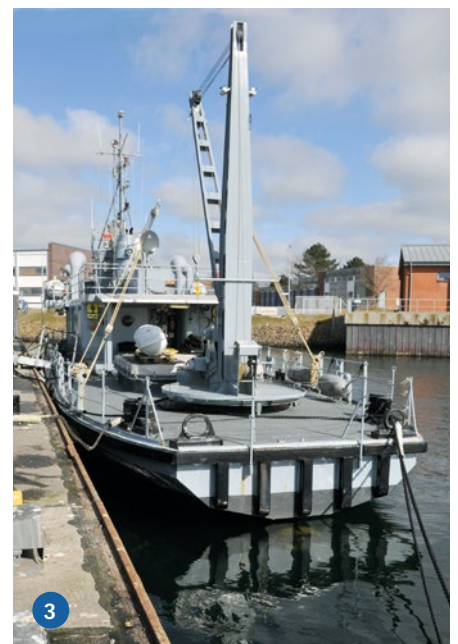
1) Im großen Maßstab ließe sich auch ein Innenausbau umsetzen, wie hier vom Steuerstand. 2) Blick auf den Mast mit seinen Instrumenten. 3) Kran-Mast auf dem Heck. Hier ist viel Handarbeit erforderlich. Ebenfalls gut erkennbar ist die Ladeluke zum Messraum
