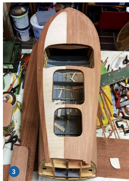
1) Der Rumpf wurde innen mit Bilgenfarbe lackiert. 2) Die Rahmen der Zugangsklappen wurden aus mehreren Schichten Mahagonifurnier hergestellt. 3) Wichtig bei der Beplankung mit Furnier ist es, die überall dieselbe Faserrichtung beizubehalten, damit es nach dem Lackieren keine Farbunterschiede gibt
