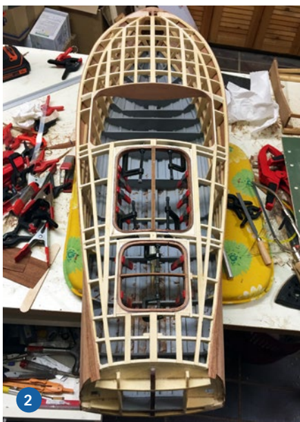
1) Der Rumpf wurde innen mit Bilgenfarbe lackiert. 2) Die Rahmen der Zugangsklappen wurden aus mehreren Schichten Mahagonifurnier hergestellt. 3) Wichtig bei der Beplankung mit Furnier ist es, die überall dieselbe Faserrichtung beizubehalten, damit es nach dem Lackieren keine Farbunterschiede gibt
