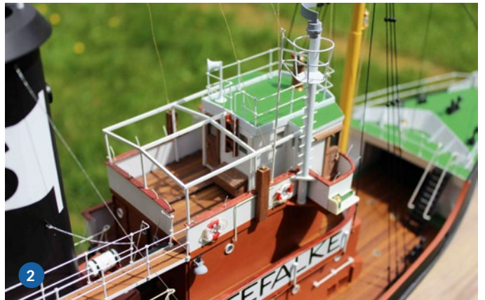
1) Der Decksaufbau wurde mit brauner Farbe lackiert. Zwischen den Planken wurde ein schmaler Streifen frei gelassen, um einen Kalfalterungseffekt zu erzeugen. 2) Der Bau des Schleppers dauerte insgesamt 16 Wochen
