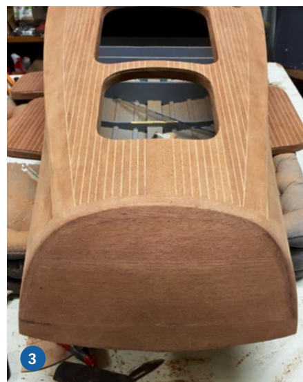
1) Im fertig geschliffenen Rumpf wurden der Antriebsmotor samt V8-Attrappe und die RC-Anlage eingebaut. 2) Auch die Klappen sind fertig mit Mahagoni beplankt. 3) Besonders anspruchsvoll und zeitintensiv war die Verkleidung des Spiegels
