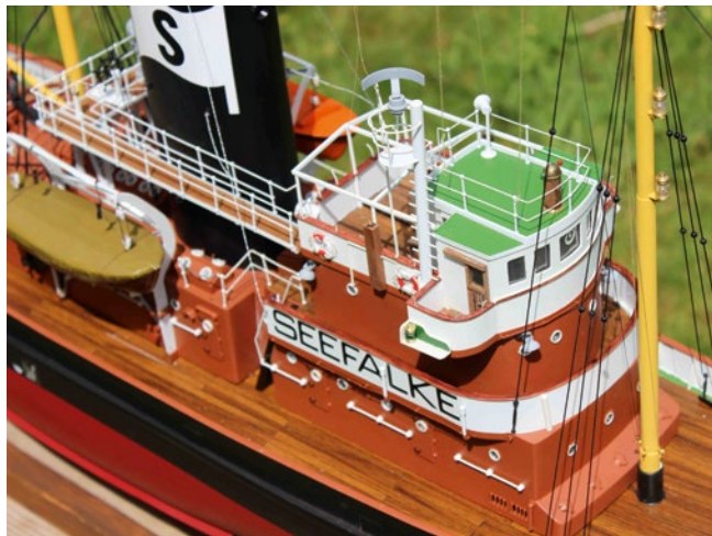
Polystyrol unterschiedlicher Stärke wurde größtenteils eingesetzt
