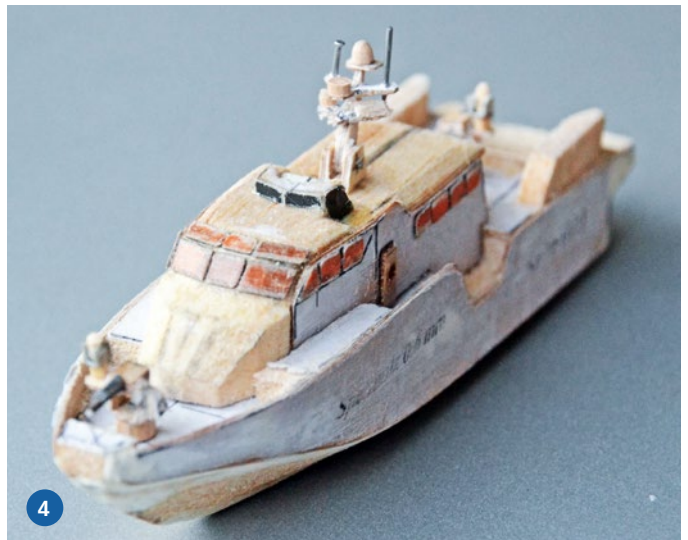
3) Das Rohmodell von steuerbord achtern. Gut zu erkennen ist hier der Klappmechanismus des Masts. 4) Der Rumpf besteht aus Balsa- und Sperrholz
