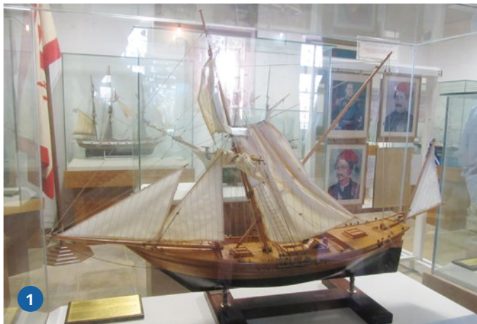
1) Die Sakoleva oder Sakoleve: Ein Typus schlank gebauter Segelschiffe in unterschiedlicher Riggung. 2) Heckansicht einer Sakoleva oder Sakoleve
