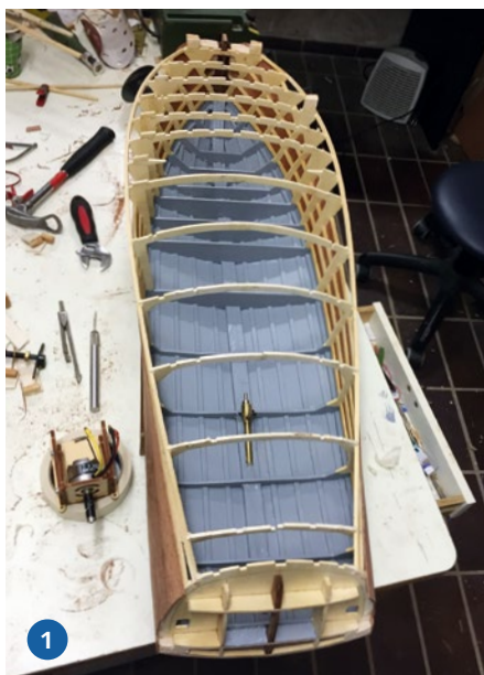
1) Der Rumpf wurde innen mit Bilgenfarbe lackiert. 2) Die Rahmen der Zugangsklappen wurden aus mehreren Schichten Mahagonifurnier hergestellt. 3) Wichtig bei der Beplankung mit Furnier ist es, die überall dieselbe Faserrichtung beizubehalten, damit es nach dem Lackieren keine Farbunterschiede gibt
