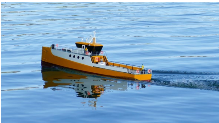
Ausgestattet mit einem 3s-LiPo sowie den beiden Bürstenmotoren, sind sehr gute Fahrleistungen zu erzielen
