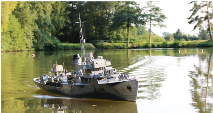
Bei der ersten ausgiebigen Probefahrt des fast fertigen Modells verrutschte ein Akku, was die Schräglage erklärt, aber die Schwimmlage war dennoch bereits gut
