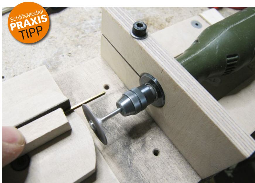
Beim Cutten von Metallen kann man auch eine selbstgebaute Lehre einsetzen
