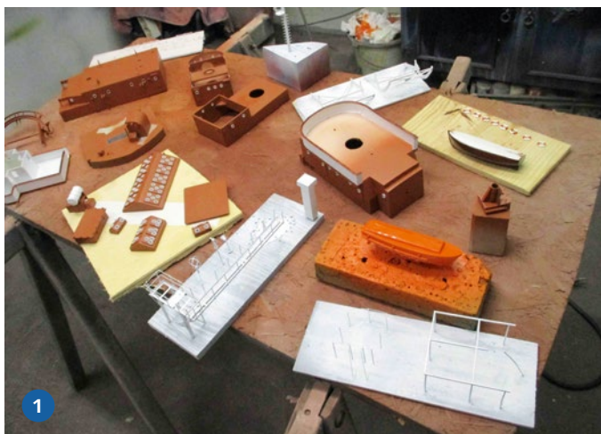
1) Es kann losgehen: Für den Bau des Modells wurde hauptsächlich Polystyrol eingesetzt, da dieser Werkstoff im Maßstab 1:50 optimal verwendet werden kann. 2) Messing kam beim Bau des Drehkranzes zum Einsatz
