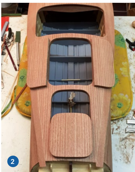
1) Im fertig geschliffenen Rumpf wurden der Antriebsmotor samt V8-Attrappe und die RC-Anlage eingebaut. 2) Auch die Klappen sind fertig mit Mahagoni beplankt. 3) Besonders anspruchsvoll und zeitintensiv war die Verkleidung des Spiegels
