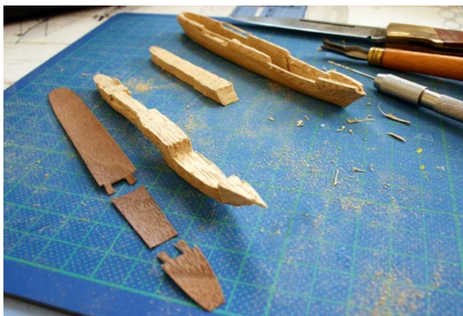
Der in der „Schultz’schen Schlüsseltechnik“ zerlegte Rumpf
