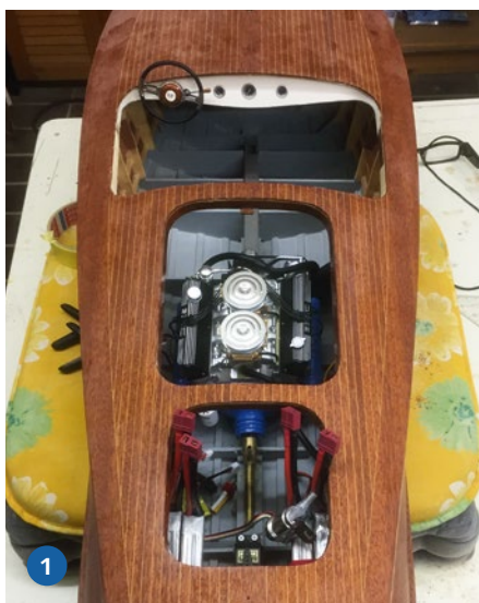
1) Im fertig geschliffenen Rumpf wurden der Antriebsmotor samt V8-Attrappe und die RC-Anlage eingebaut. 2) Auch die Klappen sind fertig mit Mahagoni beplankt. 3) Besonders anspruchsvoll und zeitintensiv war die Verkleidung des Spiegels
