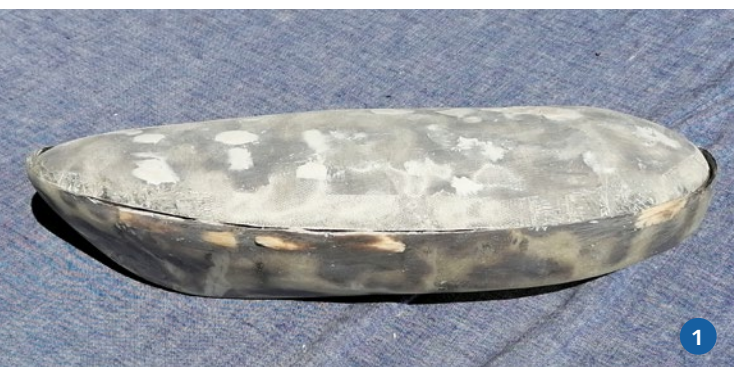
1) Der Rumpf der JOHANN FIDI wurde aus GFK-Matte direkt auf der Form laminiert. 2) Das Tochterboot ist grundiert
