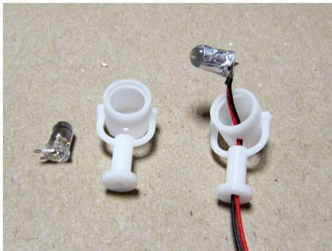
Fertigteile wie die Suchscheinwerfer lassen sich gut mit den Beleuchtungselementen ausstatten
