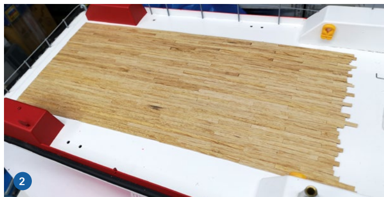
1) Ran an die Arbeit: Alle notwendigen Teile stehen für das technische sowie optische Upgrade zur Verfügung. 2) Es war dringend notwendig, das alte Arbeitsdeck zu ersetzen. Nach langer Suche fiel die Wahl auf die Beplankung der Holzplatte aus Flugzeugspertholz sowie Unterkonstruktion des Decks gegen Verzug
