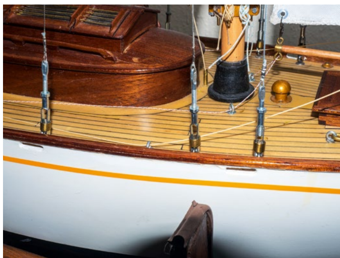
Wanten mit M3-Gabelköpfen, um diese für den Transport einfach lösen und im Betrieb spannen zu können
