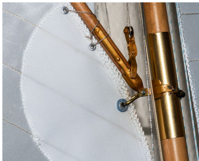
Gaffel mit Gaffelschuh am Mast. Solche Beschläge sind bei so einem Projekt in Eigenleistung zu fertigen
