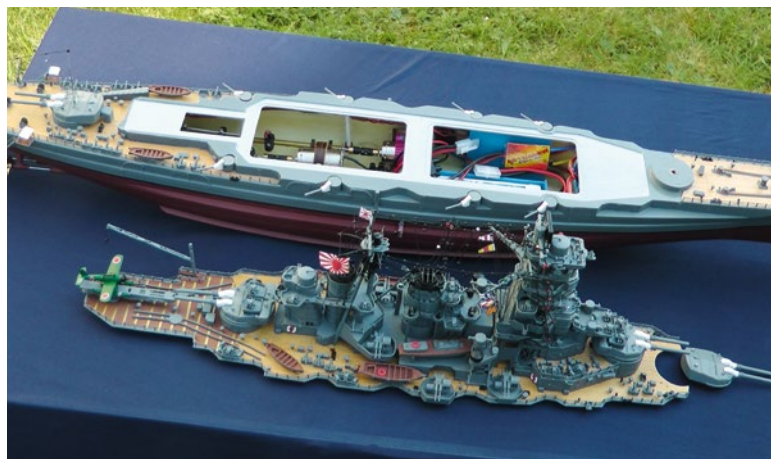
Für den Akkuwechsel und Wartungsarbeiten lässt sich der gesamte Aufbau einfach abnehmen
