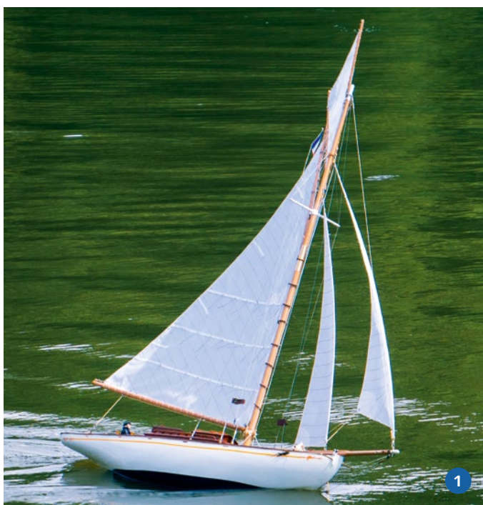
1) Auf dem Wasser zeigt sich VIOLA von ihren besten Seiten. Allerdings braucht das Modell dazu ein Gesamtgewicht von rund 9.000 g, damit es nicht zu sehr krängt. 2) Zwar sind die Segel aus recht steifen Material, aber dank optischer Anpassungen wirken sie noch authentisch
