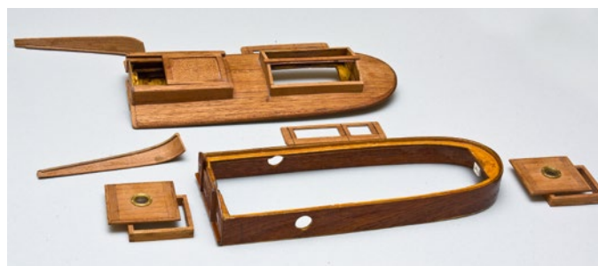
Fertig gebaute und lackierte Teile für Plicht, Kabine, Kajüte und Luke bereit zum Einbau am Modell
