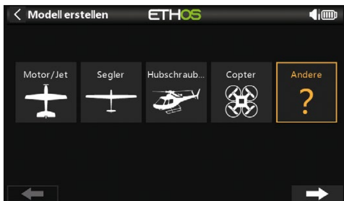
Mit Hilfe des Modelltyps „Andere“ werden Modelle des Funktionsmodellbaus konfiguriert
