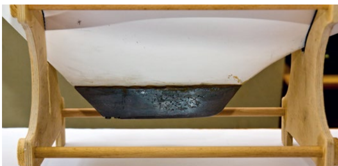
Anhand des Formteils ließ sich der Bleiballast gießen und wird nun ein- beziehungsweise angepasst
