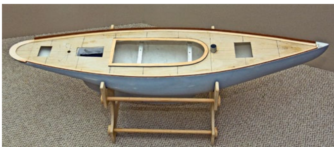
Das Schanzkleid aus einem Winkelprofil ist angebracht und innen bereits eine Holzverkleidung angeschlagen
