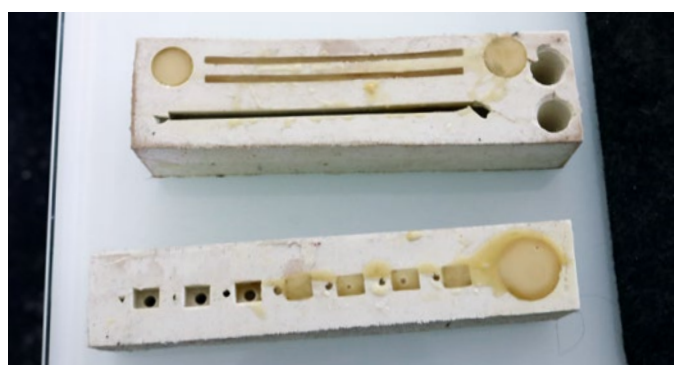
Um massenweise Bauteile zu produzieren, wie das besonders bei Ausrüstungsgegenständen rund um die Bewaffnung von Vorteil ist, bieten sich Formenbau und Resinguss an
