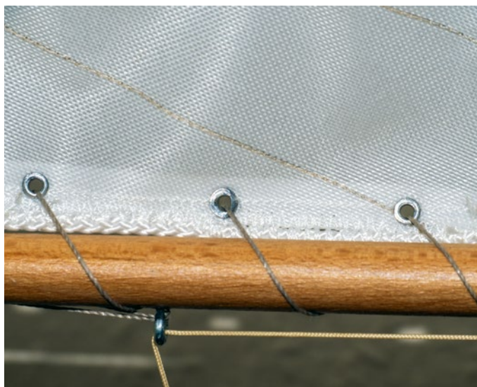
Die eng am Großbaum geführte Befestigung der Segel. Die Ösen sind aus Alu-Rohr selbst gemacht
