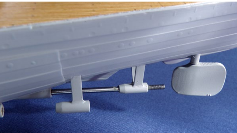
Die Wellenanlage und Ruder sind fertig eingebaut
