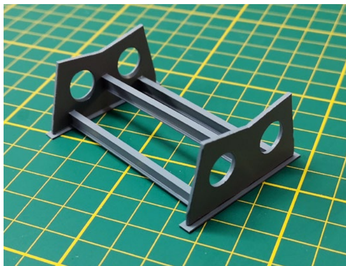
Der Halter des Beiboots musste neu erstellt werden, dafür wurden ABS-Plattenmaterial und I-Trägerprofile verwendet
