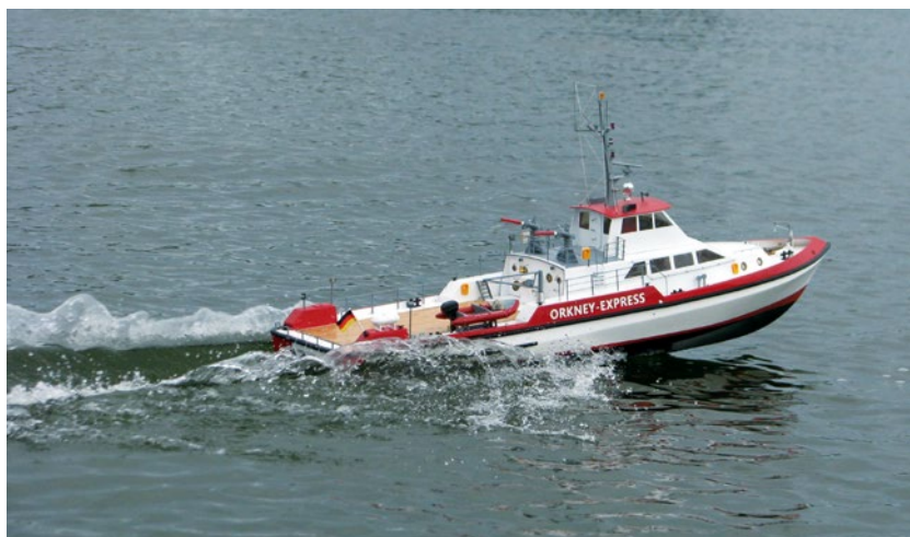
Die ORKNEY-EXPRESS erzeugt beim Gleiten auf dem Wasser lange Wellen. Sobald die Geschwindigkeit erhöht wird, hebt sich der Bug vom Wasser und Wellen überschlagen sich seitlich
