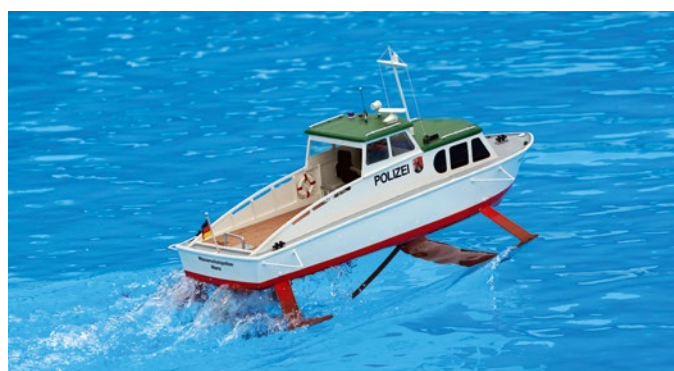
Tragflächenboot sind selten – dieses kleine Exemplar basiert auf einem ABS-Rumpf der CARINA von Graupner
