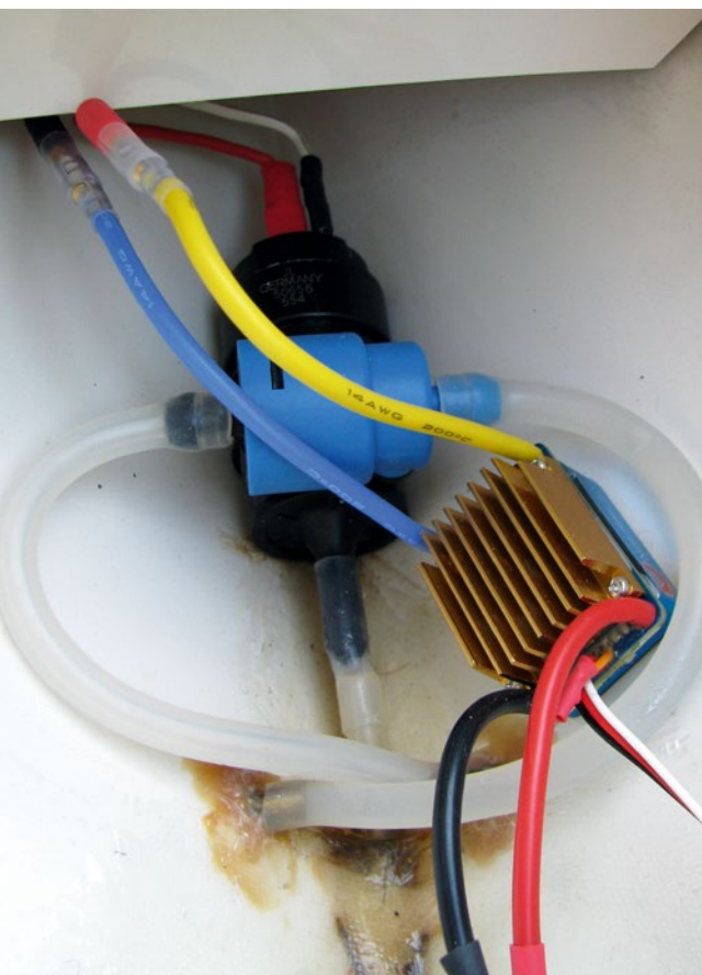
Querstrahler auf Basis einer Scheibenwischerpumpe
