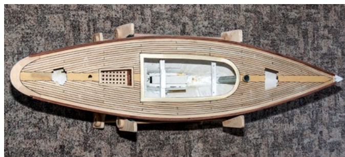
Auf das Hilfsdeck ließ sich die Beplankung gut aufbringen und trägt wesentlich zur Gesamtoptik bei
