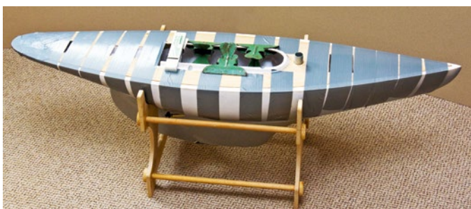
Mit jeder Menge Montageband ließ sich das Hilfsdeck einwandfrei am Rumpf befestigen
