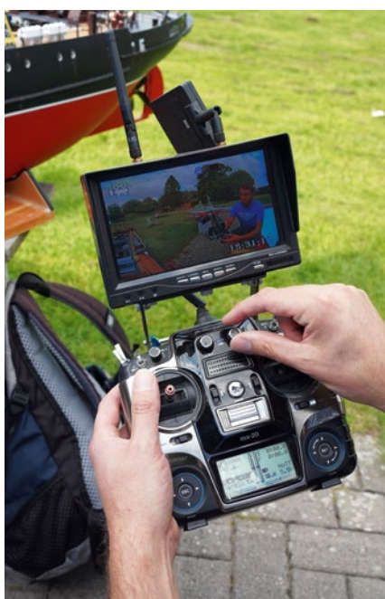
Eine von vielen Sonderfunktionen der ELBJÖRN ist die FPV-Anlage
