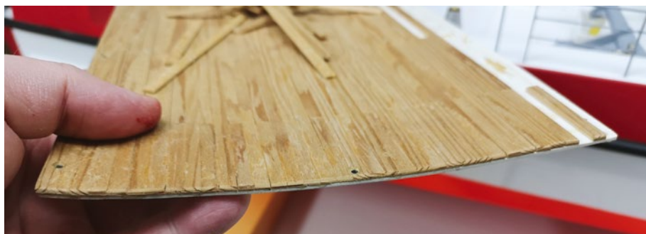
Das Arbeitsdeck aus Holz war komplett verzogen
