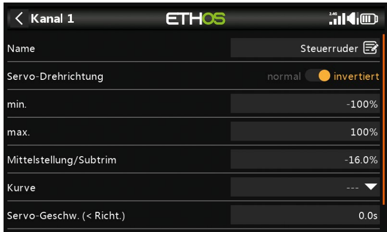
Die Drehrichtung und die Neutralposition eines Servos kann man ganz einfach anpassen
