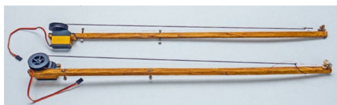
Im Rumpfinneren sind zwei Schotumlaufgestelle unterzubringen, um Hauptsegel und Vorsegel zu steuern
