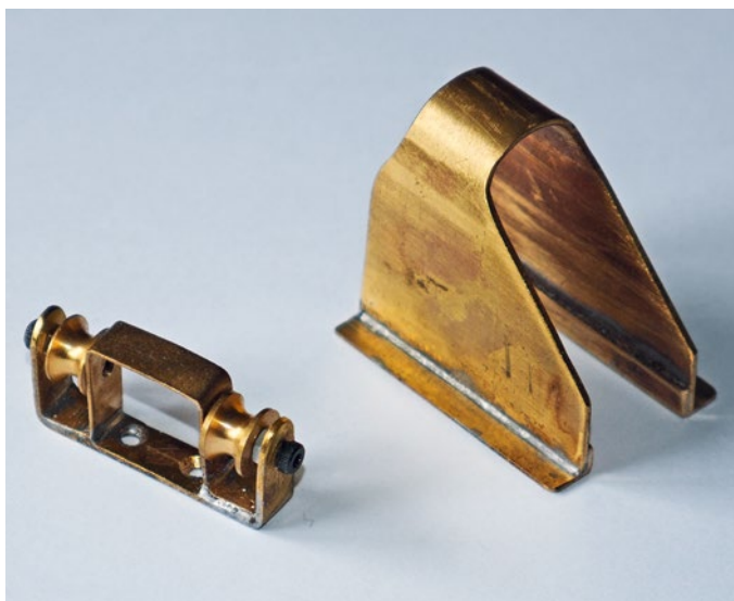
Selbst hergestellte Teile für den Klüverbaum und die Ankerbeting aus Messing
