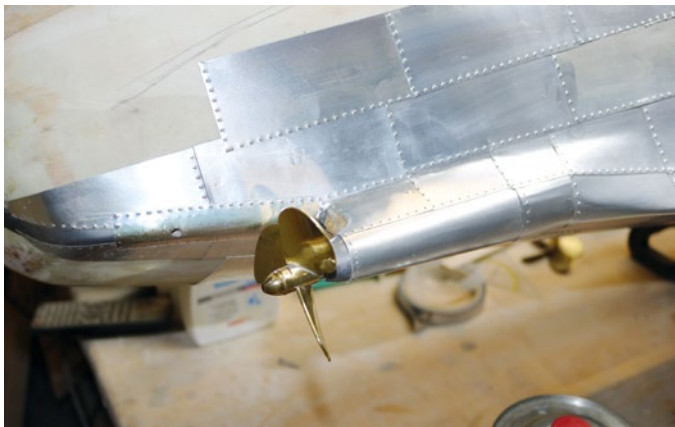
Da das Original aus genieteten Platten bestand, wurde dieses auch beim Modell durch Aluplatten imitiert
