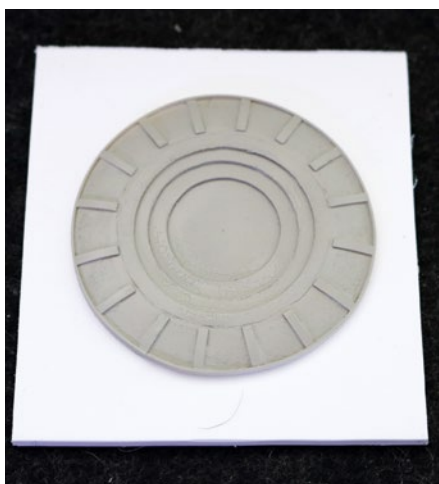
Für jedes in Serie zu fertigende Bauteil, hier für drehbaren Geschütze, entstand zunächst ein Urmodell
