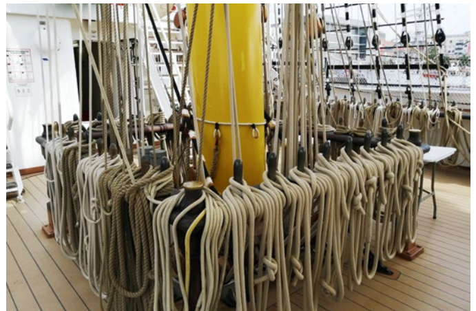
Mastgarten auf der ALEXANDER VON HUMBOLDT II. Nagelbank nennt man diesen Bereich wegen der vielen Belegnägel, die Taue halten
