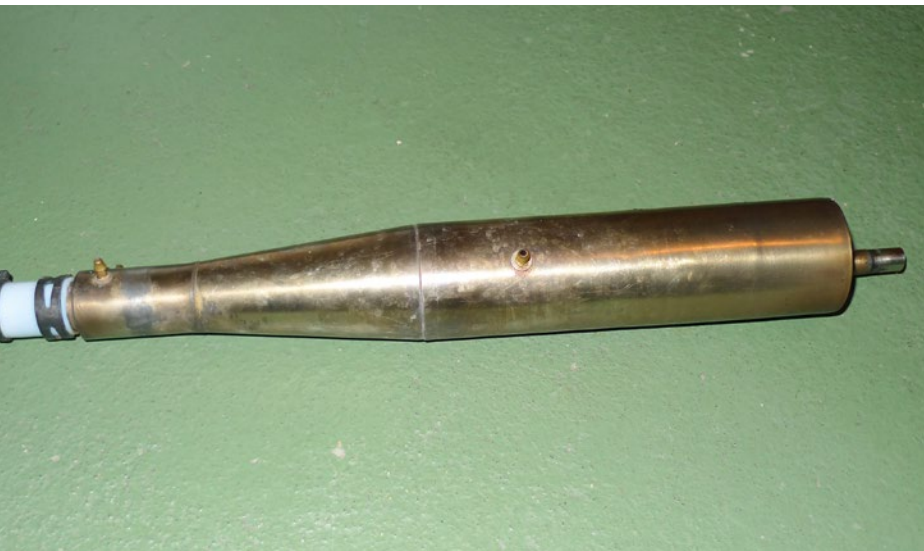
Als Resonanzaufpuff kam ein Cooper mit einer Gesamtlänge von 330 mm und einem Durchmesser von 50 mm zum Einsatz
