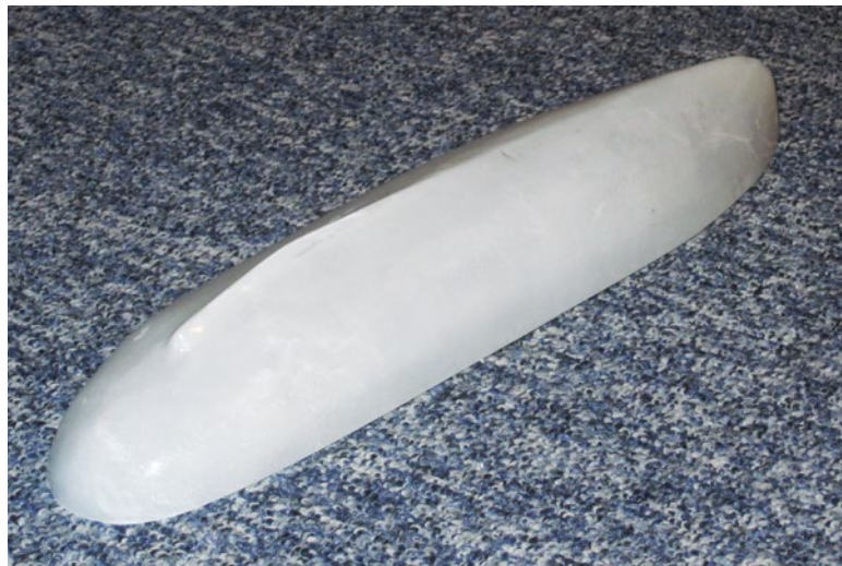
Nachdem die Formen standen, wurde ein sehr leichter Rumpf aus GFK-Gewebe laminiert
