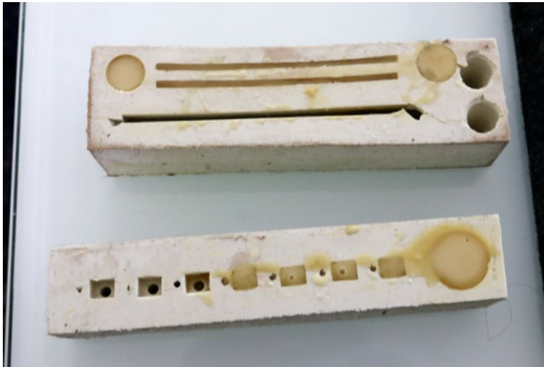
Die Silikonformen werden je nach Bauteil-Bedarf mit Resin ausgegossen
