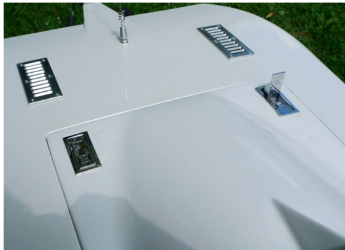
Die Haubenverschlüsse ermöglichen ein schnelles und sicheres Öffnen und Schließen des Modells
