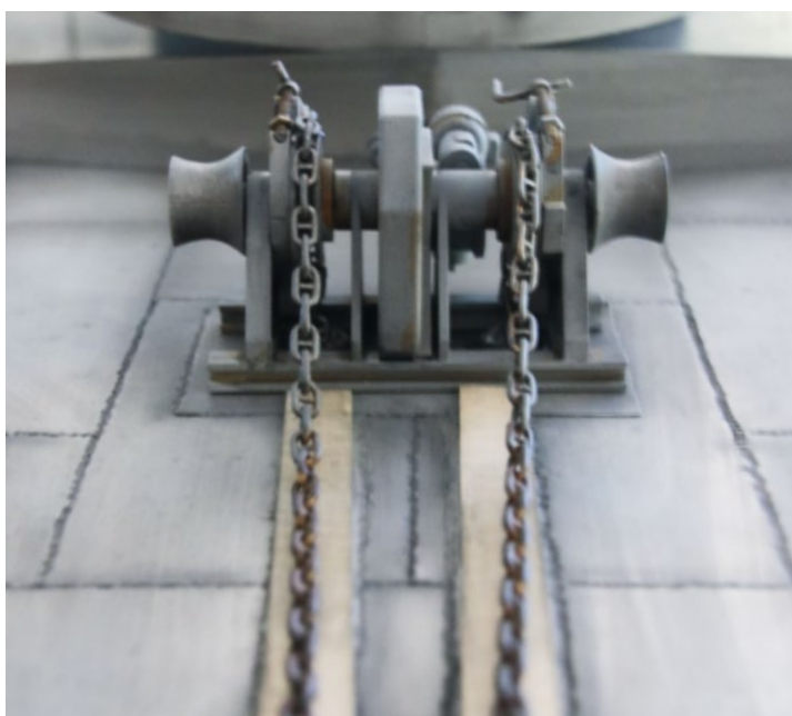
Es lohnt sich, auch auf Kaufteile zurückzugreifen, wenn diese zum Schiffstyp und maßstäblich passen, wie hier bei der Ankerwinde
