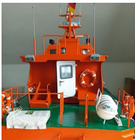
Das Heck – unter der geöffneten Klappe befindet sich der Schalter für die Empfangsanlage
