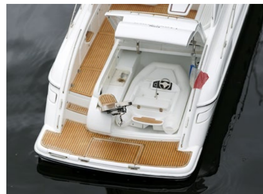
Die Heckgarage der WHITE LADY lässt sich öffnen, die Gangway bewegen und der Tender aussetzen
