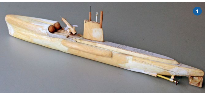
1) Das rohgeschliffene Modell mit angesetzten Seitenwülsten und dem Turm im Rohbau. Gut zu erkennen ist der Sperrholz-beplankte Mittelteil. 2) Startbereich mit Regulus II und Turm des Modells im Rohbau
