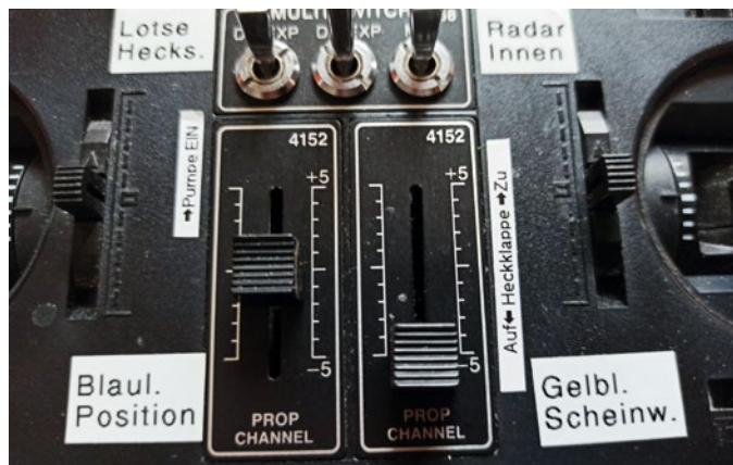
Hinweisschilder am Sender für die Ansteuerung der Beier-Schaltmodule
