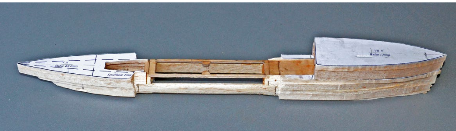
Das Rohmodell vor der Abdeckung des Mittelteils. Gut zu erkennen sind die beiden Spanten und die beiden, breiten Stringer
