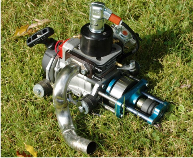
Der Zenaoh G290 mit der MHZ-Fliehkraftkupplung
