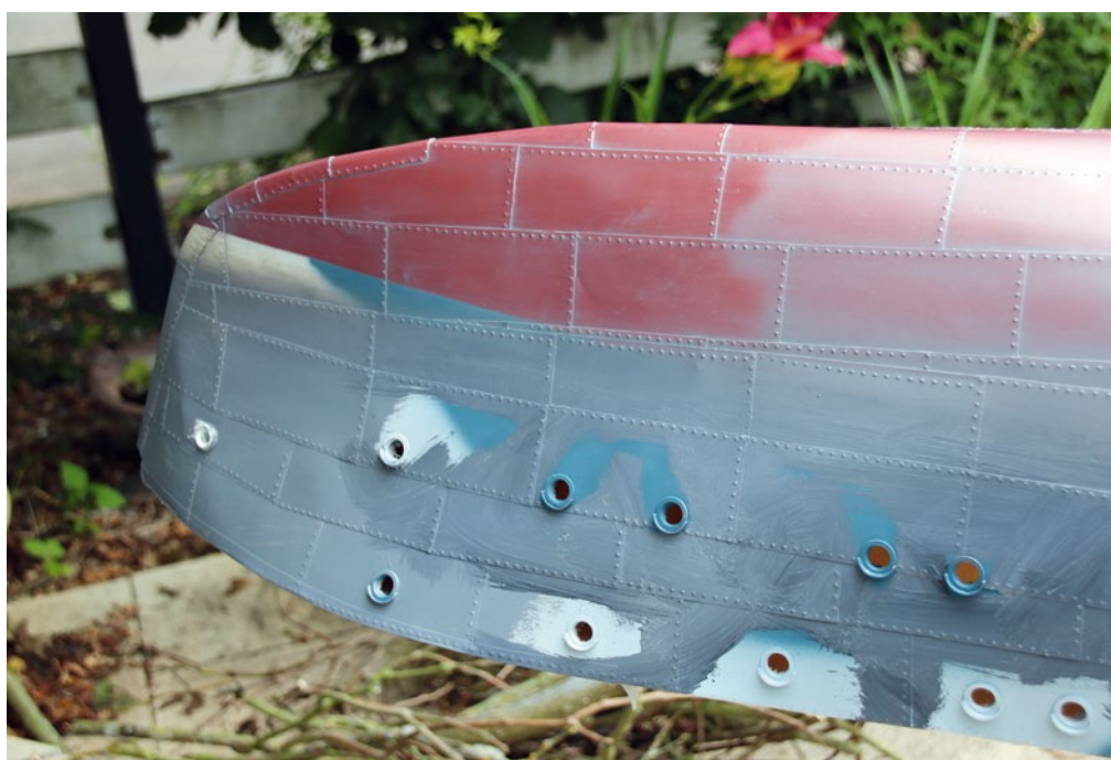
Nach dem Lackieren folgt ein Überzug des Rumpfs mit einem Ölfarben-Gemisch, das sich aus Schwarz, Weiß und Braun zusammensetzt
