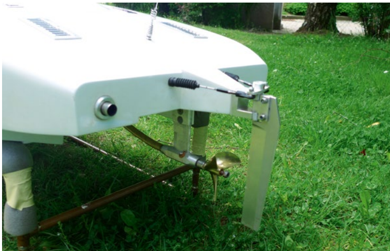
Während der Probefahrten wurden verschiedene Propeller getestet. In der optimalen Konfiguration kratzte das Modell an der 80-km/h-Marke
