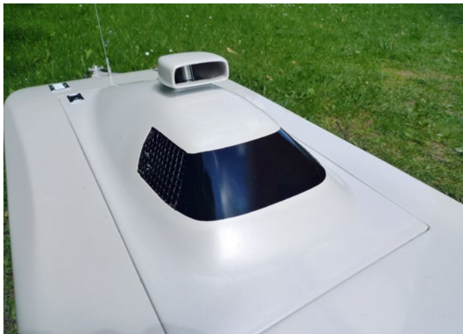
Die Fenster wurden ausgeschnitten und mit Gitter hinterlegt, sodass Kühlluft einströmen kann
