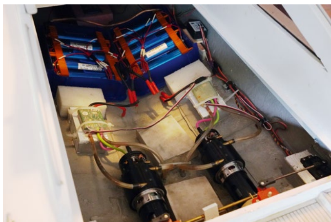
Gut 12 Jahre lang sind die in der TINA 1 genutzten LiFe-Akkus bereits im Betrieb, was für den Zellentyp spricht
