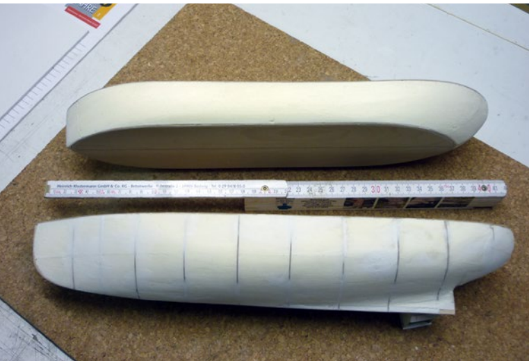
Mit Hilfe eines Spantengerüsts und Hartschaummaterial erfolgte der Formenbau
