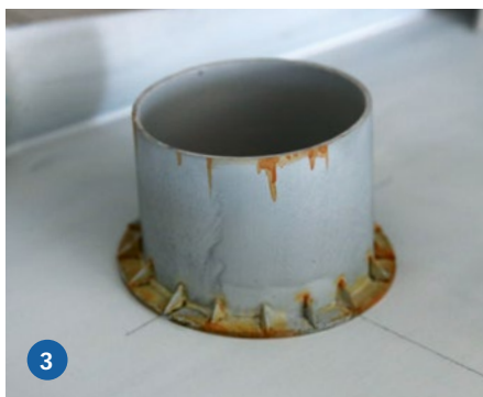
3) Besonders im Bereich von Schrauben oder harten Übergängen sind durch Lackabplatzer verursachte Rostspuren effektiv. 4) Etliche Relingstützen waren auf dem gesamten Schiff zu setzen. Zwischenzeitlich eine immer wiederkehrende Tätigkeit. 5) Polystyrol ist das Material der Wahl beispielsweise bei Schutzwänden
