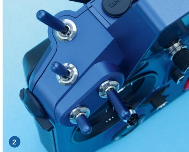
1) Außer dem voll ausgebauten Sender gehören eine Kurzanleitung, ein Trageriemen, ein USB-Kabel, Schalterkappen sowie ein 2,4-GHz- und ein 868-MHz-Empfänger zum Lieferumfang des Bundles. 2) Für die Bedienung stehen beidseitig jeweils zusätzlich vier Schalter und ein Drehgeber bereit
