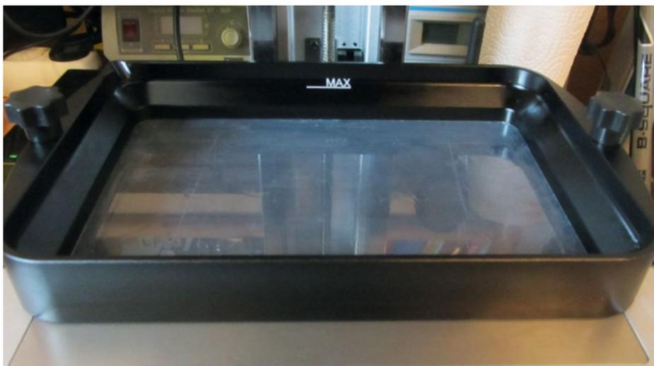
Nach der Einrichtung kann der Tank montiert und befüllt werden
