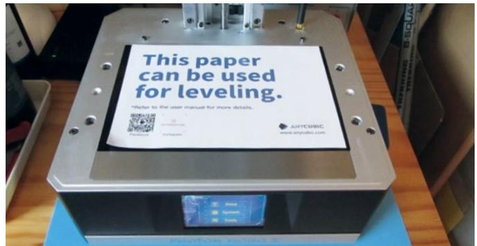
Mit Hilfe eines Blatts Papier wird das „Leveling“ der Z-Achse nach Anleitung durchgeführt
