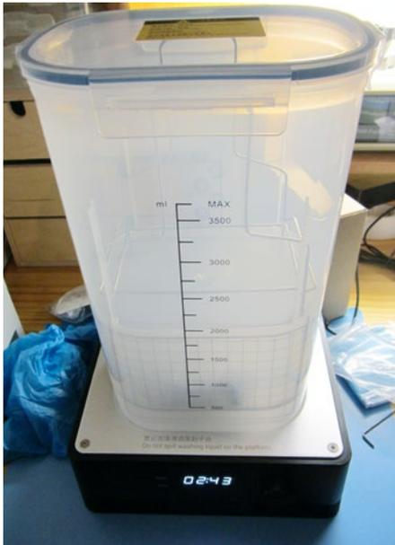
Das überschüssige Resin wird mit Isopropanol in der Waschstation entfernt
