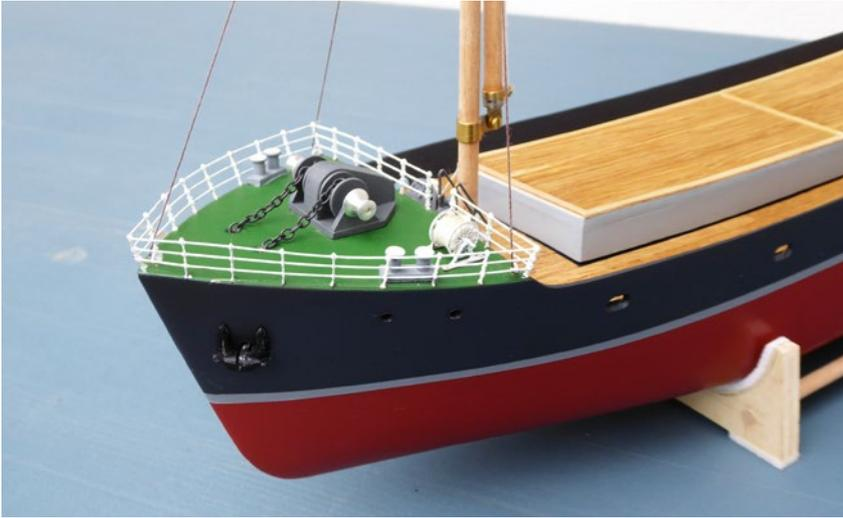
Ankerwinde, Poller und eine Seiltrommel dekorieren den Bug des Schiffs
