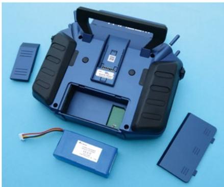
Rückseitig sind das Akkufach und ein Schacht für ein externes HF-Modul untergebracht, gut erkennbar sind die beiden rückseitigen Tasten (schwarze Knöpfe)
