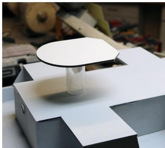
Dass die Pertinaxplatte bereits eine glatte Oberfläche bildet, ist für die späteren Lackierarbeiten von Vorteil
