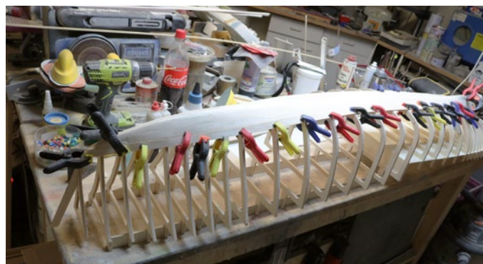
Das war der Baustand nach dem ersten Teil in SchiffsModell 7/2021 – die ersten Planken sind gesetzt
