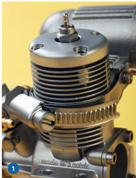
1) Ergebnis der Reinigung aus Vapor-Blastinging und Reinigern an Zylinderkopf mit eingesetzter Glühkerze. 2) Vor dem Einweichen beziehungsweise Reinigen ist erkennbar, dass der Kolben dick mit schwarzer Ölkohle verkrustet ist
