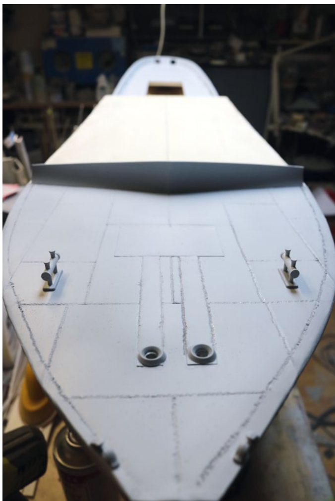
Blick aufs Vordeck mit fertigen Schweißraupen nach dem Grundieren – hier sitzen auch schon die Kettenrohre hin zu den Ankertaschen
