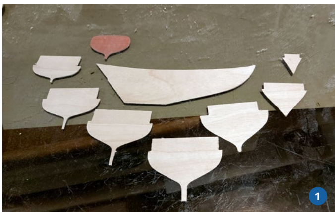
1) Die Spanten sind ausgesägt und werden zu einem Gerippe für die Beplankung. 2) Lehrling Eberhard Grün beim Ausrichten der Spanten. 3) Der Rumpf ist fertig beplankt. 4) Am Spiegel überstehende Planken sind exakt zu trennen
