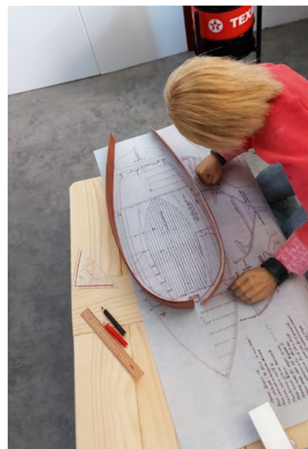
Der Süllrand wird auf dem Plan angepasst
