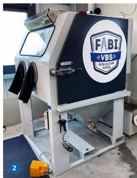
1) Zwischen die einzelnen Kühlrippen haben sich Rückstände von Öl, Staub und Fasern gesetzt und alles so stark verklebt, dass klassische Reinigungsmethoden versagen. 2) Die Firma Fabi-VBS bietet als besonderen Service das Abstrahlen von Metallteilen im Vapor-Blasting-Verfahren an, das in dieser Maschine stattfindet
