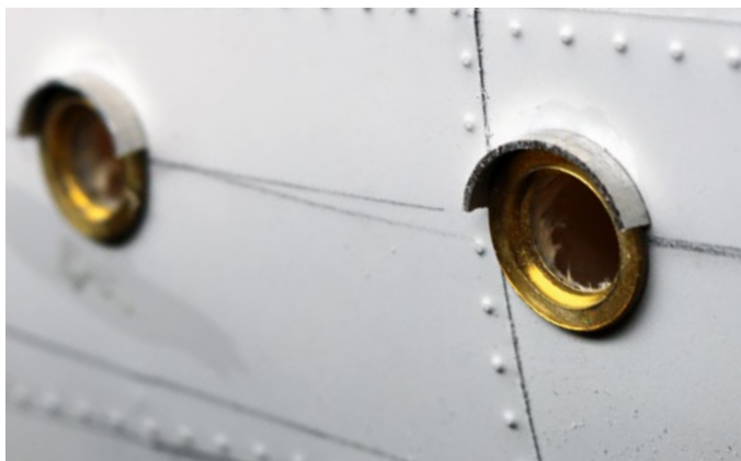
Die Blenden der Bullaugen entstanden erneut aus einem Rundrohr, der jedoch gehälfet wurde
