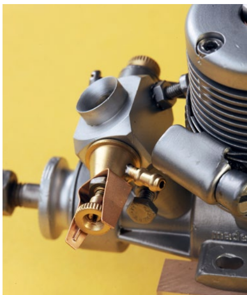
Ein Unterschied wie Tag und Nacht. Der Blick auf den Vergaser mit dem Messing-Vergaserventil offenbart, dass dieser nun „strahlend“ schön sauber geworden ist
