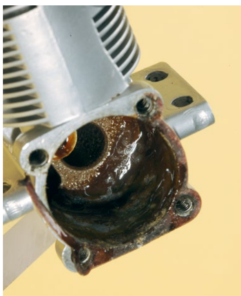
Im Gehäuse ‚schwimmt‘ der alte Ölsumpf und hat alles verklebt. Da dreht sich nichts mehr
