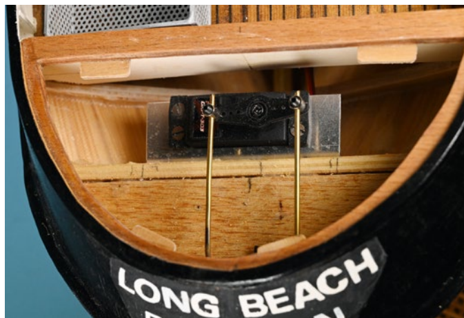
Einbau des Ruderservo im Heck
