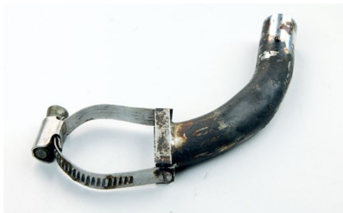
Der Auspuffkrümmer wurde mit Harzlöser gereinigt. Das sieht zwar nicht wie fabrikneu aus, aber der Unterschied ist gewaltig
