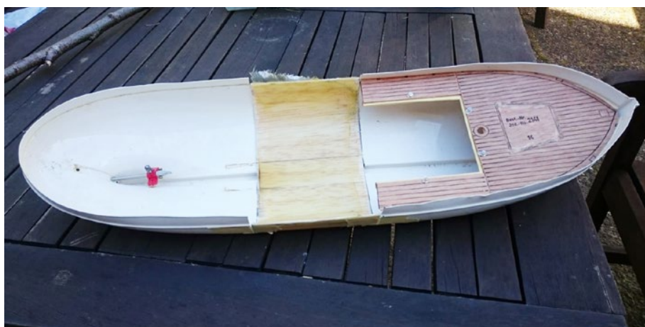
Der erste Schnitt tat noch weh, doch mit der eingefügten Verlängerung ergibt sich gleich ein ganz anderes Bild
