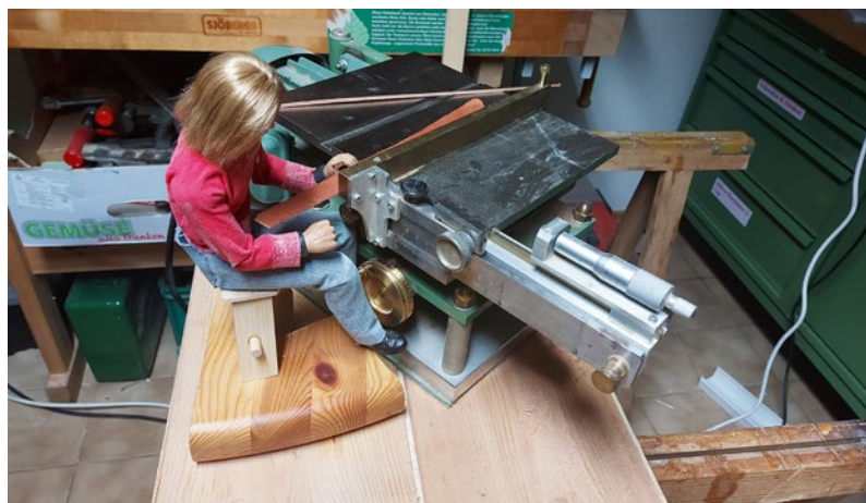
Die sichtbaren Spanten für das Cockpit werden auf einer Präzisionssäge gefertigt
