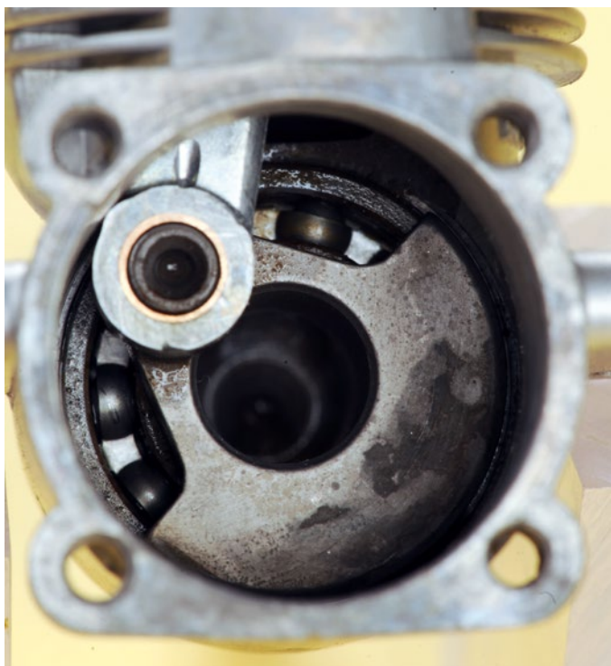
Im Kurbelgehäuse ist alles wieder klinisch sauber und rein. Selbst das Kugellager ist von Ölresten befreit
