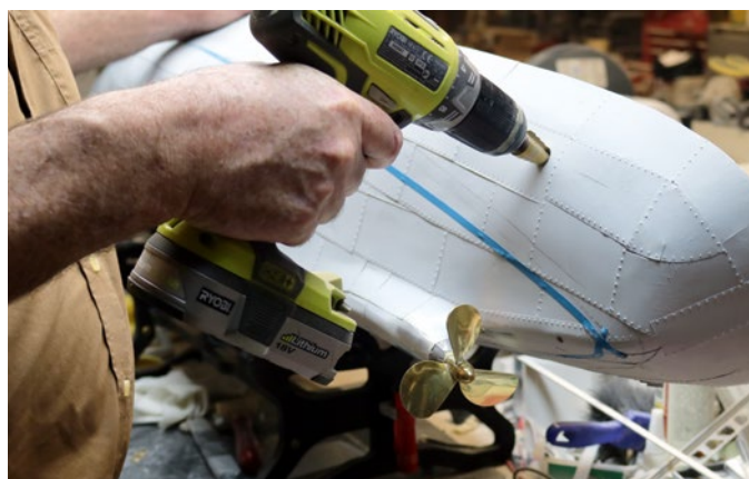
Ein Schritt, den man sich trauen und gut vorbereiten muss: Das Setzen der Bohrlöcher für die Bullaugen
