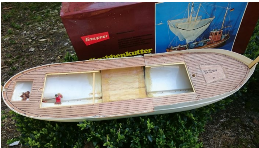
Nachdem der Rumpf verlängert wurde, erfolgte derselbe Prozess auch beim Deck
