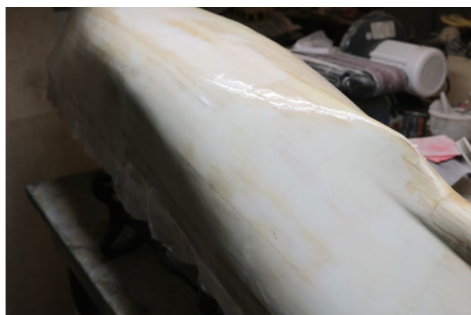
Frisch aufgetragene und mit Epoxidharz getränkte Gewebe-Matte zur Versiegelung des Rumpfs
