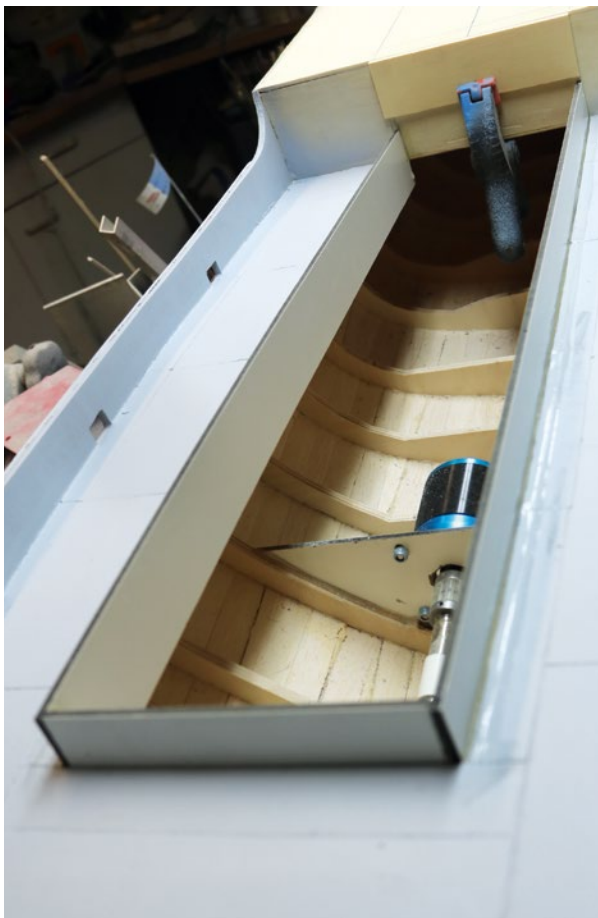
Damit kein Wasser ins Innere eindringen kann, sorgt ein hoher Süllrand – dieser fixiert später auch den Aufbau
