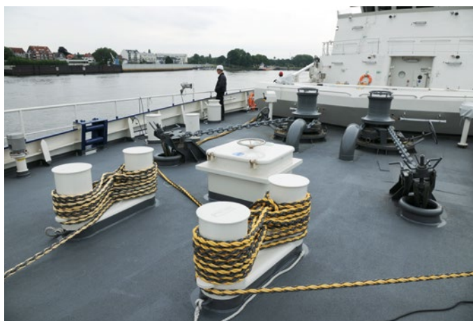
Blick auf die Anker- und Spillanlage auf der Back
