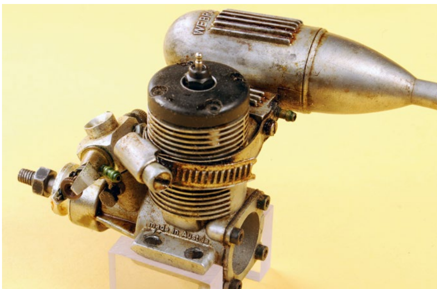
Ein Unterschied wie Tag und Nacht. Der Blick auf den Vergaser mit dem Messing-Vergaserventil offenbart, dass dieser nun „strahlend“ schön sauber geworden ist
