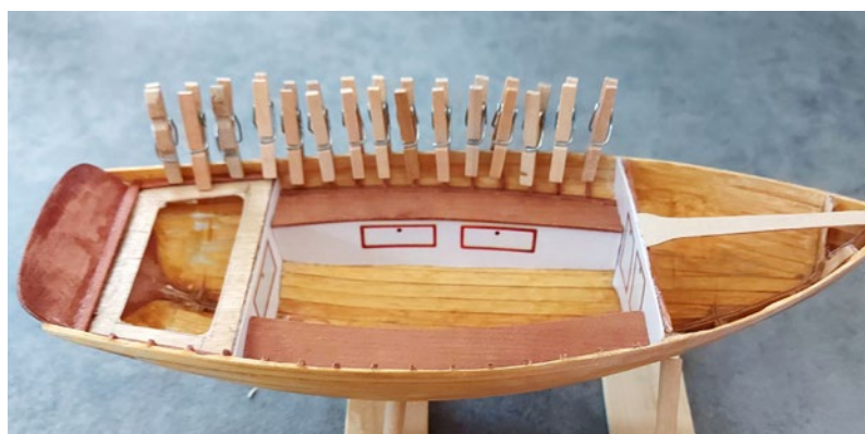
Die Spanten werden mit kleinen Klammern gehalten, bis der Kleber getrocknet ist
