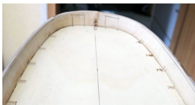
Die überstehenden Stützspanten sind abschließend entfernt worden
