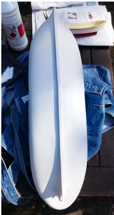
Nach der Grundierung ist die „Flickstelle“ nicht mehr zu sehen
