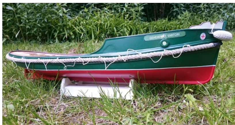
Viele Beschlagteile konnten vom TÖN-Baukasten übernommen werden. Der umlaufende Fender entstand jedoch aus einer alten Hundeleine
