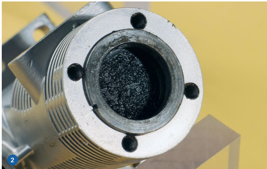
1) Ergebnis der Reinigung aus Vapor-Blastinging und Reinigern an Zylinderkopf mit eingesetzter Glühkerze. 2) Vor dem Einweichen beziehungsweise Reinigen ist erkennbar, dass der Kolben dick mit schwarzer Ölkohle verkrustet ist
