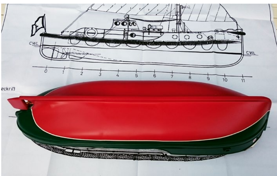
Um 120 mm musste der TÖN-Rumpf verlängert werden, damit er genau den Dimensionen des SARTORI-Rumpfs entspricht
