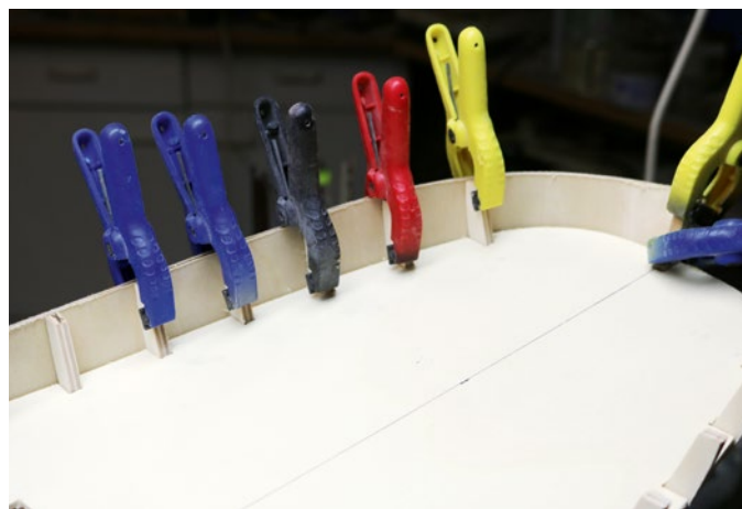
Das Schanzkleid ist an die bewusst überstehenden Rumpfspanten angesetzt und entstand am Stück als Abwicklung und nicht aus Plankenleisten
