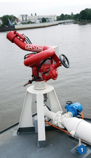
1) Löschmonitore und Zuleitung auf dem Brückendeck. 2) Der große MKG-Klappkran
