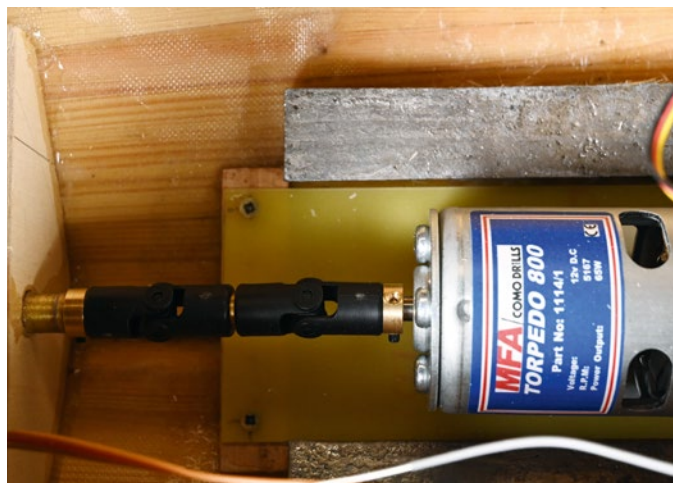
Motoreinbau mit Ballaststücken
