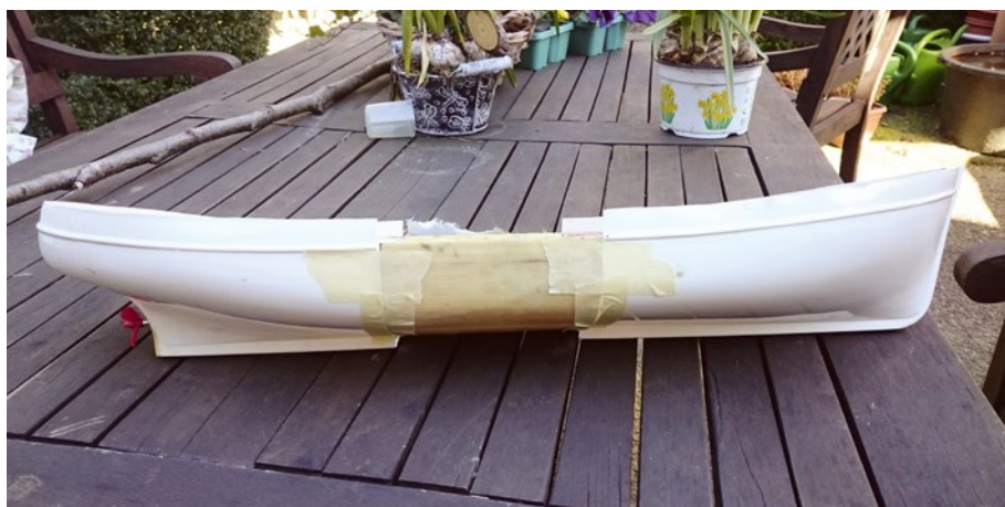
Das eingefügte Verlängerungsstück besteht aus einem Sandwich aus Balsaholz und GFK-Laminat
