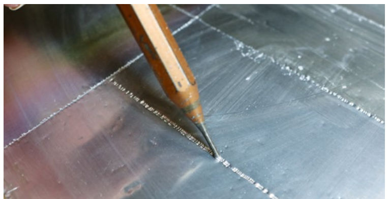
Das komplette Deck ist mit dünnem Alu belegt. Um die charakteristischen Schweißraupen zu imitieren, wurden diese Stücke für Stück ins Metall gearbeitet
