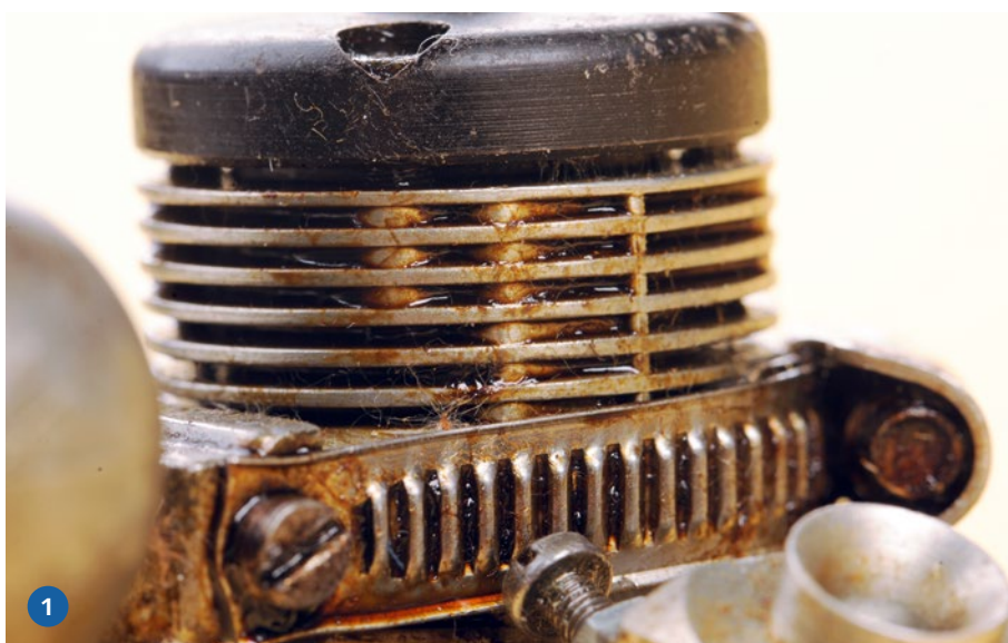
1) Zwischen die einzelnen Kühlrippen haben sich Rückstände von Öl, Staub und Fasern gesetzt und alles so stark verklebt, dass klassische Reinigungsmethoden versagen. 2) Die Firma Fabi-VBS bietet als besonderen Service das Abstrahlen von Metallteilen im Vapor-Blasting-Verfahren an, das in dieser Maschine stattfindet
