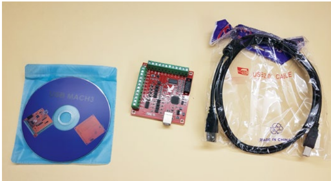
Im Lieferumfang der USB-Interfacekarte: CD-ROM mit Treiber und Mach3-Software, die USB-Karte und ein USB-Kabel
