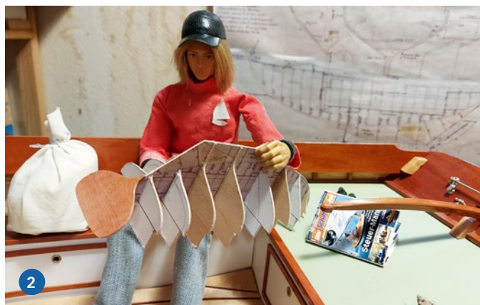
1) Die Spanten sind ausgesägt und werden zu einem Gerippe für die Beplankung. 2) Lehrling Eberhard Grün beim Ausrichten der Spanten. 3) Der Rumpf ist fertig beplankt. 4) Am Spiegel überstehende Planken sind exakt zu trennen
