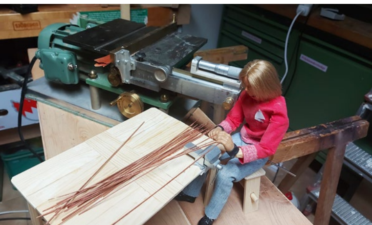
Die sichtbaren Spanten für das Cockpit werden auf einer Präzisionssäge gefertigt
