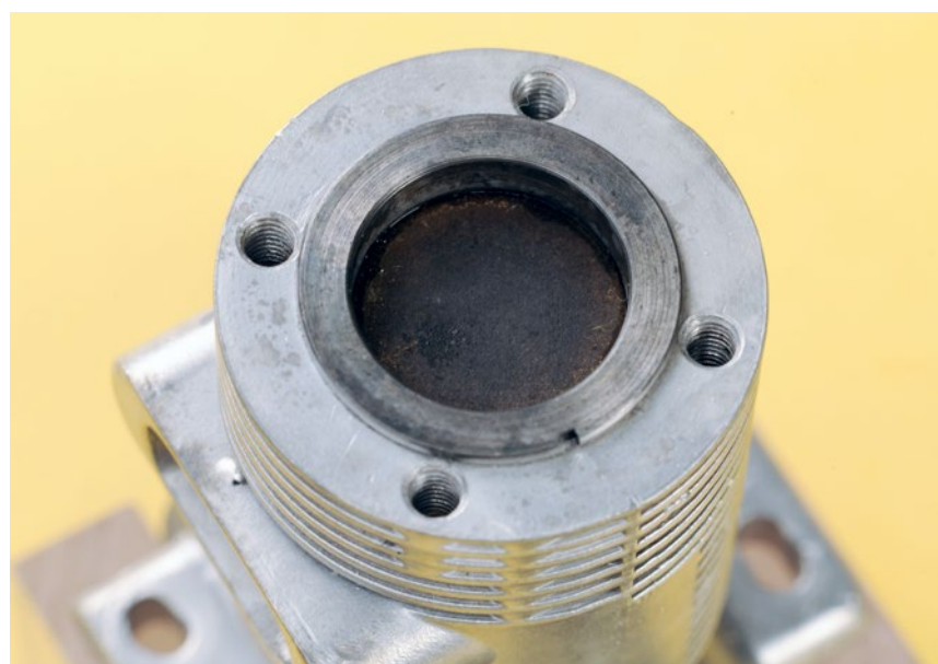
Nach dem Einweichen und Reinigen sind Kolben und Zylinderwandung sauber. Gereinigt wurde hier mit Harzlöser
