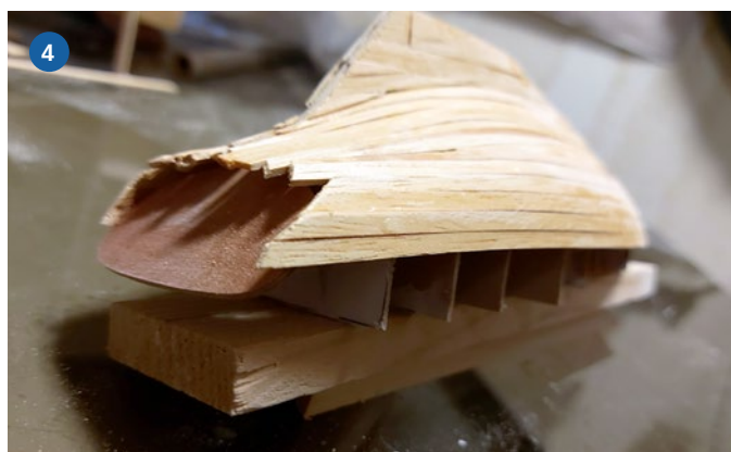
1) Die Spanten sind ausgesägt und werden zu einem Gerippe für die Beplankung. 2) Lehrling Eberhard Grün beim Ausrichten der Spanten. 3) Der Rumpf ist fertig beplankt. 4) Am Spiegel überstehende Planken sind exakt zu trennen
