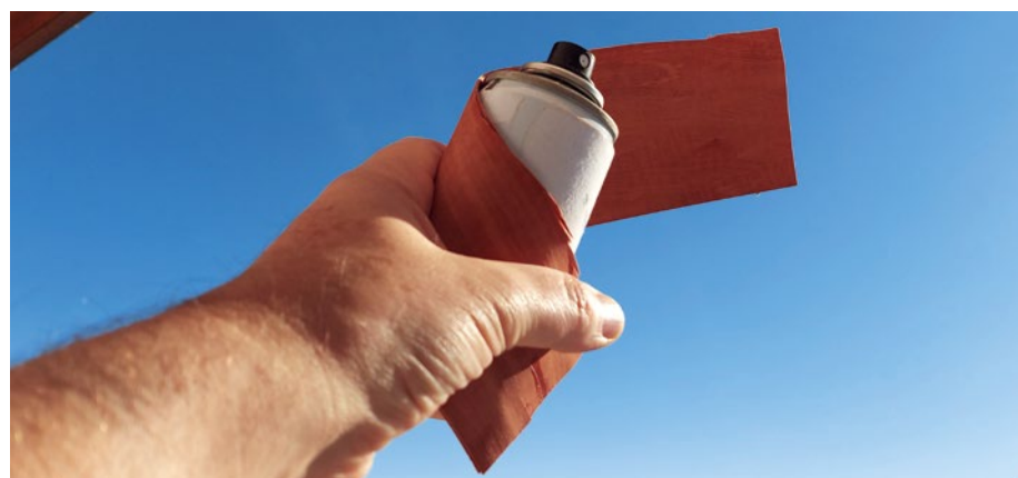
Formverleimen von zwei Furnierstreifen mit Sekundenkleber
