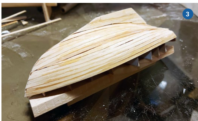
1) Die Spanten sind ausgesägt und werden zu einem Gerippe für die Beplankung. 2) Lehrling Eberhard Grün beim Ausrichten der Spanten. 3) Der Rumpf ist fertig beplankt. 4) Am Spiegel überstehende Planken sind exakt zu trennen
