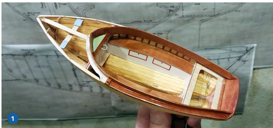
1) Die Unterkonstruktion für das Vordeck mit Magnethalterung. 2) Eberhard und Cordula Grün haben SchiffsModell im Abo und können das jedem Schiffsmodellbauer zur Nachahmung empfehlen
