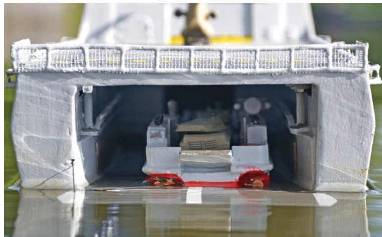
Clou der LPD-29 ist, dass das im Dock mitgeführte Schiff durch Absenken des Hecks ausschiffen kann
