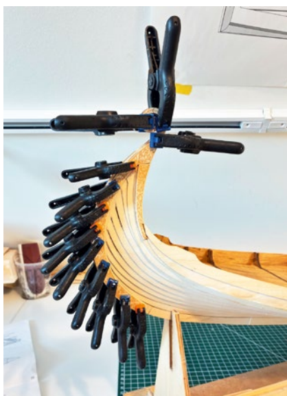
Montage der gravierten Zierelemente an Bug und Heck für die Wikinger-Charakteristik
