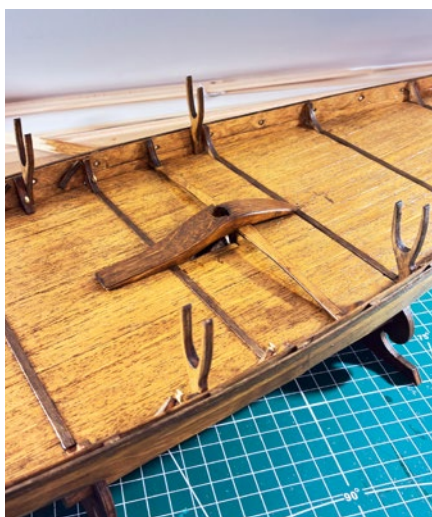
Montage der Klampen, Haken für die Takelage sowie der Ruderrollen
