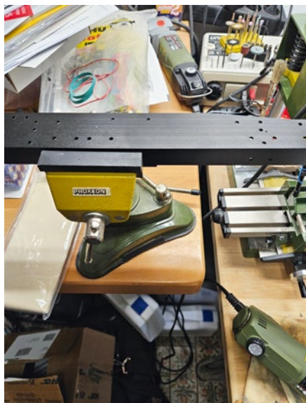
Haupttraversen des Aufliegers, gekürzt und für die weitere Montage vorbereitet
