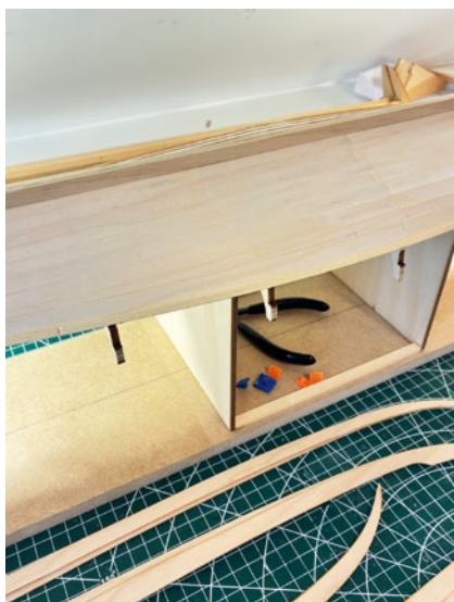
Die flexiblen, vorgeformten Sperrholzplanken lassen sich dank ihrer Beschaffenheit mühelos verlegen
