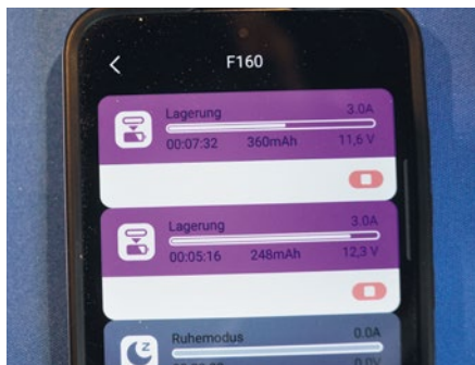
... und die Fernüberwachung des Ladevorgangs (hier auf Erhaltungsspannung) ermöglicht
