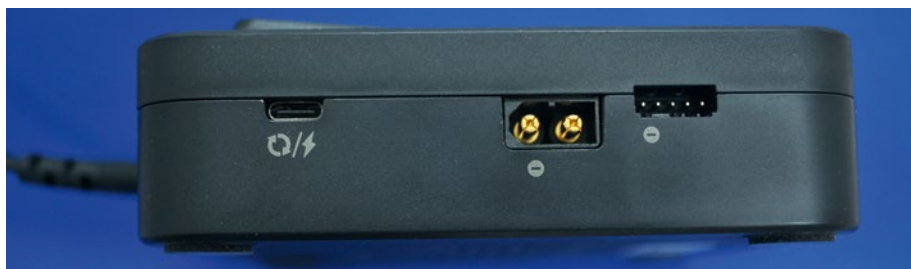
Integrierte XT60 Lade- und XT-Balancerstecker machen Adapterkabel für die meisten Akkus überflüssig
