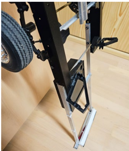
Die für die Heckverlängerung verbauten Alu-Rechteckrohre
