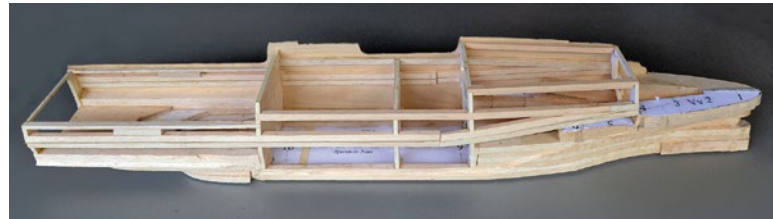
Vorteil des LPD-29 ist die relativ einfache Konstruktion, die einen Nachbau aus wenigen Spanten, Stringern und Plankenplatten ermöglicht
