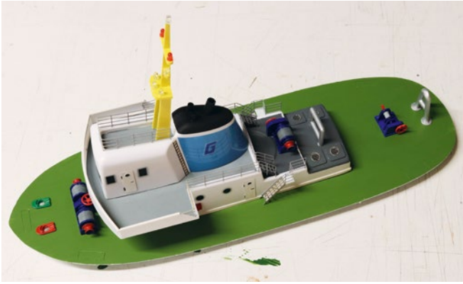
Ergänzung einer selbst gebauten Beistopperwinde und Seilführung auf dem Achterdeck
