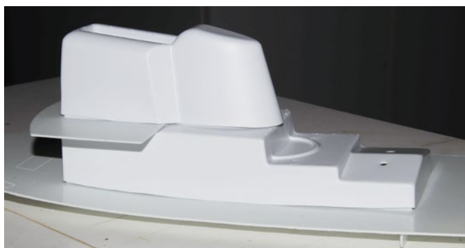
Korrektur von Passungenauigkeiten bei der oberen Decksplatte und den unteren Aufbauten
