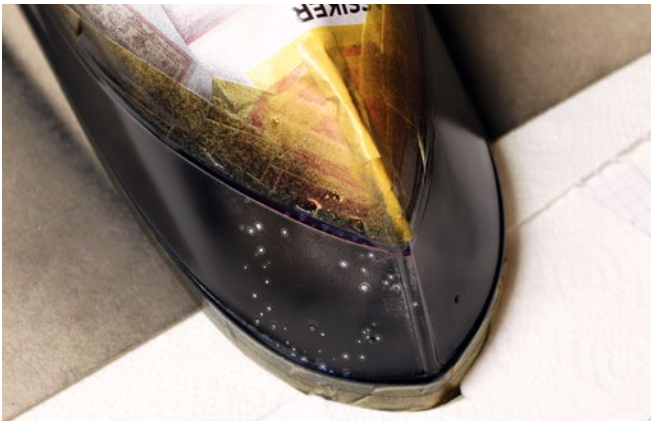
Das Missgeschick beim Lackieren: Wassertropfen auf dem noch nicht getrockneten schwarzen Rumpf
