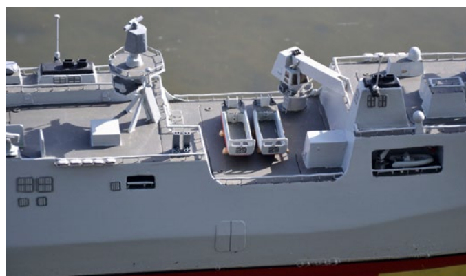
Mittig platziert sind zwei LCM-6 Boote, die vom Kran ausgesetzt werden könnten
