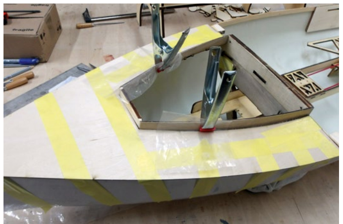
Bündig mit dem Hauptspant und mit viel Klebeband wird das Vordeck verklebt
