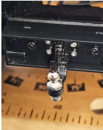
Die für den Betrieb am Modell ausreichend dimensionierte metallene Kugelkupplung, bezogen von Absima
