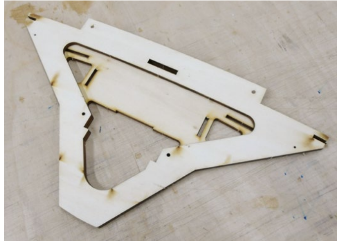
Zentrales Element ist der aufgedoppelte Rumpfspant, der punktuell mit dem Rumpf verklebt ist
