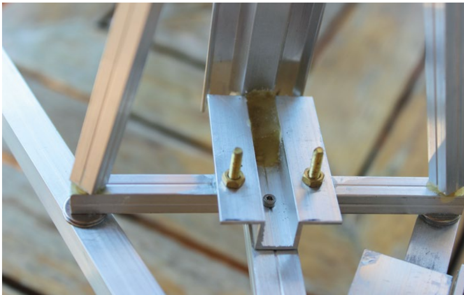
Das Omega-förmige Alu-Stück zur zentralen Aufnahme der Bugstütze
