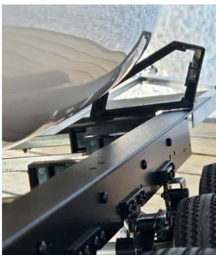
Die angepassten Abstützungen am Bug, fixiert und in Kunststoff eingegossen für optimalen Halt
