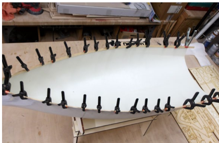
Anbringen der Decksstringer an die Rumpfschale. Viele Klemmen halten das Ganze in Position
