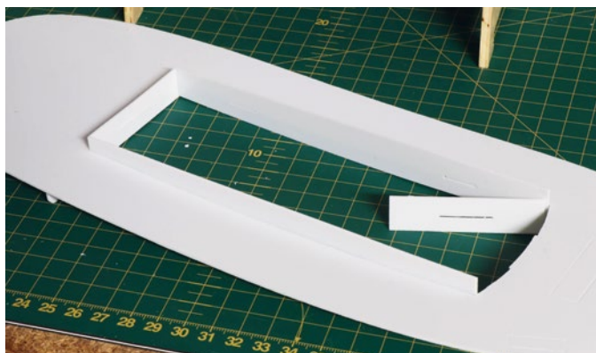
Einpassen des Süllrands in den Decksausschnitt, der Nacharbeit erfordert
