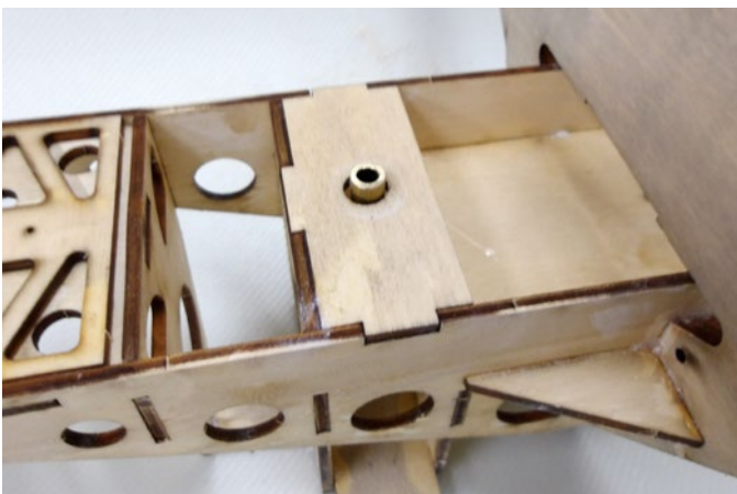
Nach dem Bohren des einzigen Lochs im Rumpf wird die Messinghülse zur Aufnahme des Kielbolzens eingebracht
