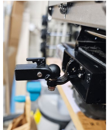
Die montierte Kupplungsklaue, gesichert mit einer M3-Sechskantschraube und in das Deichselrohr integriert
