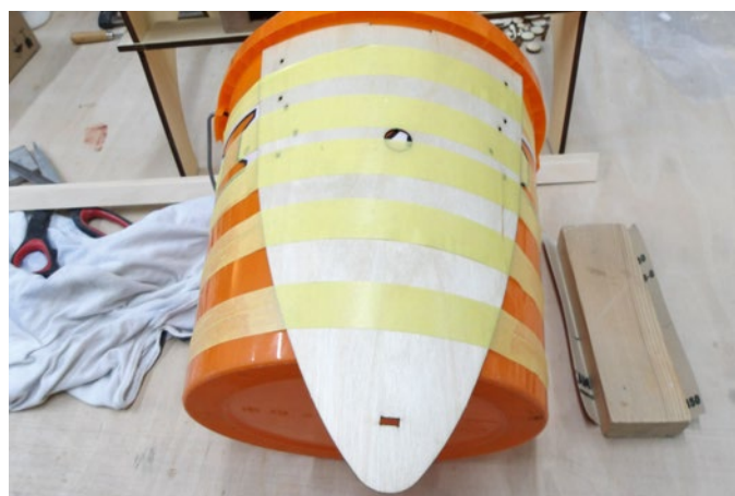
Das gewässerte Kajütdach ist beispielsweise über einem Eimer vorzubiegen
