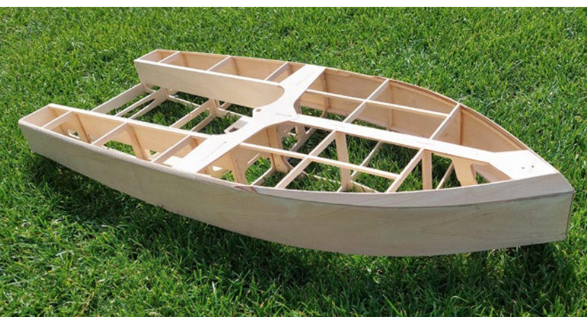
Beplankungsmaterial ist aus dem eigenen Fundus beizusteuern. Hier zu erkennen ist die nach eigenen Vorstellungen modifizierte Rumpfkante im Bugbereich
