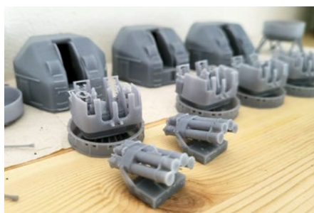
Die Teile werden in mehreren, möglichst einfach zusammen zu bauenden Elementen gedruckt
