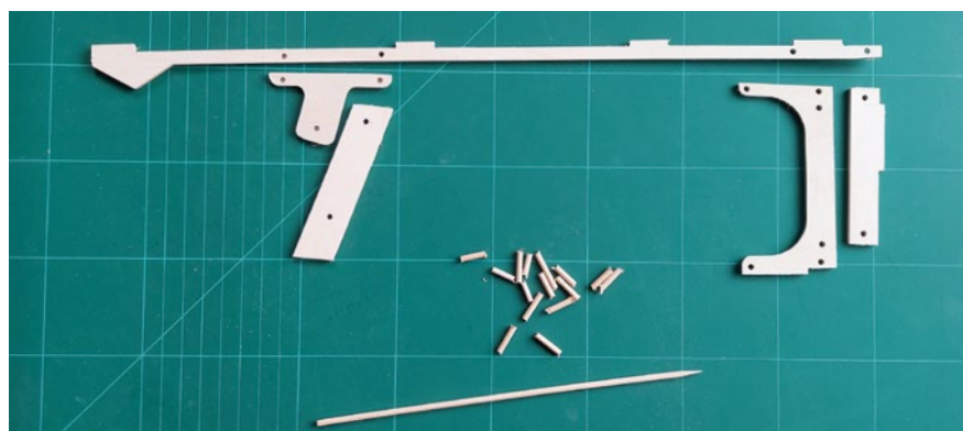
Bauteile, die zu doppeln oder aufeinander zu bauen sind, werden über Passestifte exakt positioniert
