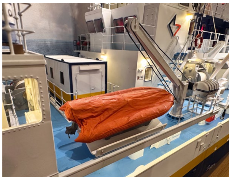
Die Plane des Beiboots besteht aus einem Tempotaschentuch, das ich mit einem Gemisch aus wasserfestem Holzleim und Wasser eingestrichen habe
