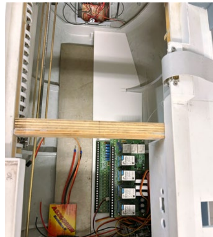
Darüber kam dann eine 3 mm starke Polystyrolplatte als Maschinenraumboden. Auf dieser wurden die Elektrokomponenten befestigt
