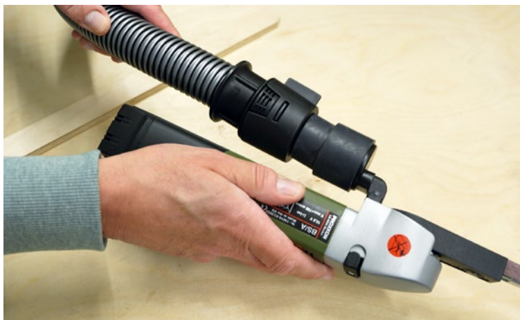
Selbst akkubetriebene Werkzeuge mit integrierten Ansaugstutzen sind zusammen mit dem WSA nutzbar
