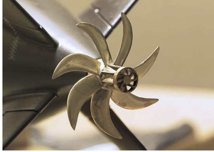
Selbst gelöteter Messingpropeller mit Antikavitationsdüse
