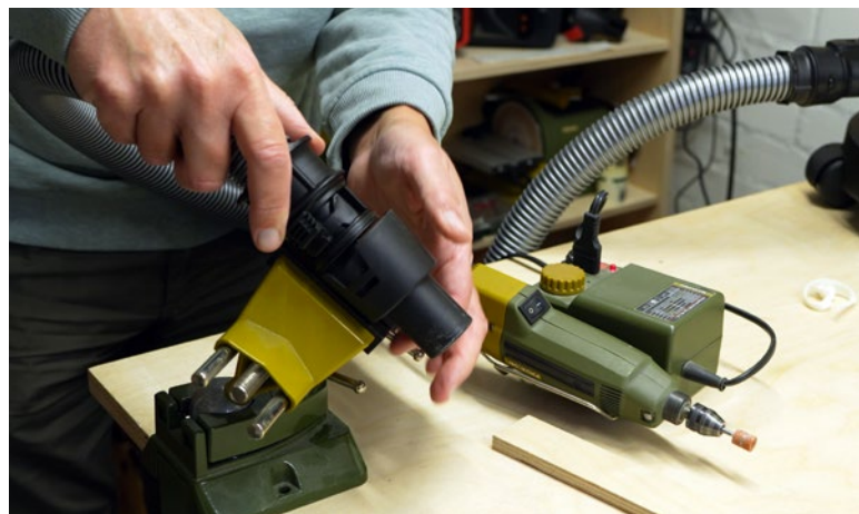
Eingeklemmt in einem Schraubstock lässt sich auch lokal absaugen, beispielsweise bei Einsatz von Handschleifgeräten
