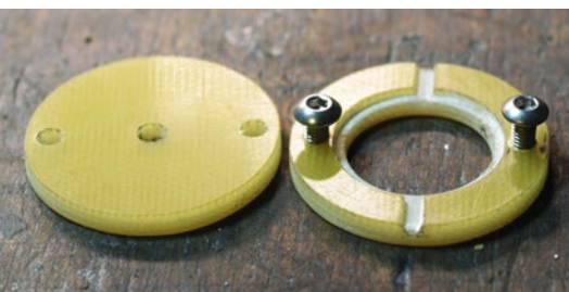
Stattdessen entstand im Eigenbau ein schraubbarer Deckel
