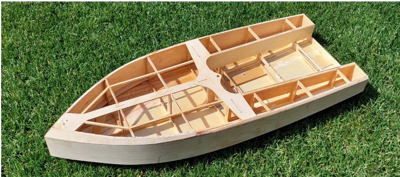
Der Boden ist beplankt und ein Foto zur weiteren Motivation gemacht – denn jetzt folgt die etwas monotone Arbeit des Rumpfschleifens
