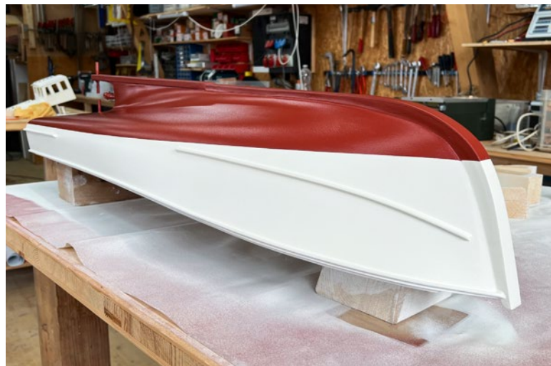
Das Unterwasserschiff erhält die Farbe Rostrot
