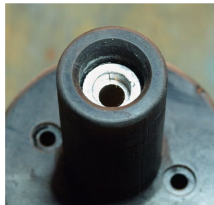
Im Alulager ist die Aufnahme für ein Kugellager gedreht
