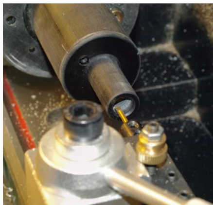
Ausdrehen des Druckkörperdeckels zwecks Aufnahme eines Alulagers
