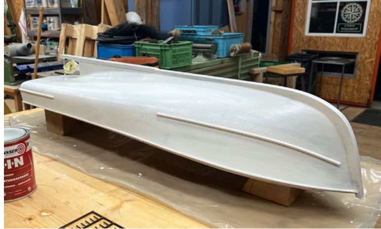
Der in Weiß lackierte Rumpf nach dem Grundieren
