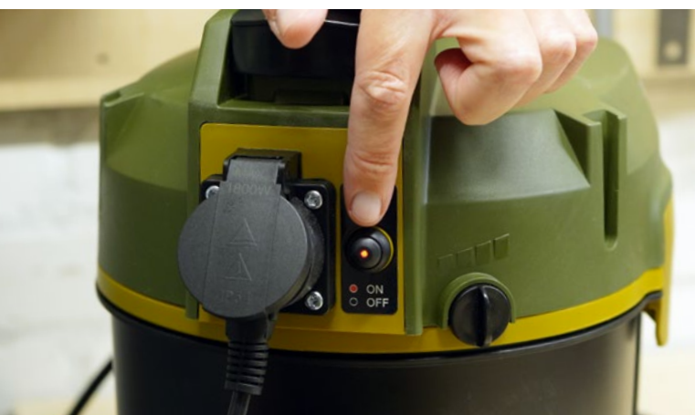
Praktisch ist die integrierte Startautomatik. Der Sauger ist nur aktiv, wenn das Werkzeug eingeschaltet ist
