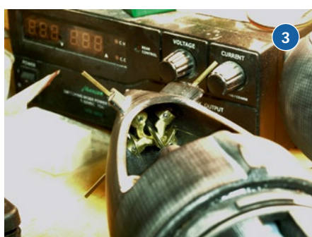
1) Beim Anziehen der Feststellschraube platze das PETG-Druckteil auf. 2) Neu gefertigte Ruderanlenkungen aus Messing. 3) Im Heck eingesetzte Ruderanlenkungen mit Lenkstangen
