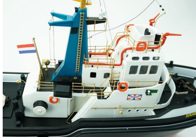
Feuerlöschschläuche, Geländer und Details an der Kabine des Schleppers
