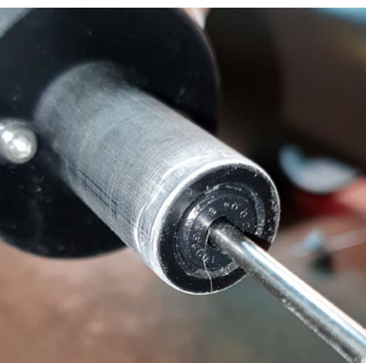
Der umgedrehte Wellendichtring wurde nicht eingeklebt
