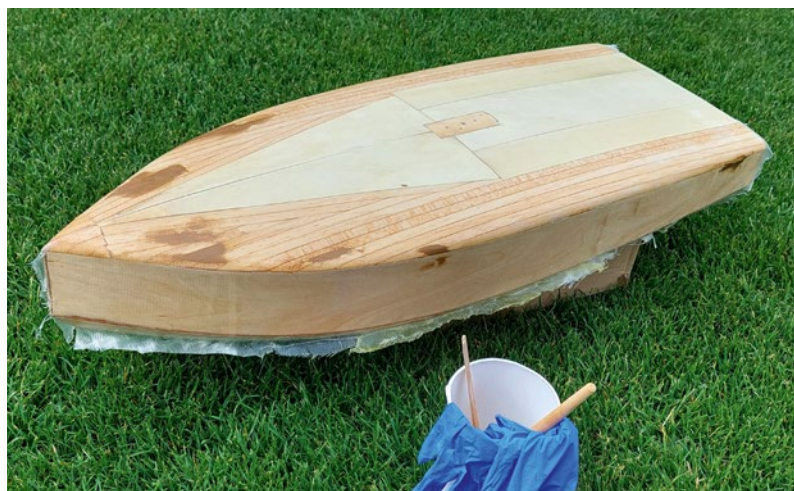
Wasserdichtigkeit lässt sich erst durch eine Lage Glasfasermatte und Harz erzielen. Das macht man an der frischen Luft und mit Einweghandschuhen
