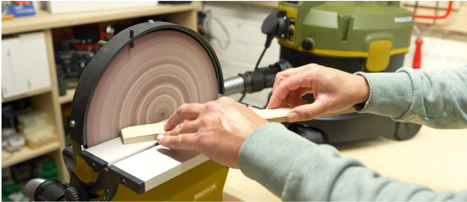
Beim Schleifen anfallender Staub wird direkt in den WSA (im Hintergrund) abgesaugt und hält Werkzeug sowie Werkstatt sauber
