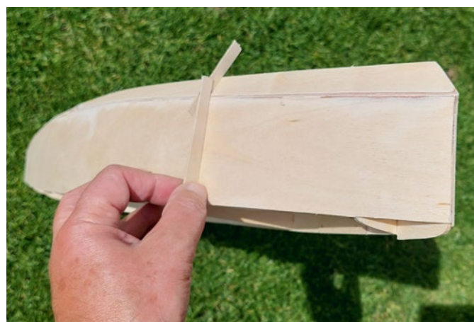
Zum exakten Schleifen der Rumpfkantenmodifikation wurde eine Winkelschablone als Kontrollinstrument genutzt
