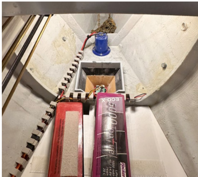
Ganz vorne der Kettenkasten, dann Bugstrahlruder, Vertiefung für die Unterwasserkamera sowie Scheinwerfer und dahinter der Raum für die Akkus
