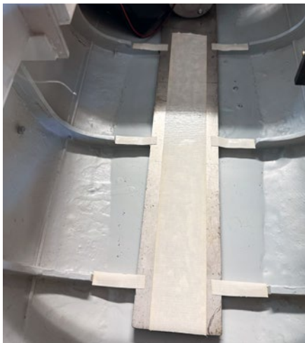
Ganz unten wurden 4 x 8 mm dicke Niro-Stahlplatten mit Hilfe von doppelseitigem Klebeband eingebaut
