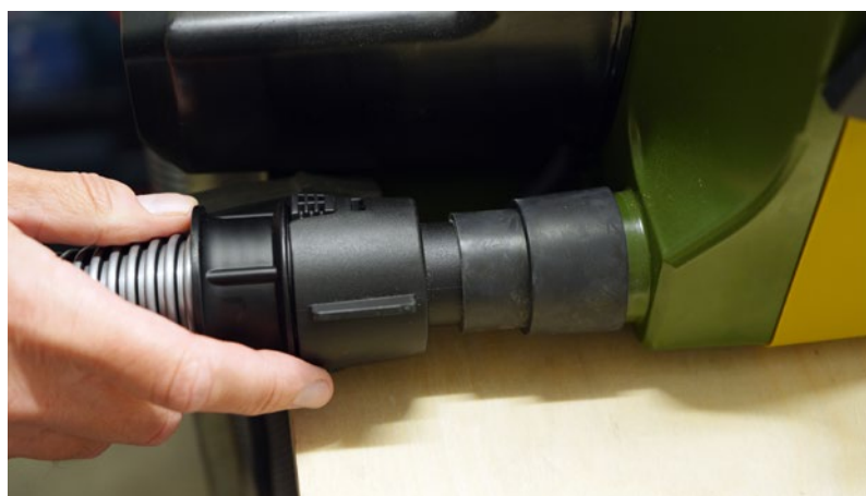
Über mitgelieferte Adapter lassen sich vor allem die Absaugstutzen an Proxxon-Geräte sehr gut anschließen
