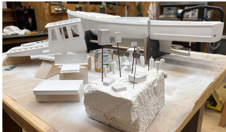
Die weiße Grundierung wird auf diverse Teile aufgetragen
