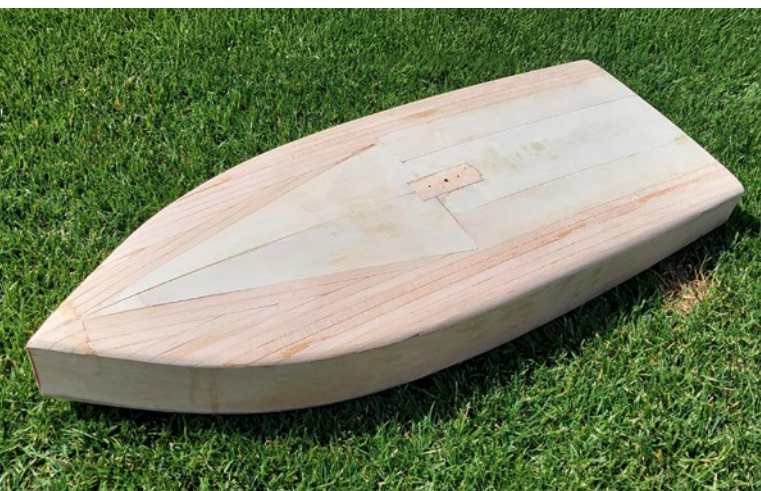
Das Schleifen fördert die schönen Konturen des Unterwasserschiffs der b-seven M zu Tage. Gut sichtbar sind die verschiedenen Beplankungsteile aus Leisten und Platten
