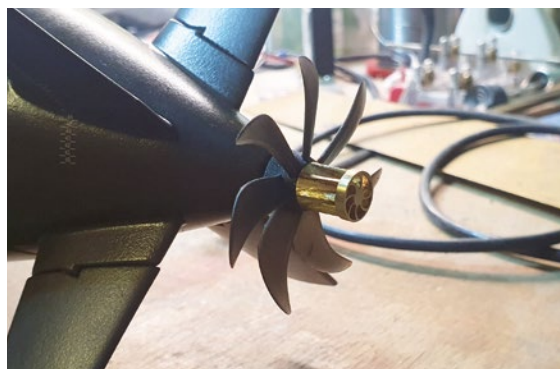
1) Beim Anziehen der Feststellschraube platze das PETG-Druckteil auf. 2) Neu gefertigte Ruderanlenkungen aus Messing. 3) Im Heck eingesetzte Ruderanlenkungen mit Lenkstangen
