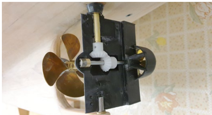
Ein Blick in die Mechanik des Aktivruders veranschaulicht die Funktion
