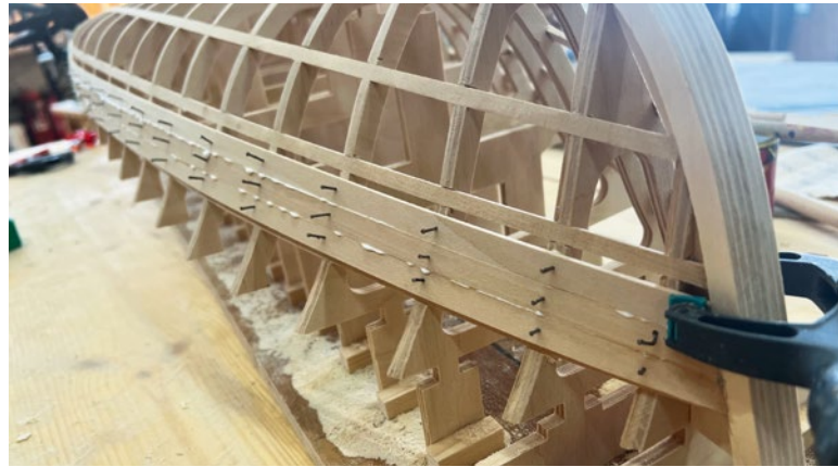
Nachdem die Spanten gestrakt waren, wurde der Rumpf mit Zedernleisten beplankt
