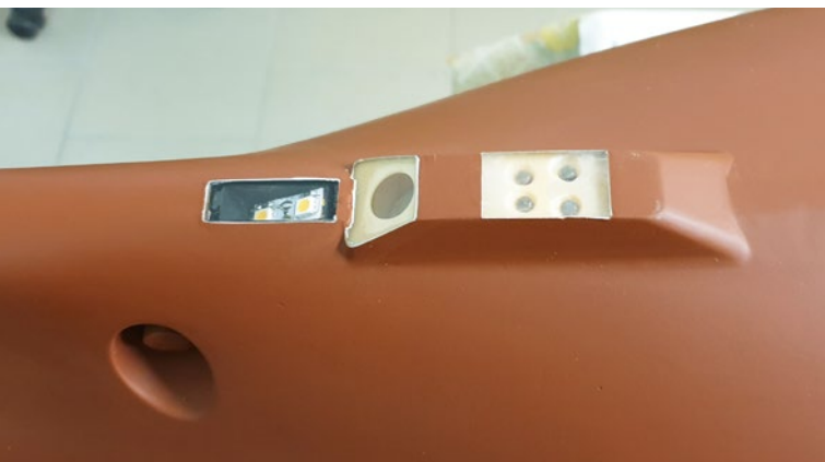
Im Sonardom sind die Unterwasserkamera und die LED-Beleuchtung untergebracht
