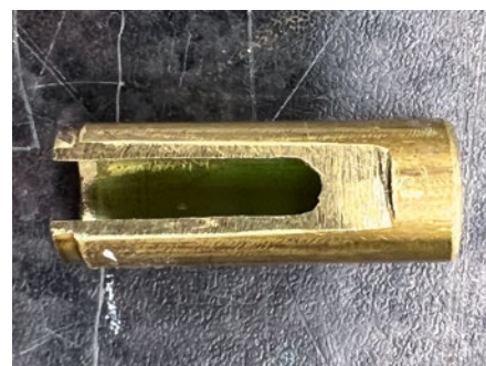
Die Mastfußhülse, worin der Mast steckt, entstand ebenfalls auf der Drehbank
