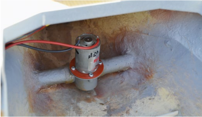
Als Manövrierhilfe wurde im Bug ein Querstrahlruder von Raboesch eingebaut
