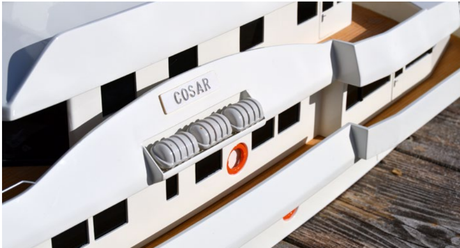
Die Rettungsringe sind nicht mit Haltern befestigt, sondern in die Wand eingelassen
