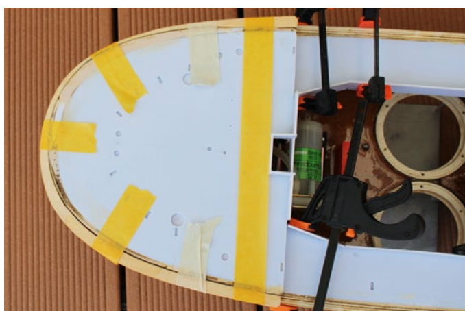
Nach dem Verspachteln und Anpassen der Scheuerleiste sieht alles wieder gerade aus
