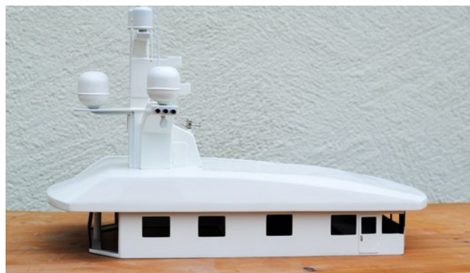
Danach wurden sie anhand der Schablonen in Polystyrol nachgebaut
