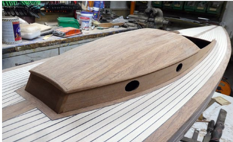
Das Dach der Kajüte ist abnehmbar, um ins Innere des Boots zu gelangen
