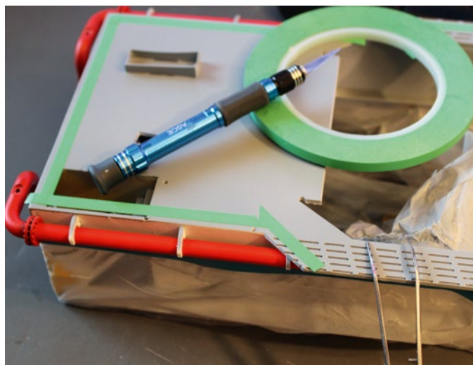
Die zu lackierten Flächen müssen sorgfältig abgeklebt werden
