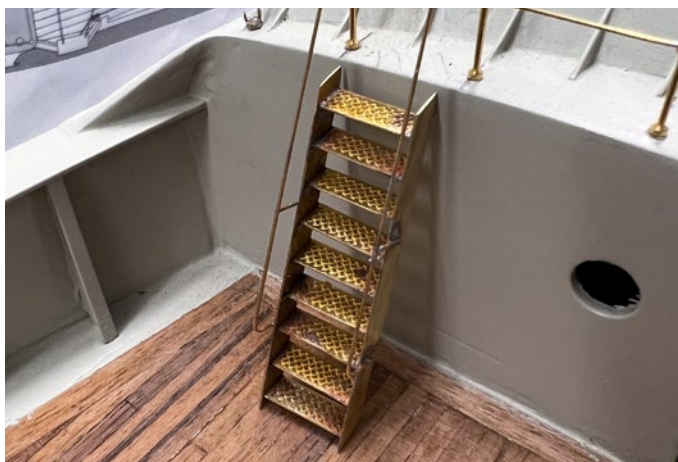
Der Kunststoffniedergang wurde durch ein fein detailliertes Ätzteil ersetzt
