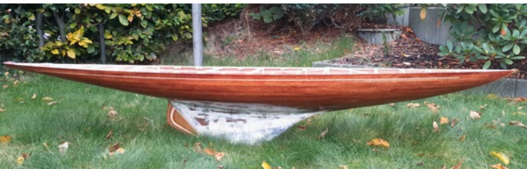
Vor der ersten Schwimmprobe wurde der Rumpf mit G8 wasserdicht versiegelt
