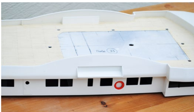
Mit Pappschablonen wurden die einzelnen Stockwerke des Aufbaus konstruiert
