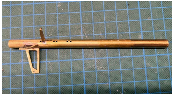
Danach wurden die Löcher für die Kabel gebohrt und Traversen angelötet
