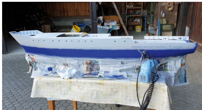
Lackiert wurde der Rumpf mit der Airbrushpistole und Tamiya-Farben
