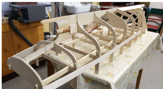
Das Spantengerüst steht von selbst und das Bepunken kann beginnen
