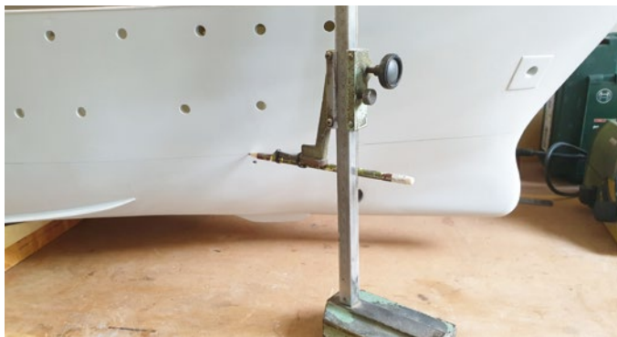
Danach wurde die Wasserlinie mit einem modifizierten Höhenreißer angestrichen
