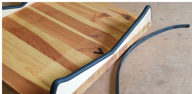
Der Schiffsständer entstand aus einer massiven Kiefernplatte und Gummi-Halbrundprofil
