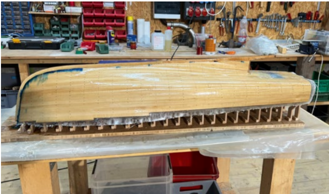
Der fertige Rumpf wurde mit drei Lagen Glasfasermatte überzogen
