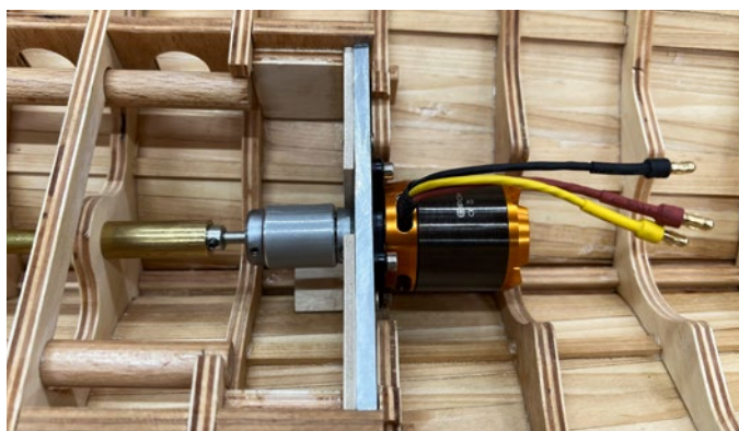
Der Motorspant wird mit dem angeschraubten Motor zuverlässig eingeklemmt
