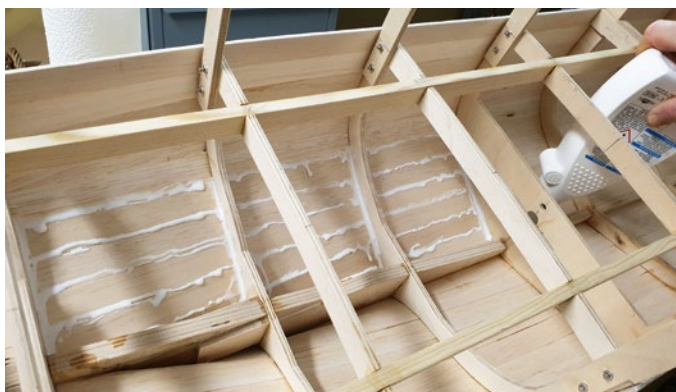
Abschließend werden die Lücken mit wasserfestem Holzleim verstrichen
