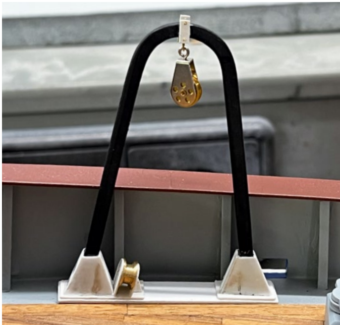
Die Netzgalgen bestehen aus einem gebogenen rechteckigen Kunststoffprofil
