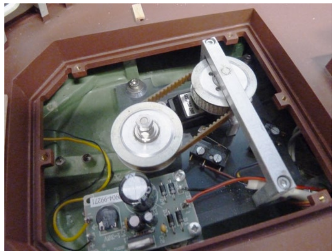
Unter der Grating auf dem Achterdeck befindet sich der Zugang zur Ruderanlage
