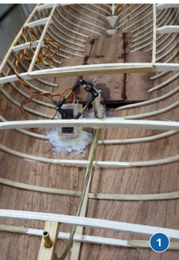
Vor der ersten Schwimmprobe wurde der Rumpf mit G8 wasserdicht versiegelt
