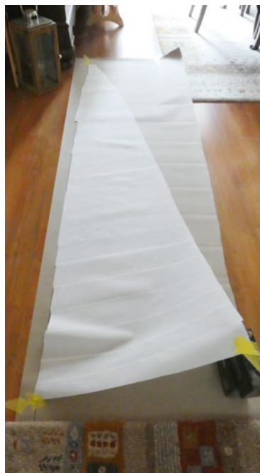
Die Segel wurden mit dem Heißschneider aus dünnem Dacron geschnitten
