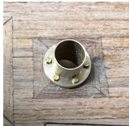
Für die Durchführung des Masts durch das Deck wurde ein Mastfuß gedreht
