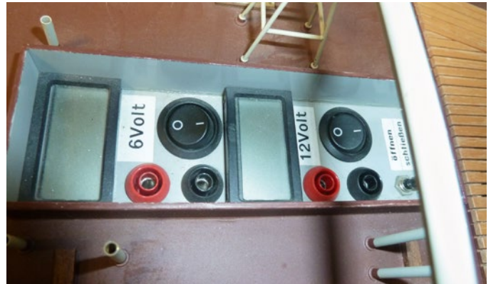
Unter einem Stapel Leckwehrrahmen sind die Schalter der Stromversorgung versteckt
