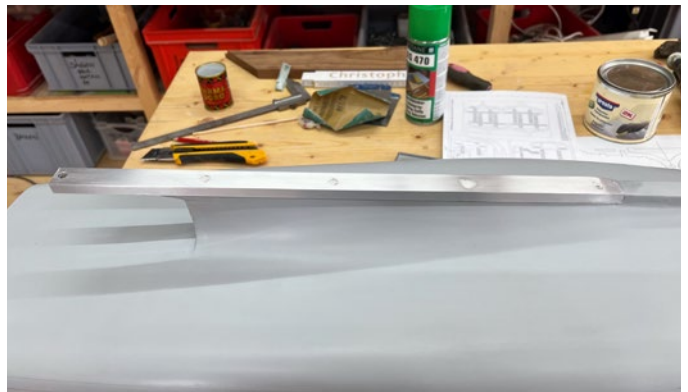
Zum Schluss wurde zum Schutz des hinteren Kiels ein Aluprofil aufgeschraubt
