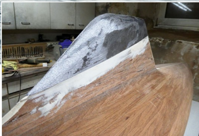
Der Bleikiel wurde in Formsand gegossen und am Boot angebracht
