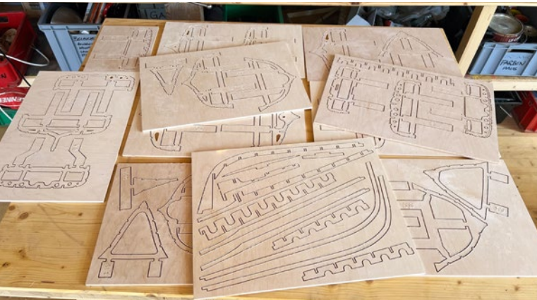
Das von Nils für mich gefräste Spantenpaket hat mir beim Bau sehr geholfen
