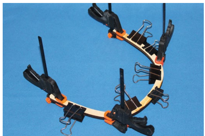
Verschiedene Klammern helfen beim Verkleben der Scheuerleisten
