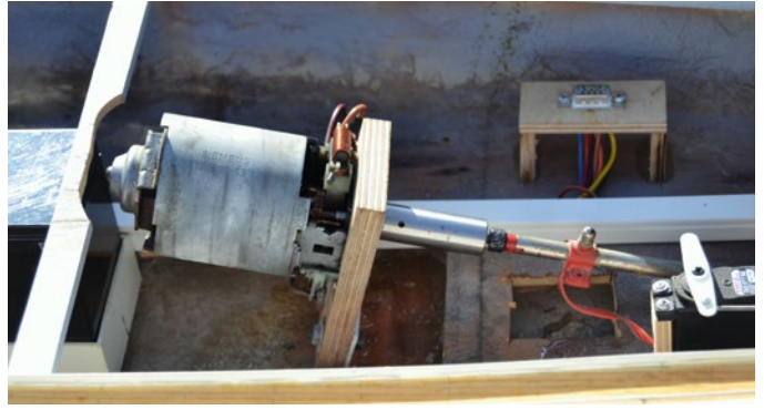
Als Antrieb kam ein günstiger Lüftermotor vom Schrottplatz zum Einsatz
