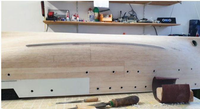
Die Bullaugen sind bereits verschliffen, Schlingerkiele und Bugstrahler sind noch in Arbeit
