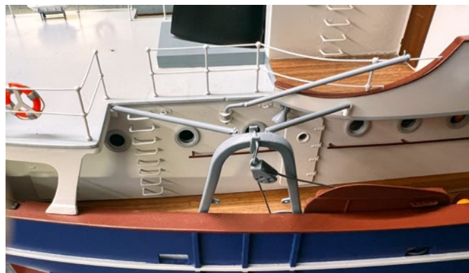
Die hinteren Abstützungen kann man wegklappen, um den Aufbau abzunehmen
