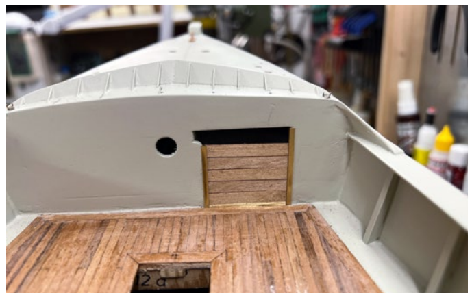
In die H-Profile werden die Brettchen zum Verschluß des Kabelgatts eingelegt
