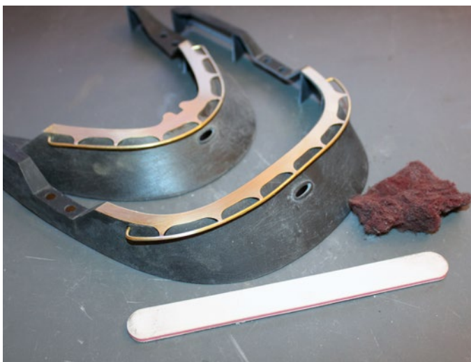
Die Reling am Schanzkleid muss aus einem Ätzteil und einem Rohrstück gelötet werden
