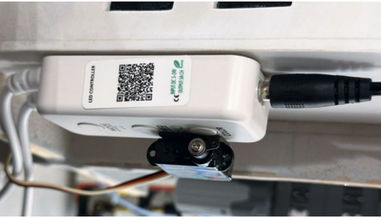
Beim Beleuchtungsmodul übernimmt ein Servo den Farbwechsel
