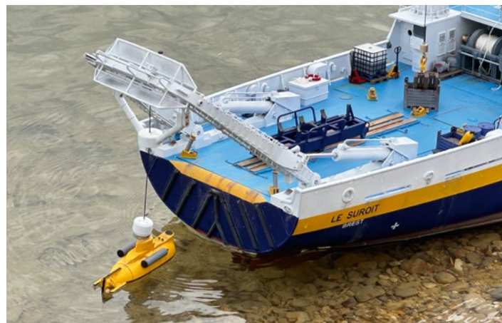
Mit Hilfe des Elektromagneten kann das U-Boot abgesetzt werden
