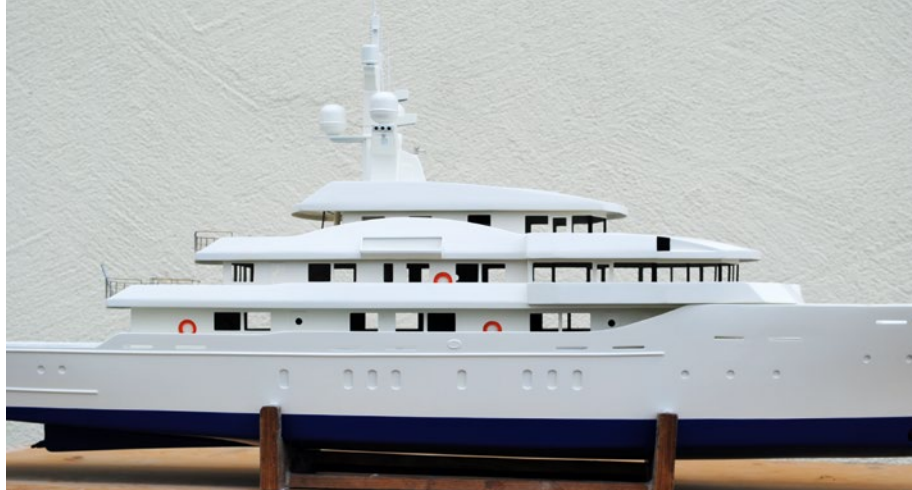
Die schwarzen Acrylscheiben wurden erst nach dem Lackieren in die Fensteröffnungen des Rumpfs geklebt
