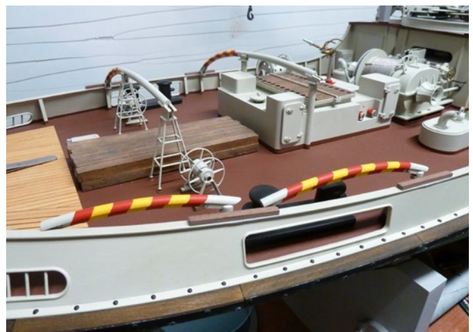
Wenn nicht geschleppt wird, können die Trossenbügel zur Seite geklappt werden
