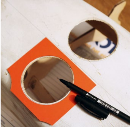
Schablonen helfen dabei, die Tunneldurchbrüche auf das richtige Maß zu bringen
