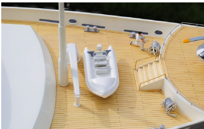
Das Schlauchboot wurde mit Außenborder, Sitzbänken und einem Fahrpult ergänzt
