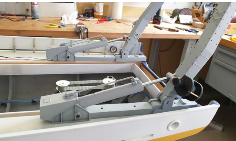
Ausgeschwenkt wird der A-Frame über zwei Lego-Spindelantriebe mit Getriebemotoren
