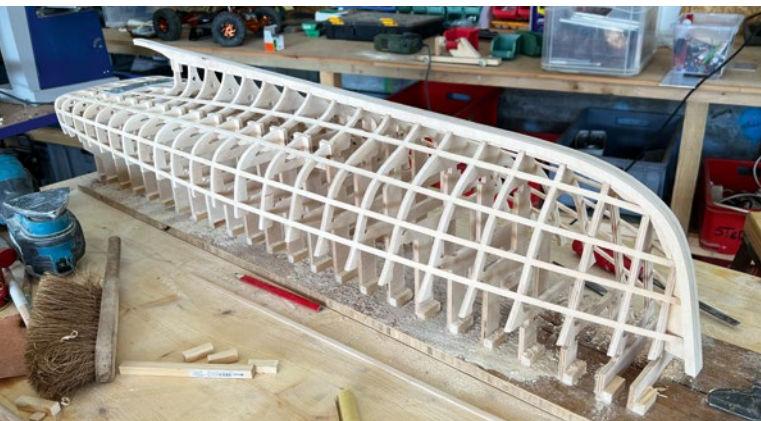
Anschließend wurden die Stringer in die vorgesehenen Ausschnitte eingesetzt
