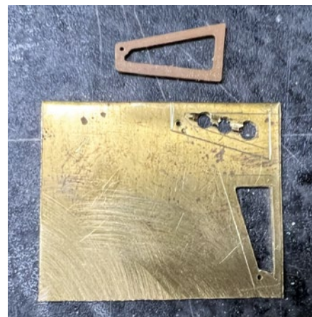
Die Halter der Flaschenzüge werden aus stabilem Messing nachgebaut
