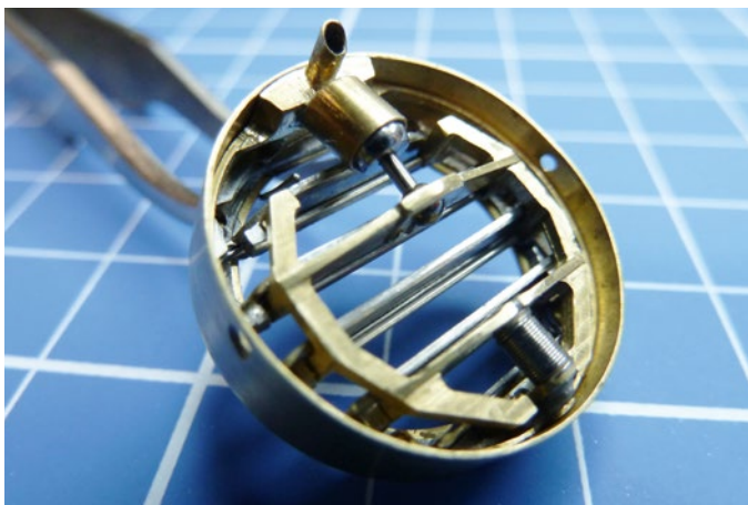
Der Lamellenvorhang des Signalscheinwerfers wird pneumatisch angesteuert
