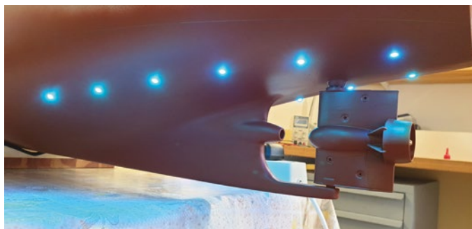
Das Heck der LE SUROIT mit fertigem Aktivruder und RGB-Unterwasserbeleuchtung
