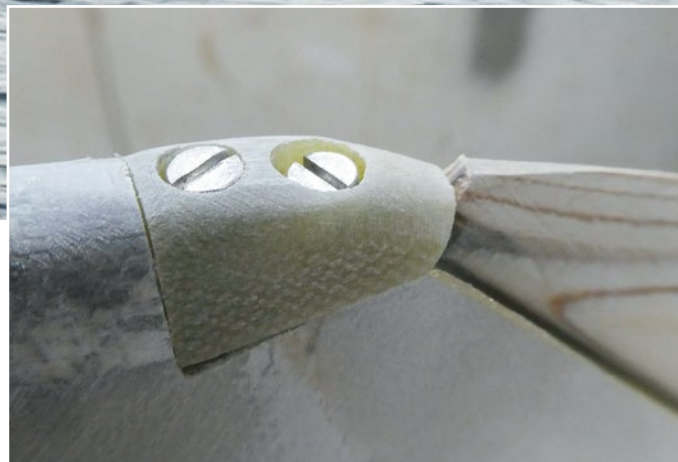
Die untere Lagerung der Ruderwelle ist geschraubt und damit demontierbar
