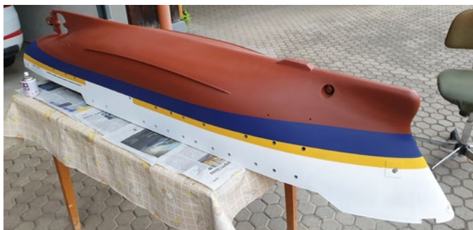
Das Unterwasserschiff wurde mit rotbrauner Spraila-Grundierung lackiert
