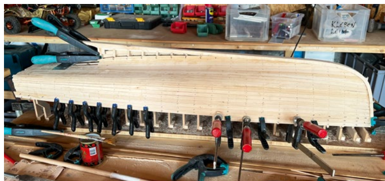
Am Übergang zum Kiel wurden schmalere Leisten verwendet
