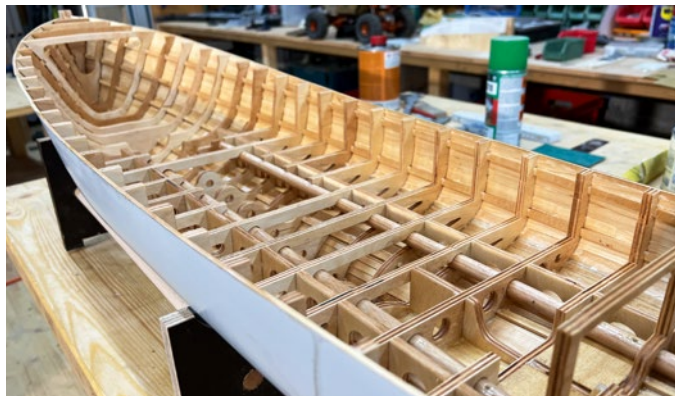
Um Platz im Rumpf zu bekommen, habe ich alle überflüssigen Stege herausgetrennt
