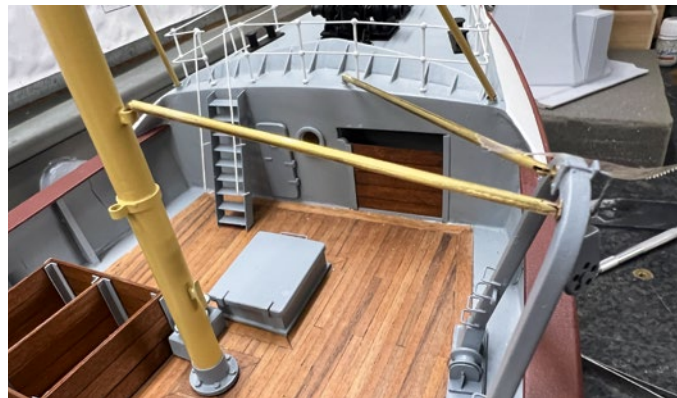
Der vordere Galgen stützt sich am Mast und an der Back ab
