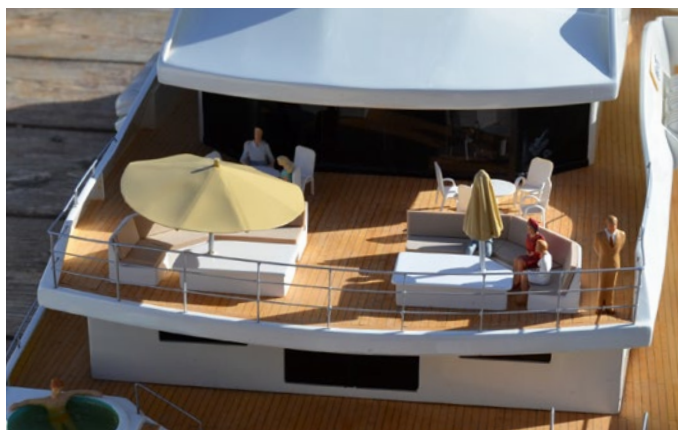
Aus Messingröhrchen und Polystyrol entstanden die beiden Sonnenschirme
