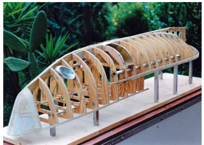
Der Ausgangspunkt ist ein klassischer Überkopf-Spantbau
