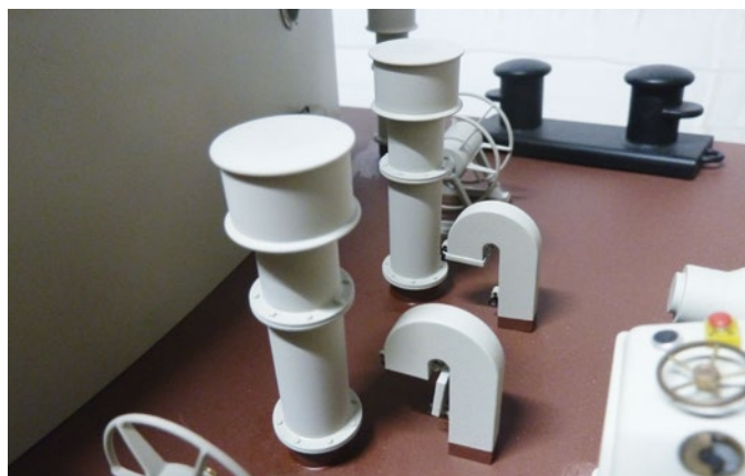
Diverse Lüfter, Poller und Winden auf dem Backdeck
