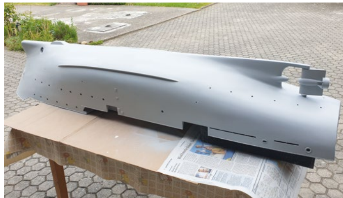
Der Rumpf wurde innen und außen mit Sprilla-Autolackgrundierung gestrichen
