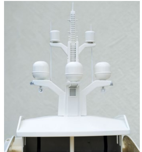
Die Radome sind aus Ü-Eier-Verpackungen und Rohrendstücken nachgebaut
