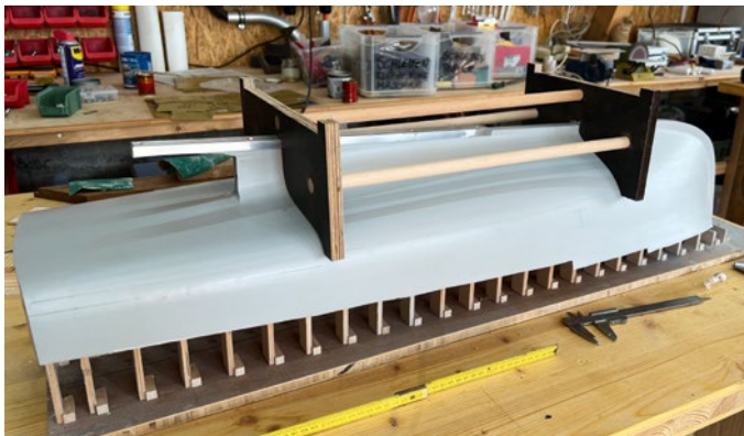
Der Ständer wurde gebaut, damit der Rumpf von der Helling getrennt werden kann
