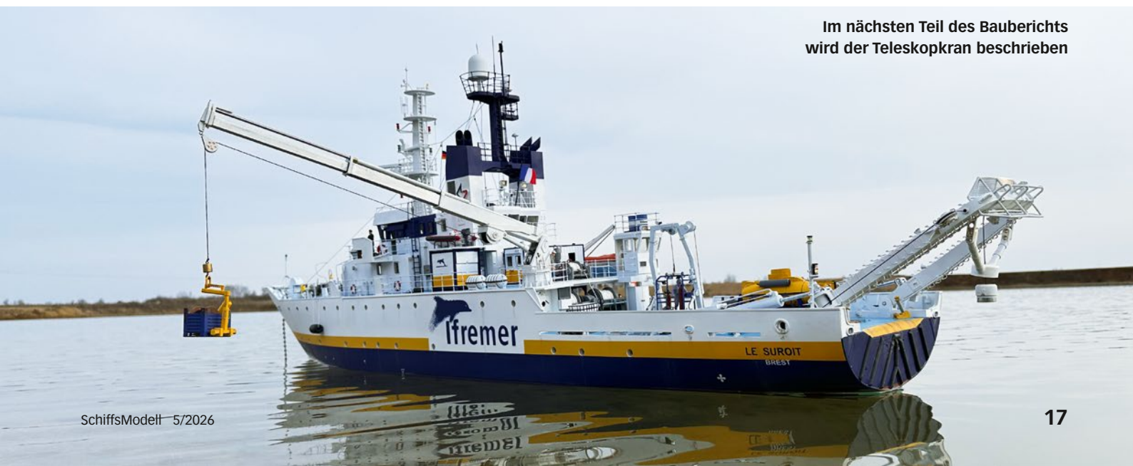
Mit Hilfe des Elektromagneten kann das U-Boot abgesetzt werden
