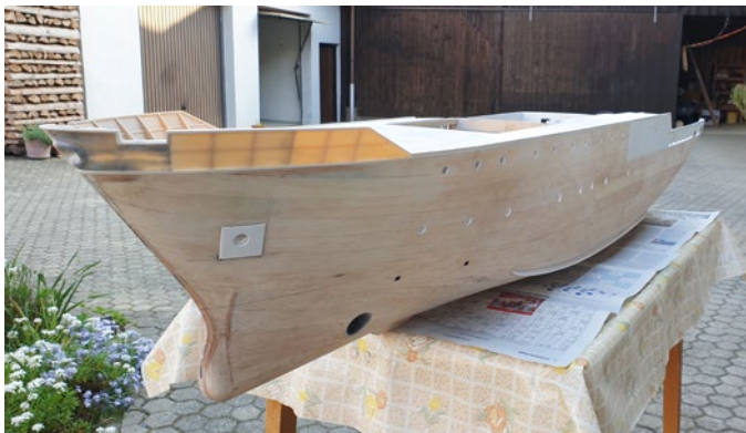
Das Schanzkleid am Bug wurde wegen der Rundungen 3D-gedruckt
