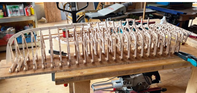
Das Gerüst wurde aufgestellt und an Klötzen auf dem Hellingbrett geleimt
