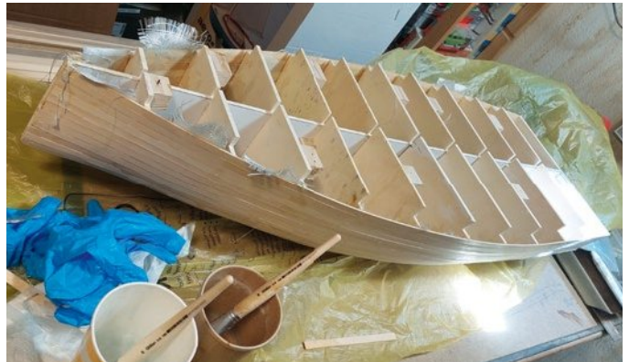
Von innen wurde die Rumpfform mit Glasfasermatte verstärkt
