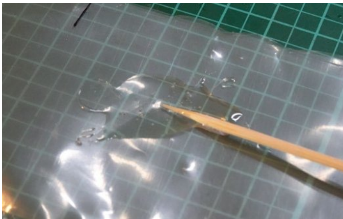
Den Scheibenkleber direkt aus der Tube auf das Werkstück zu übertragen, klappt nur selten. Daher gibt man besser einen großen Tropfen auf eine nicht saugfähige Unterlage und tupft den Kleber dann mit einem Zahnstocher oder einem anderen spitzen Gegenstand ganz gezielt auf die richtige Stelle
