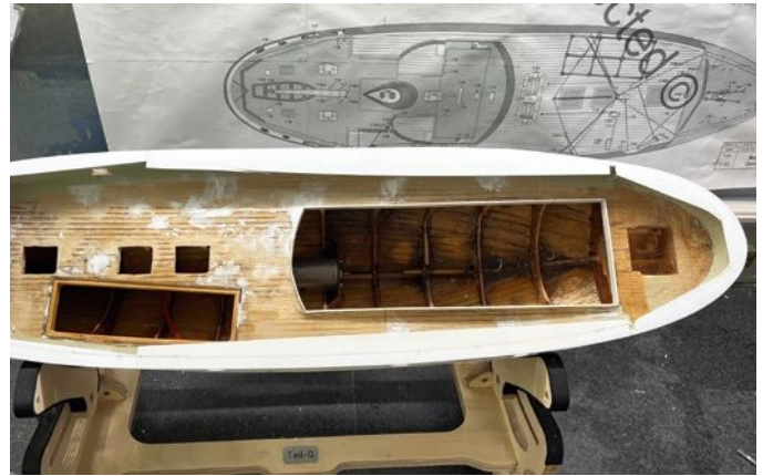
Für die Abschlussleiste wurden zuerst Polystyrolstreifen mit Überbreite aufgeklebt
