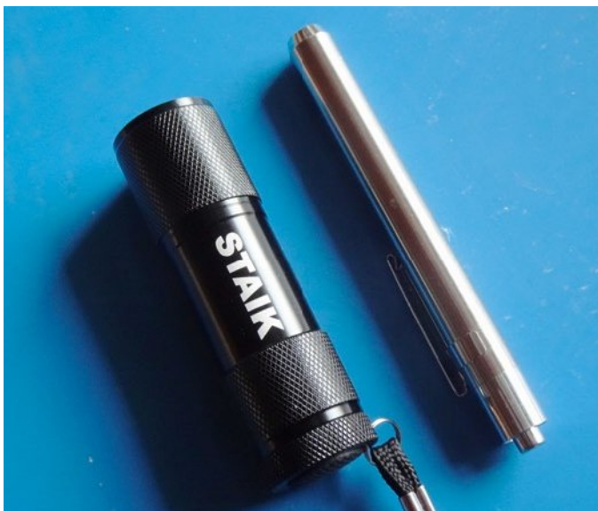
Zum UV-Kleber gehört unbedingt eine entsprechende UV-Lampe, die es in unterschiedlichen Größen und Lichtstärken gibt, um den Kleber zu aktivieren
