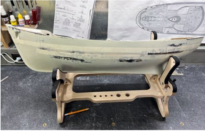
Für die Positionierung der Speigatten wurde die Deckshöhe nach außen übertragen
