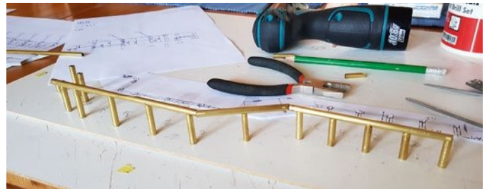
Die Cargorail habe ich aus Messingröhrchen zusammengesteckt und verlötet
