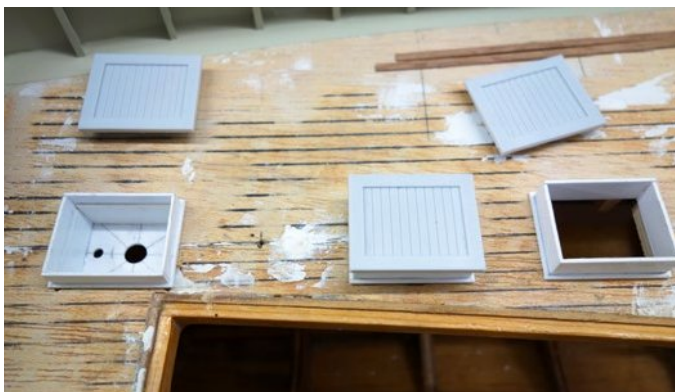
Zur Festlegung der Leibhölzer wurden zuerst die Fischkisten aus Polystyrol gebaut
