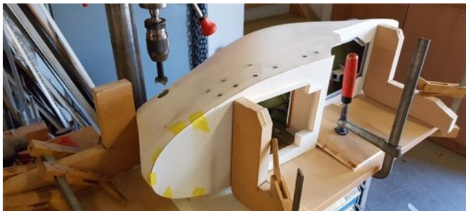
Ein Fall für die Werkstatt: Die Bohrungen für das Bugstrahlruder werden eingebracht
