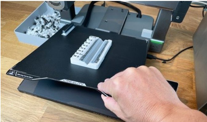
Die Druckauflage ist biegsam, sodass man das gedruckte Modell schnell lösen kann
