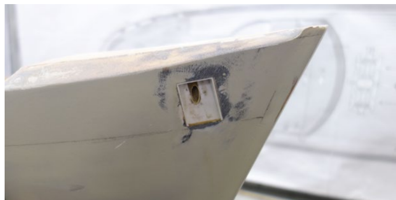
Die Ankertasche wurde aus Polystyrol neu gebaut und eingesetzt
