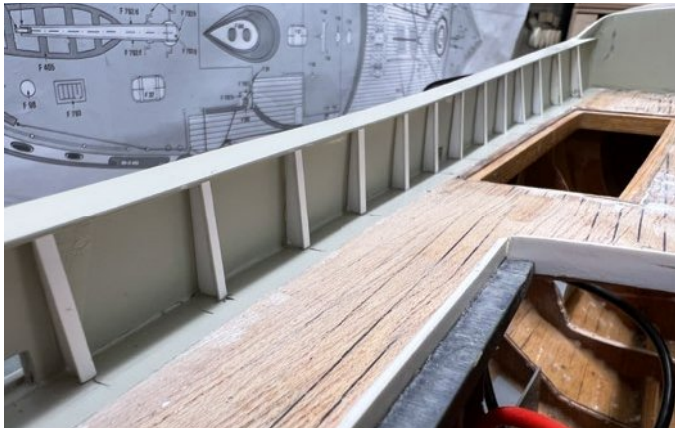
Die neuen Schanzkleidstützen habe ich aus Polystyrolstreifen gefertigt
