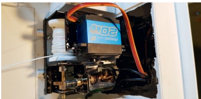
Da die Schleppwinde im Windenhaus versteckt ist, konnte sie funktional gebaut werden
