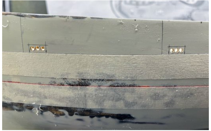
Danach wurden die Speigatten vorgebohrt und mit Feilen auf das richtige Maß gebracht
