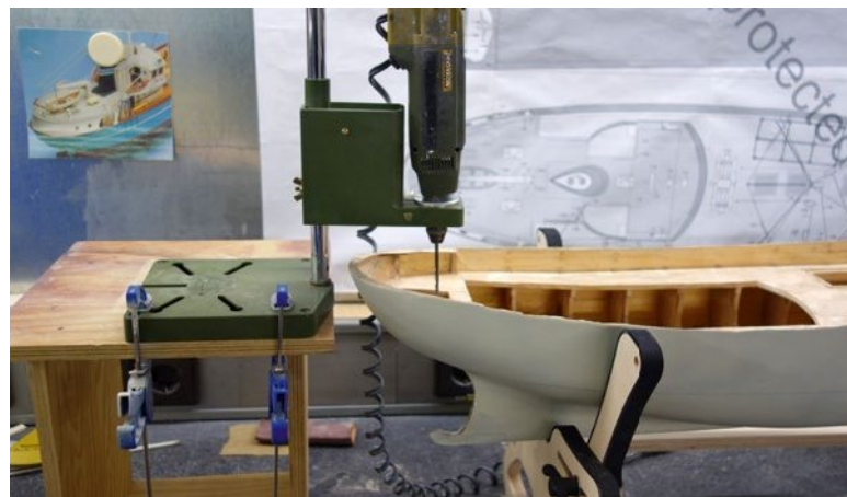
Mit einem Bohrstander konnte die Bohrung für den Ruderkoher exakt eingebracht werden
