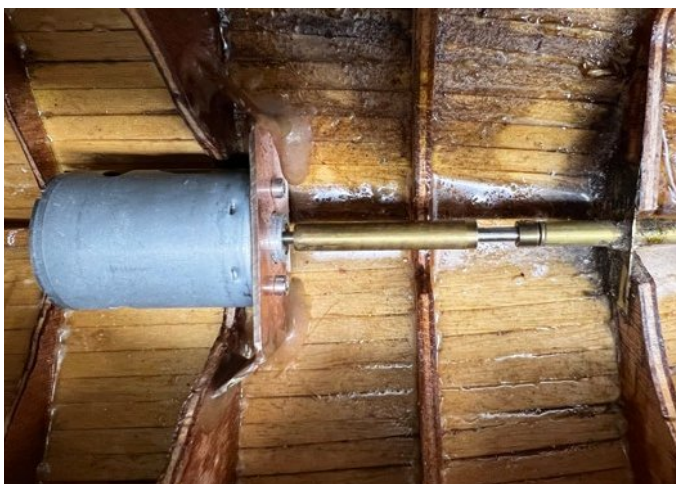
Mit einem Wellenadapter wird der Motorhalter mit eingebautem Motor eingeklebt
