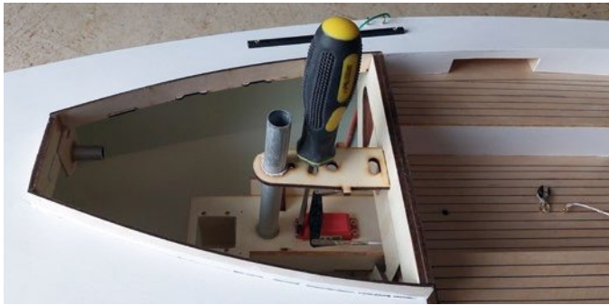
Sinnig angebrachte Bohrungen erleichtern den Einbau der Fernsteuerung
