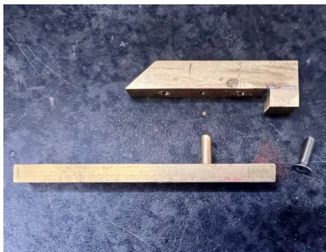
Die neue Ruderhacke besteht aus zwei verschraubten Messingteilen
