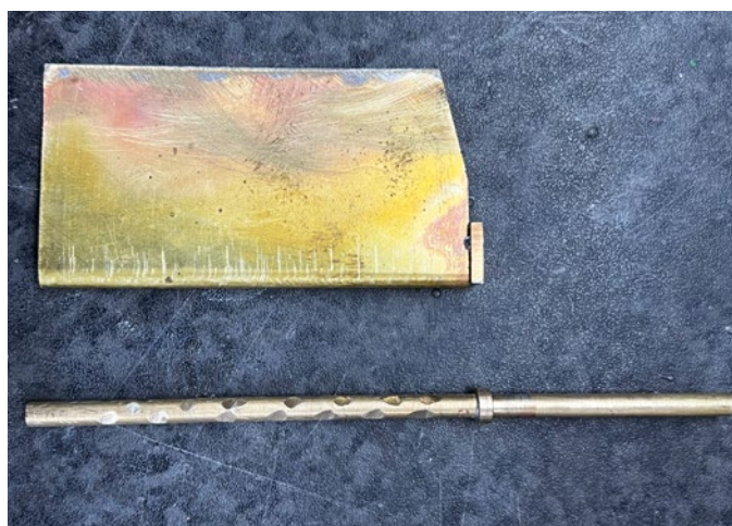
Durch das Ausgießen mit Epoxidharz wird die Welle gegen Verdrehen gesichert
