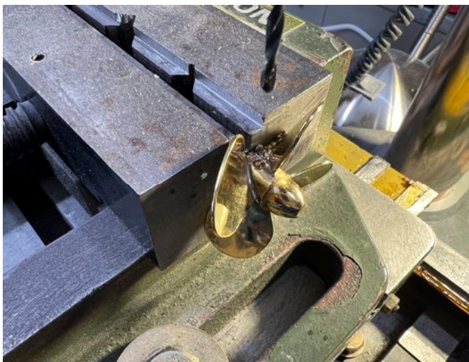
Mit einer Madenschraube direkt im Propeller wird dieser vor dem Abfallen gesichert
