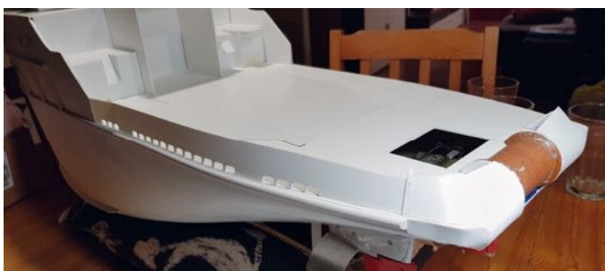
Beim hinteren Schanzkleid muss man mit der Anzahl der Speigatten sehr aufpassen
