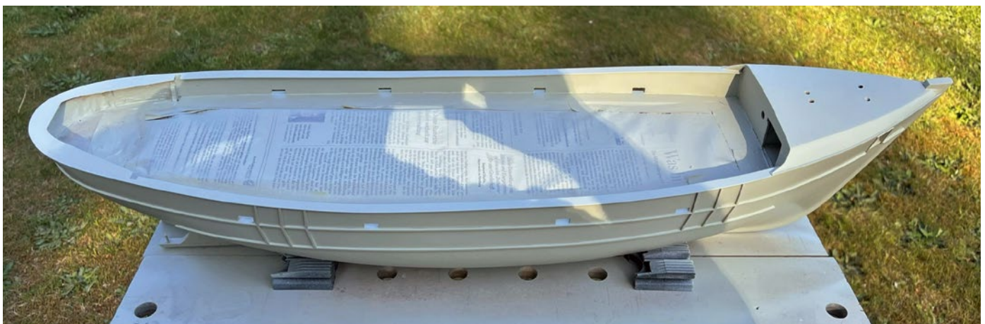
Nachdem der Handlauf beschnitten war, wurde der komplette Rumpf grundiert
