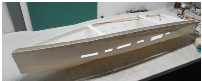
Die Fotos zeigen, wie aus ABS-Platten ein Bootsrumpf entstehen kann
