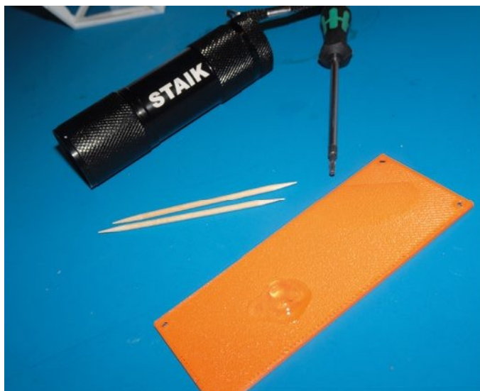
Ein großer Tropfen auf der Platte sowie Zahnstocher und Taschenlampe liegen griffbereit. Wir haben keinen Zeitdruck, der Kleber härtet erst bei Bestrahlung mit der Lampe aus
