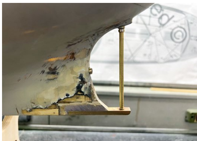
Durch exaktes Arbeiten passen Ruderhacke und Ruderwelle einwandfrei zusammen
