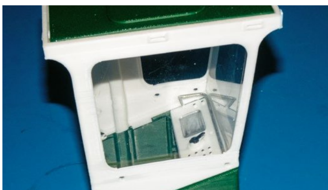
Hier sind die Verhältnisse für den Kleber denkbar schlecht. Nur schmale Klebeflächen und zusätzlich kann man bei dem offenen Fahrstand auch noch die Innenseiten der Fensterrahmen sehen
