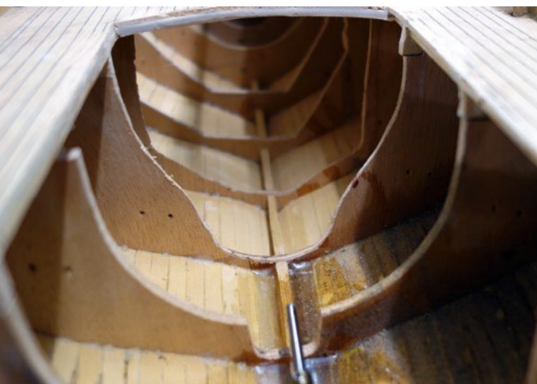
Für den späteren Einbau der Technik mussten die Spanten teilweise ausgesägt werden
