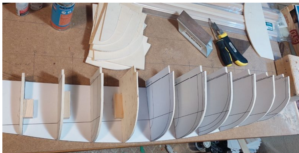
Alles begann mit dem Bau eines Urmodells für den Rumpf
