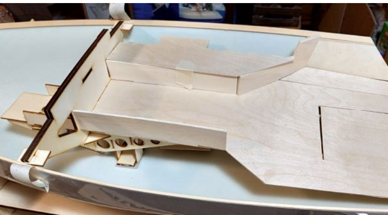
Als Nächstes kam der Rohbau des Cockpits an die Reihe
