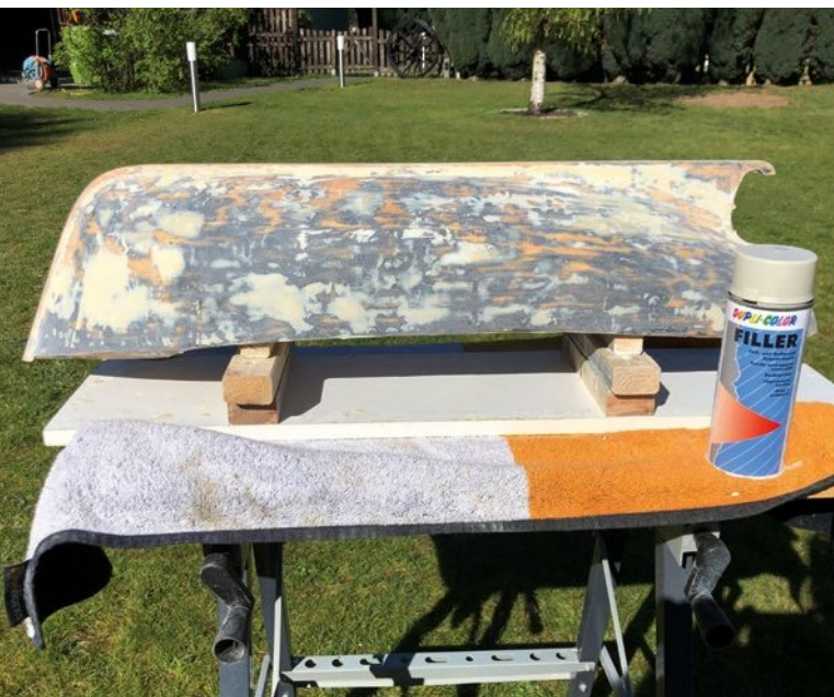
Zuerst wurde der Rumpf mit drei Lagen GFK überzogen und ist dadurch stabiler
