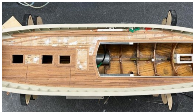
Zum Abschluss des Rumpfbaus wurde das Deck mit maßstäblichen Brettchen beplankt
