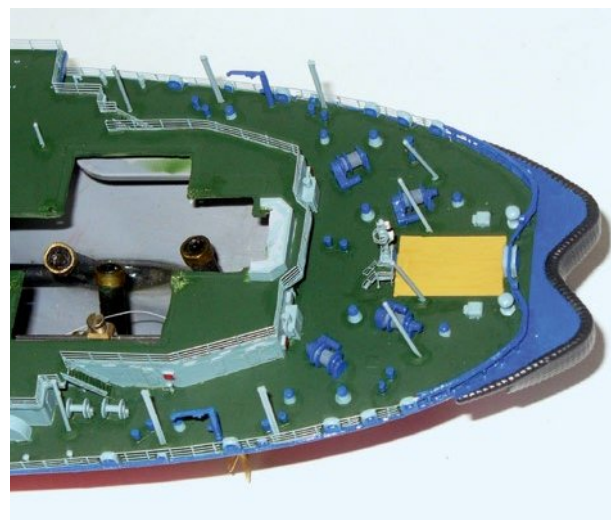
Auf dem Achterdeck sind bereits die Stützen für die Heliplattform gesetzt
