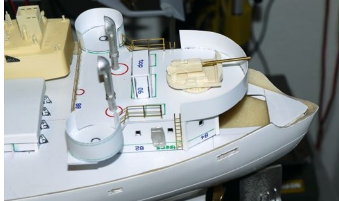
Aus den bedruckten Polystyrolplatten entstanden dann die Aufbauten
