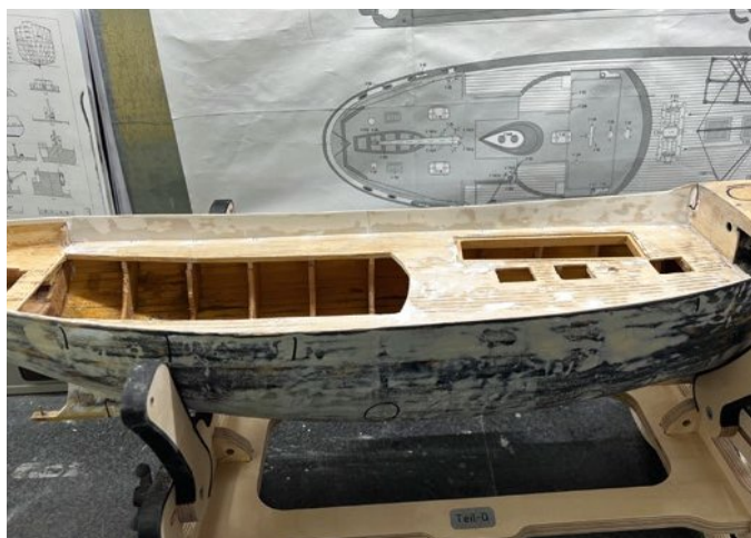
Mit 0,5 mm starken Polystyrolstreifen habe ich das Schanzkleid innen aufgedoppelt
