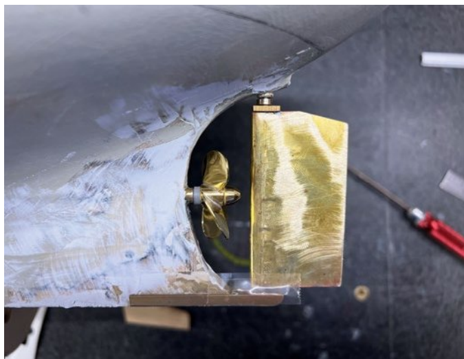
Bei der Probemontage von Propeller und Ruder passte alles auf Anhieb
