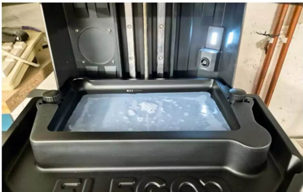
Die beheizte Resinwanne fasst gut einen Liter Kunstharz, bevor die Maximalmarkierung erreicht ist
