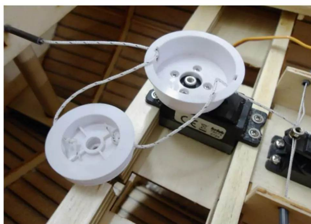
Die Schoten werden direkt auf die Trommel der Winde gewickelt
