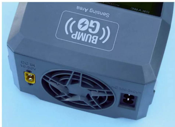
Rückseitig wird die Gleichspannungsquelle über einen XT-60- und die Wechselspannung über einen Eurostecker angeschlossen
