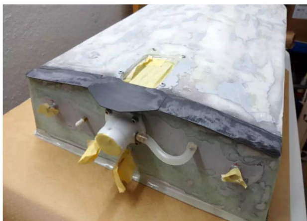
Am Heck sieht man die Abrisskante und die Autobailer zur Rumpfentwässerung
