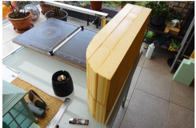
Danach habe ich die grobe Form mit dem Heißdrahtschneider ausgeschnitten
