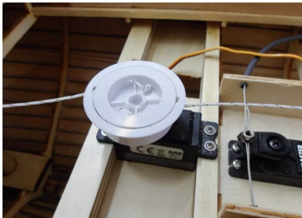
Die Trommel wird in einem Topf geführt, was durchaus zu Wuling führen kann
