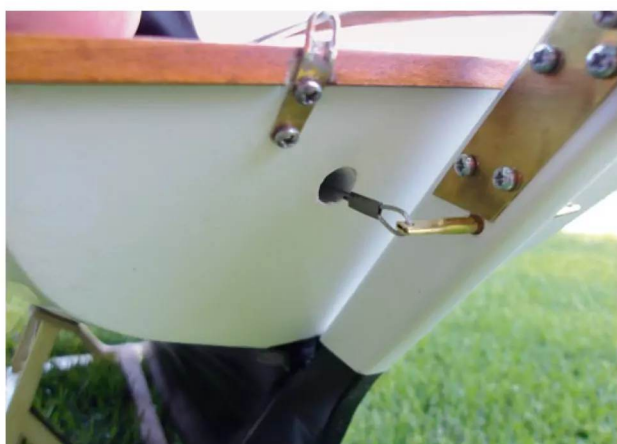
Am Heck werden die Seile dann am Ruder befestigt
