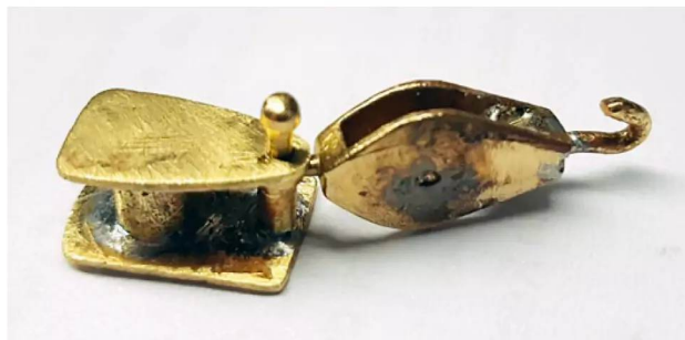
Da mit dem Schlepphaken auch geschleppt werden soll, ist er stabil aus Messing gelötet
