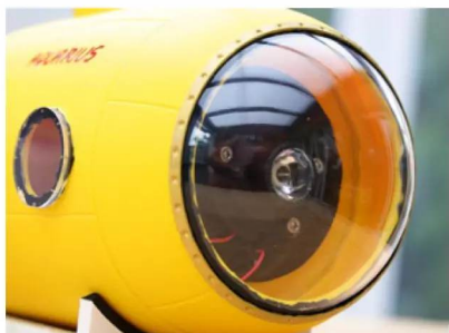
Am Bug ist eine große Plexigaskuppel mit Beleuchtung eingebaut
