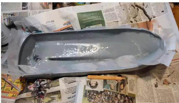
In den fertig verklebten Rumpf habe ich zusätzlich eine 50-g-Glasfasermatte einlamiert
