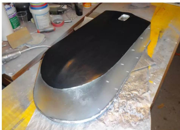
Das Unterwasserschiff wurde schwarz, der restliche Rumpf mit Chromsilber lackiert
