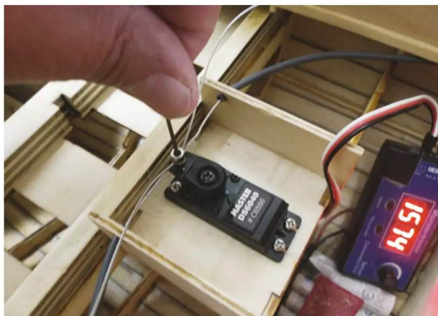
Das Ruder wird über Steuerseile vom Ruderservo angesteuert
