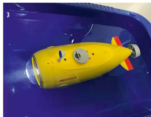
Die erste Wasserung zur Trimmung in der Plastikschaale war erfolgreich
