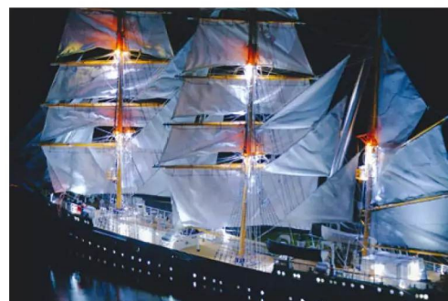
Die GORCH FOCK kann mit sieben Glühlampen und 55 LEDs beleuchtet werden
