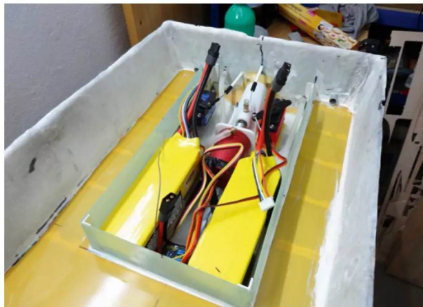
Rechts und links des Jets wurden die Akkus und die Steuerungsservos eingebaut
