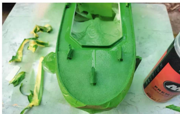
Ein Stück Heimat: Der Anti-Rutschbelag an Deck besteht aus Borkumer Sand
