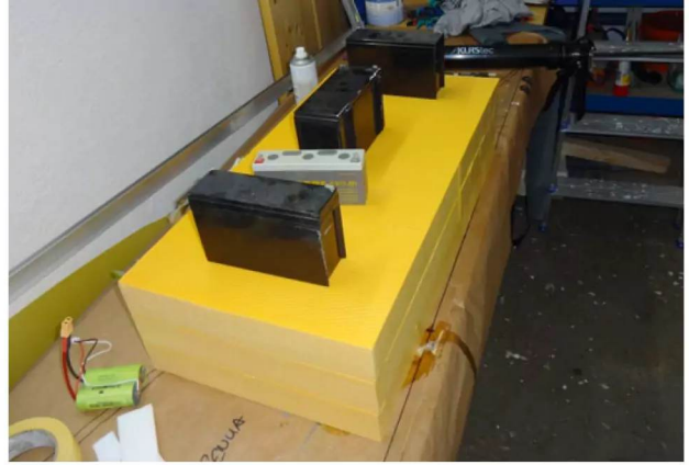
Für die Positivform des Rumpfs wurden Isoliermaterialplatten zusammengeklebt
