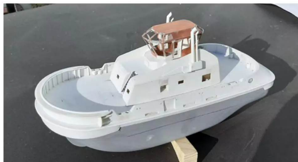
Zuerst habe ich versucht, die Brücke der BAVARIA aus Platinenmaterial zu löten
