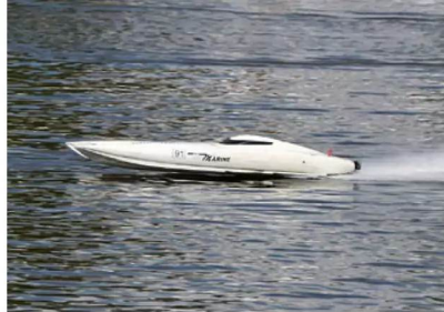
Die weit verbreitete MYSTIC, hier als 1.380-mm-Version mit zwei SSS 4092/1650-Motoren an je 6s
