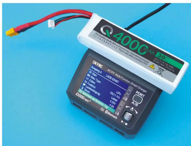
So wird ein Akku für Lese- und Schreibvorgänge des NFC-Tags auf dem Ladegerät platziert
