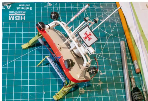
Das Dach des Steuerstands ist wie beim Original klappbar ausgeführt
