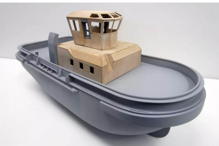
Danach wurde mit bewährten Material gebaut, Joachim bei der BUSSARD mit Sperrholz
