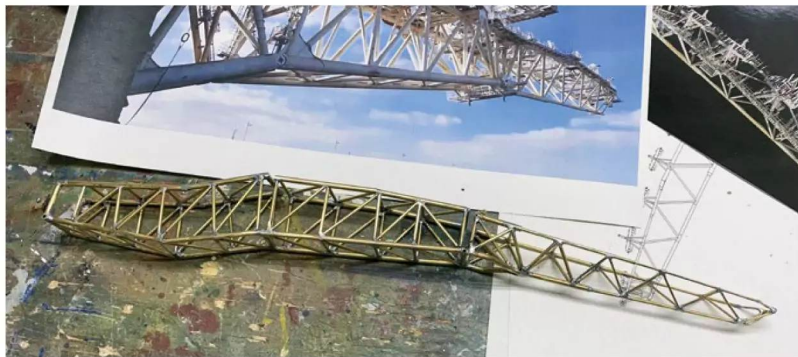
Der Stinger, mit dem die Rohre verlegt werden, ist aus Messingrohren zusammengelötet
