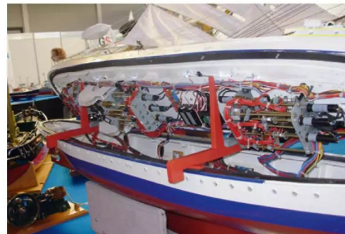
Das Deck kann komplett abgeklappt werden, um an die umfangreichen Einbauten zu gelangen
