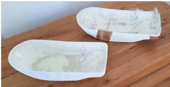
Im zweiten Versuch hatten die Abzüge des Rumpfs die nötige Stabilität
