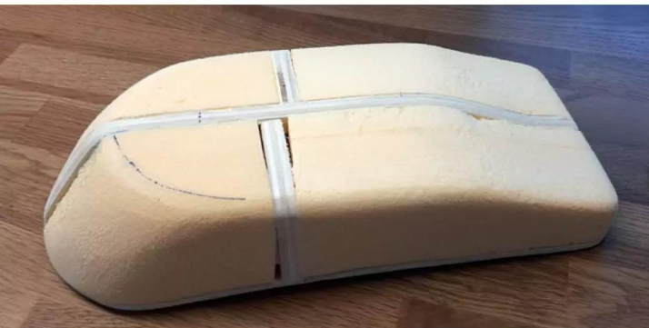
Die geschliffene Form des Rumpfs kann nun gespachtelt werden
