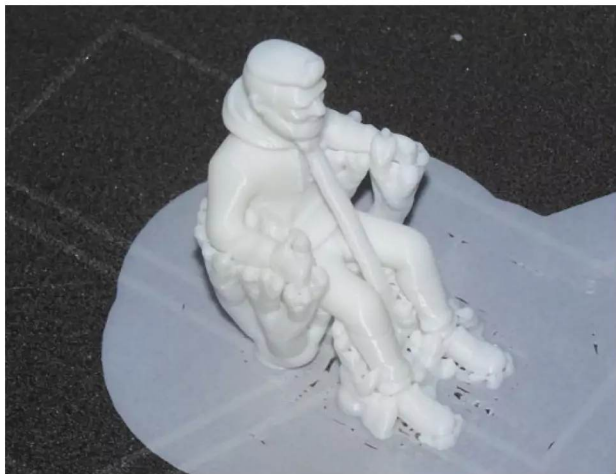
Die von Slicer hinzugefügten Stützen lassen die Figur beim Drucken zuerst merkwürdig aussehen
