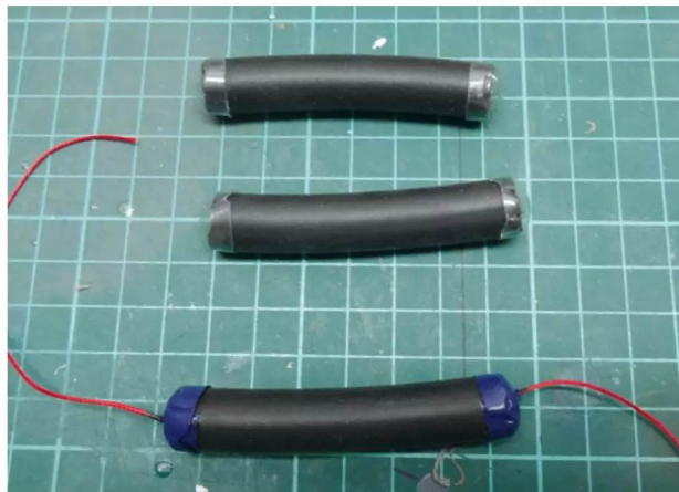
Die Fender entstanden aus Moosgummi-Rundschnur und ausgestanztem Tablettenblister
