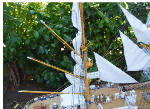
Alle 23 Segel sind ferngesteuert verstellbar, 17 davon können auch gerefft werden
