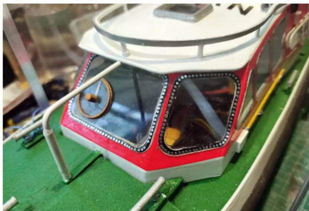
Die Fensterschrauben sind aus Vinylfolie ausgeschnitten und einzeln aufgeklebt
