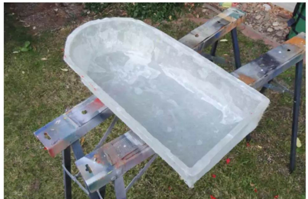
Auf der fertig verschliffenen Positivform konnte eine Negativform laminiert werden
