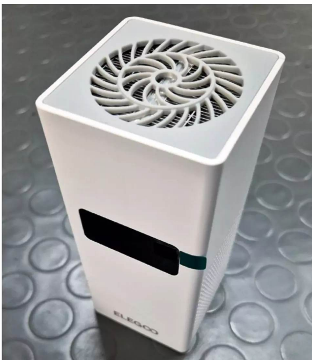
Elegoo Heater: Die Luft wird von unten durch den Filter angesaugt, im Heater erwärmt und durch den eingebauten Ventilator im Druckraum verteilt
