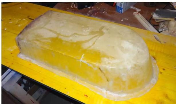
Zum ersten Mal habe ich einen Rumpf in einer Negativ-Form laminiert
