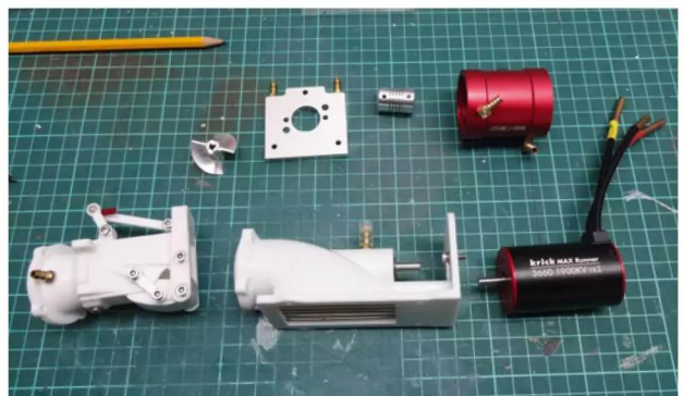
Das Antriebssset besteht aus einem Jet von MSQ und einem Brushless-Motor von Krick
