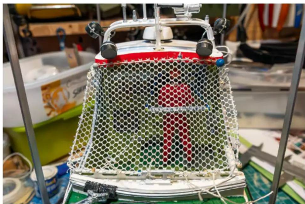
Das Schleppseilschutznetz kann bei Bedarf ausgerollt werden
