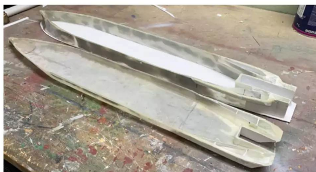
Der Rumpf ist horizontal geteilt in ein Über- und Unterwasserteil
