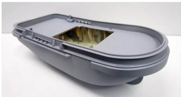
Im Bug- und Heckbereich der BUSSARD wird der Moosgummi verklemmt und eingeklebt
