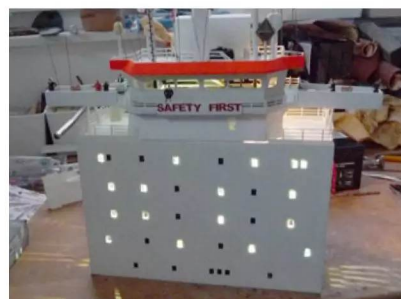
Dank der Pappschablonen strahlt nun nicht mehr der ganze Aufbau
