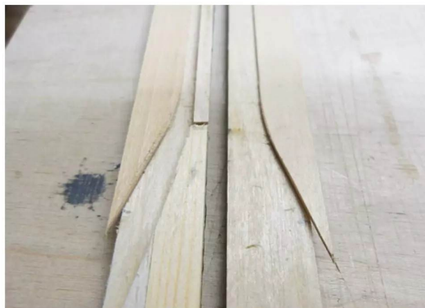
Danach werden die beiden Masthälften zusammengefügt
