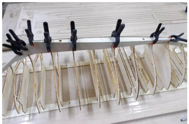
Am Kiel werden die ersten Planken gesetzt
