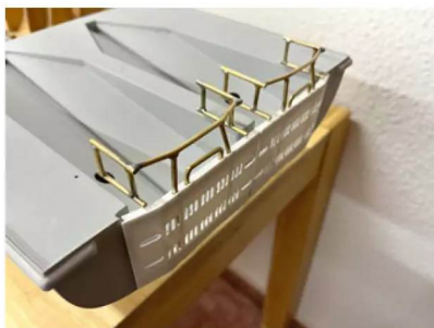
Die zahlreichen Öffnungen in der Heckklappe wurden per Hand gefräst
