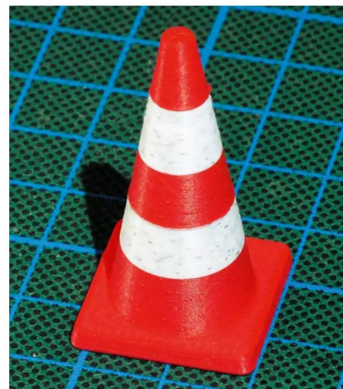
Durch die gekapselten Behälter sind auch mehrfarbige Drucke problemlos möglich
