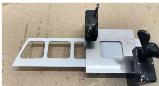
Die verschiedenen Fenster sind mit passenden Metallformen ausgefräst
