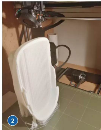
1) Beim liegenden Druck des Rumpfs wird viel Stützstruktur benötigt. 2) Durch die hohe Schichthöhe entstehen am stehend gedruckten Rumpf typische Stufenmuster. 3) Auch das liegend gedruckte Deck weist deutliche Stufen auf
