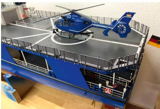
Der Hubschrauber auf dem Helideck kaschiert den Lautsprecher des Soundmoduls
