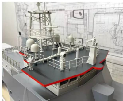
Das Dach des Ruderhauses ist mit zwei Löschkanonen bestückt, die ebenfalls funktionieren
