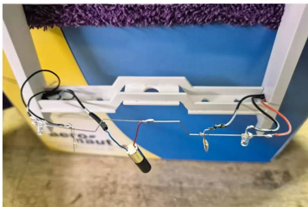
LEDs und Motor werden dann an den jeweiligen Minuspol angeschlossen
