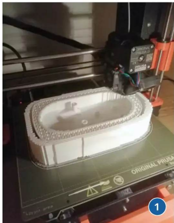
1) Beim liegenden Druck des Rumpfs wird viel Stützstruktur benötigt. 2) Durch die hohe Schichthöhe entstehen am stehend gedruckten Rumpf typische Stufenmuster. 3) Auch das liegend gedruckte Deck weist deutliche Stufen auf
