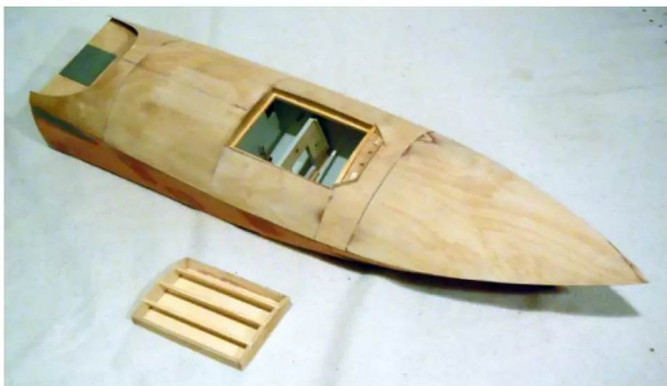
Der Decksbelag aus Sperrholzsegmenten und die Motorraumabdeckung sind neu
