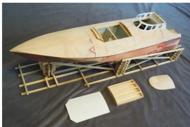
Das Boot ist im Rohbau fertig und kann nun grundiert werden
