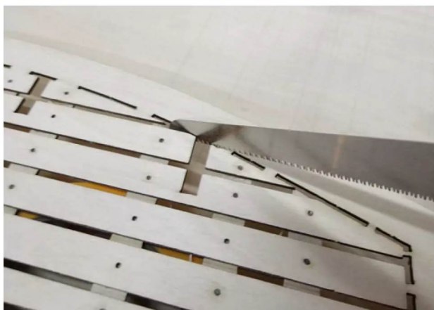
Die Bodenbretter werden auf einen Unterbau aufgeklebt und danach ausgesägt
