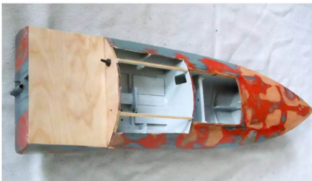
Neue Einkleidung der Oberflächen am Heck und seitliche Unterzüge für das neue Deck
