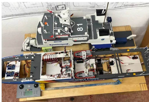
Durch die großen Decksöffnungen kommt man gut an die verschiedenen Einbauten
