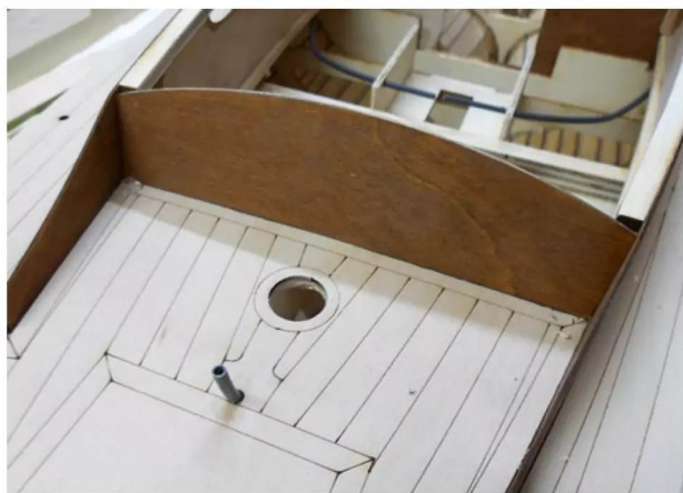
Der Einbau der Kajütvorderwand schließt die Arbeiten am Aufbau bereits ab
