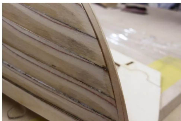
An Bug und Heck werden die Planken ineinander geschmiegt und mit einem Steven versehen
