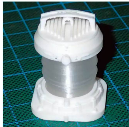
Mit transparentem Filament kann man Schiffsbeleuchtung in einem Stück drucken
