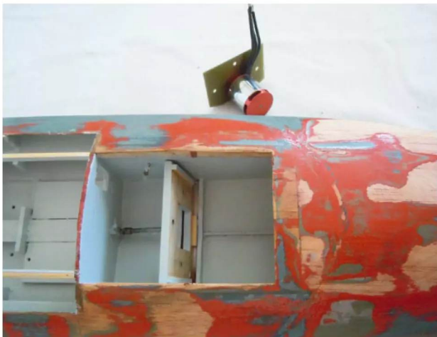
Der neue Motor mit Wechselträger sitzt auf einem Motorspant mit Positionsleisten
