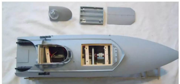
Die Zugangsöffnungen sind fertig zum wasserdichten Verschließen des Boots
