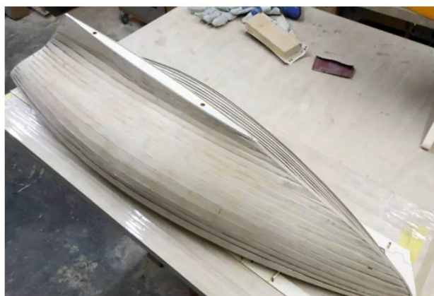
Die Beplankung ist ein Geduldsspiel, gelingt aber dank guter Vorfertigung wunderbar
