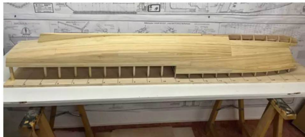
Der Rumpf wird in klassischer Spantbauweise über Kopf realisiert
