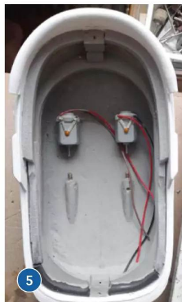
4) Mit teils rabiaten Mitteln wurde die Stützstruktur im Rumpf entfernt. 5) In den fertig gedruckten Rumpf werden die Motoren eingepasst und eingeklebt. 6) Auf der BRAGE wird zwischendurch mit einigen Details eine Stellprobe gemacht
