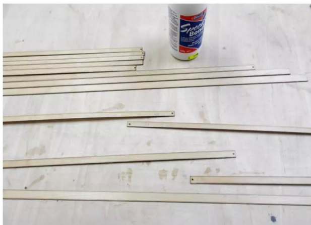
Der Mast besteht aus vielen Einzelteilen, die zu zwei Hälften verklebt werden
