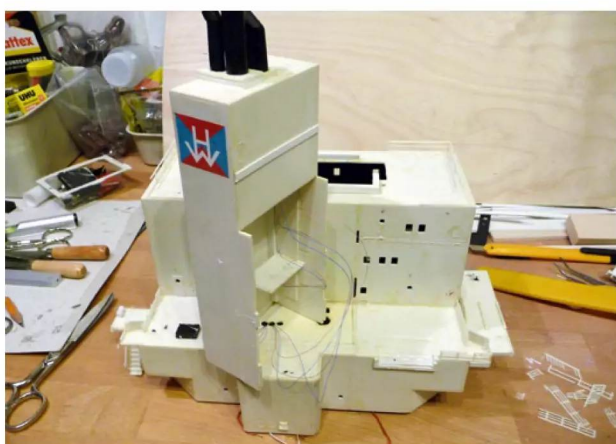
Der Schornstein wurde vorsichtig vom Aufbau getrennt
