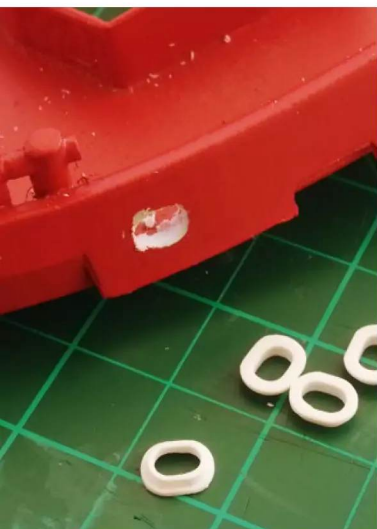
Die Trossenklüsen sind Frästeile aus der Restekiste
