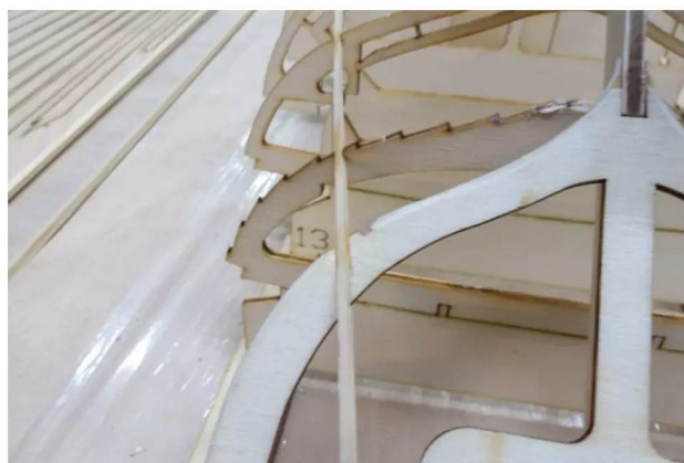
Die Stringer stabilisieren das Spantengerüst zusätzlich
