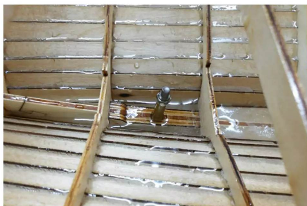
Die Kielbolzen sitzen bombenfest, nachdem sie mit Harz vergossen sind
