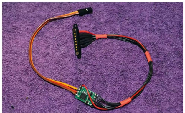
Das fertig verkabelte Schaltmodul mit dem Gegenstück des Magnetkontakts
