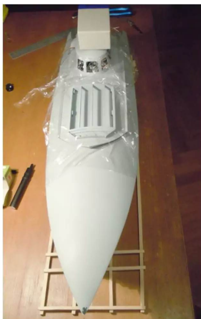
Mit Frischhaltefolie gesichert werden die Dichtungsfugen über Nacht eingepresst
