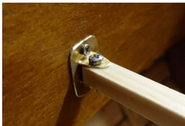
Nachdem die Teile zusammengelötet sind, werden sie an Ort und Stelle verschraubt
