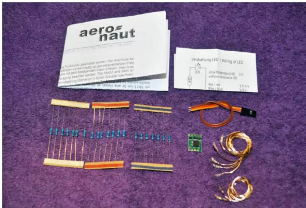
Das Set enthält das Schaltmodul, verschiedene Widerstände, Anschlusskabel und fünf LEDs
