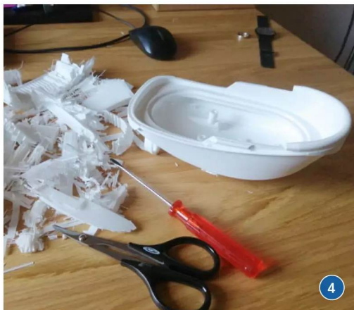
4) Mit teils rabiaten Mitteln wurde die Stützstruktur im Rumpf entfernt. 5) In den fertig gedruckten Rumpf werden die Motoren eingepasst und eingeklebt. 6) Auf der BRAGE wird zwischendurch mit einigen Details eine Stellprobe gemacht
