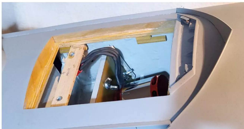
Die Haltevorrichtungen unter Deck für die Befestigungsbrettchen mit den Gewinden
