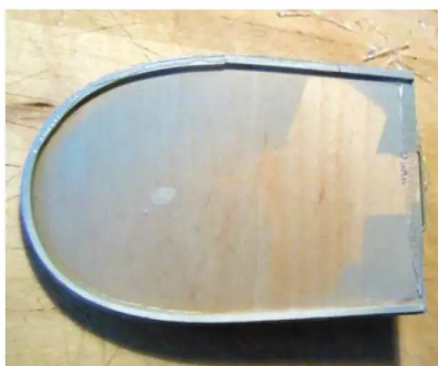
Am nächsten Morgen können die Überstände des Silikons abgeschnitten werden
