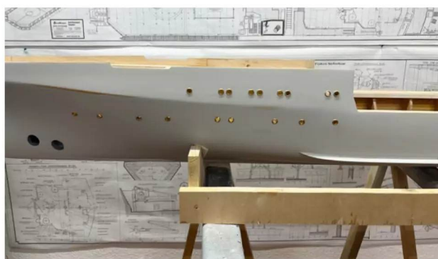
Nachdem die Löcher exakt gebohrt waren, wurden Messing-Bullaugen eingesetzt
