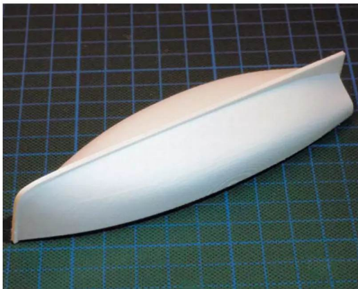
Rümpfe werden in zwei Hälften gedruckt, die man dann einfach zusammenklebt
