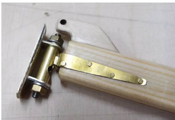
Die Befestigung des Großbaumbeschlags wird aus sechs Messingteilen verlötet
