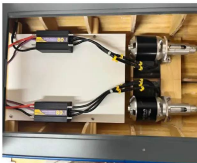
Angetrieben wird die POTSDAM von zwei actro-Motoren
