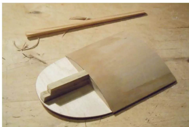
Zwei gehobelte Leisten sorgen für die Biegung des Kabinendachs
