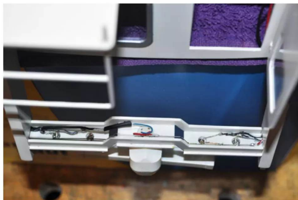
So lassen sich LEDs und das Radar ordentlich am Mast verbauen
