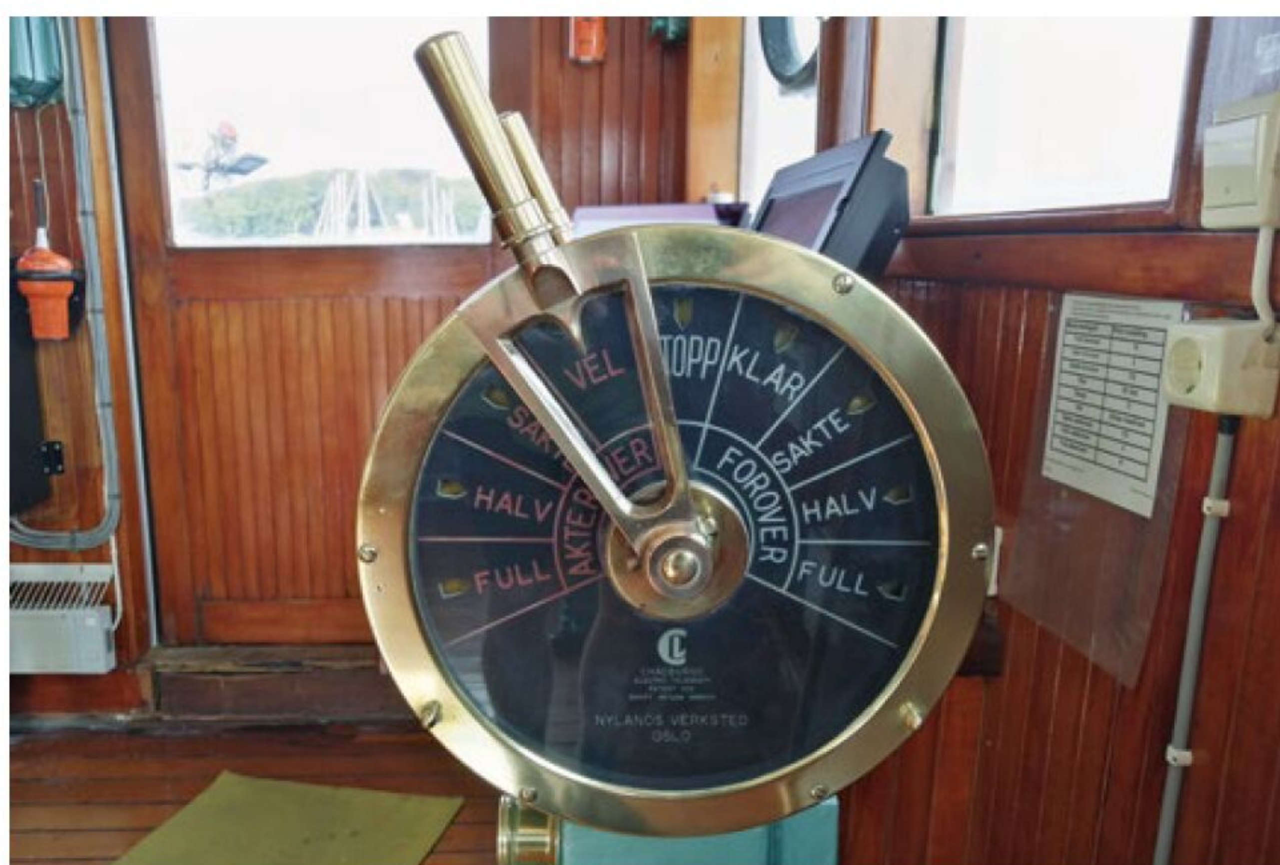
Der alte Maschinentelegraf übermittelt die Befehle der Brücke in den Maschinenraum
