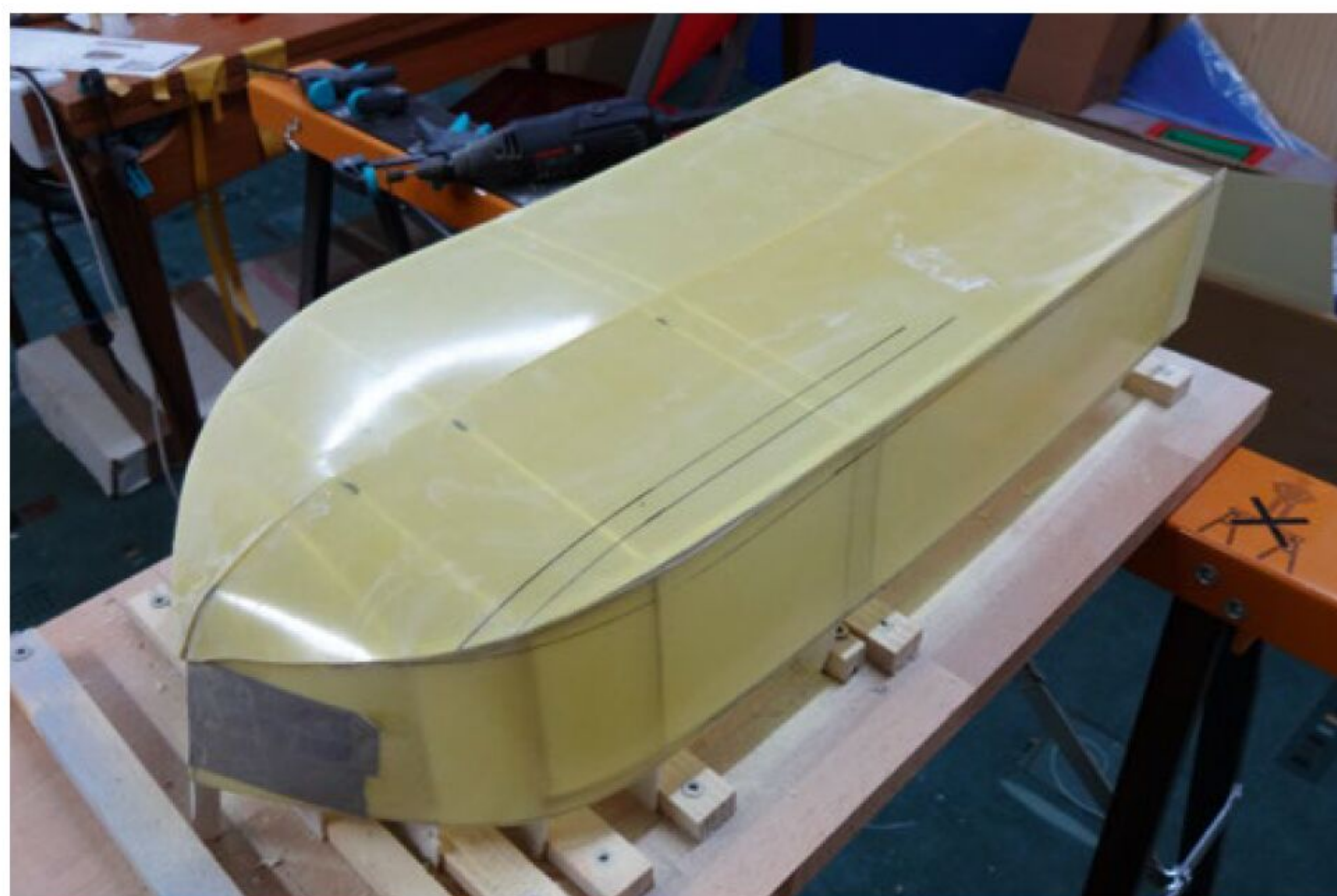
Auch für den Rumpfboden habe ich zwei GFK-Platten verwendet
