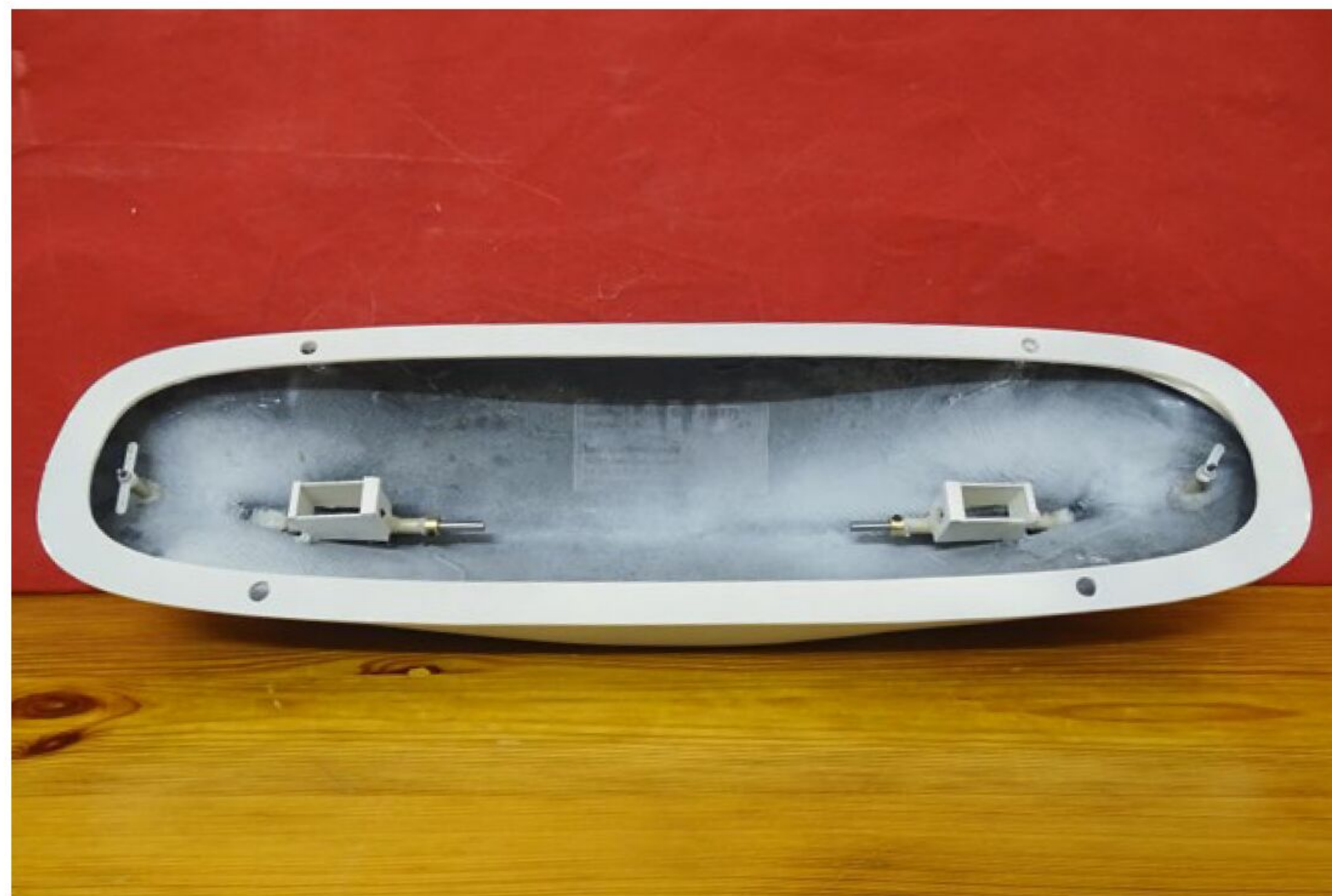
Das Profil aus Polystyrol sorgt für die Dichtung zwischen Aufbau und Rumpf
