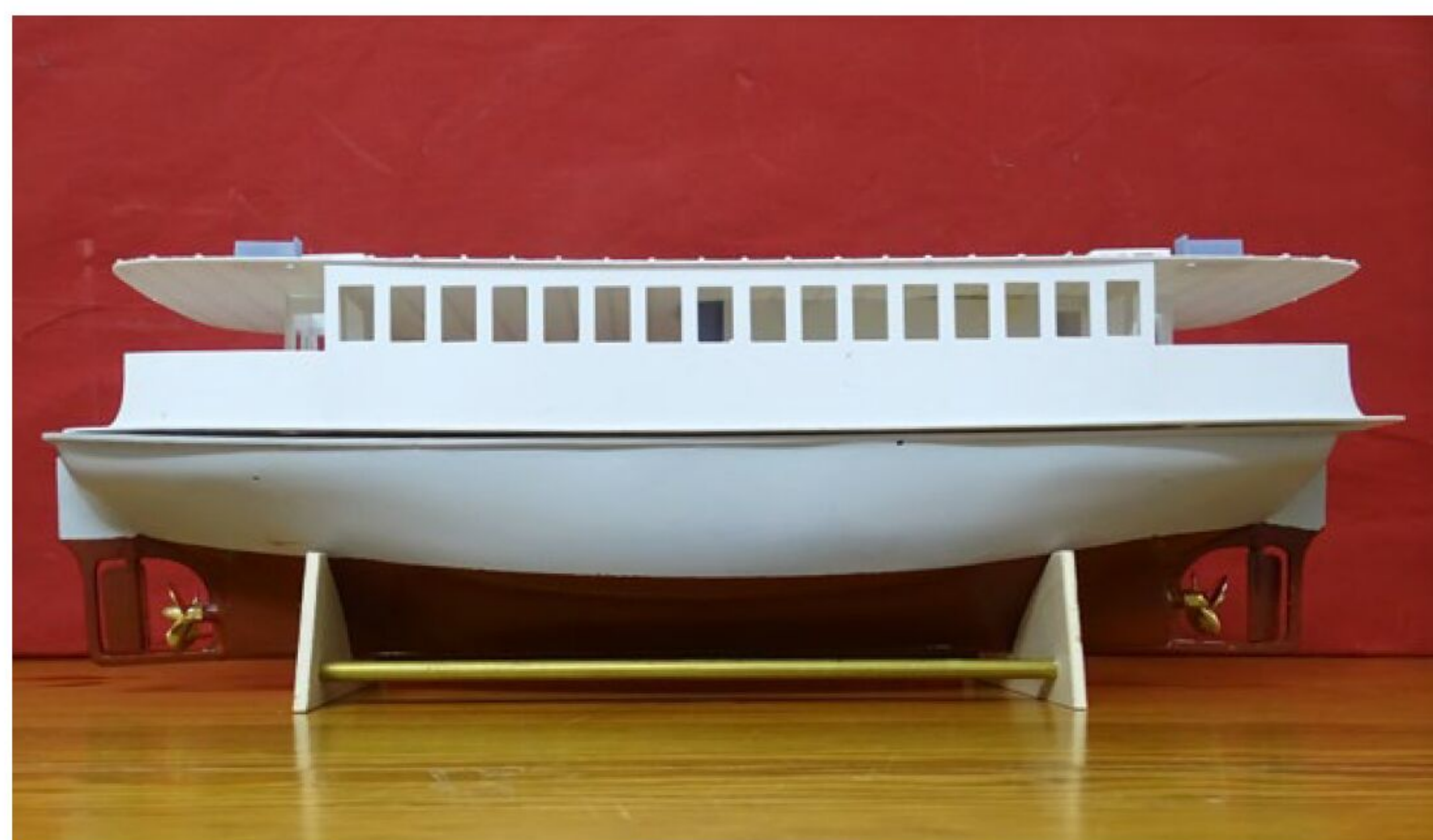
Durch die Aufbauten erhält man die exakte Wölbung für die Dichtung
