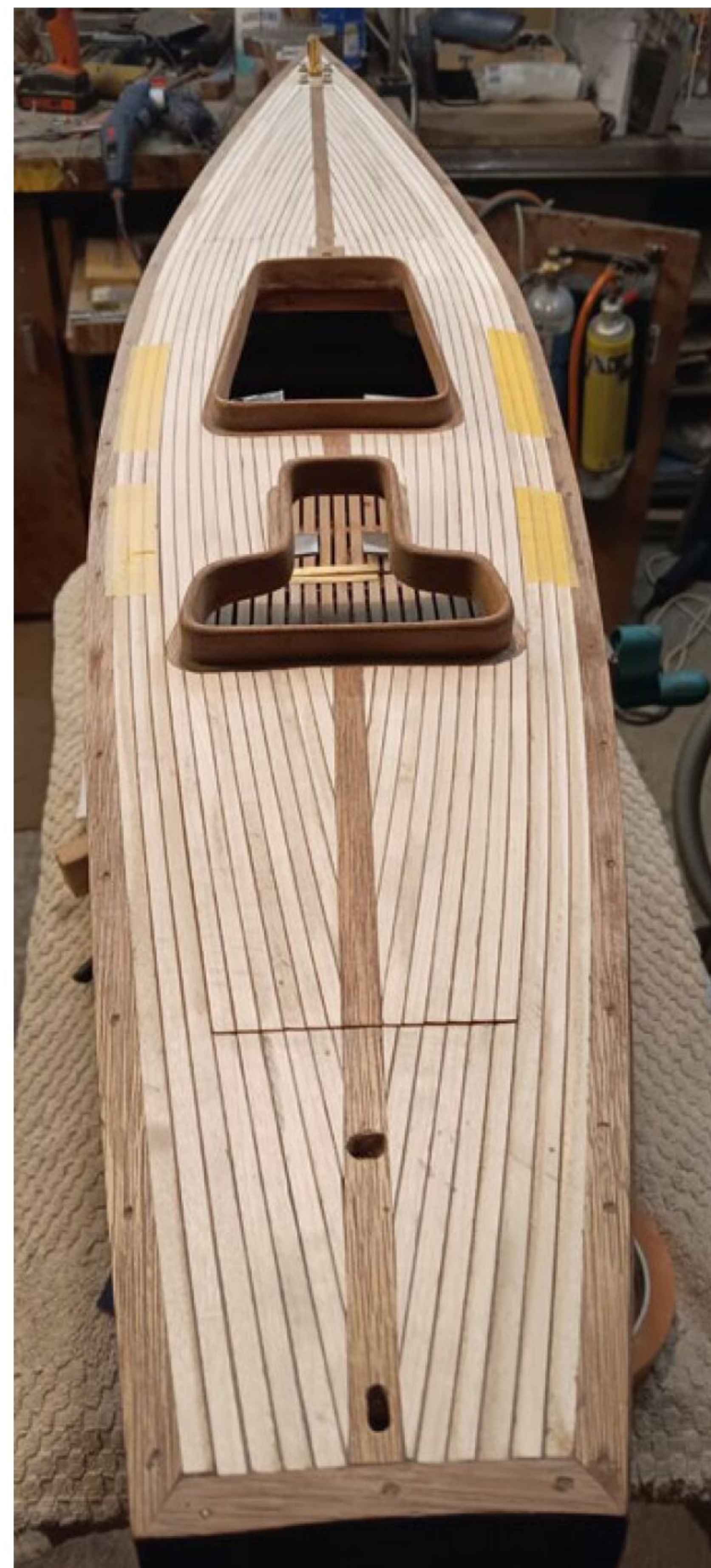
Das Deck im Rohbau mit den beiden Cockpits und dem großen Decksausschnitt
