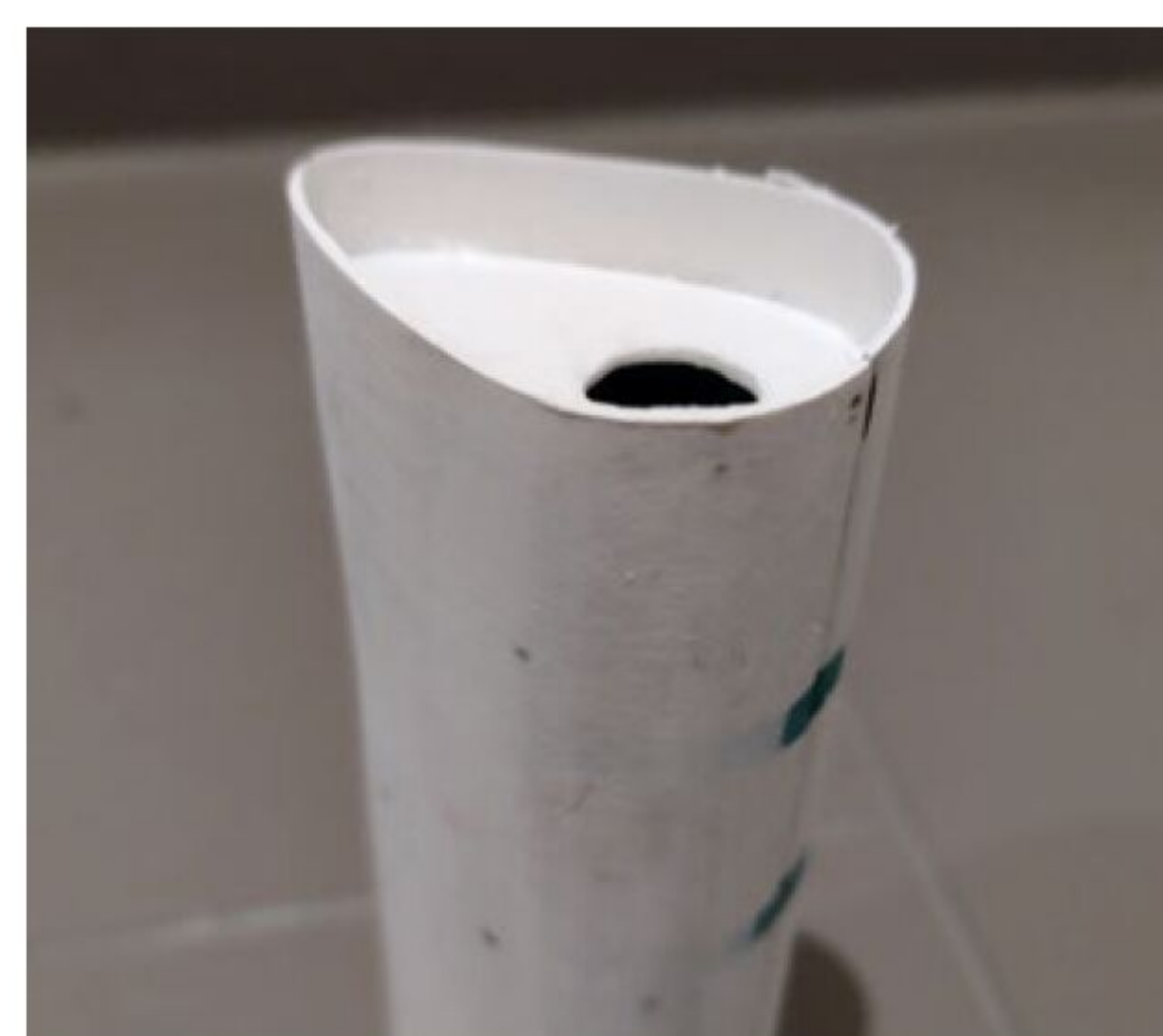
Als oberer Abschluss wurde eine Platte mit einer Bohrung für das Dampfrohr eingeklebt
