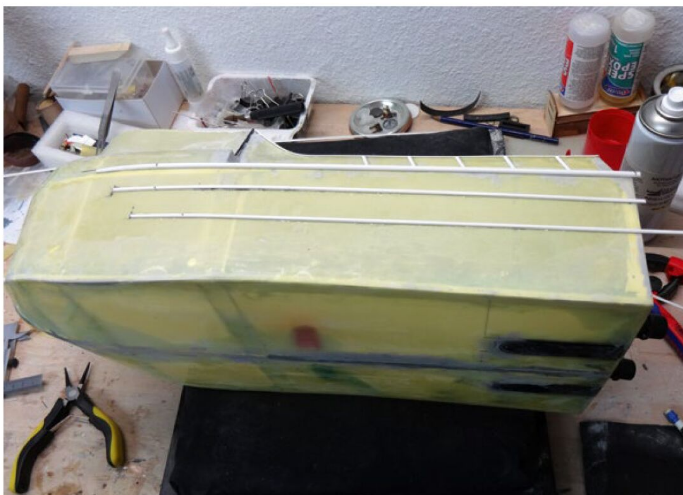
Mit Halbrundprofilen werden die Scheuerleisten auf der Bordwand angebracht
