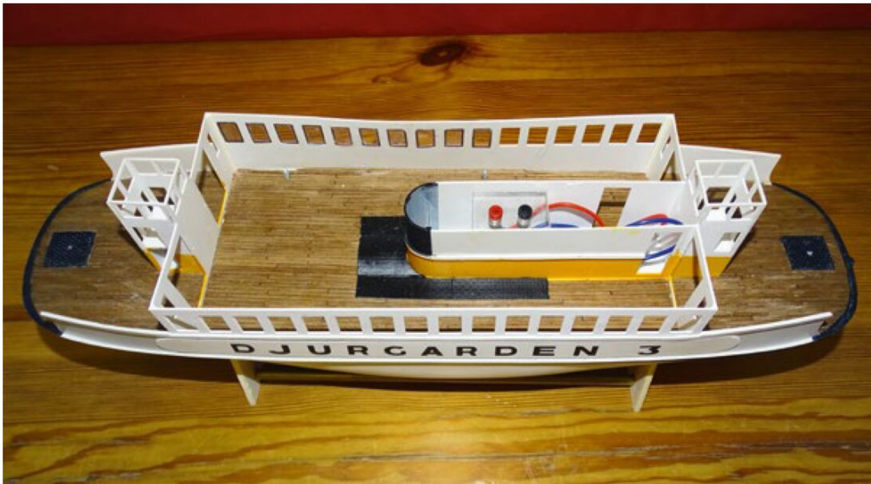
In den Maschinenschacht wurden Schalter und Ladebuchsen eingebaut
