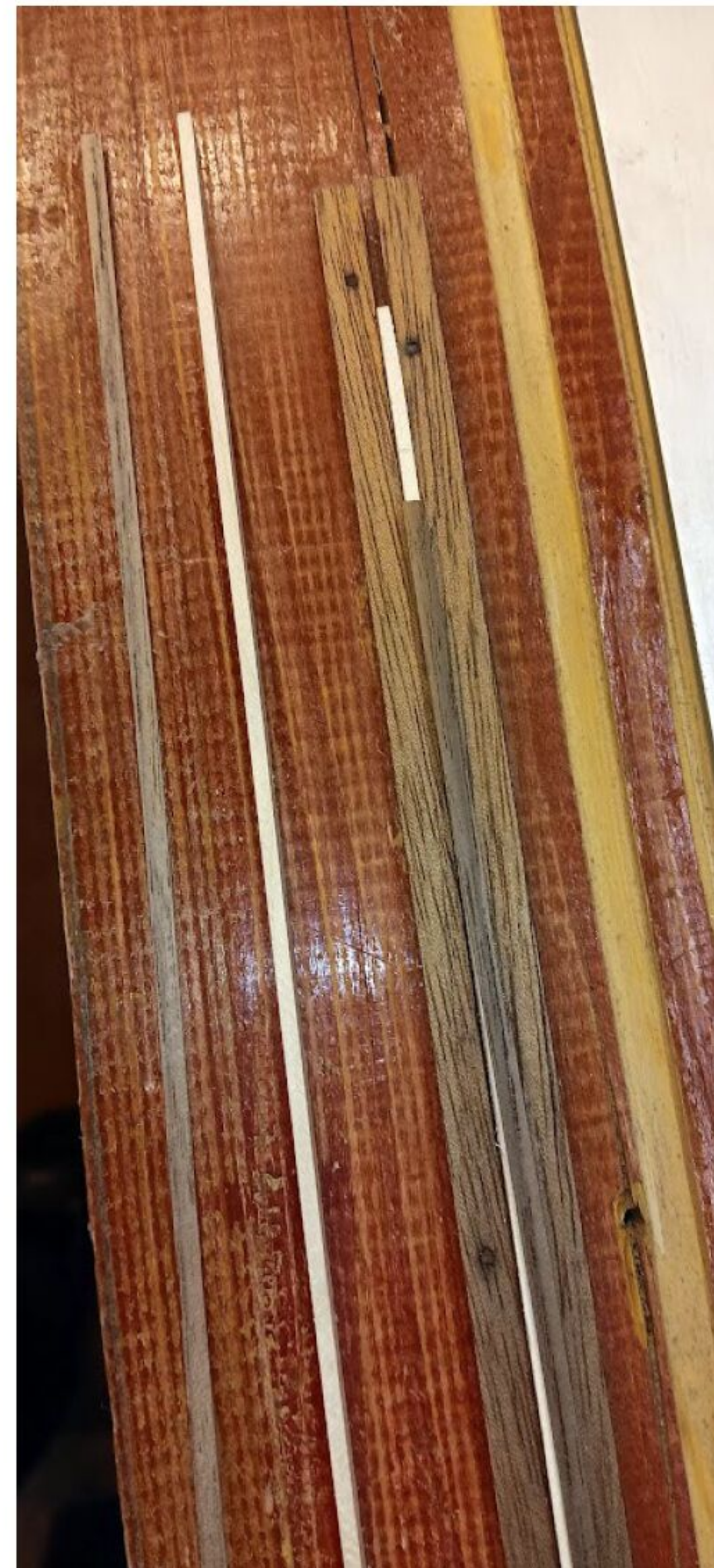
Vor dem Verlegen wurde je eine Planke mit der Kalfaterung verklebt
