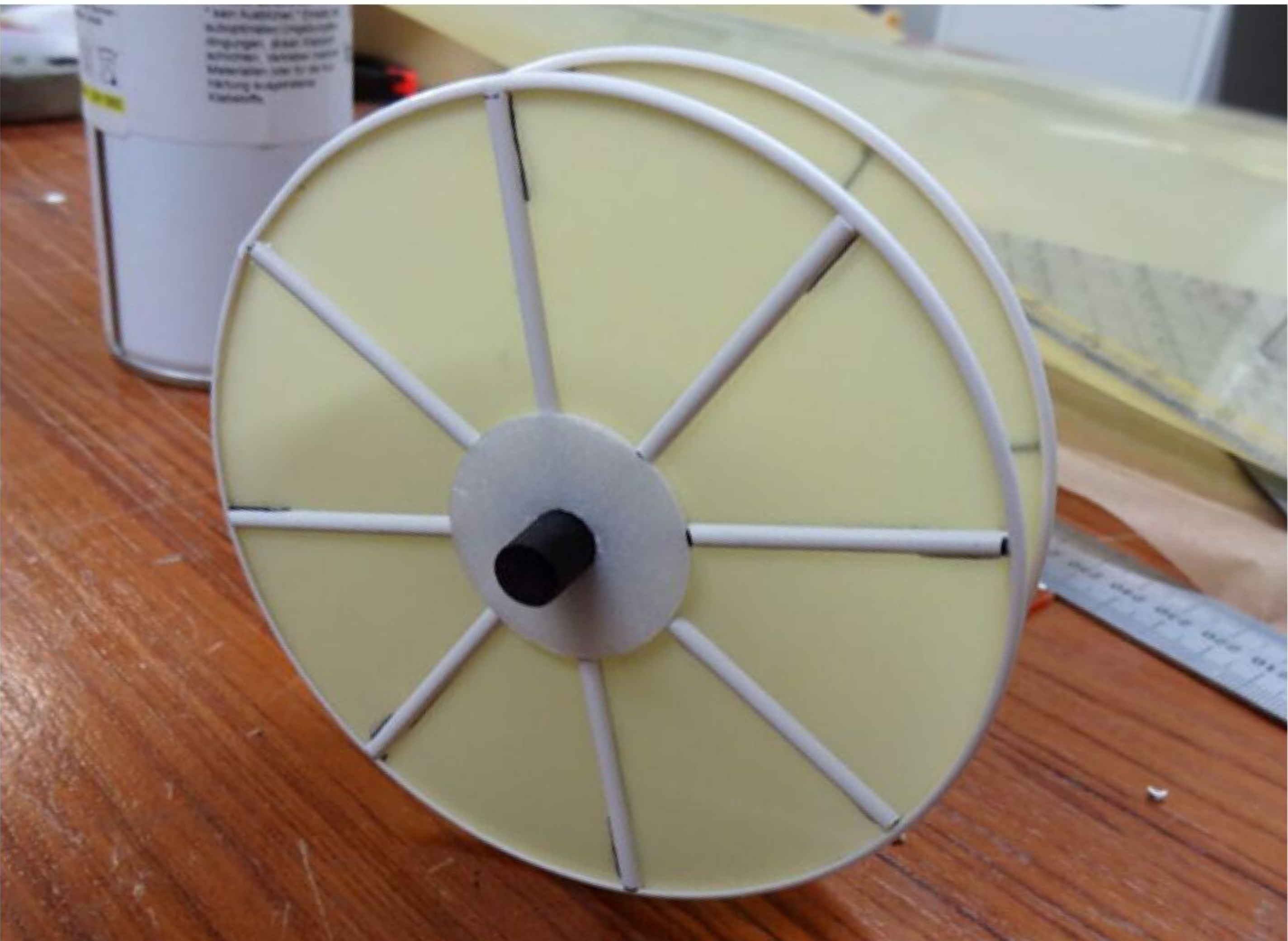
Die Netztrommel entsteht aus GFK und Halbrundprofilen
