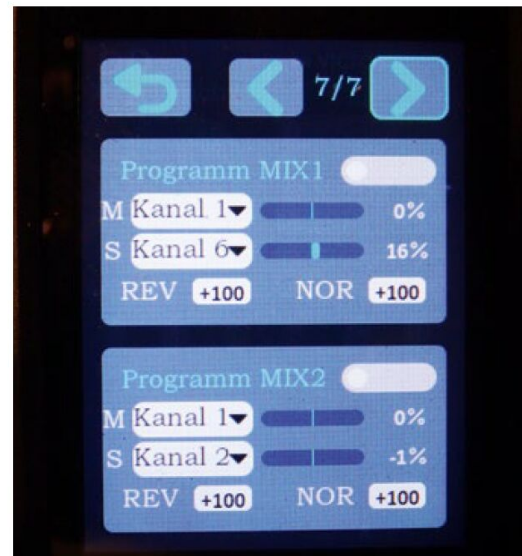
Mit den beiden freien Mixern kann man jeweils zwei Funktionen kombinieren
