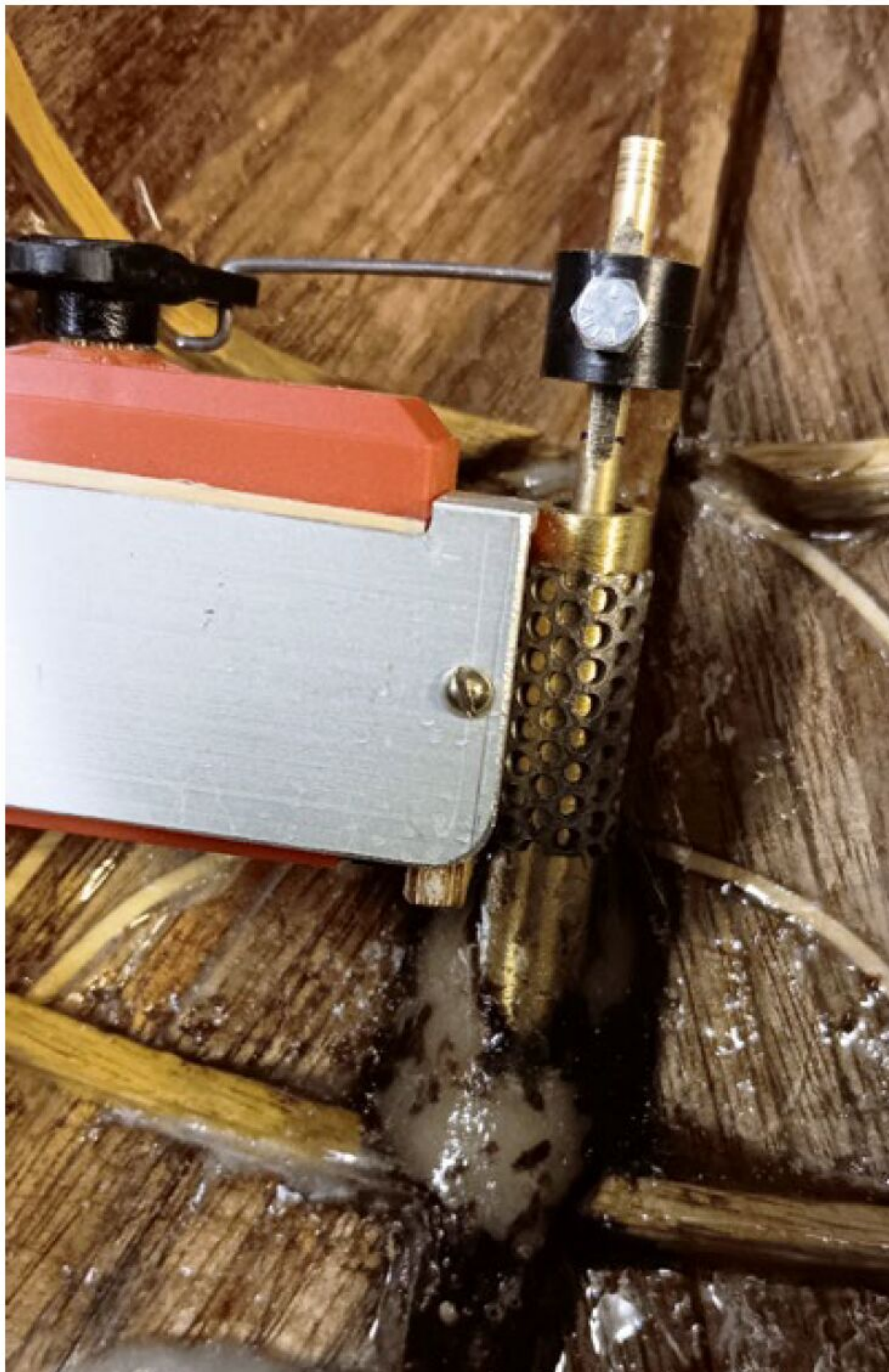
Das Ruderservo ist mit einem Lochblech am Ruderkoer angeklemt
