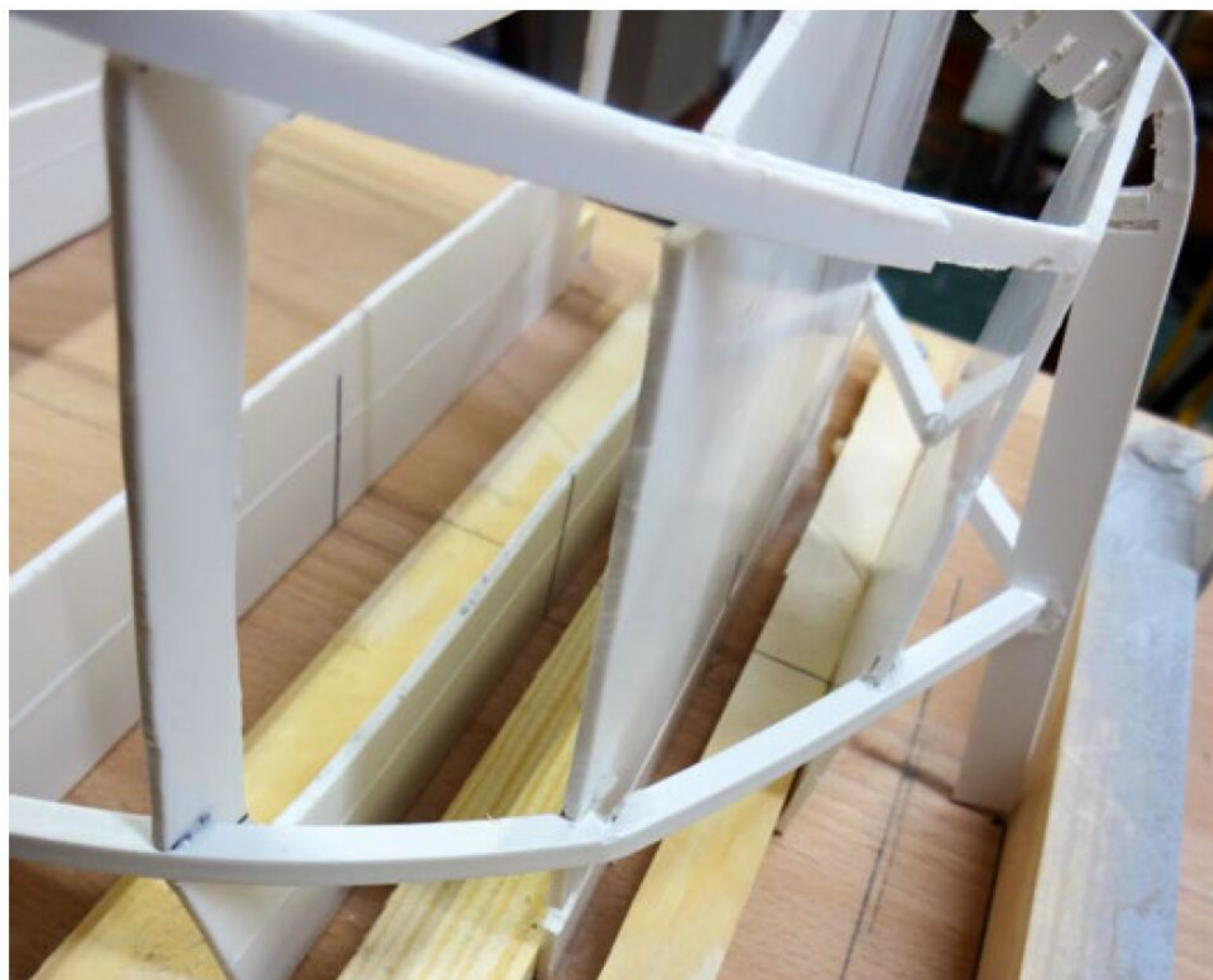
Die Stringer waren für die Biegung am Bug zu dick und mussten geteilt werden
