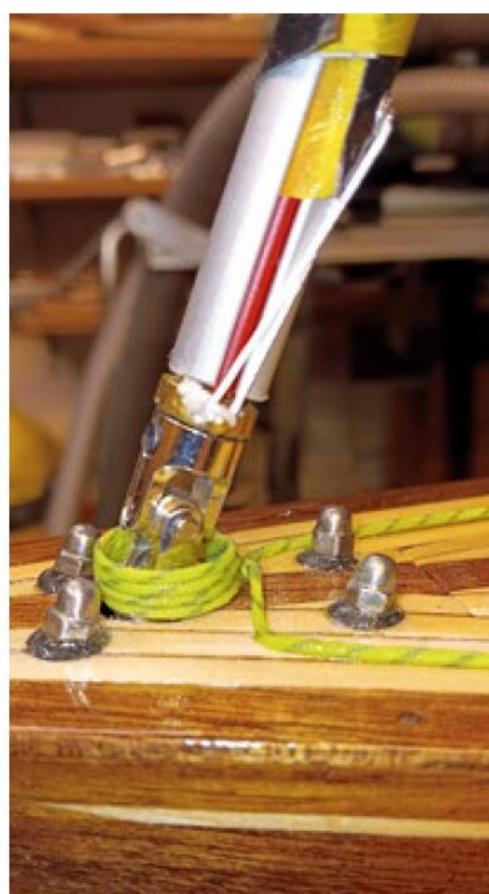
Der Fockmast ist mit einem Kardangeln beweglich auf Deck befestigt
