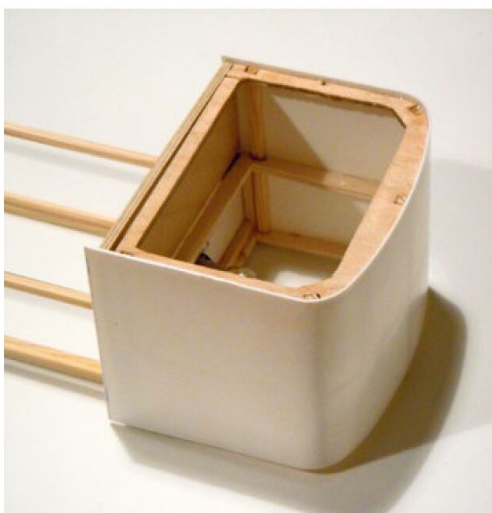
Gut zu erkennen, wie die Polystyrol-Platte um die Aufbauten herumgelegt wurde
