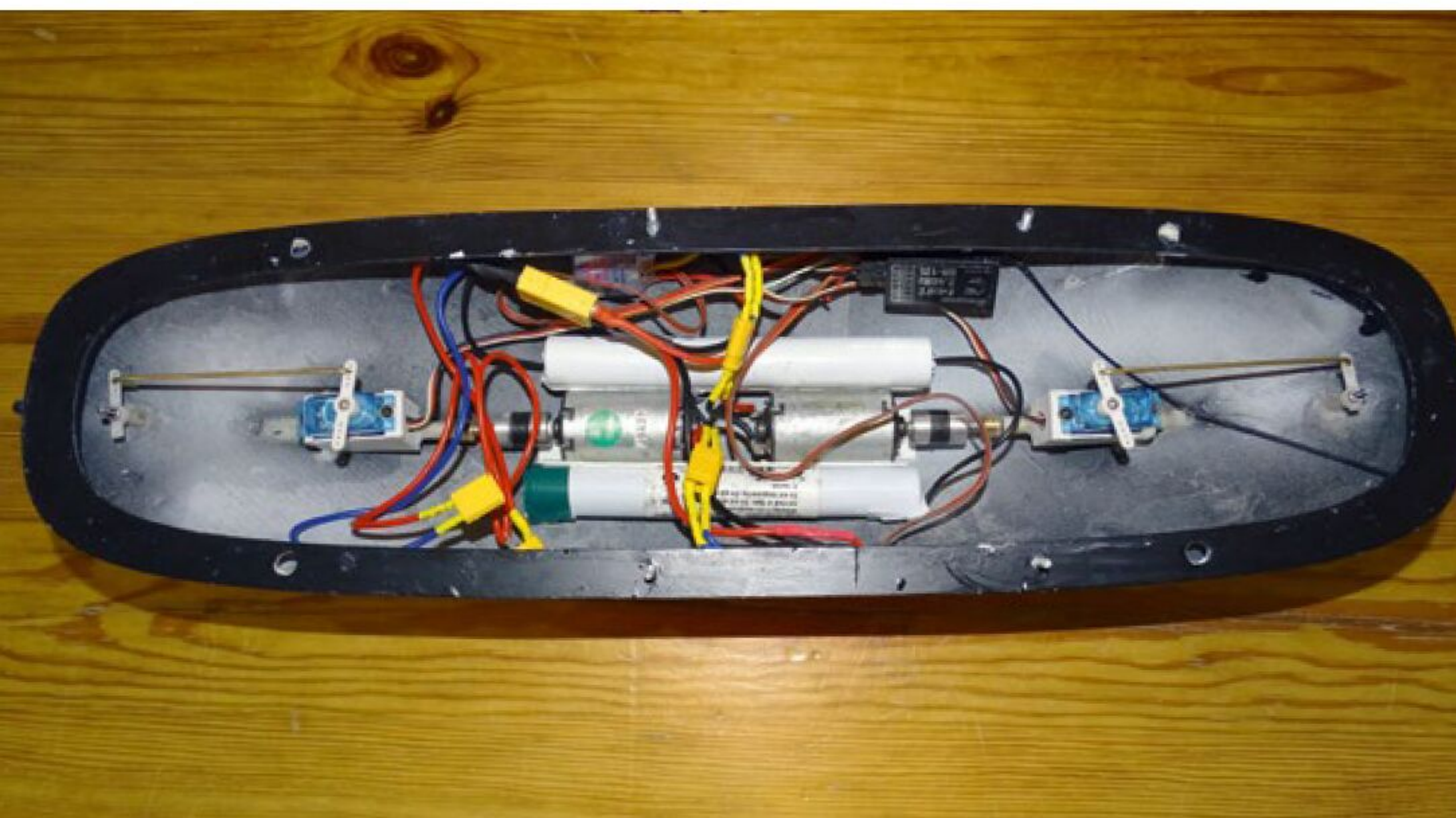
Ich habe mich für eine Verbindung zum Aufbau durch vier Gewindestangen entschieden
