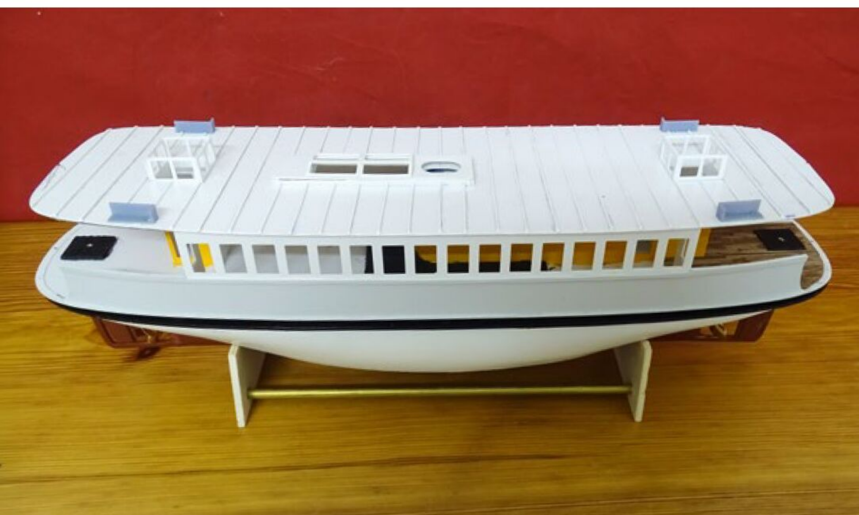
Zwischendurch wurde das Dach mit Leisten beklebt
