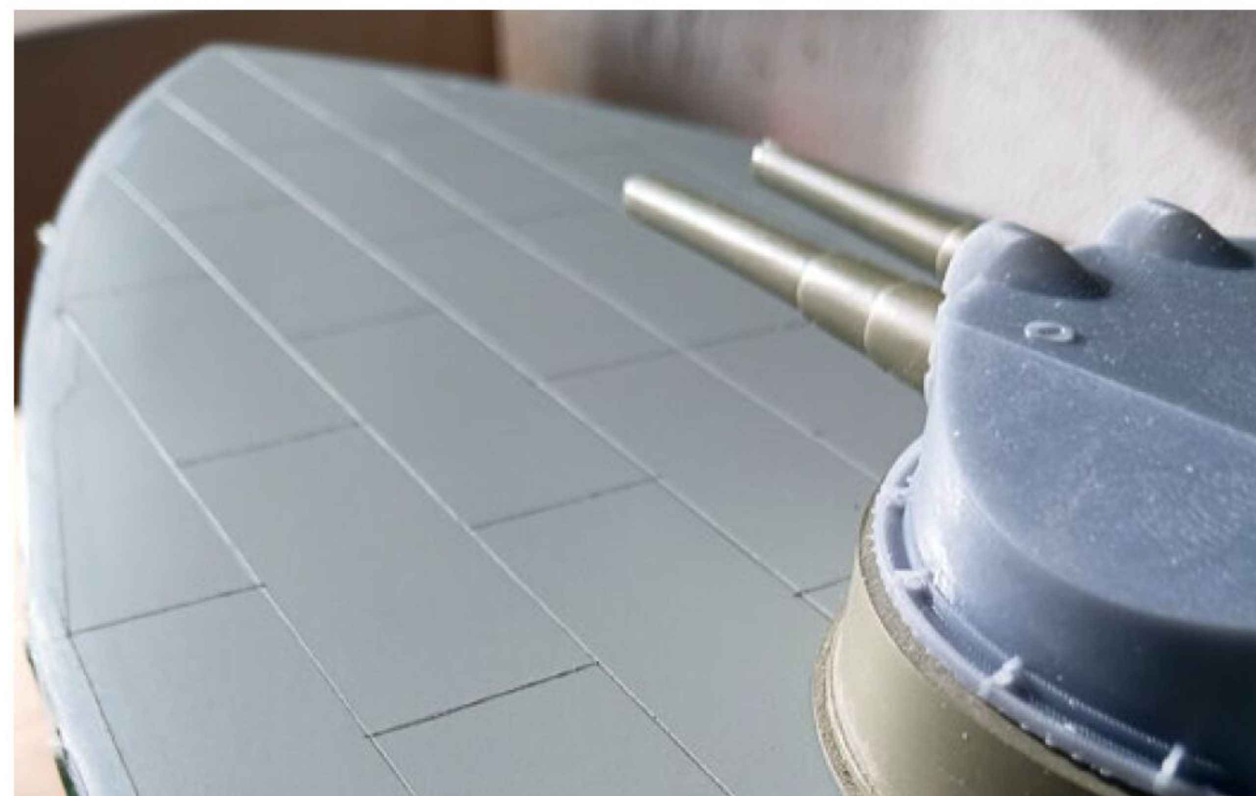
Auf das Back- und Achterdeck wurde Asbestzement aufgetragen und mit hellgrauem Linoleum belegt
