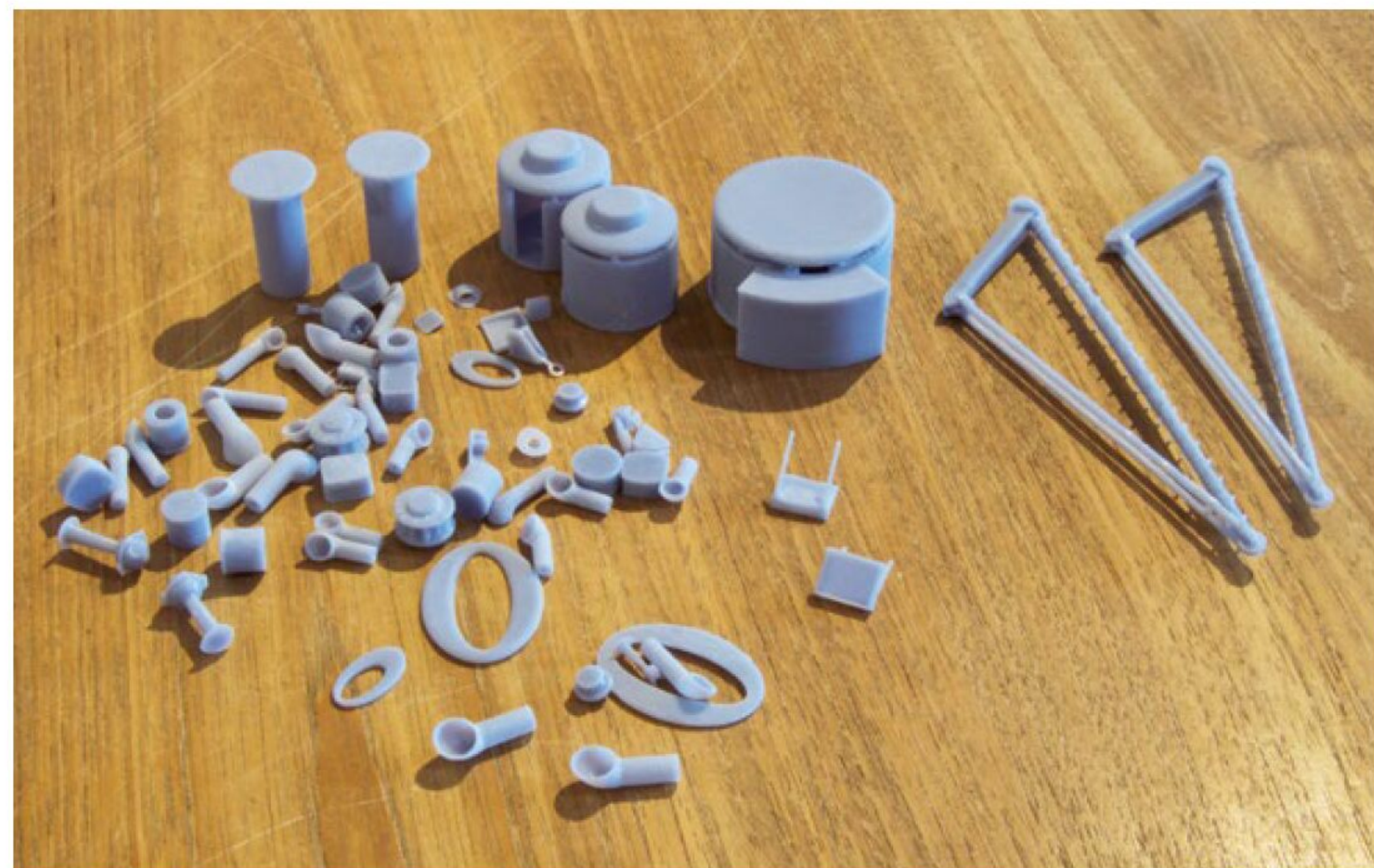
Mit dem 3D-Drucker konnten auch viele andere Beschlagteile hergestellt werden
