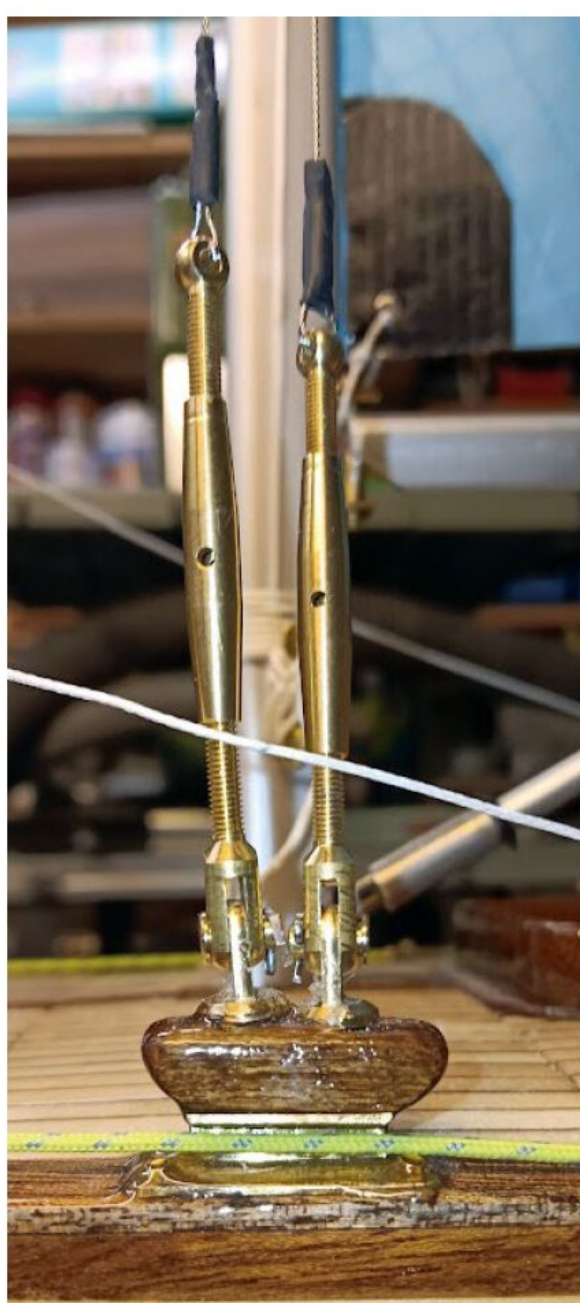
Die Konstruktion der Befestigung der Wantenspanner dient ebenso der Schotführung
