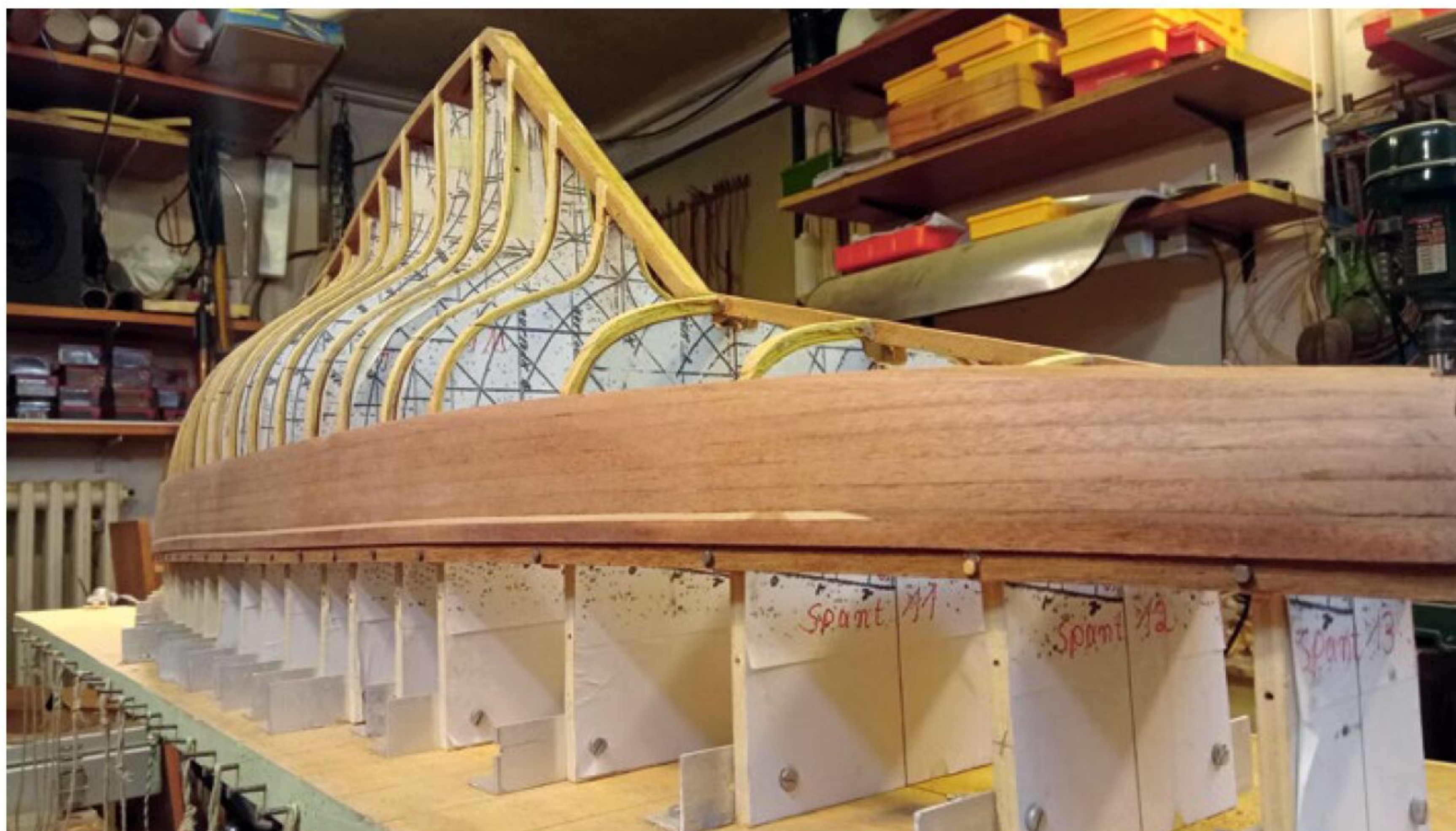
Steuerbord-Ansicht mit den ersten Rumpflanken und eingesetzter Zierleiste
