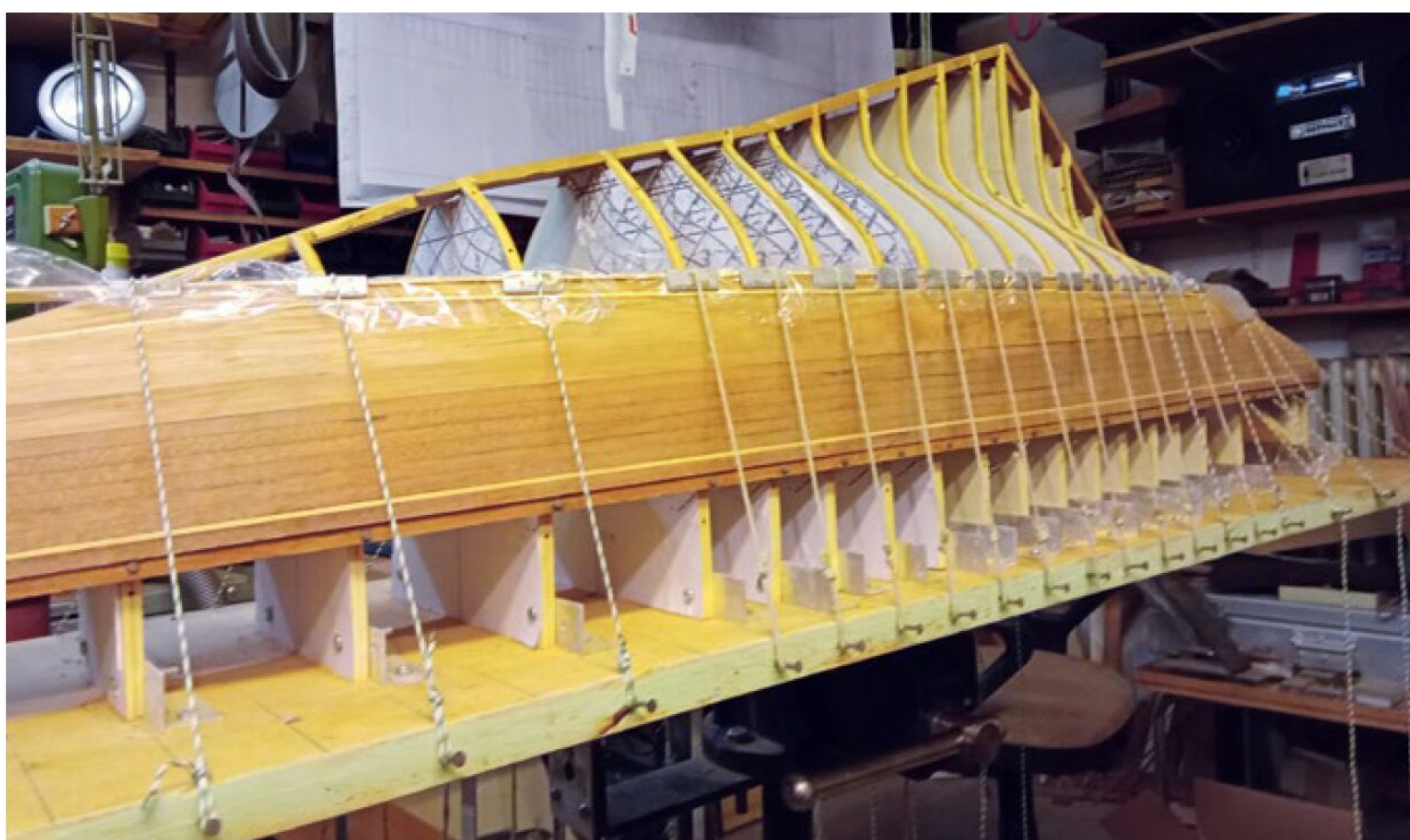
Spannschnüre und Aluwinkel halten die neu verleimten Planken
