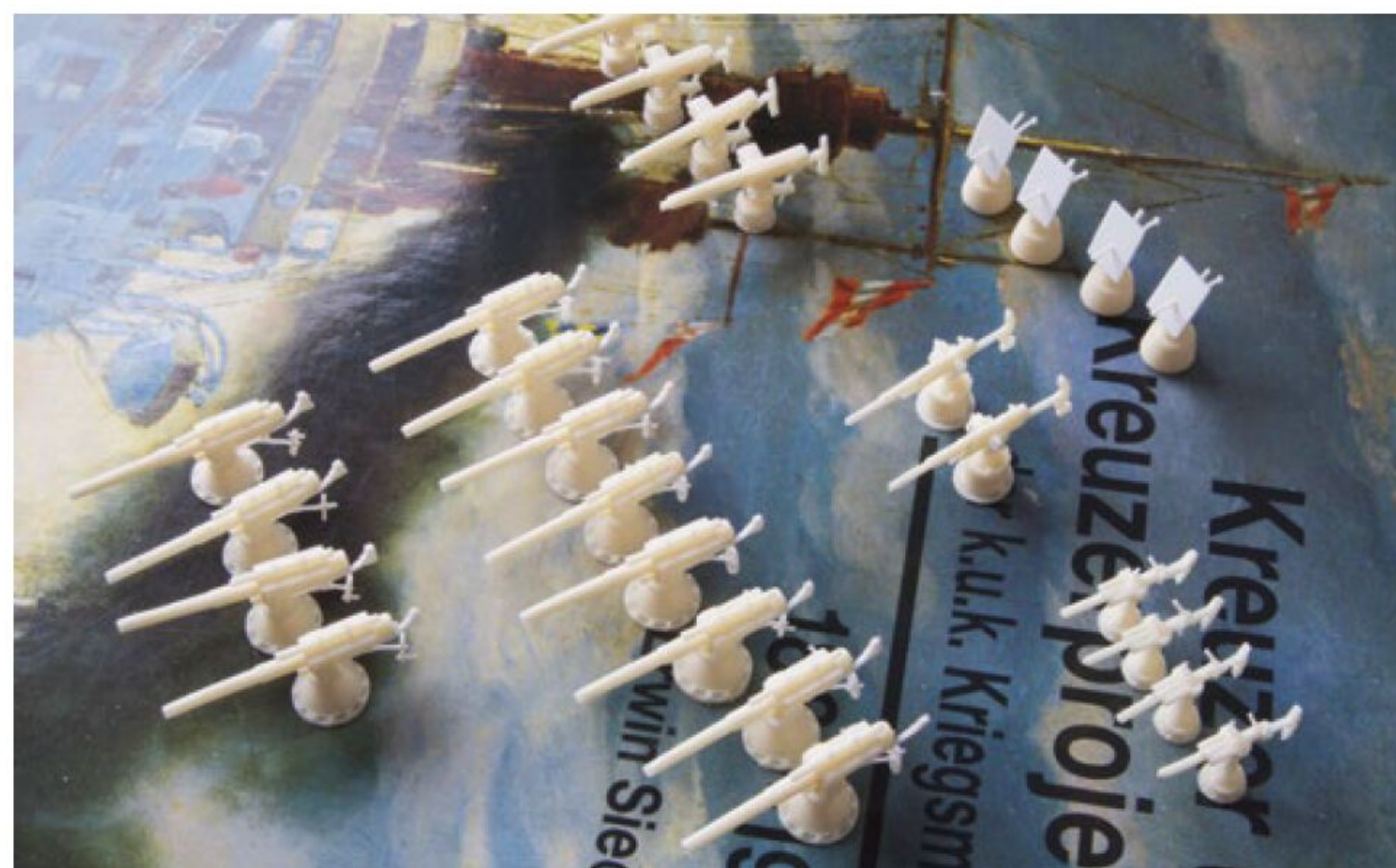
Für die kleinen Kaliber wurden Urmodelle aus Messing erstellt und mit Silikon abgeformt
