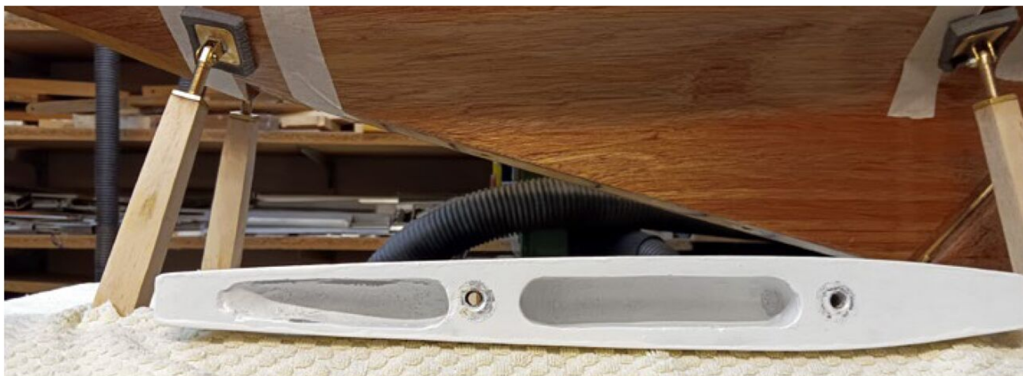
Dank eines Rechenfehlers musste der Kiel nachträglich erleichtert werden
