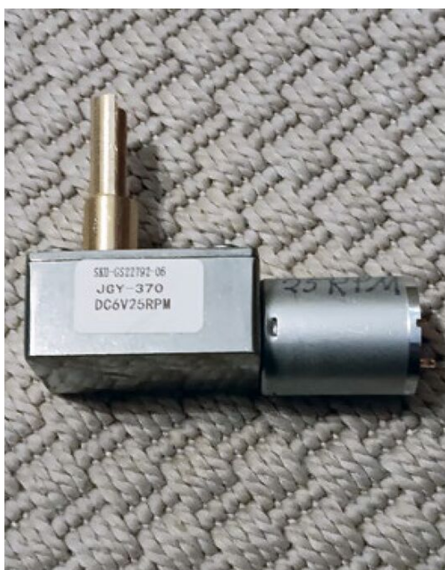
Der Elektromotor für die Rollfock mit angeflanschem L-Getriebe
