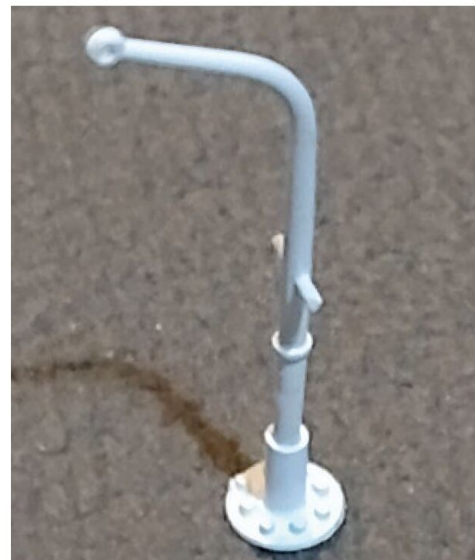
Die Davits für die Beiboote wurden mit einer neuen Decksaufnahme versehen
