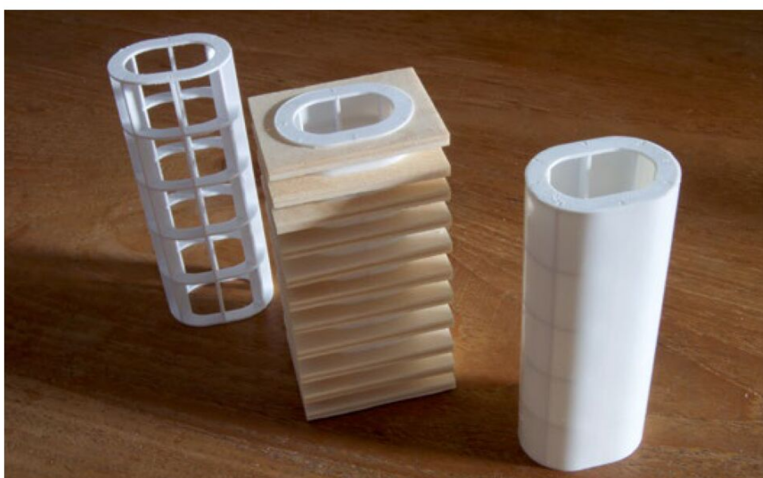
Auch für den Schornsteinbau konnte eine Holzschablone verwendet werden
