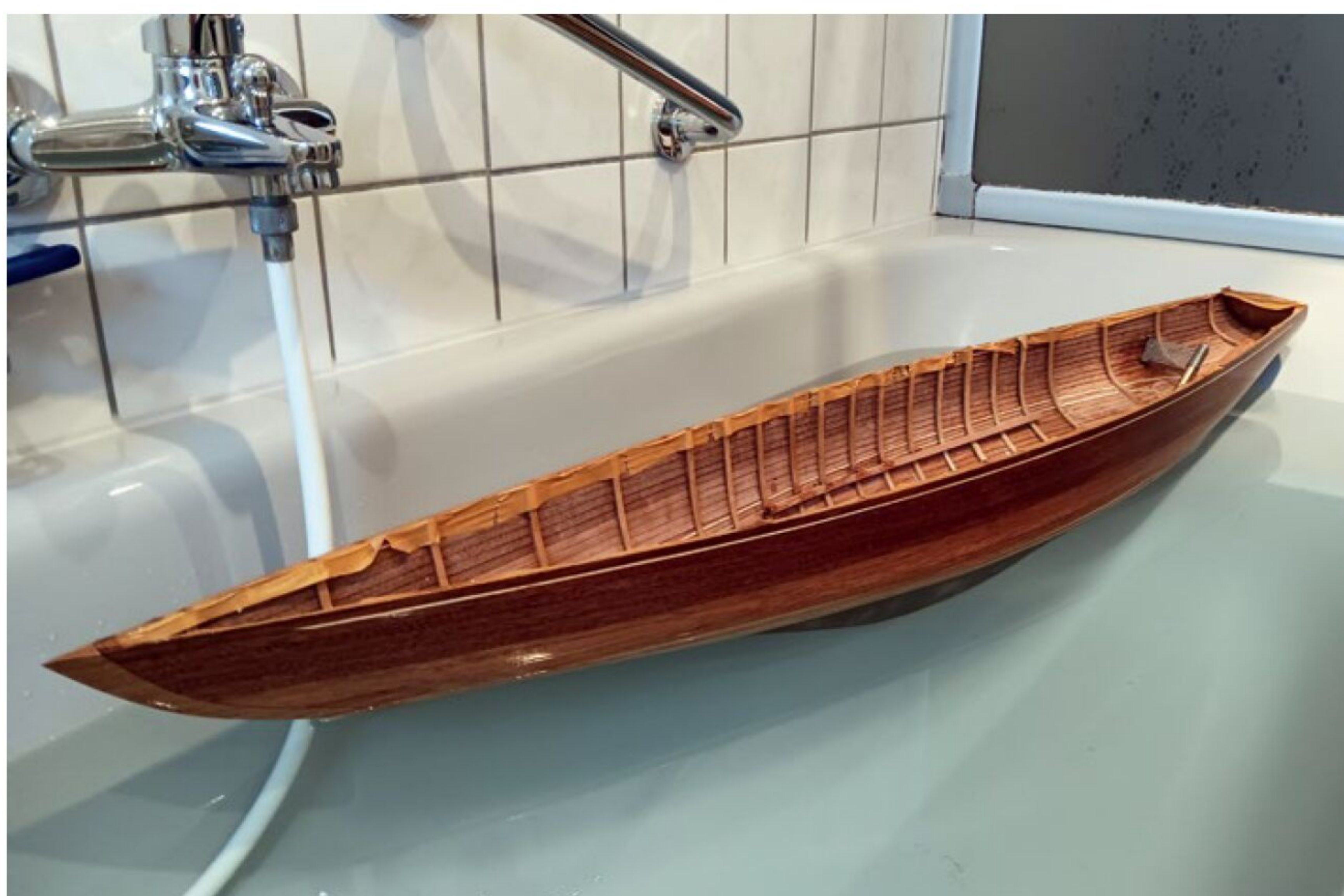
Nachdem der Rumpf lackiert ist, kann das Gewicht des Bleikiels bestimmt werden
