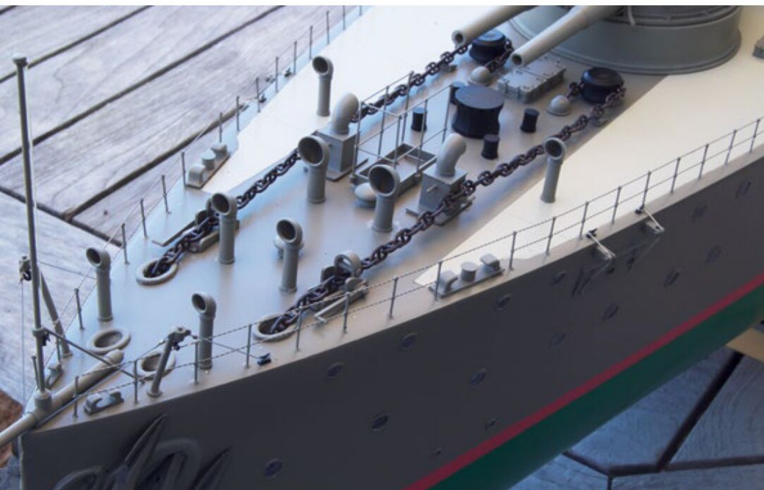
Der 3D-Druck bot die Möglichkeit, alle Lüfter problemlos maßstäblich herzustellen
