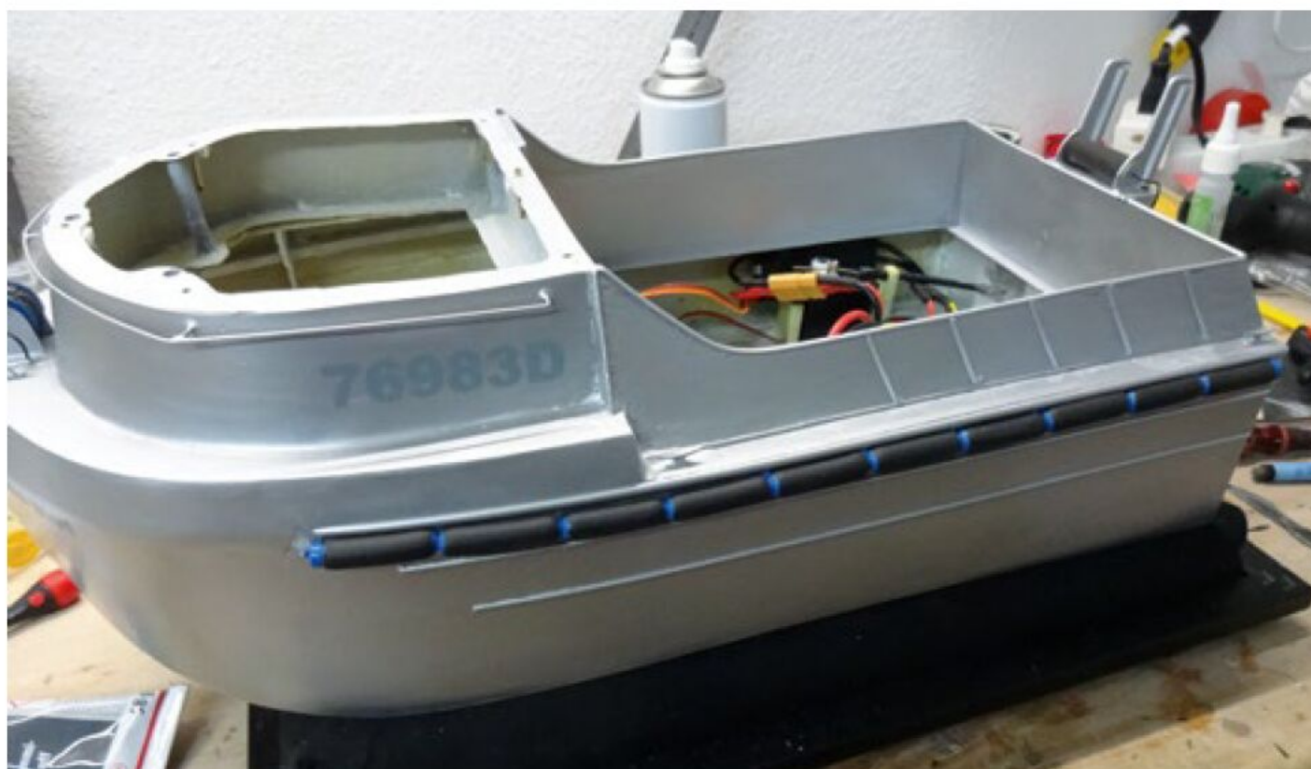
Danach können die Bootsnummer, der Name und die Fender angebracht werden
