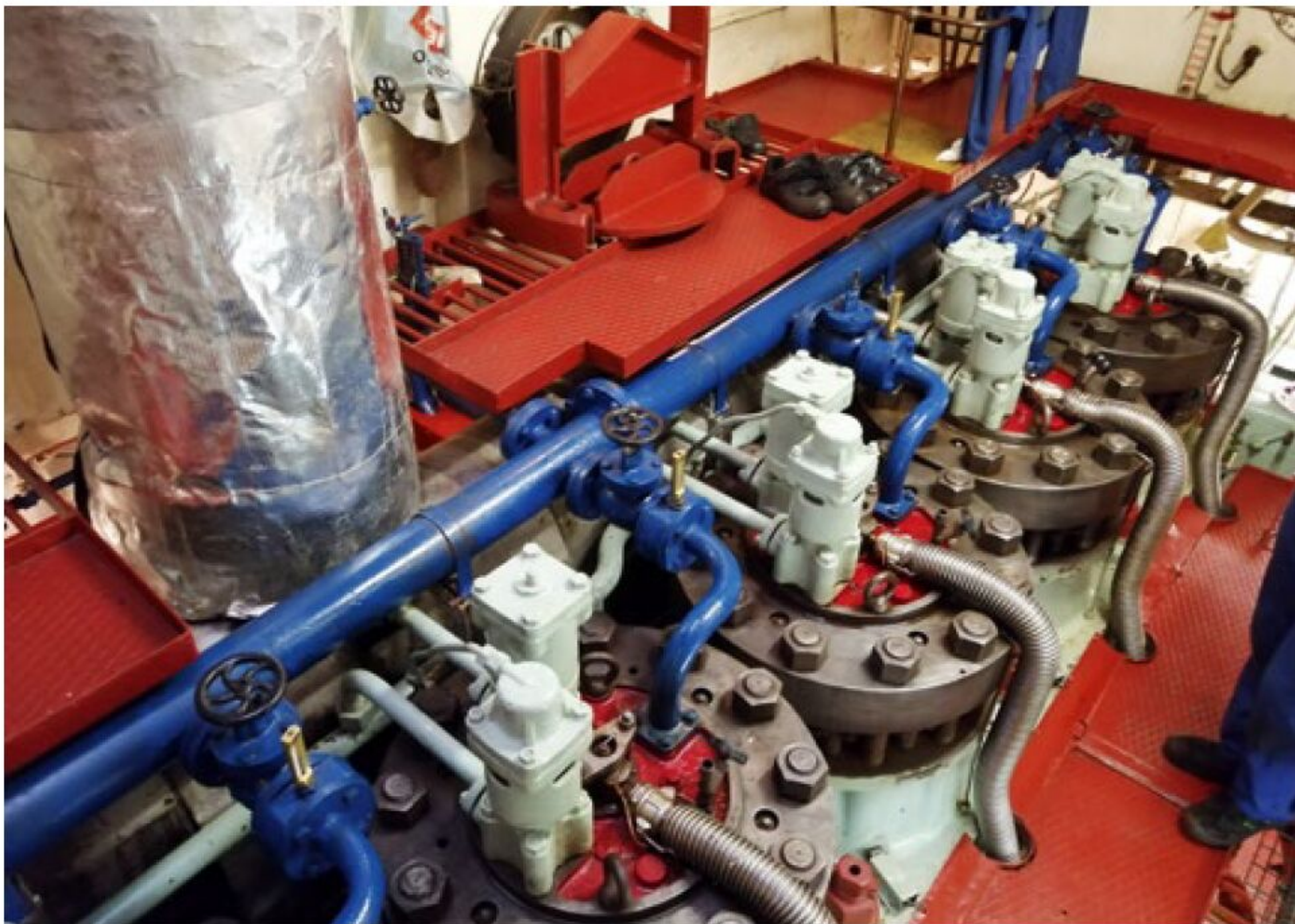
Nach wie vor arbeitet hier ein Atlas Polar Sechszylinder-Zweitakt-Dieselmotor
