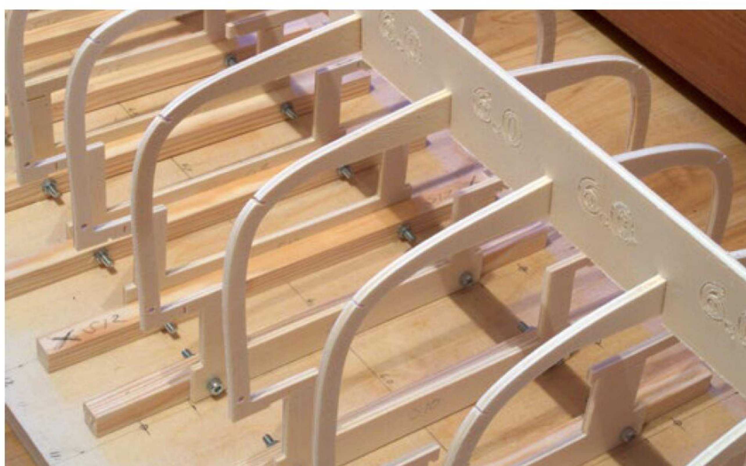
Der Rumpf ist klassisch kieloben mit angeschraubten Holzspanten gebaut
