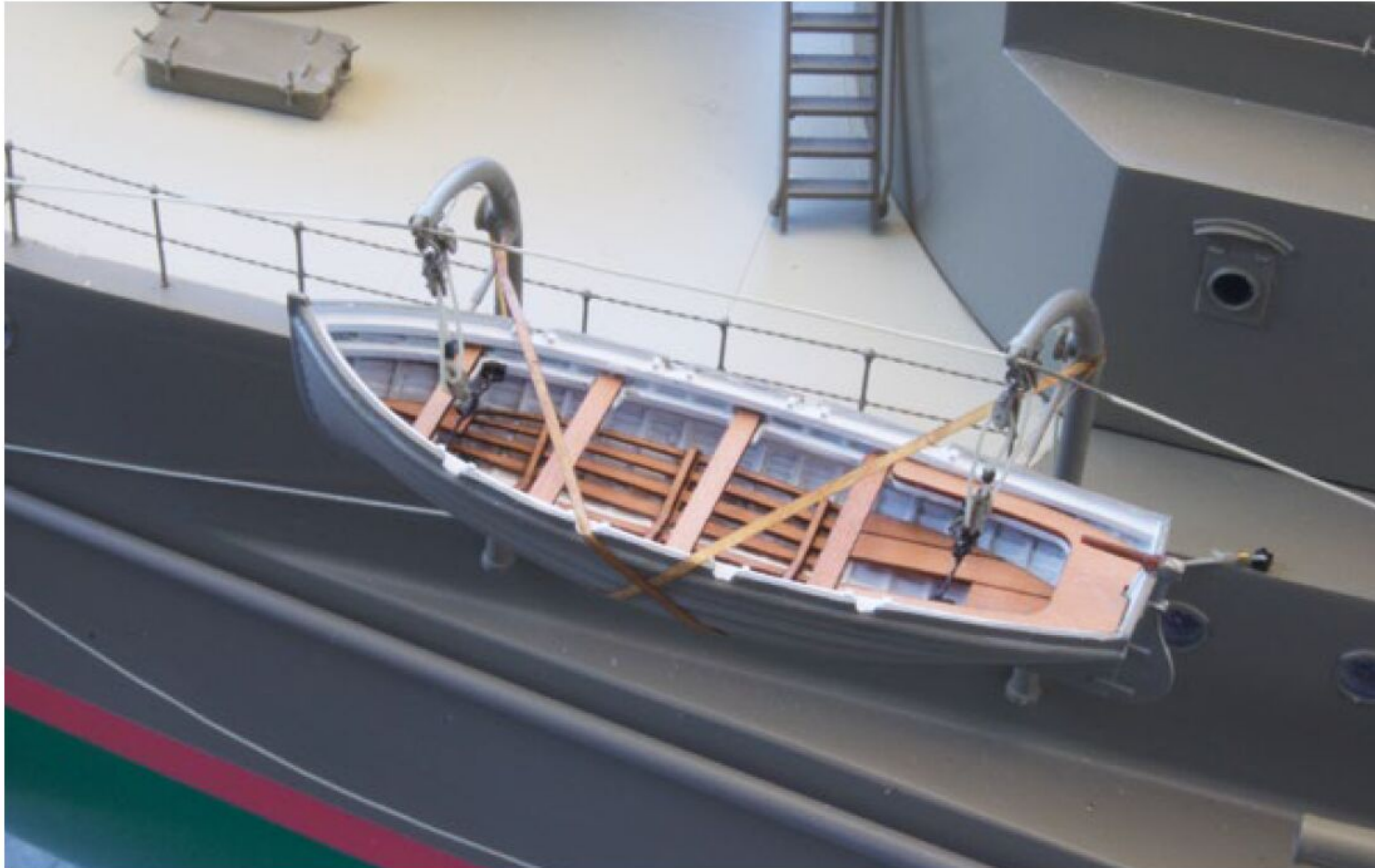
Die Innenausstattung der Jolle ist aus Birnbaumfurnier gelasert und mit Klarlack versiegelt
