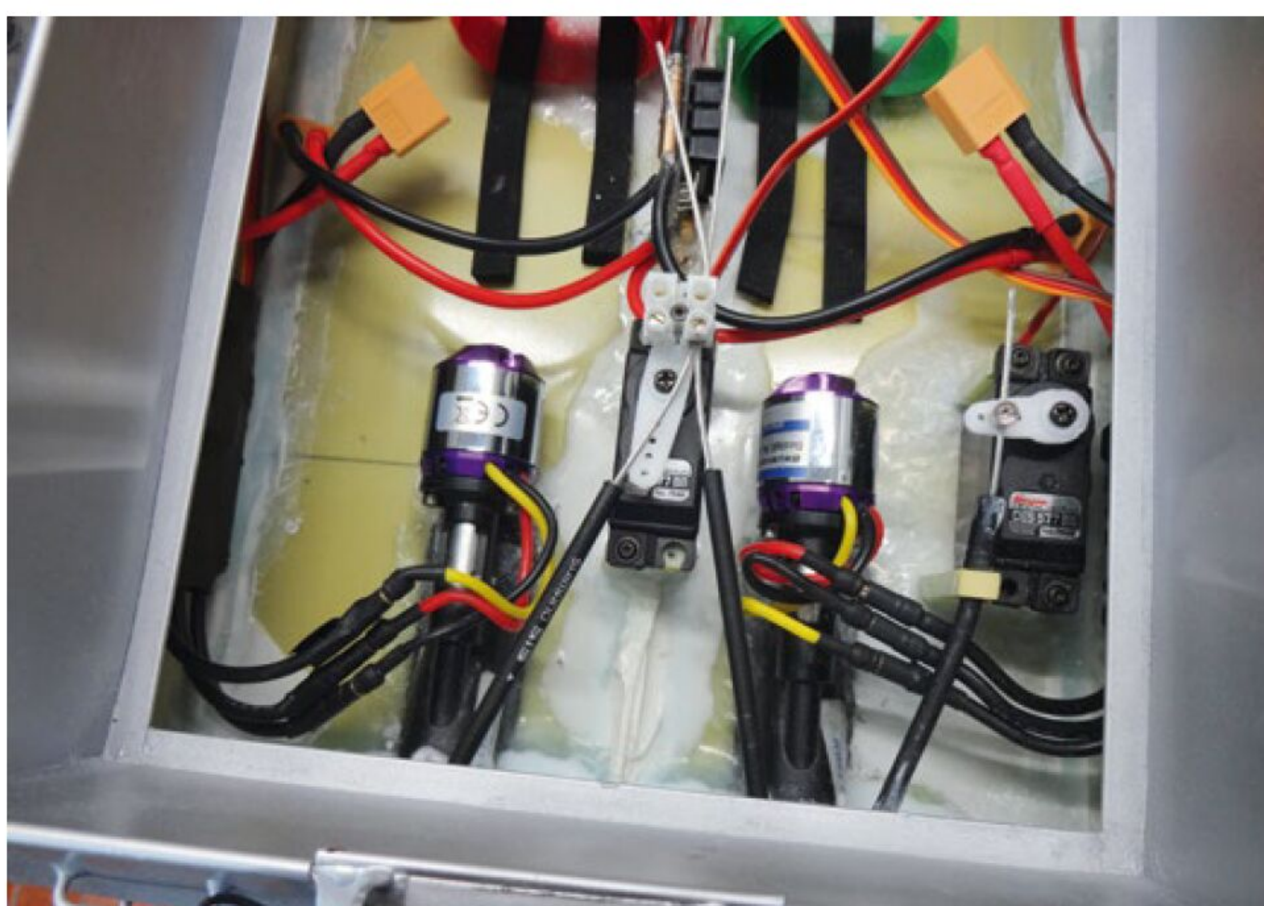
Zum Schluss habe ich noch die Ansteuerung der Rückwärtsklappen der Jets eingebaut
