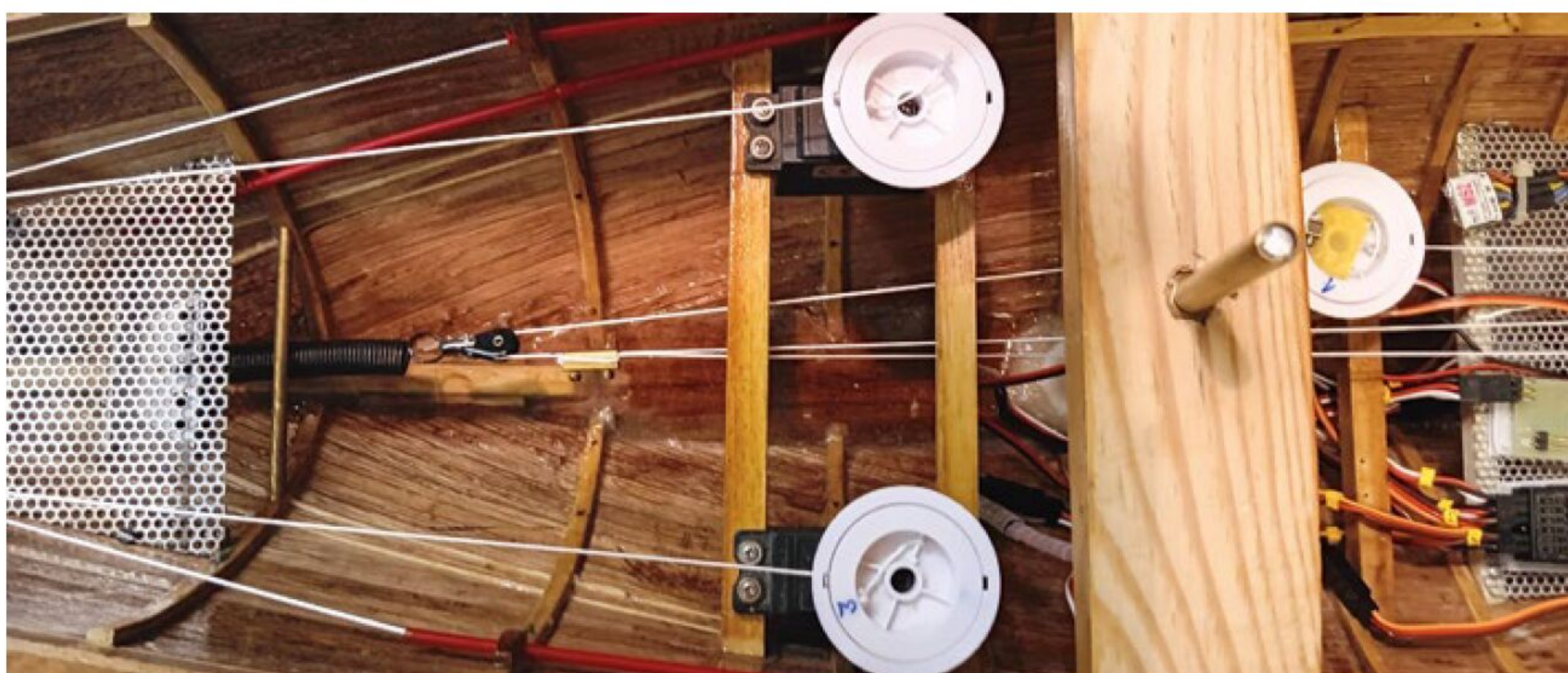
Im Vorschiff sind das Stabisierungsbrett des Masts und die Genua-Segelwinden untergebracht
