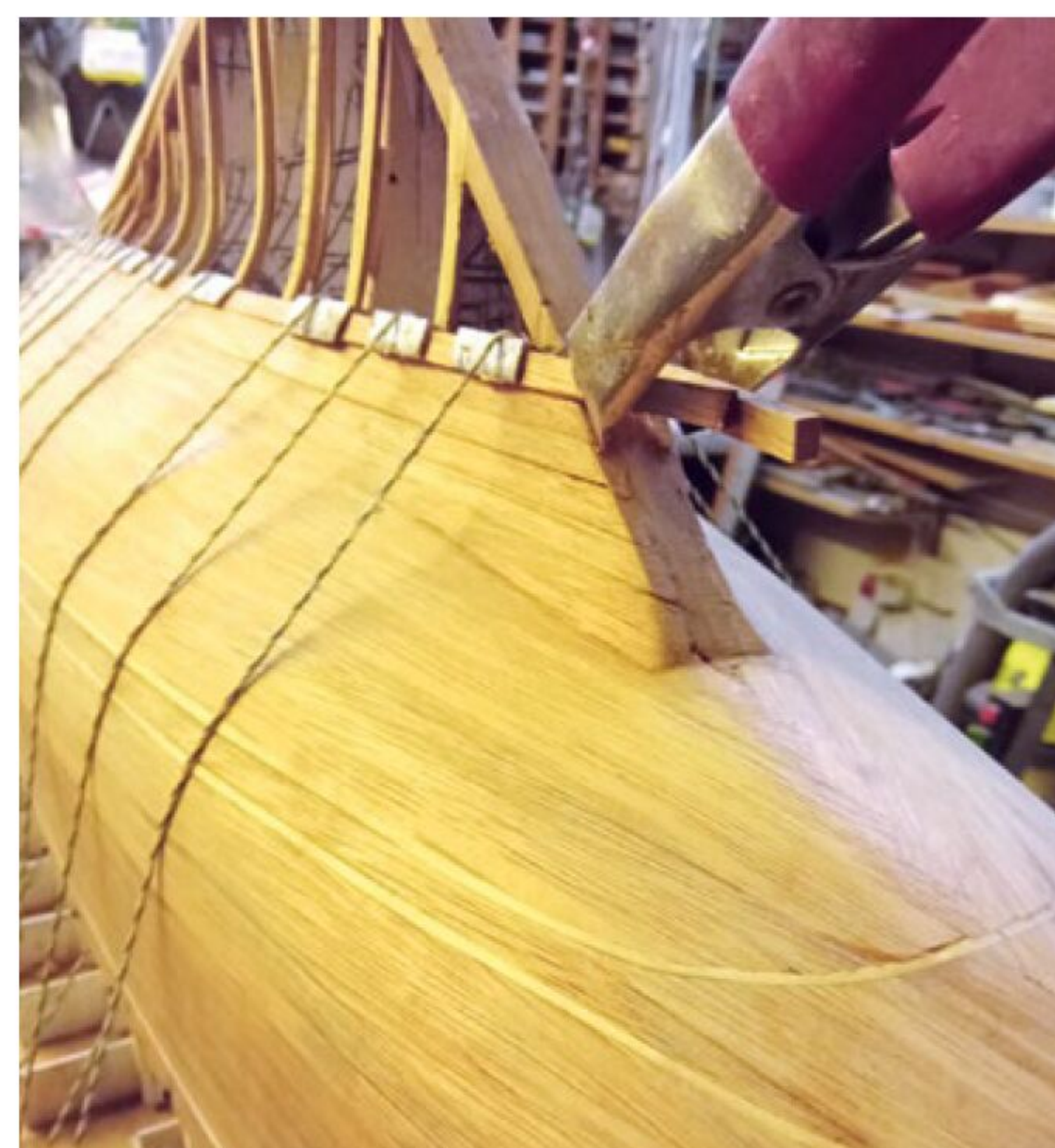
Am Bug- und Heckbereich mussten einzelne Planken vorher gewässert werden
