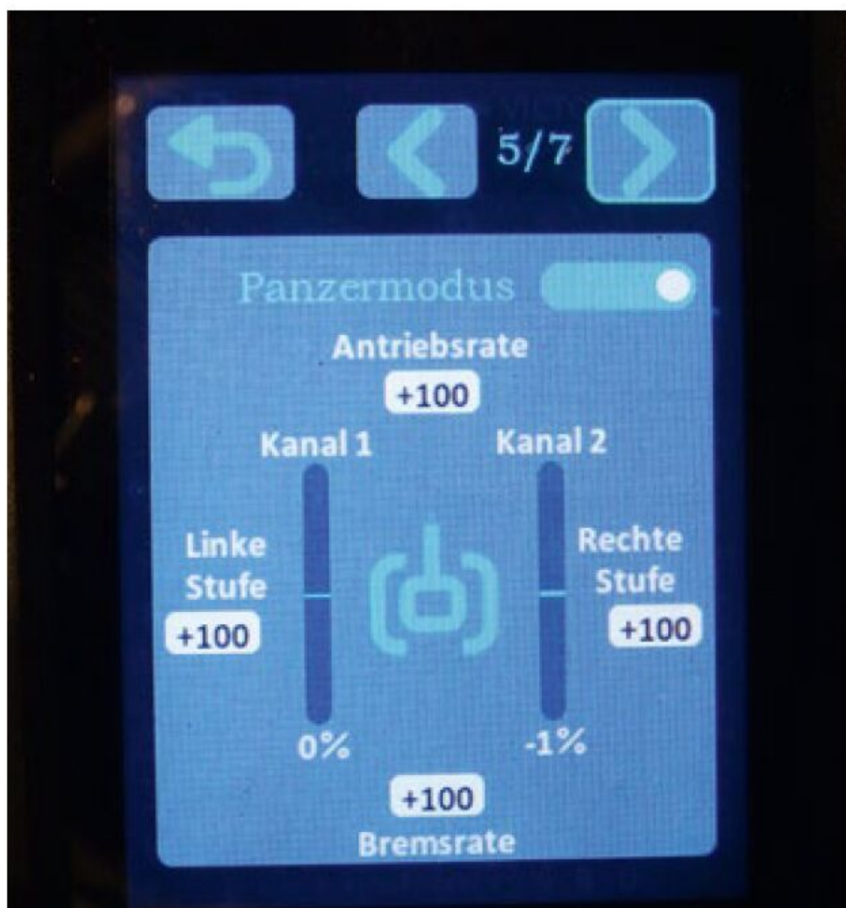
Der Panzermodus eignet sich gut für Schiffsmodelle mit zwei Antriebsschrauben
