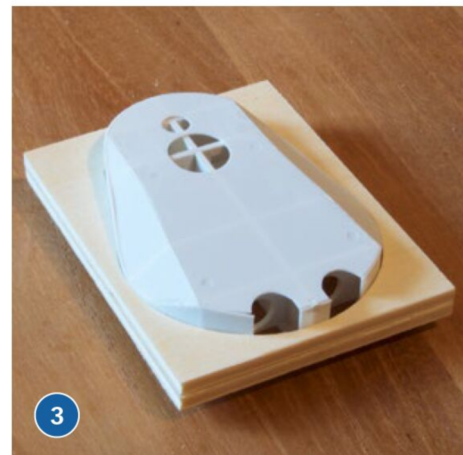
1) Die Einzelteile für die Artillerietürme wurden vorher ausgefräst. 2) Das Spantengerüst und die Verkleidung passen genau in die Holzschablone. 3) Zum Schluss kann der Turm auch von oben verkleidet werden
