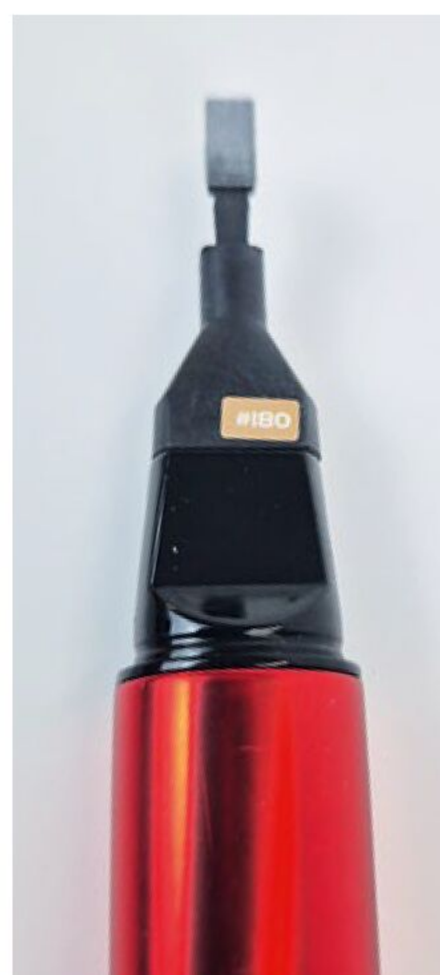
Sander mit aufgesetztem Schlefkopf mit 180er-Schleifpapier. Der Aufkleber dient zur Kennzeichnung des Schleifpapiers
