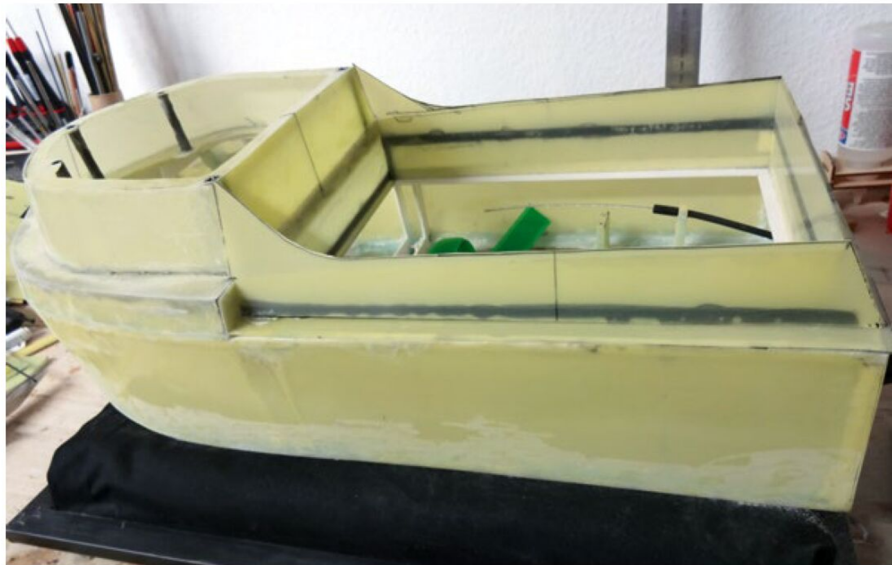
Dank der Carbonstäbe ließen sich die schrägen Bordwände perfekt anbringen
