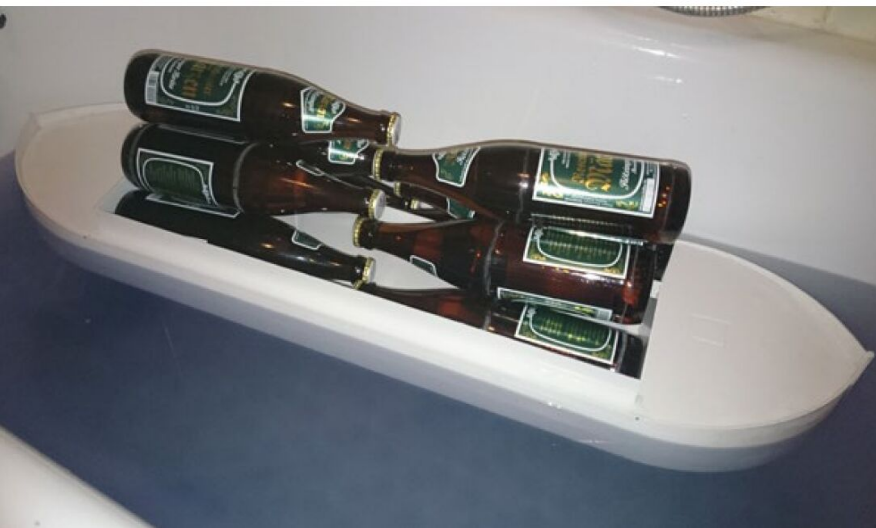
Belastungstest in der Badewanne: Die Schute ist mit 8,75 kg voll beladen
