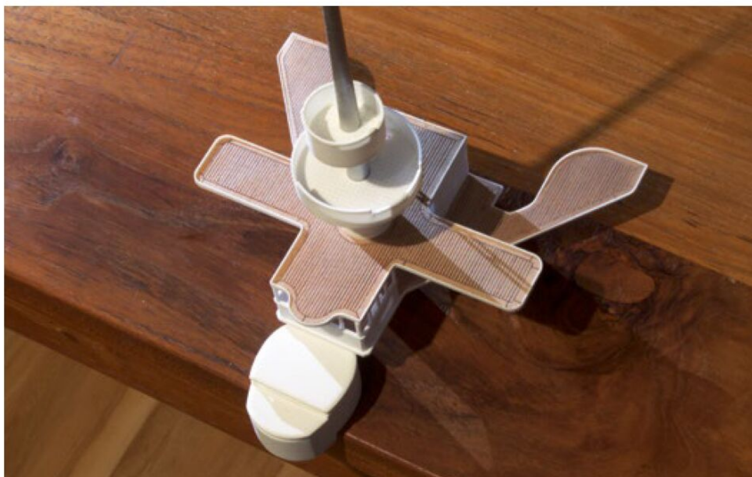
Der vordere Aufbau ist aus einem Mix aus Polystyrol, Aluminiumrohr und Holz entstanden
