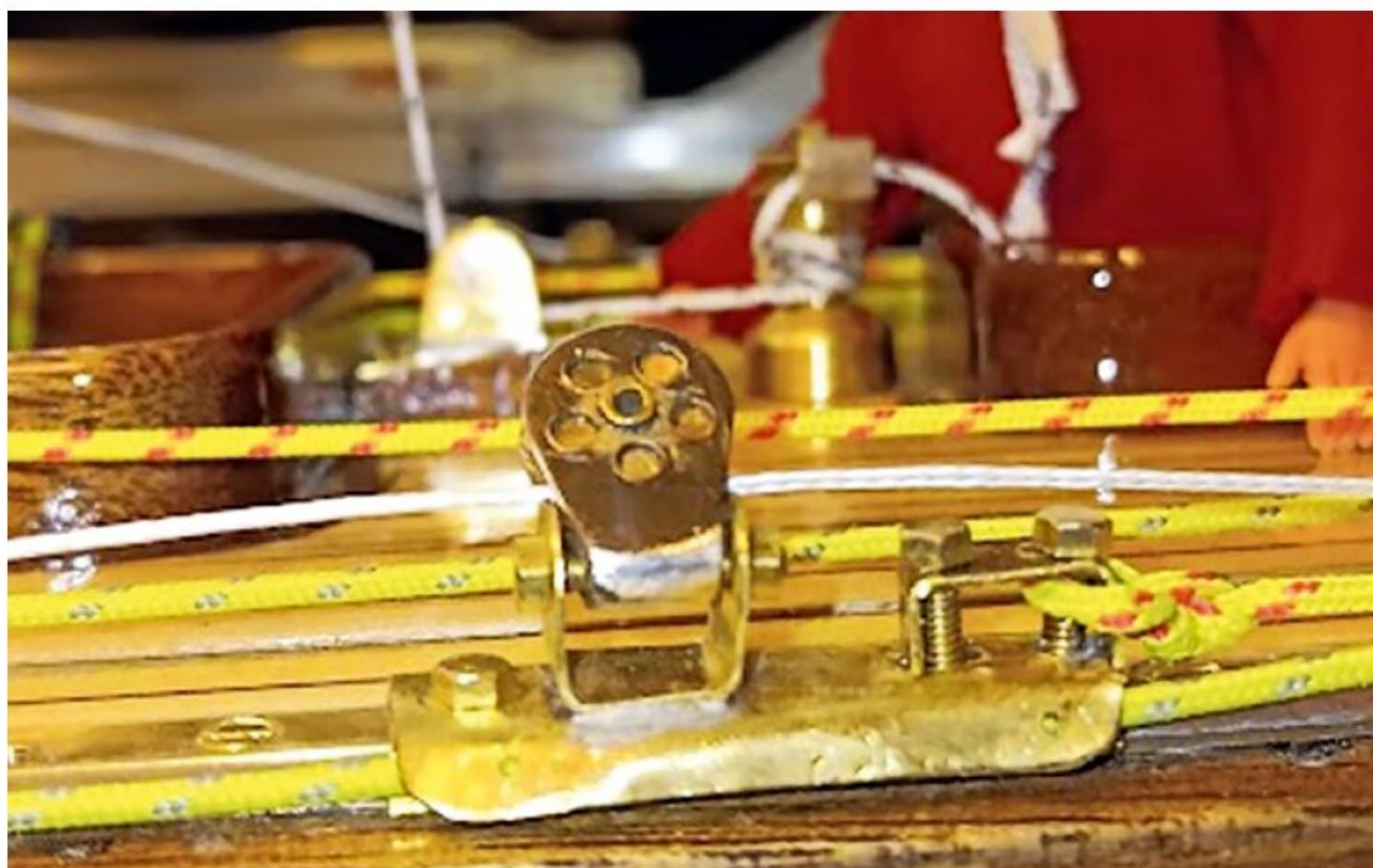
Einer der verstellbaren Schlitten für die Schotführung der Rollfock
