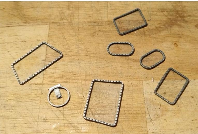
Die Scheiben werden zum Schluss hinter die Fensterrahmen geklebt und beschnitten
