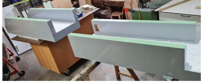
Das Dock wird vor Ort mit Stehbolzen und einer Verschraubung zusammengesetzt
