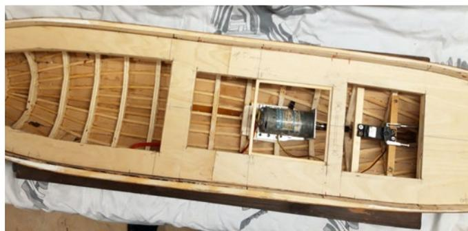
**Der Motor und das Ruderservo wurden vor dem Deck in den Rumpf eingesetzt**
