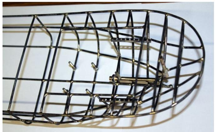
Das Spantengerüst im Bereich des Hecks mit Stevenrohr, Ruderkoher und Motorhalterung
