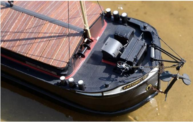
Das Vorschiff mit Ankerwinde und dem flexiblen Ankerspriet und Stockanker
