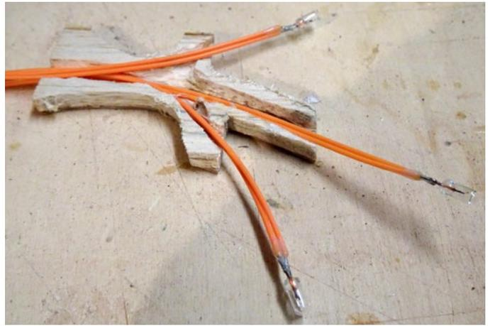
Der Kern des Masts besteht aus starkem Balsaholz, in den Kabelkanäle geschnitten wurden
