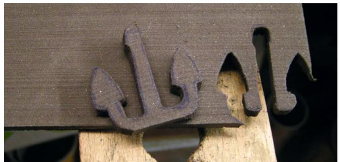
Der aus einer Gummiplatte mit der Laubsäge ausgesägte Rohling des Hallankers
