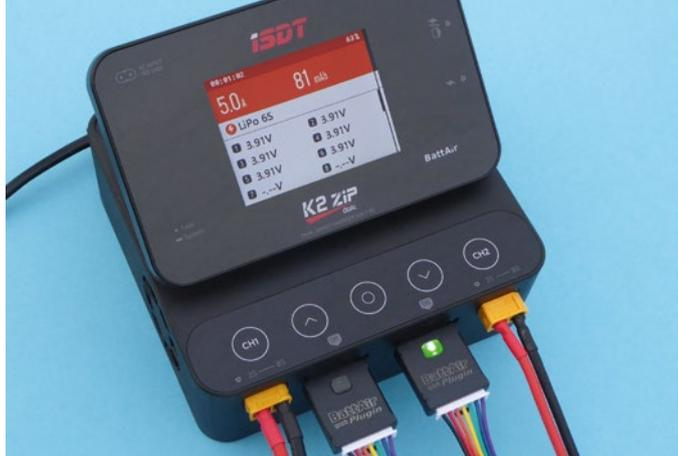
Das angewinkelte Display liegt gut im Blickfeld und lässt sich optimal ablesen, sämtliche Akkuanschlüsse erfolgen auf der Frontseite. Hier sind auch die BattAirs im Betrieb
