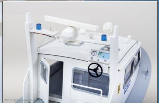
Das Boot wird auf einem tiefgezogenen ABS-Rumpf mit Laserteilen aus ABS aufgebaut.
