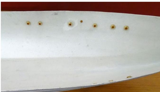
Die Bullaugen bestehen aus Messingrohr und werden von innen in den Rumpf geklebt
