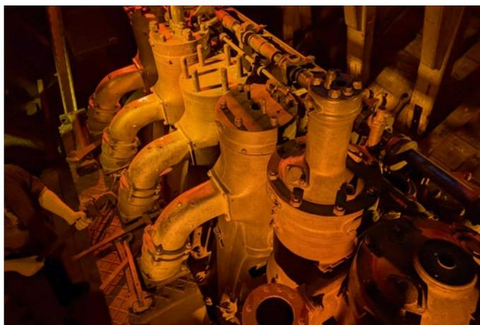
**Die Dreifach-Expansions-Dampfmaschine der FRAM mit 220 PS**
