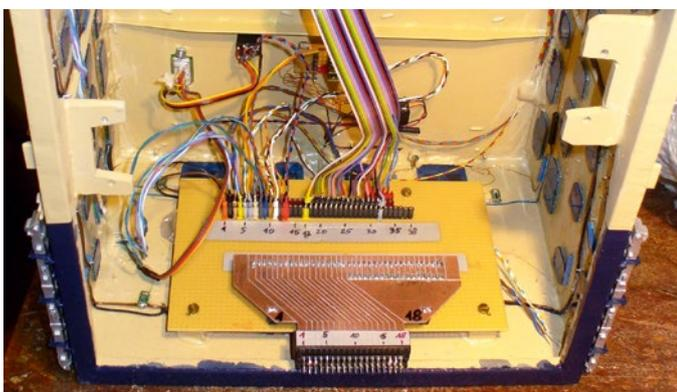
Der elektrische Kontakt zwischen Rumpf und Aufbau übernimmt ein Platinenverbinder
