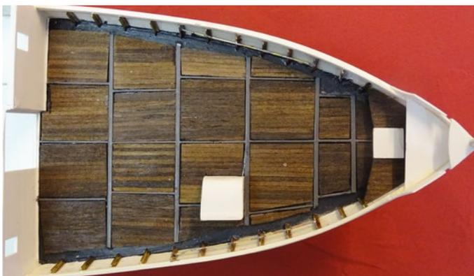
Das Vordeck besteht aus einzelnen mit Holzleisten furnierten Polystyrol-Platten
