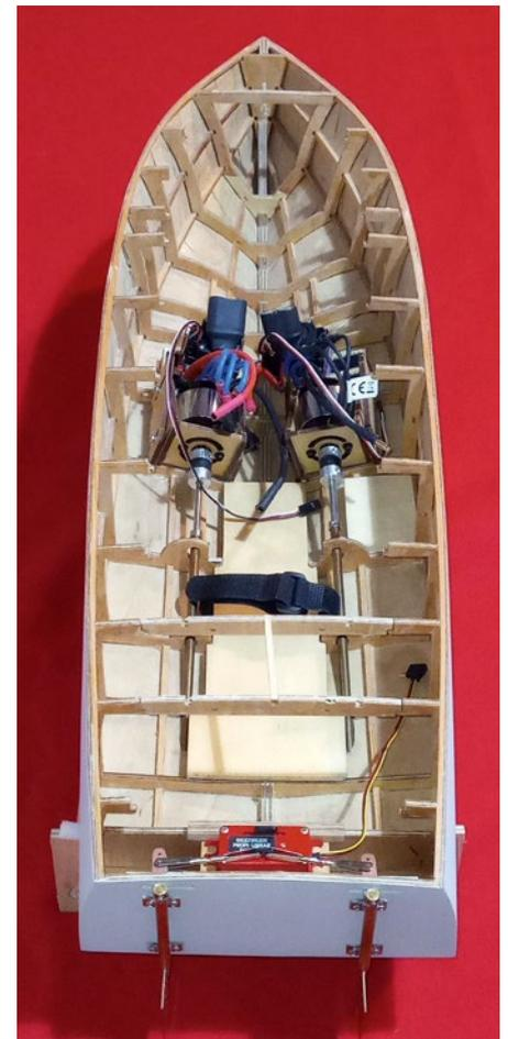
Die Motorträger der Antriebsanlage passen genau zwischen die Spanten
