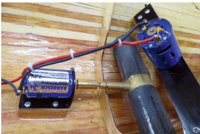
Im Bug arbeiten zwei Querstromruder mit Raboesch-Motoren
