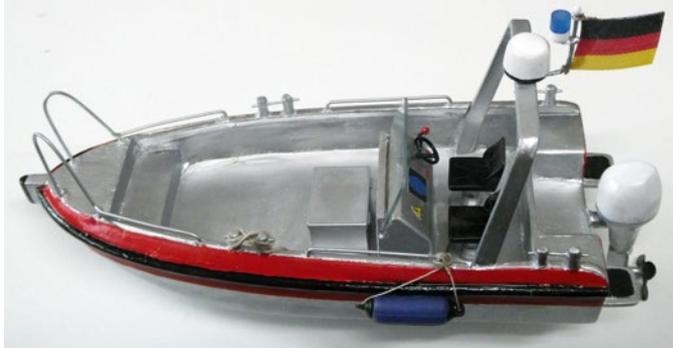
Das Beiboot wurde mit einem Styrodurkern und darüber verleimtem Sperrholz gebaut
