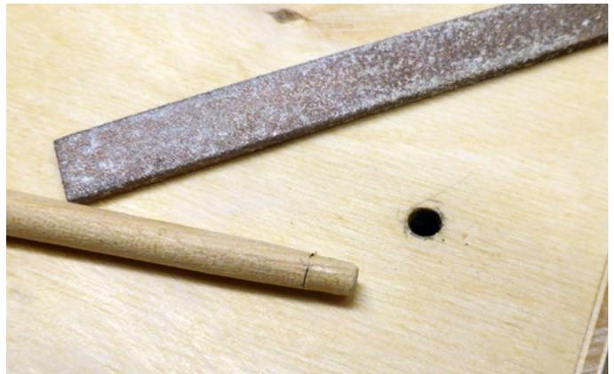
... außerdem saß die Bohrung im Boden zu weit vorn und musste wieder geschlossen werden
