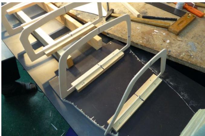
Auf einem Hellingbrett werden die fertigen Spanten aufgestellt
