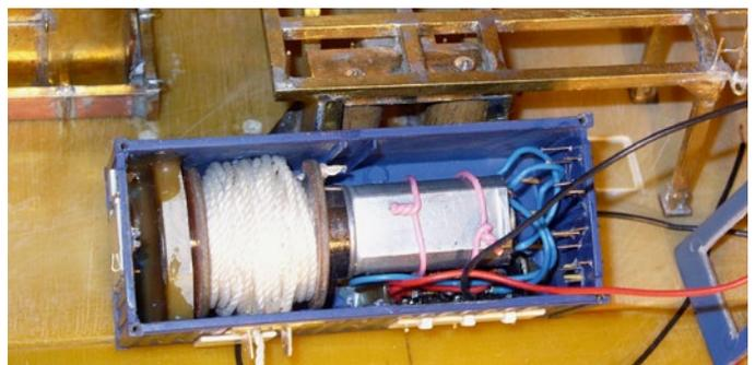
Im Container ist die Seilwinde für den Gravity-Corer versteckt
