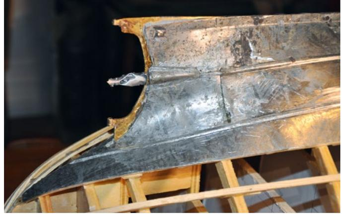
Der Rumpf wird wie beim Original mit Stahlblechstreifen beplankt
