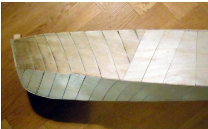
Die gegenläufige Ausrichtung der Doppeldiagonalkarweelbeplankung
