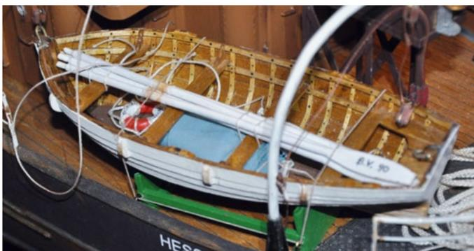
Der fertige Rumpf des Beiboots wurde nachträglich mit Spanten versehen
