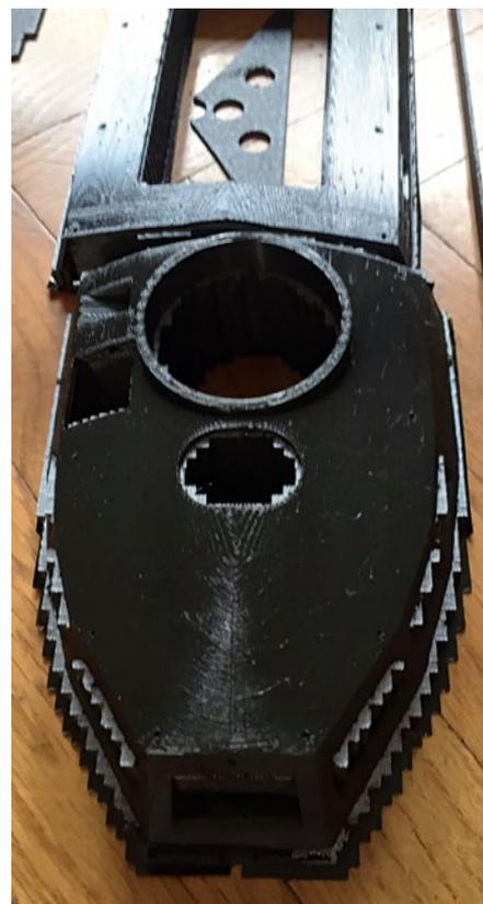
Die großen Anbauteile im Filamentdruck müssen noch stark beschliffen werden
