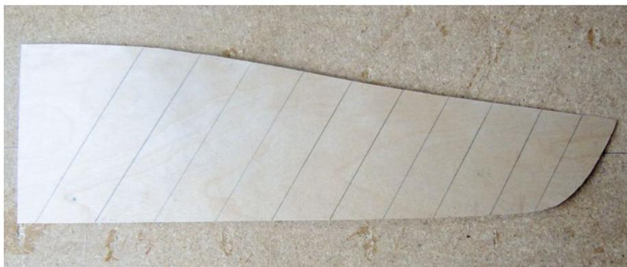
Das Beplankungsfeld für den Bugbereich mit Markierungen für den 45°-Schrägschnitt
