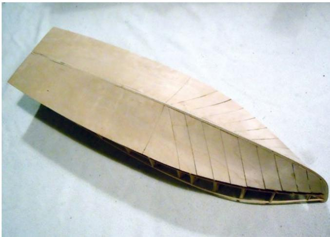
Die erste Schicht der Beplankung mit Schrägbeplankung im Bug
