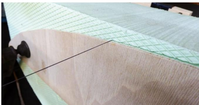
Mit einem selbstgebauten Heißdrahtschneider wird die grobe Form aus Styrodur ausgeschnitten
