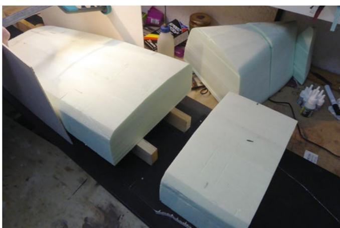
Der fertige Rumpf wird in acht Teile zerschnitten, um die Spanten abzunehmen
