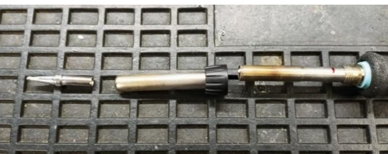
Die Lötspitzen lassen sich problemlos und schnell ohne Werkzeug wechseln
