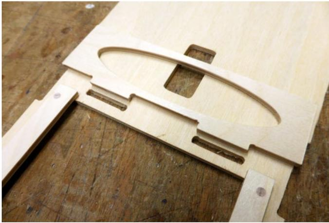
**Die Bauteile sind passgenau gefräst und benötigen keine Nacharbeit**
