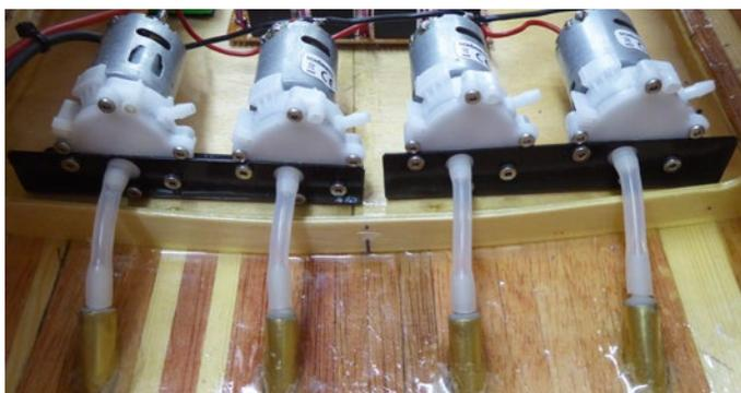
Die sechs Löschkanonen werden von vier Wasserpumpen versorgt
