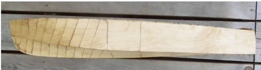
Der fertig beplankte Rumpf wurde mit zwei Schichten Epoxidharz gestrichen
