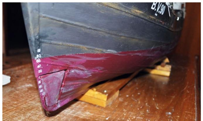
Das charakterische Bugruder ist im fertigen Schiff eingebaut
