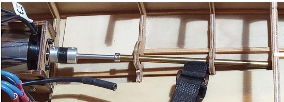
Einer der Motoren mit der selbstgebauten Wellenanlage
