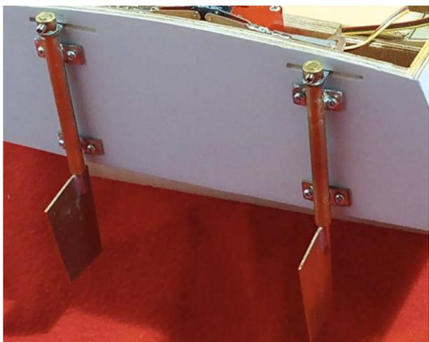
Ruderanlenkung im Rohbau, hier noch mit Linearservo
