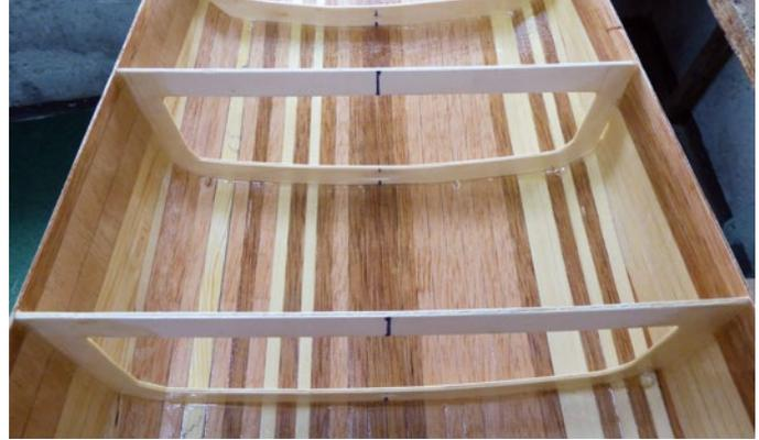
Der fertig beplankte Rumpf wird außen und innen mit Epoxidharz gestrichen
