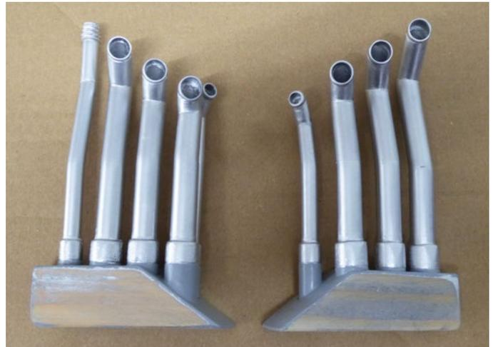
Die Abgasrohre wurden aus diversen Rohrstützen aus PS zusammengesetzt
