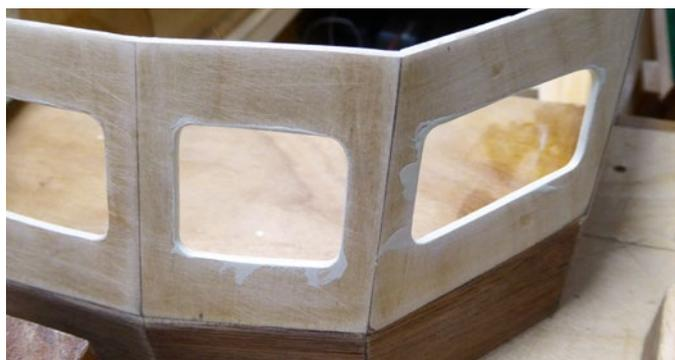
In die bereits verklebten Segmente des Aufbaus werden die Fenster gesägt
