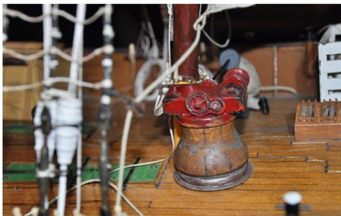
Neben dem Großmast steht das elektrisch betriebene Spill für das Einholen des Netzes
