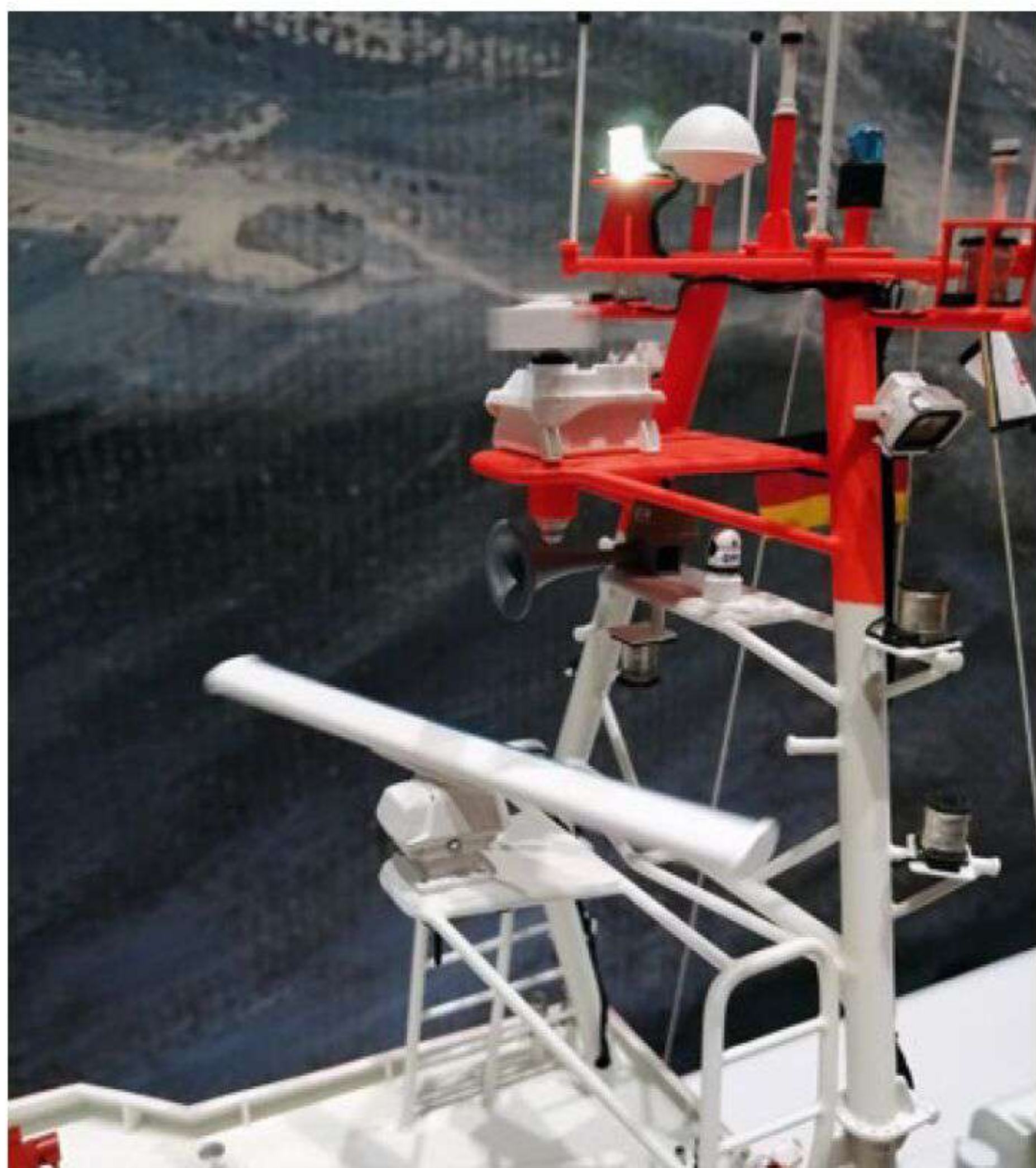
Der Mast der BERLIN ist in Hart- und Weichlöttechnik entstanden
