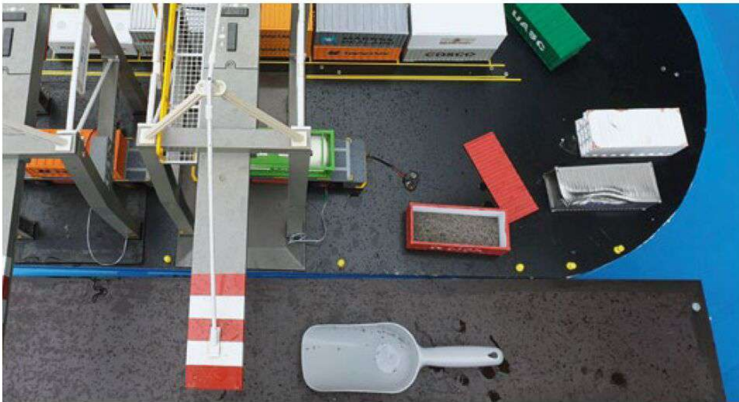
Durch Edelstahl-Strahlkies in einigen Container werden die Module getrimmt
