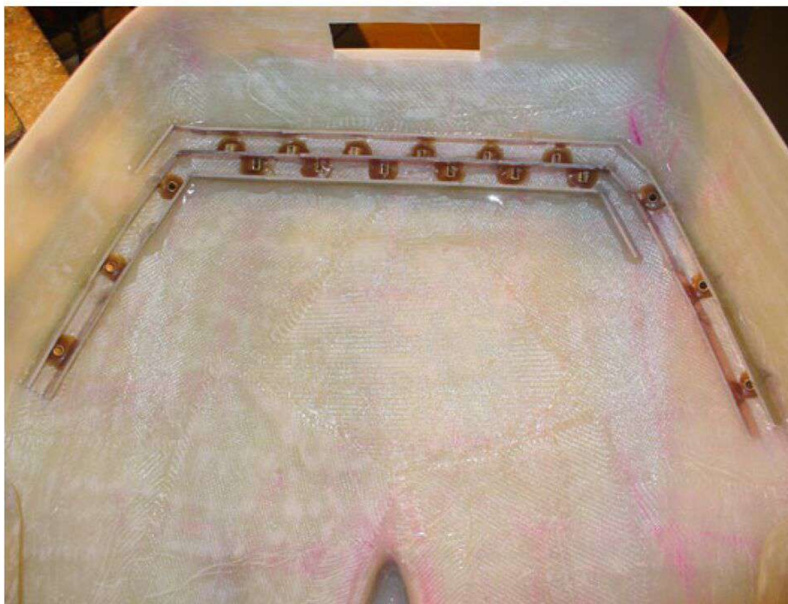
Hier sind die Kanäle für die Wasserdüsen am Bug noch offen
