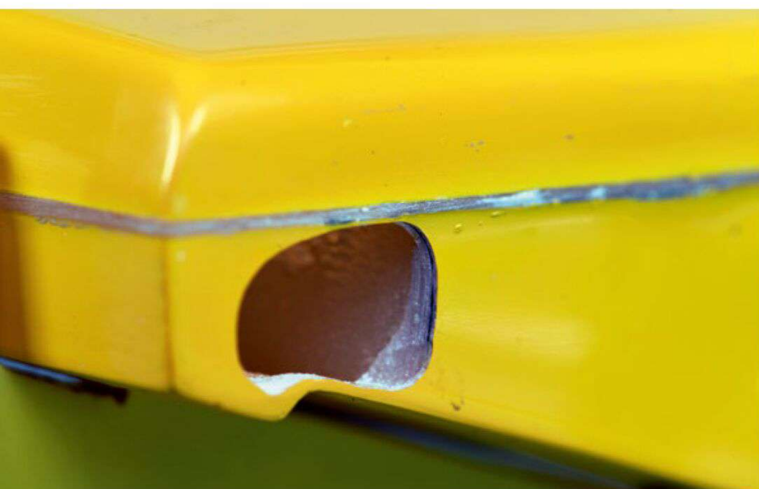
Im Heck sitzt die Öffnung für den Kentertunnel
