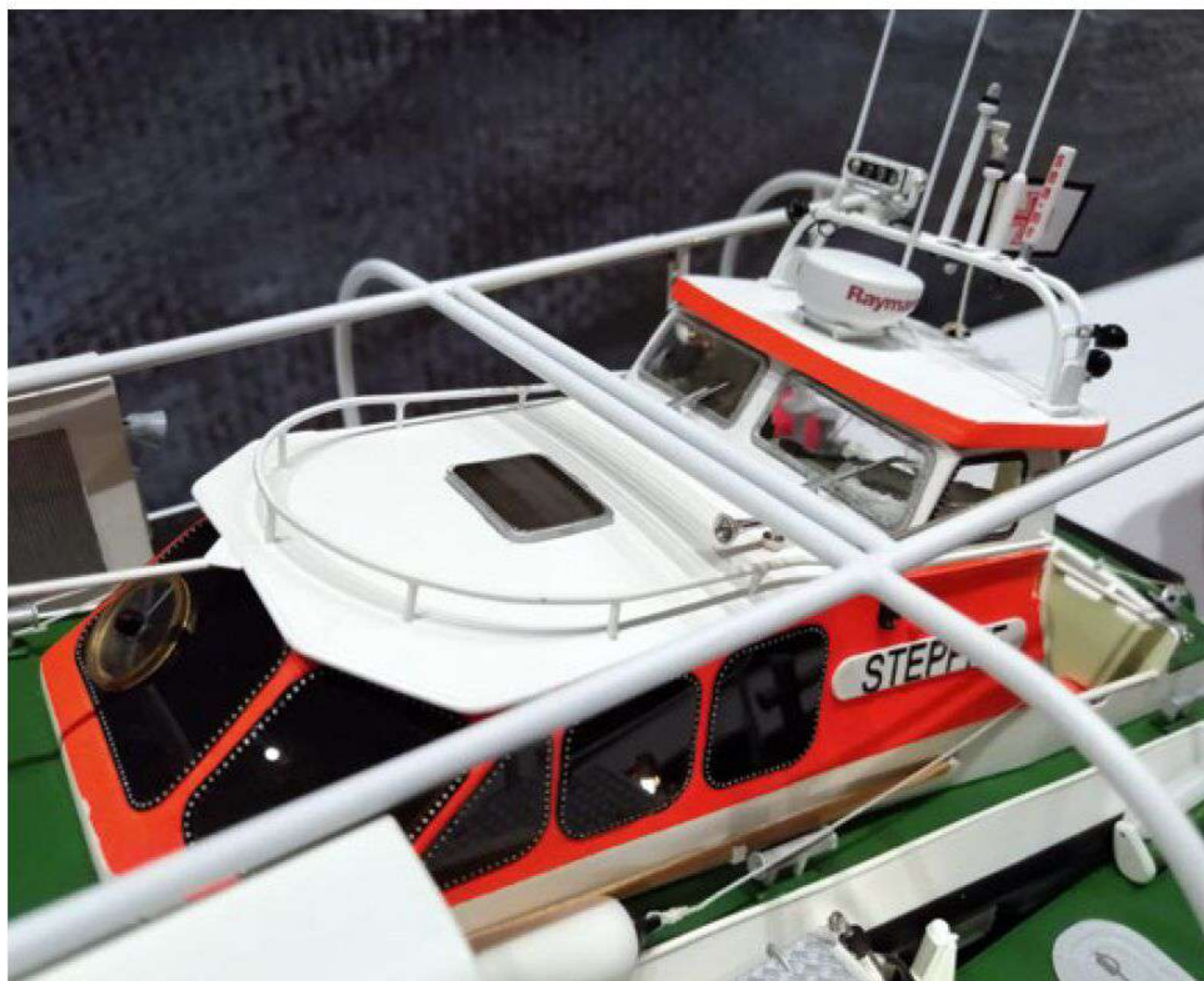
Das Tochterboot STEPPKE lässt sich mittels Magnet auch wieder an Bord nehmen
