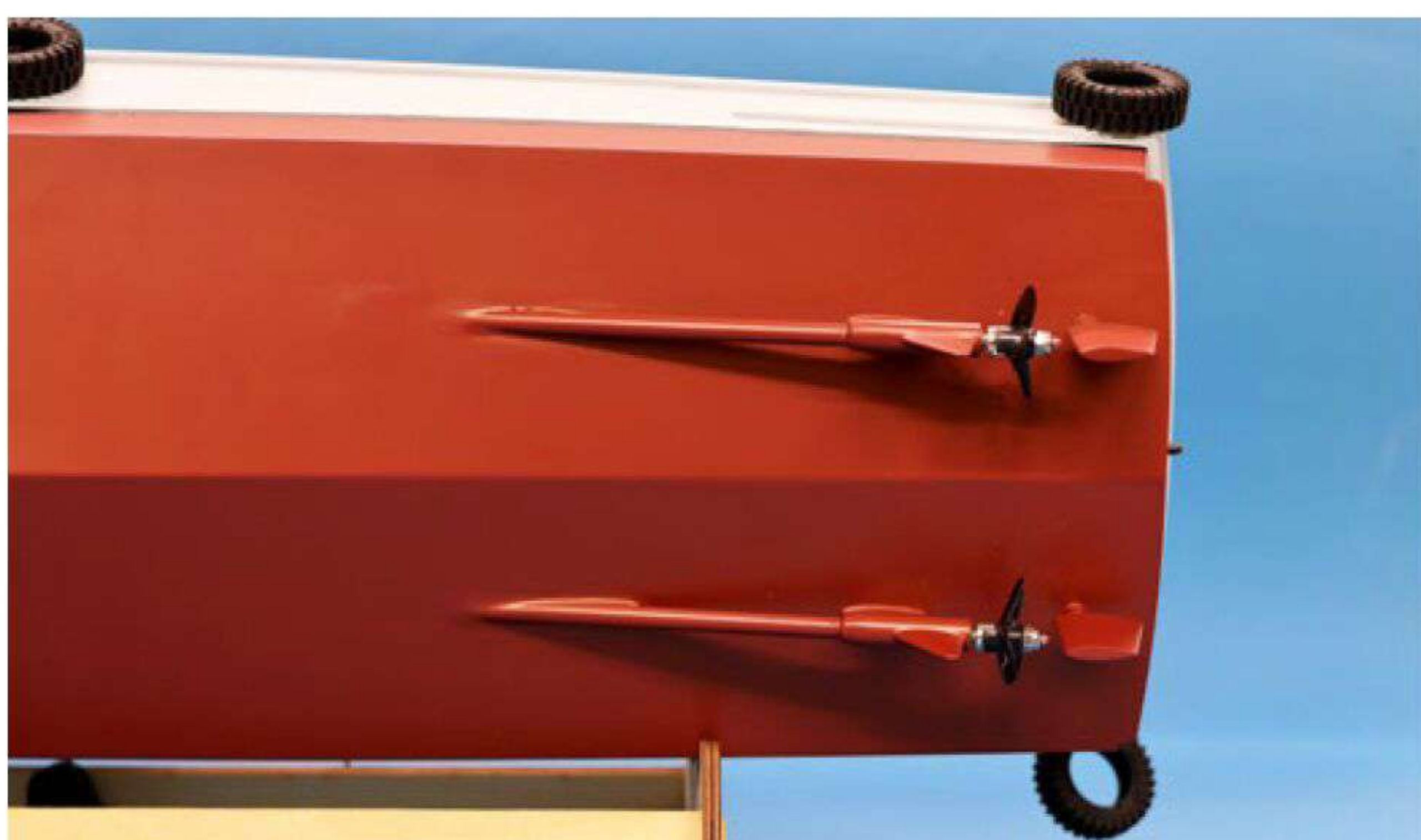
Links- und rechtsdrehende Propeller schließen Drall aus. Die Ruder wirken sehr gut
