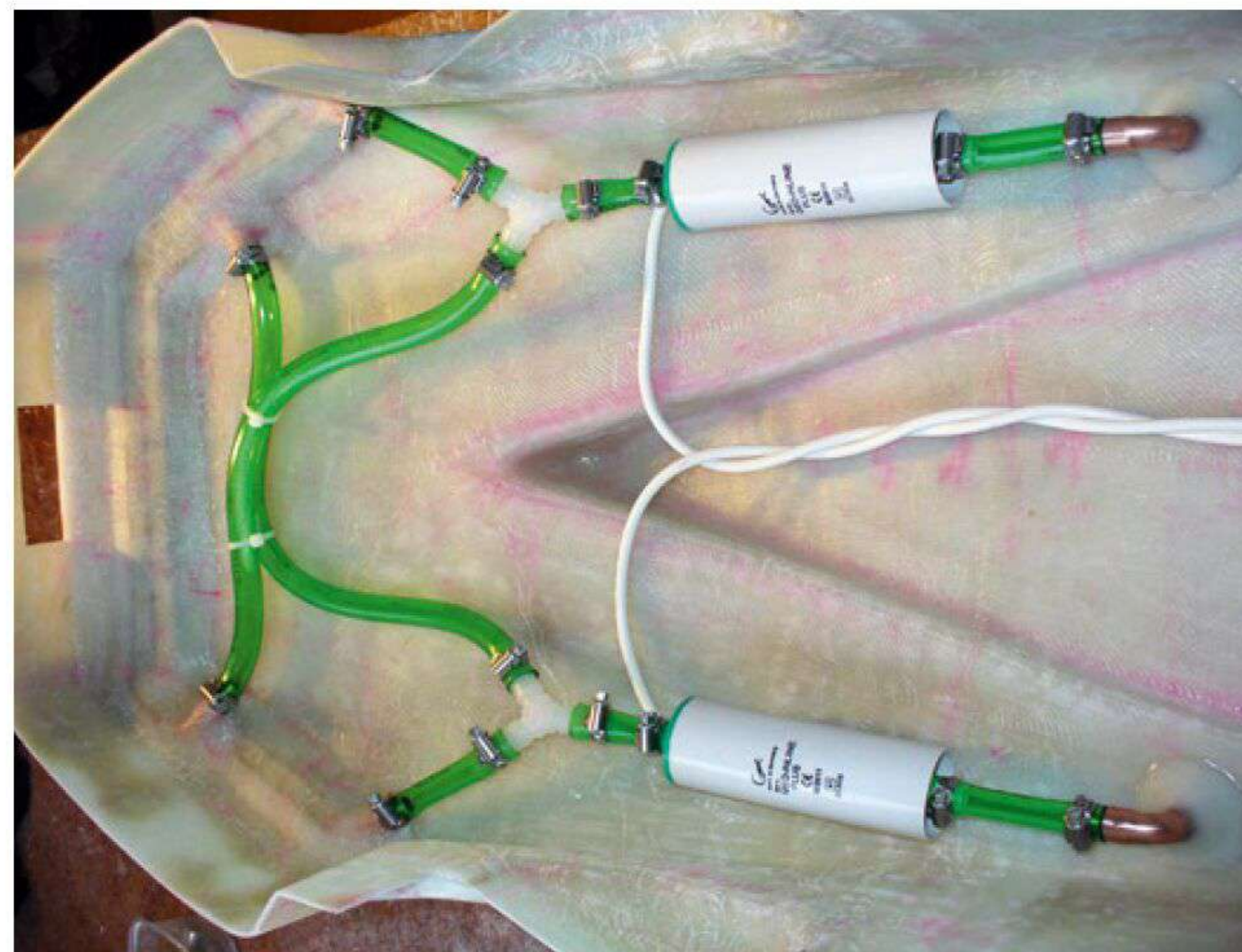
Die zwei getrennt angesteuerten Pumpen stammen aus den Campingbereich
