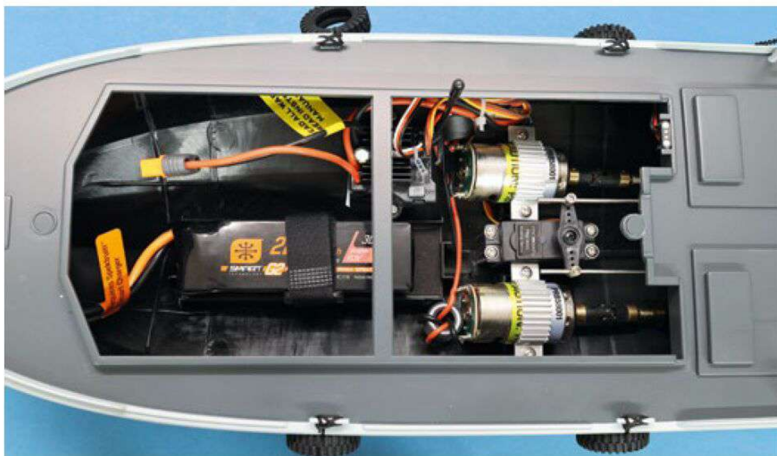
Fixiert vom Klettband kann man den Akku exakt positionieren. Die Motoren liefern eine zum Modell passende Leistung
