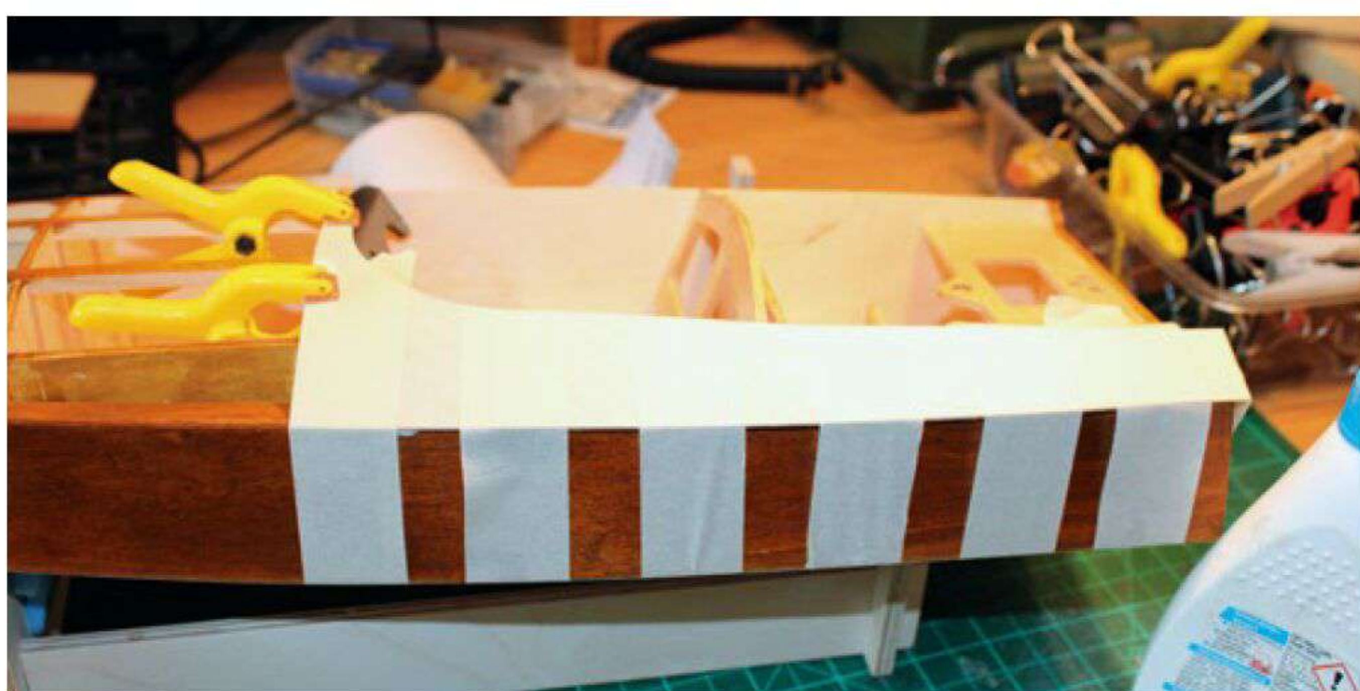
Mit Klebebändern wird die Decksbeplankung am Cockpit gesichert
