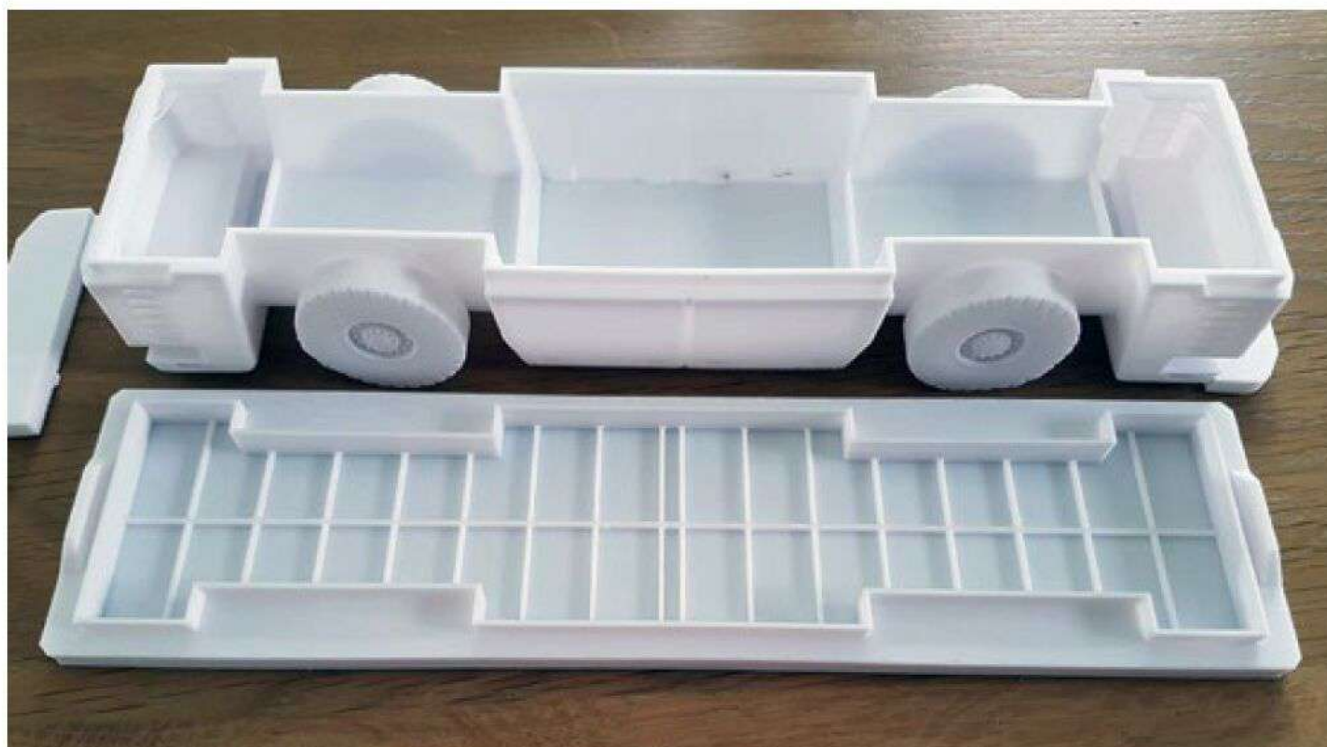
Die Automated Guided Vehicles sind relativ einfach zu drucken
