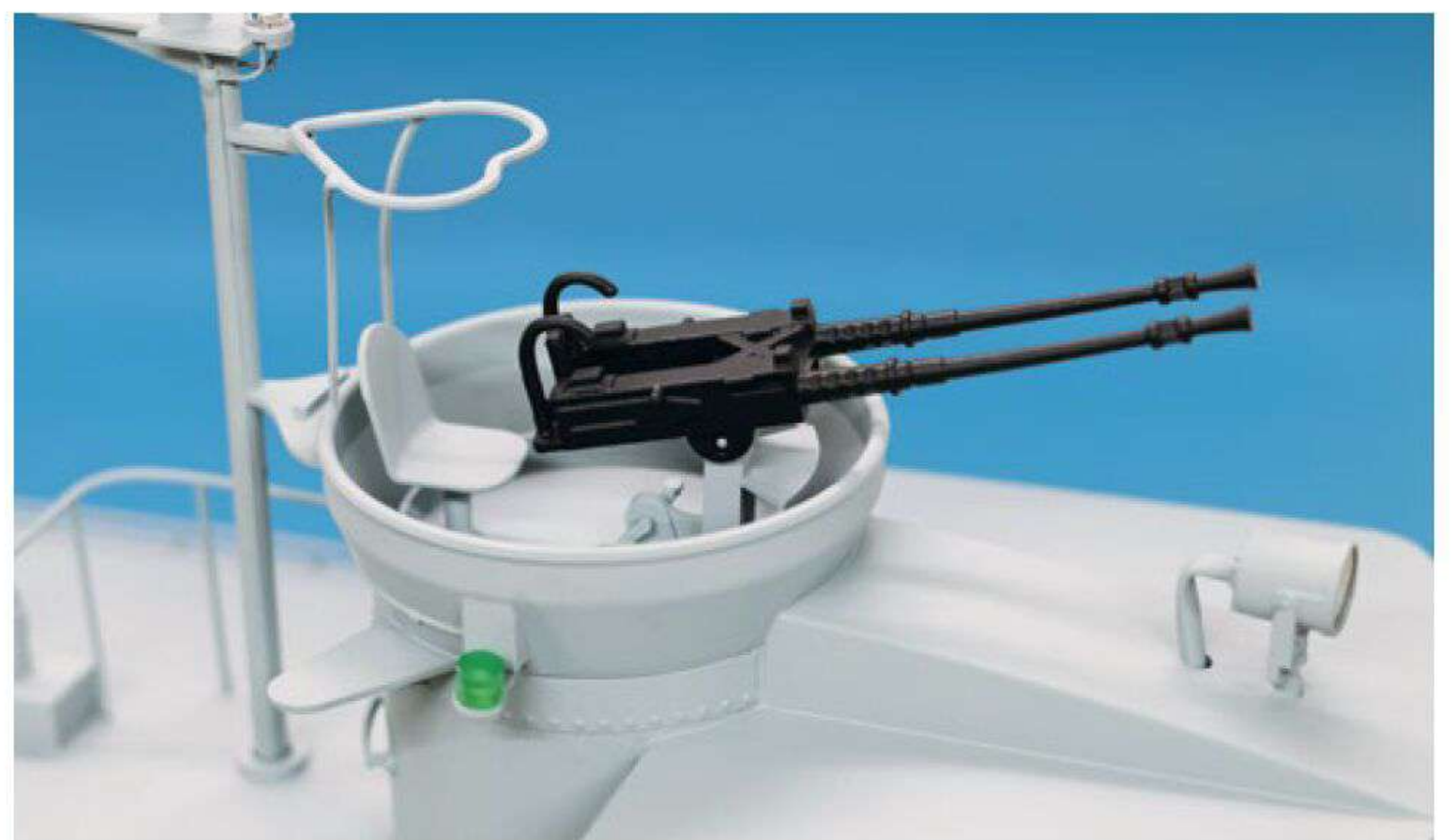
Das MG im Geschützturm ist beweglich gelagert und ließe sich über ein Servo separat ansteuern
