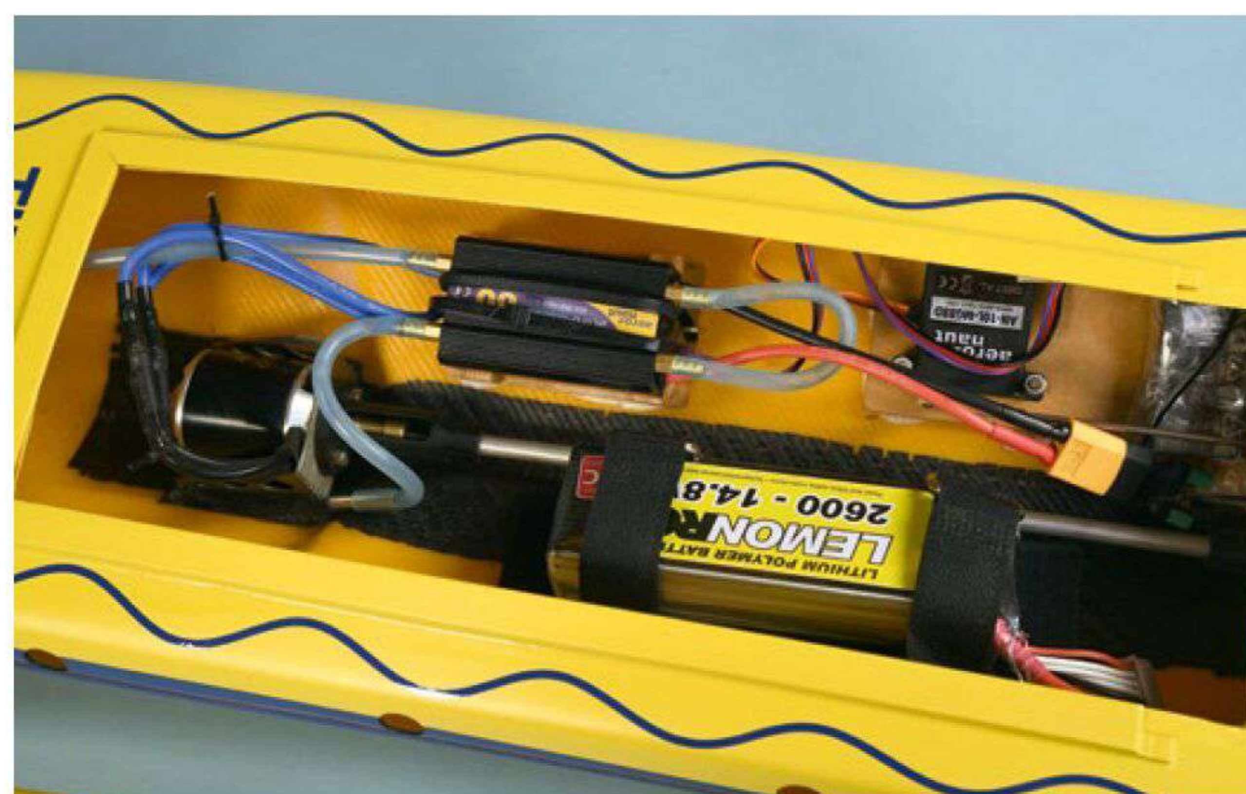
Auf den eingeklebten Brettchen ist die Technik im Bootsinneren gut austariert
