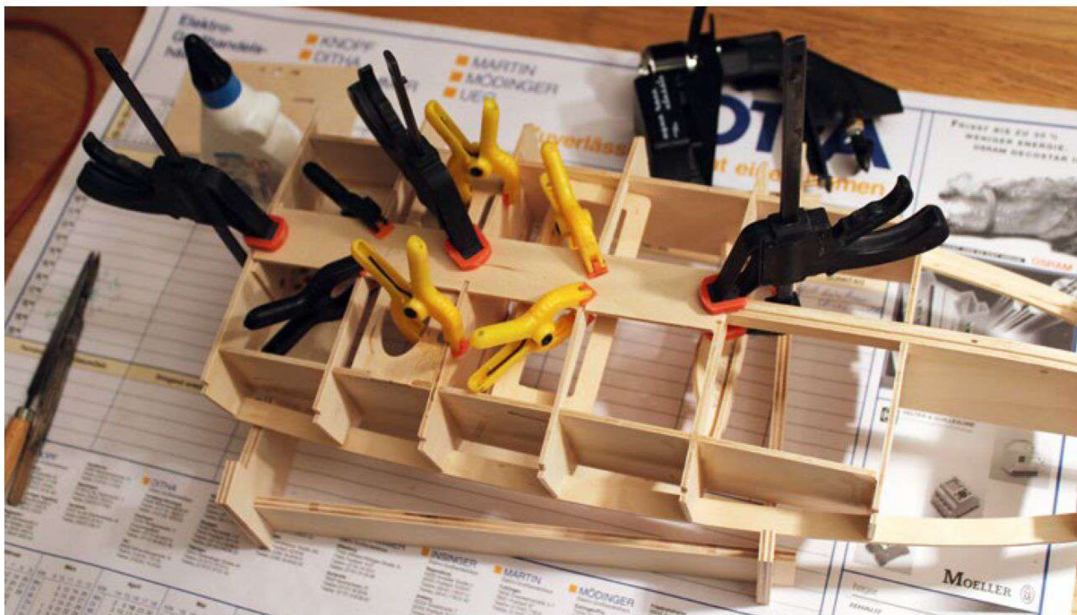
Danach wird das Kielbrett eingepasst, verklebt und zum Trocknen gut fixiert
