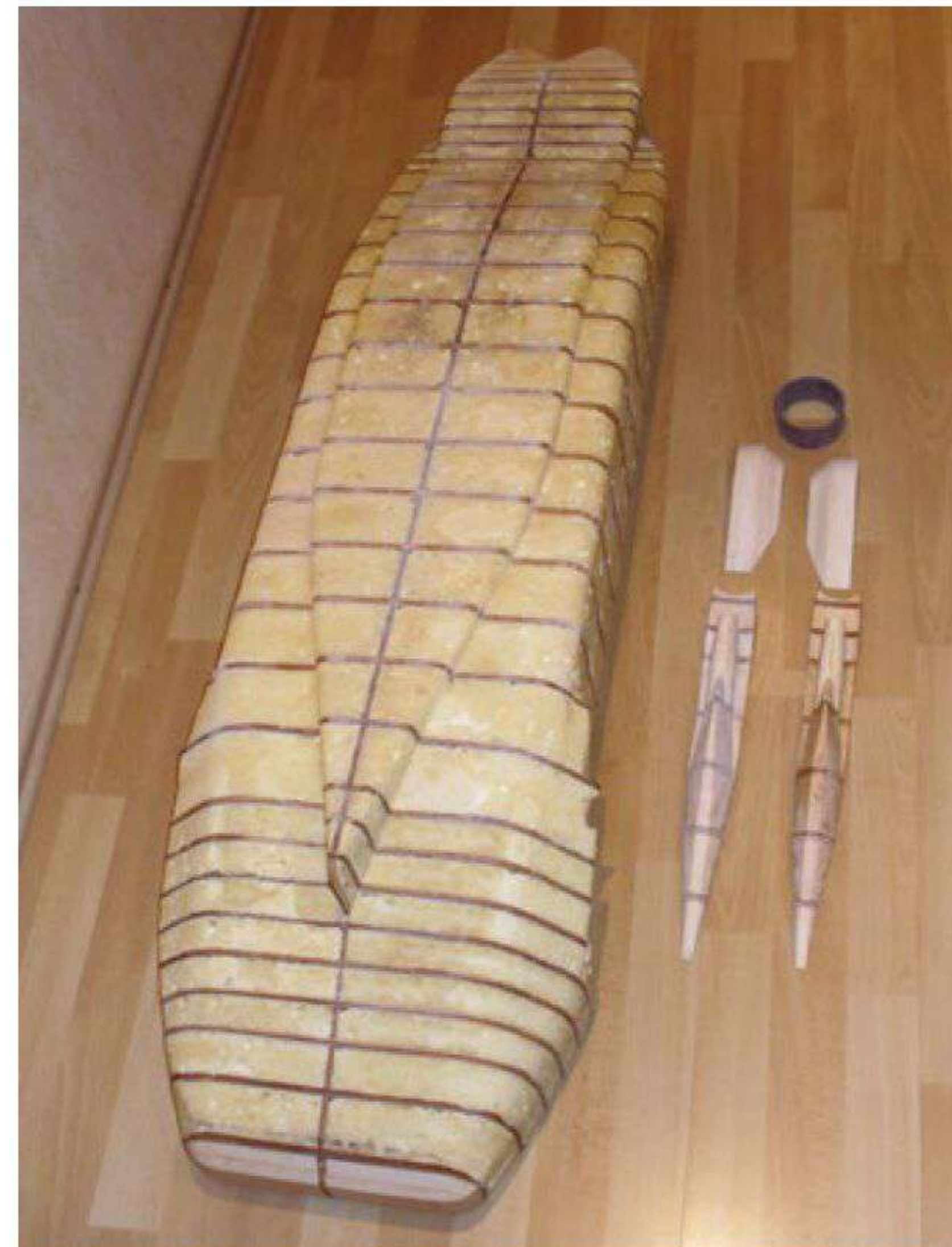
Wellenhosen und Seitenteile der Turning Reamer mussten eigene Formen bekommen
