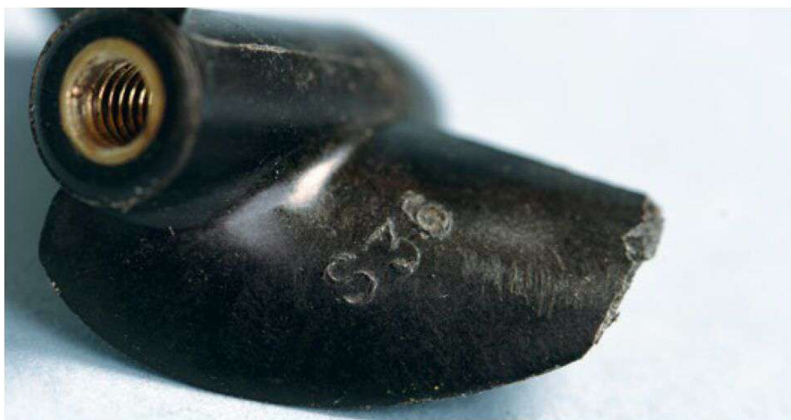
Der Propeller hatte nach den ersten Runden stark gelitten
