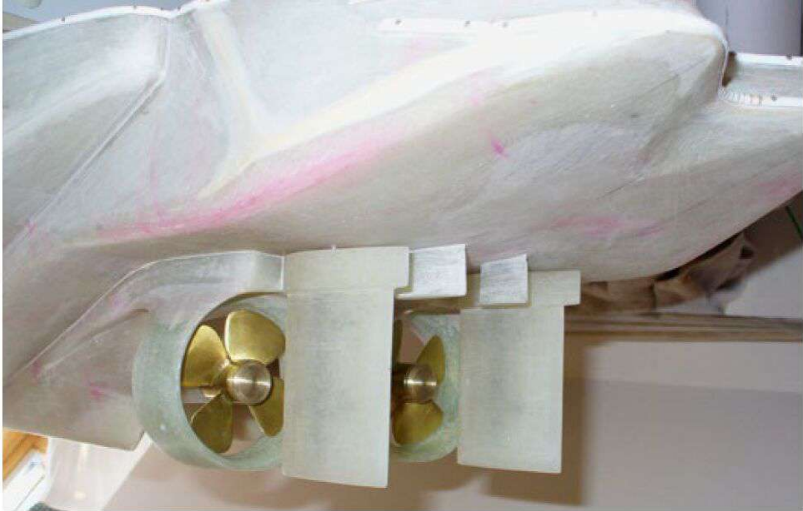
Die Wellenanlagen, Ruder und die Ruderanschlüsse sind nun fertig
