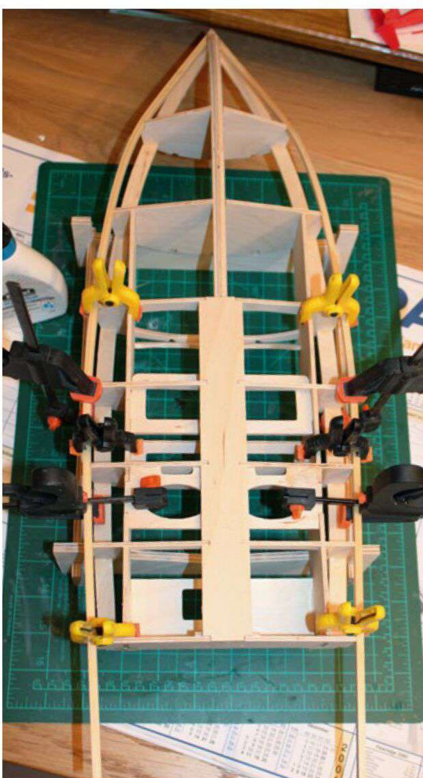
Danach wird das Kielbrett eingepasst, verklebt und zum Trocknen gut fixiert
