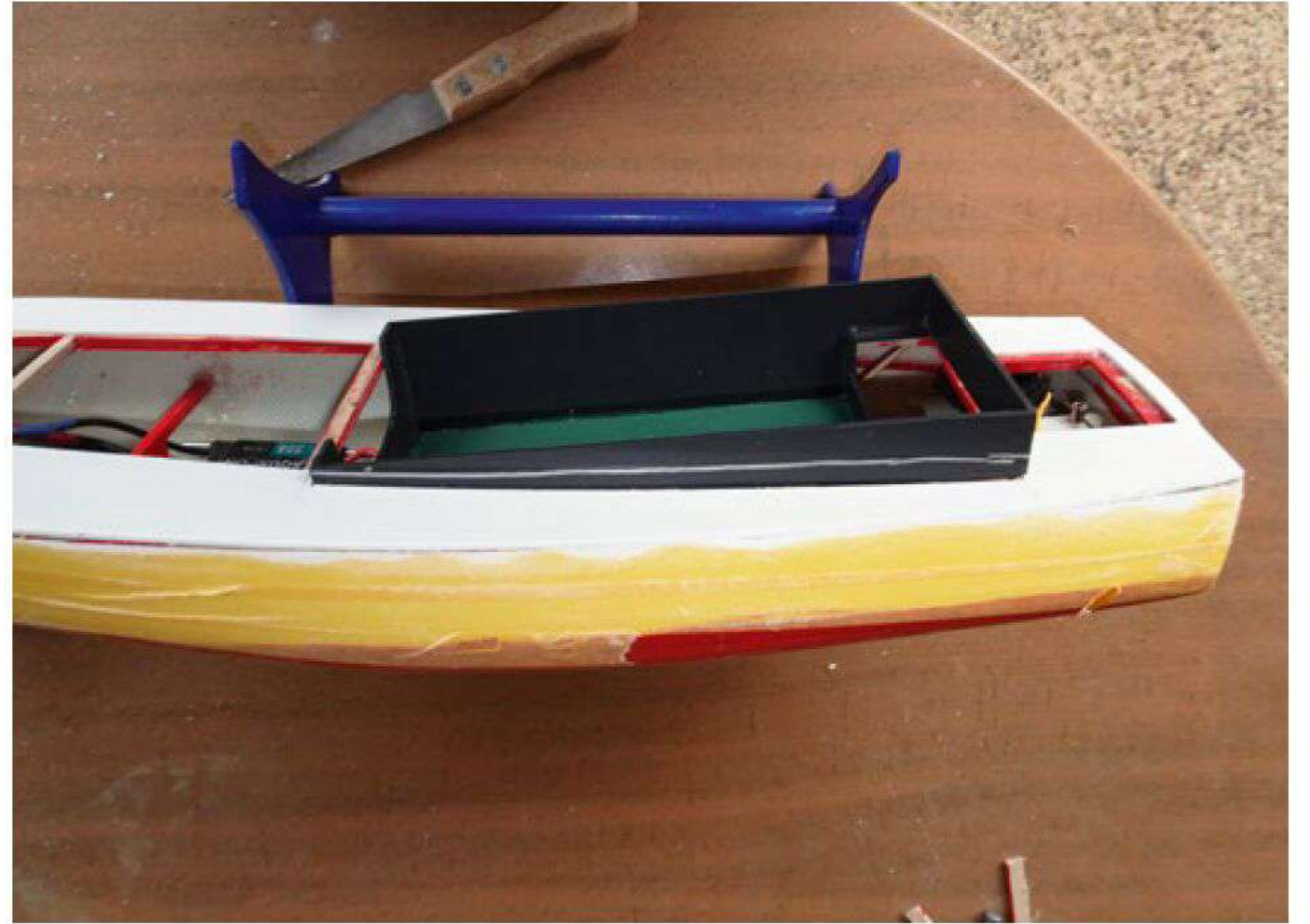
Vor dem Verschleifen der Decks wird der Rumpf mit Klebeband geschützt. Die Seitenwände der Plicht wurden passend abgesägt
