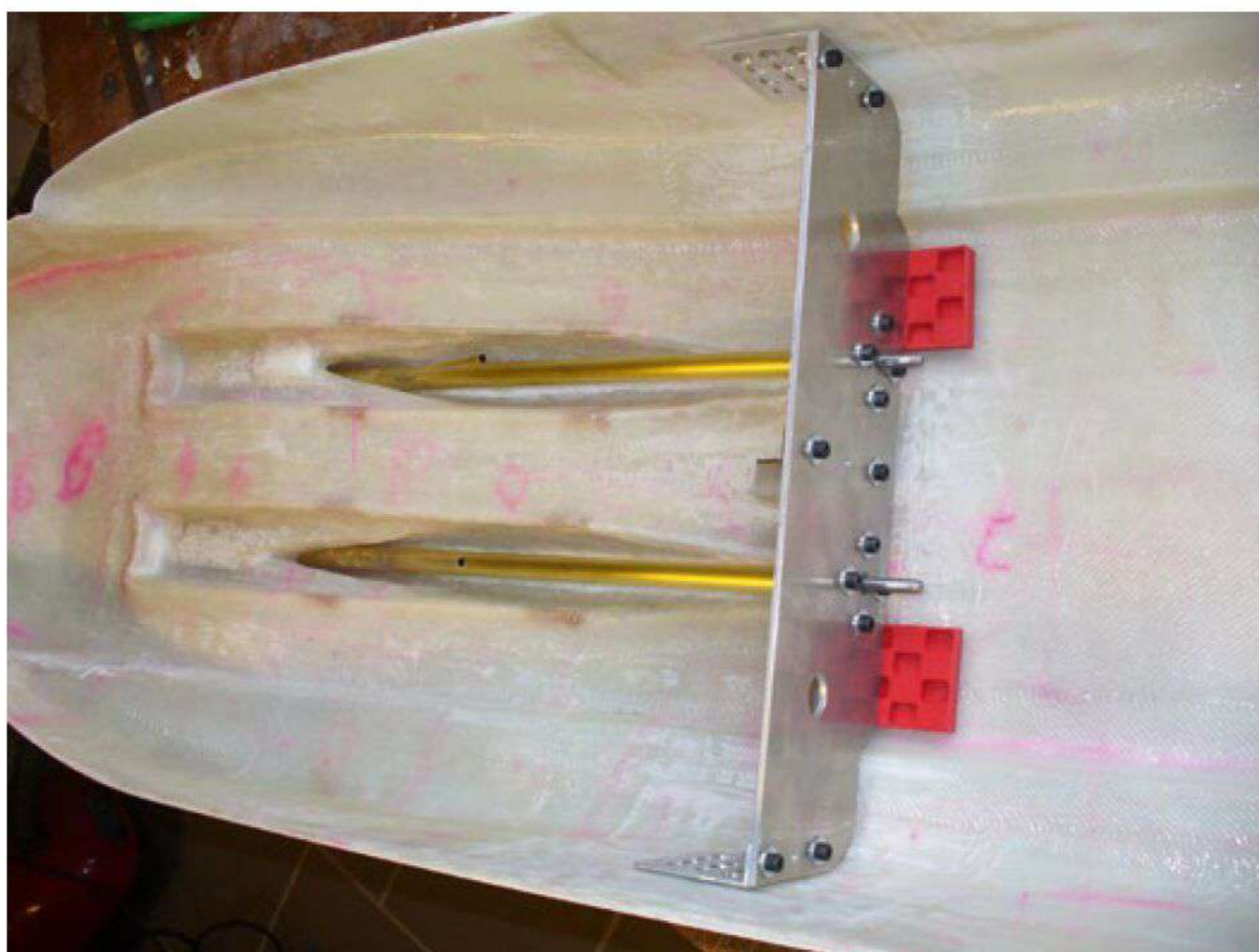
Der Motorträger wurde zusammen mit den Stevenrohren eingebaut
