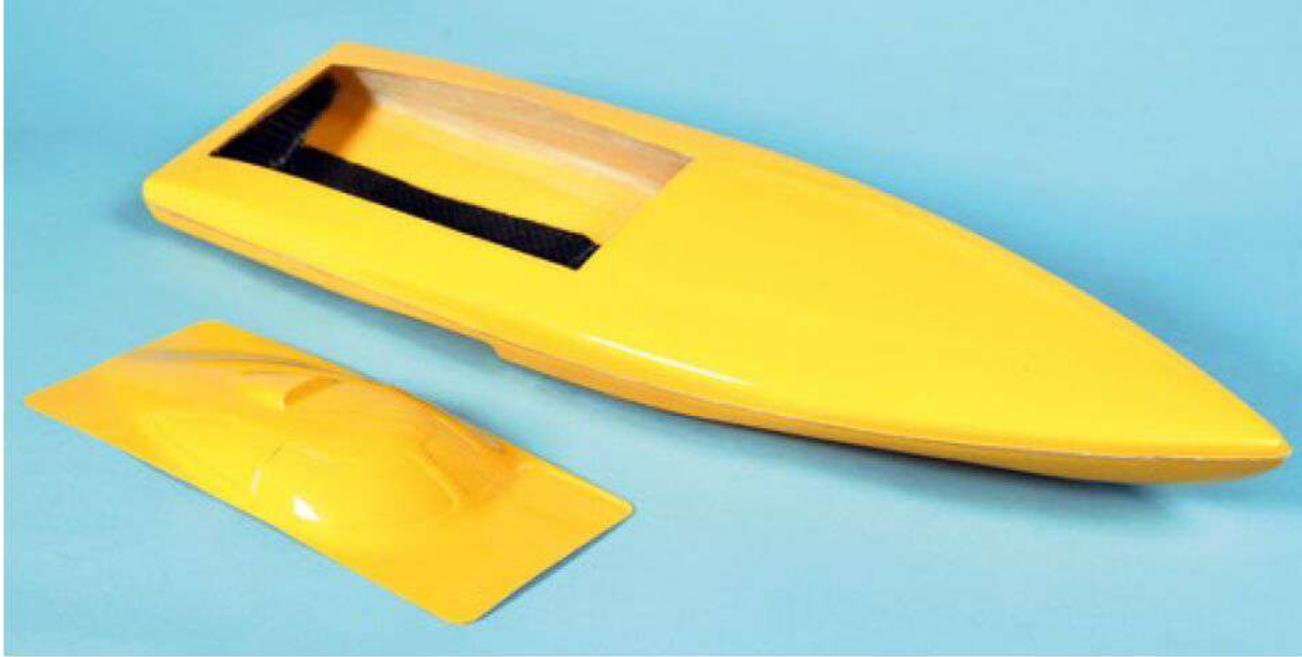
Der GFK-Rumpf der TIBURÓN mit eingefärbter Gelcoat-Schicht
