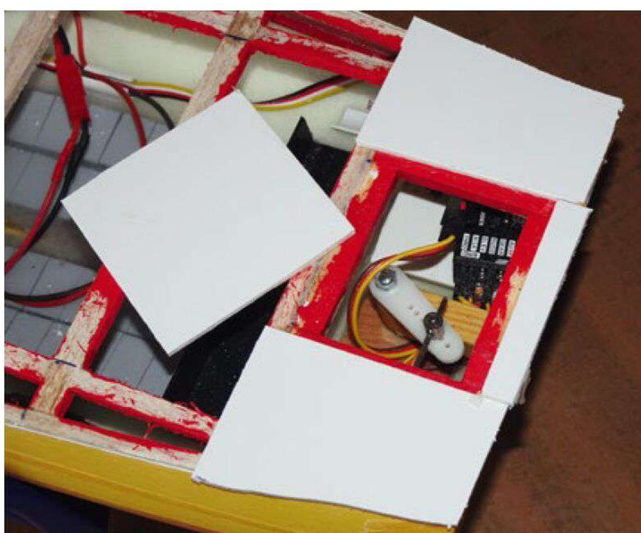
Das Achterdeck mit dem großen Ausschnitt über der Ruderanlage wird aus mehreren Teilen aufgebaut
