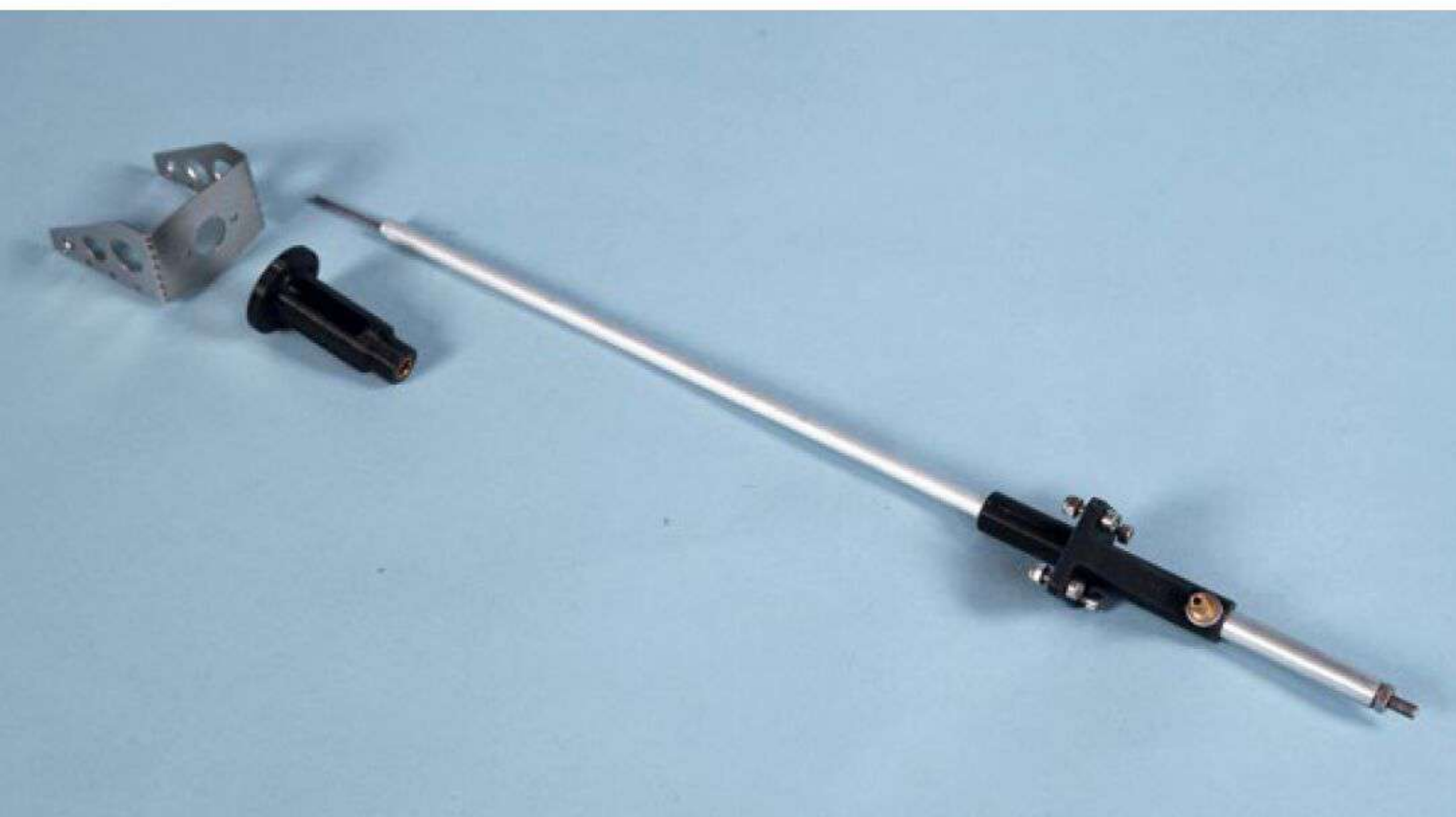
Die Wellenanlage mit Motorhalterung und Rumpfdurchführung
