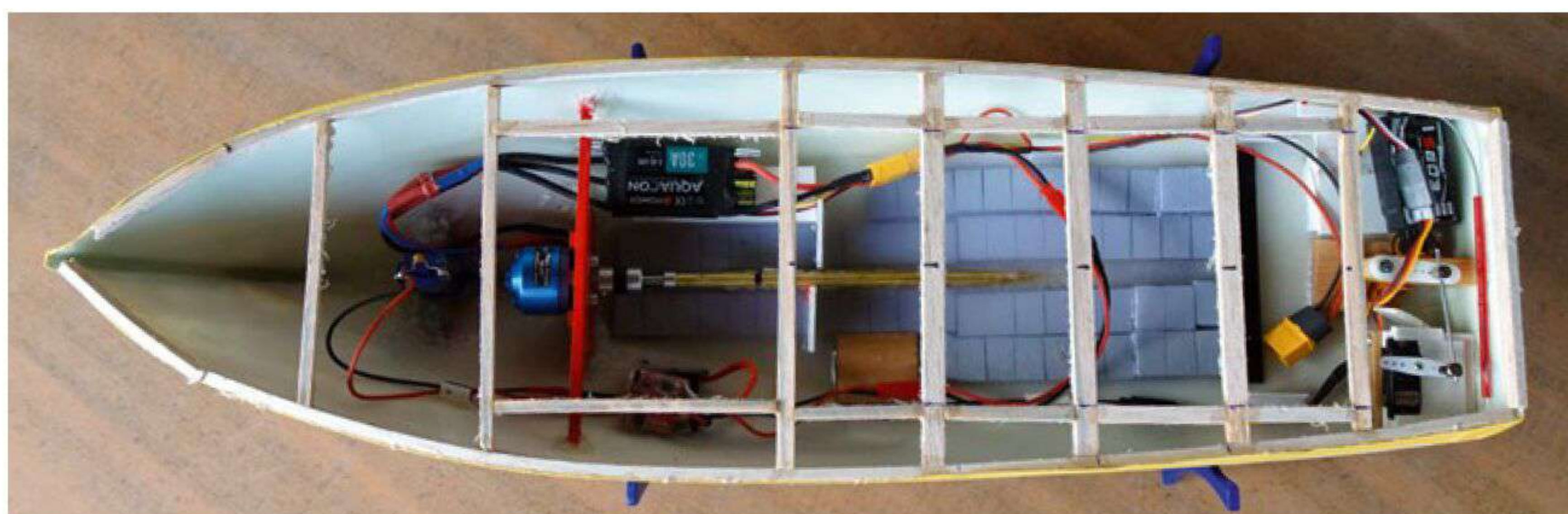
Die Auflagen für die Decks werden eingeklebt. Zuerst die Querstreben, dann werden die Längsstreben in Einzelteilen entlang der Ausschnitte für die Plicht und den Zugang unter den Aufbauten eingesetzt
