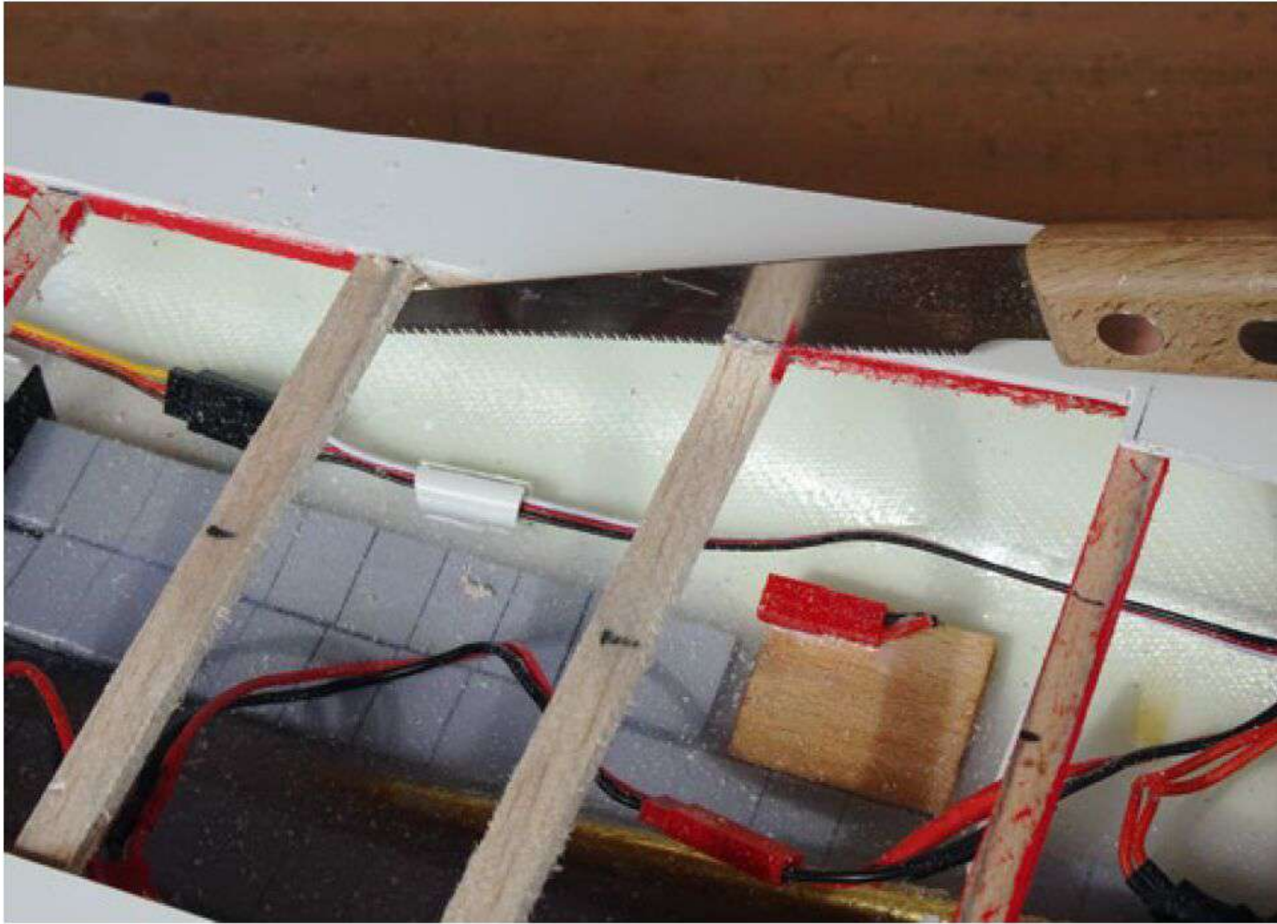
Nachdem die Seitendecks eingeklebt sind, werden die Unterzüge im Bereich der Plicht wieder ausgesägt
