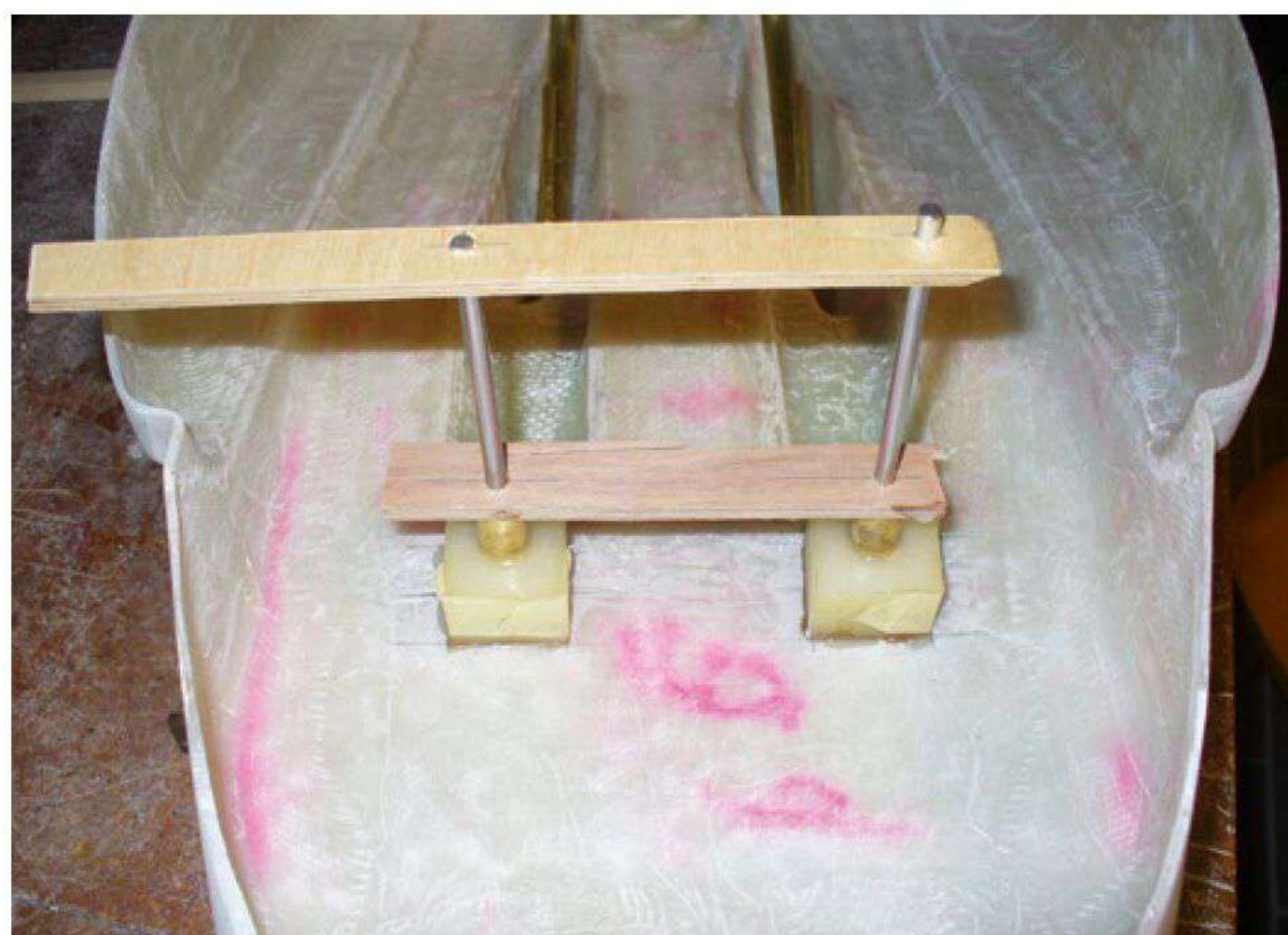
Für die Ruderachsen wurden zwei Fundamente mit angedicktem Harz ausgegossen
