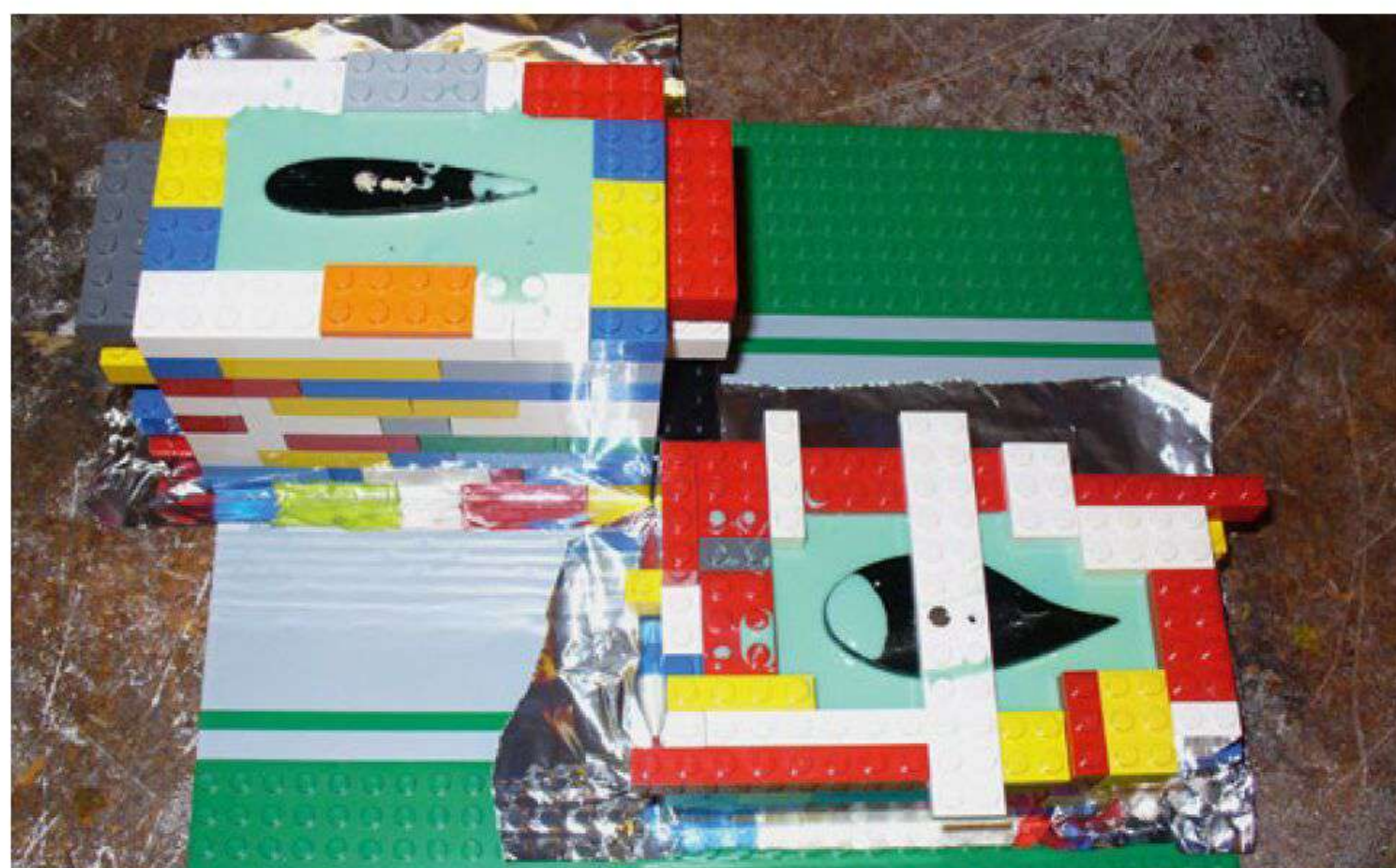
Die Silikonformen für die Ruder sind augenscheinlich selbst gebaut
