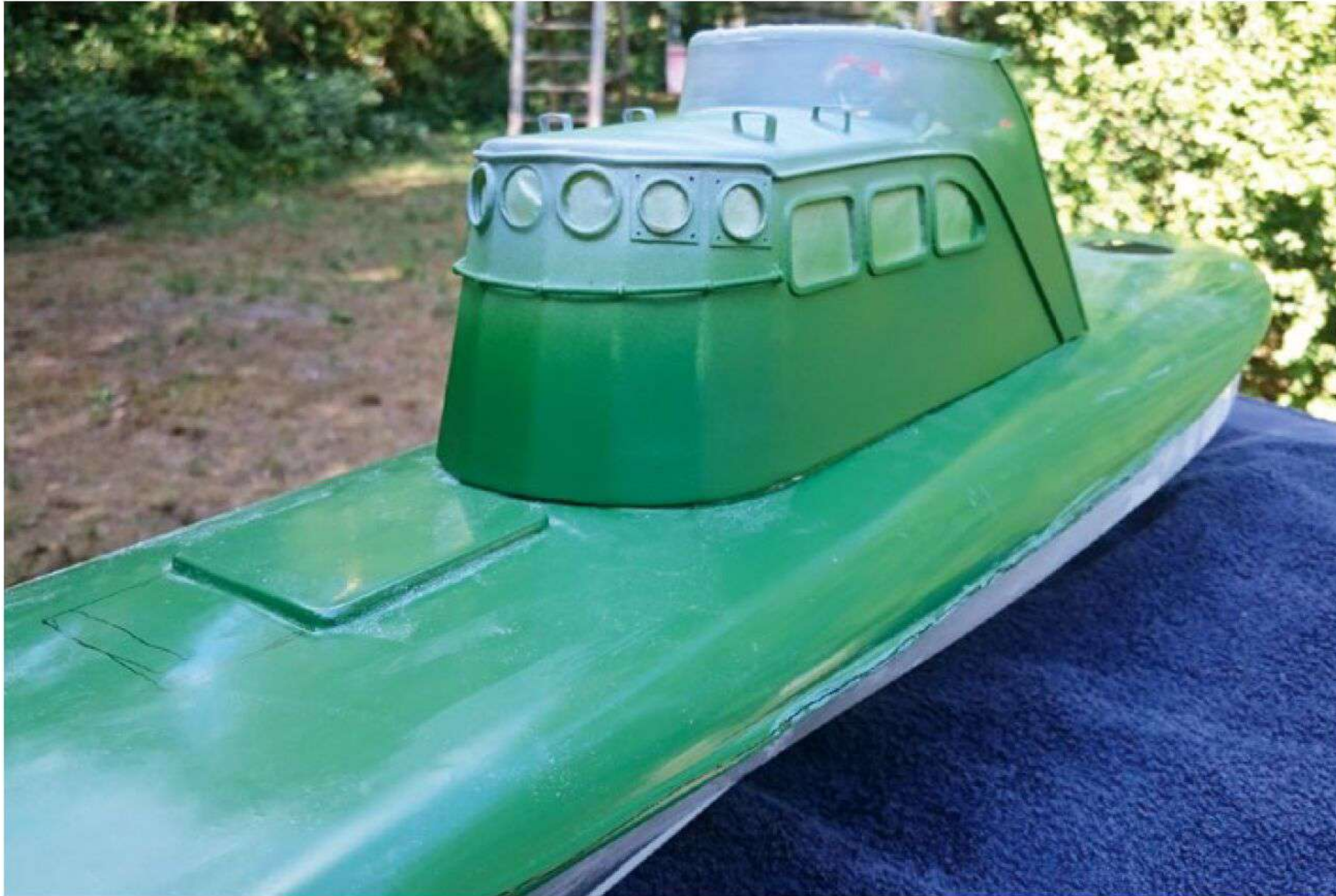
Der Aufbau entstand komplett aus Resten von ABS-Platten
