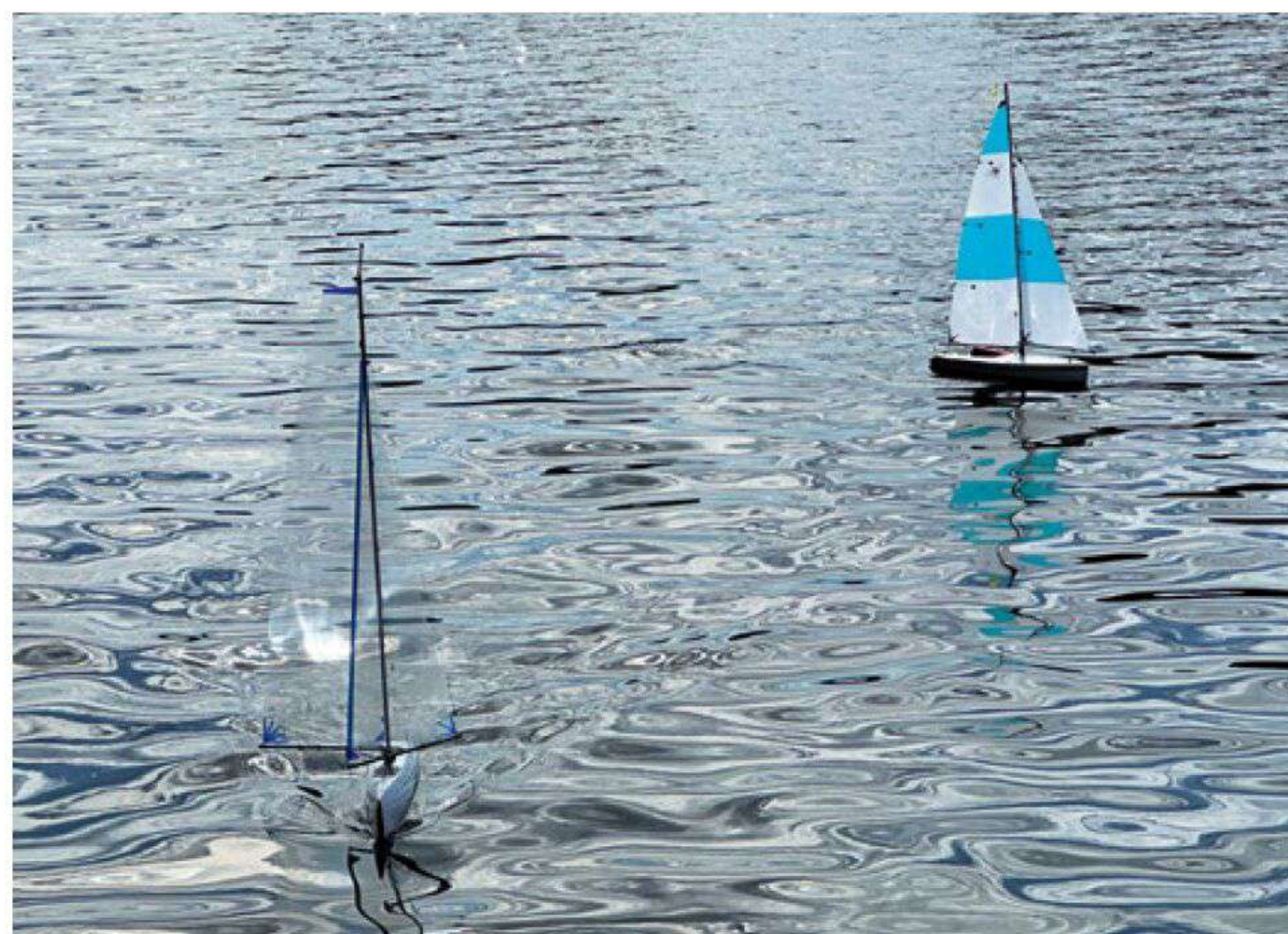
Wo sind die Segel? Die laminierten Profilsegel benötigen für die Sichtbarkeit horizontale Streifen
