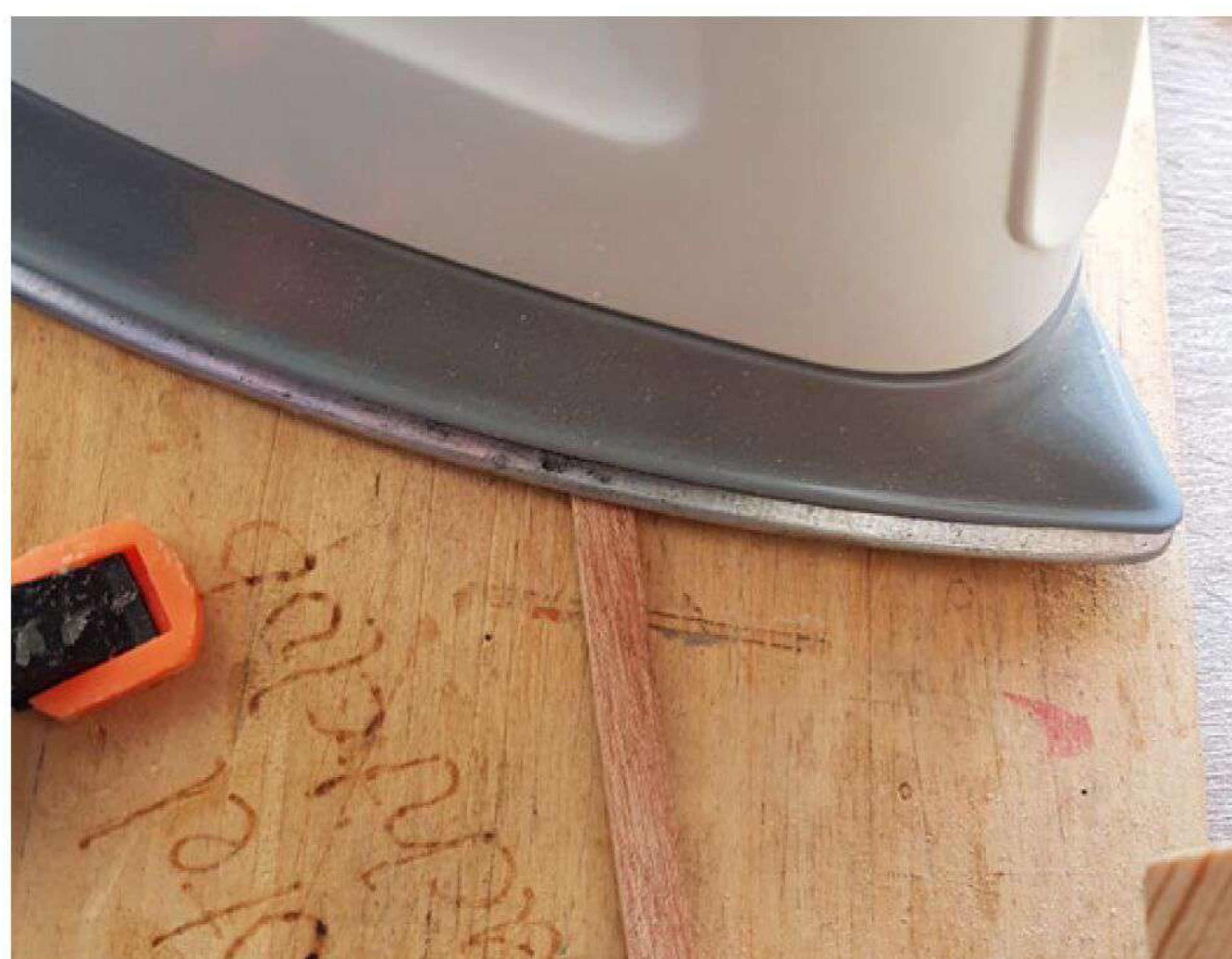
Mit einem alten Bügeleisen werden die gewässerten Planken gebogen
