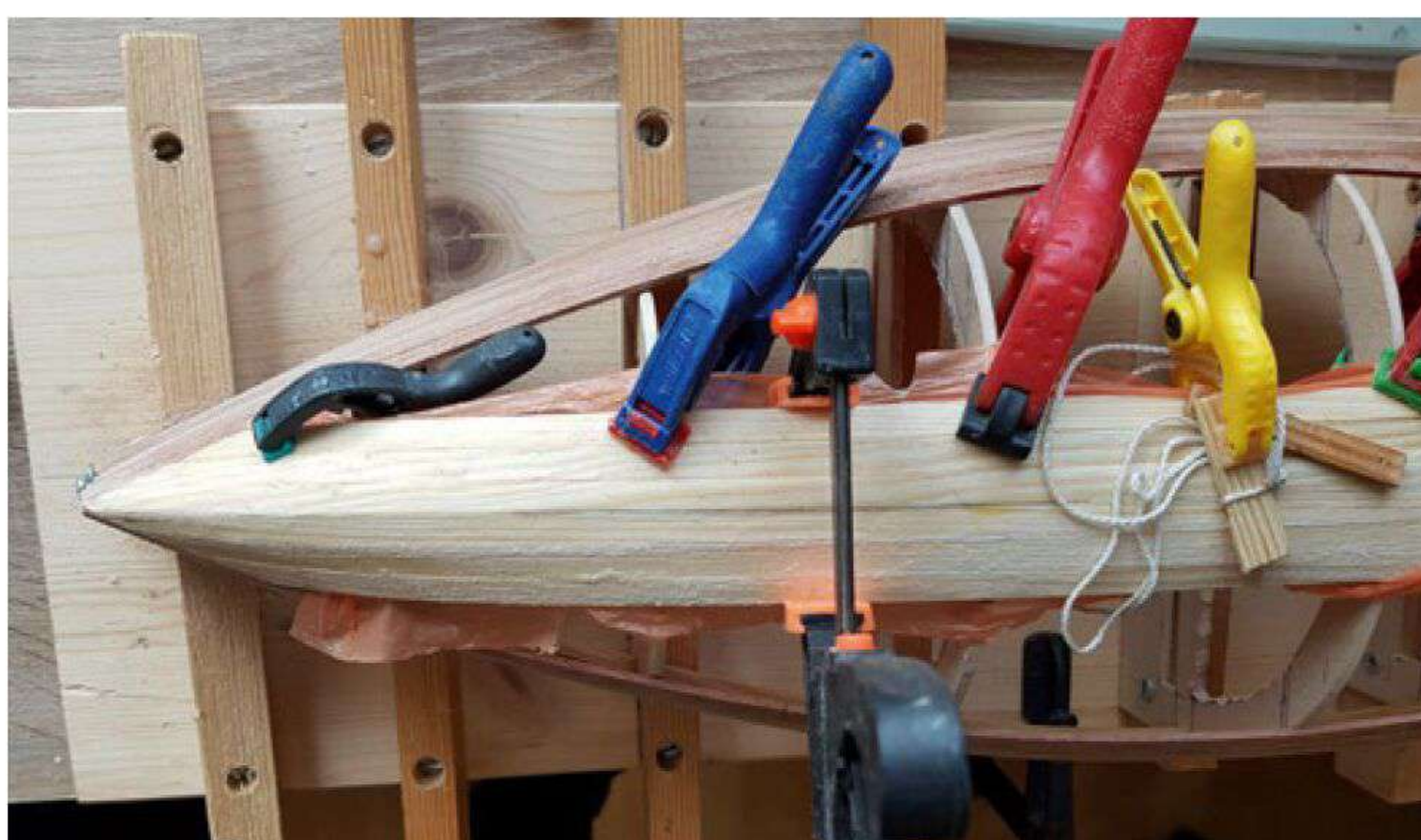
Das Unterwasserschiff wird nicht mit Mahagoni beplankt, da es lackiert wird
