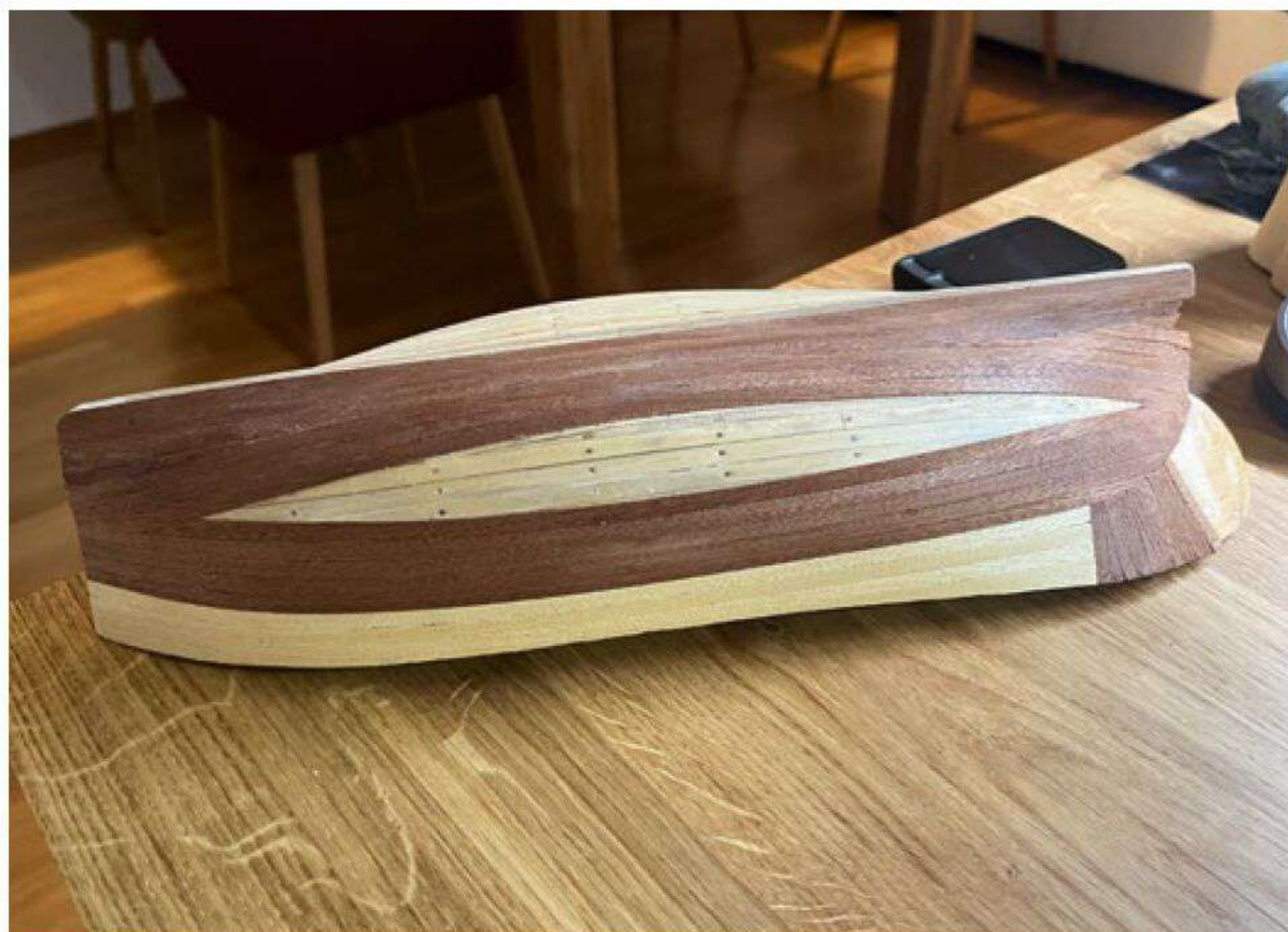
Zusätzlich wurde der Rumpf mit Streifen aus Sapelli-Holz beplankt
