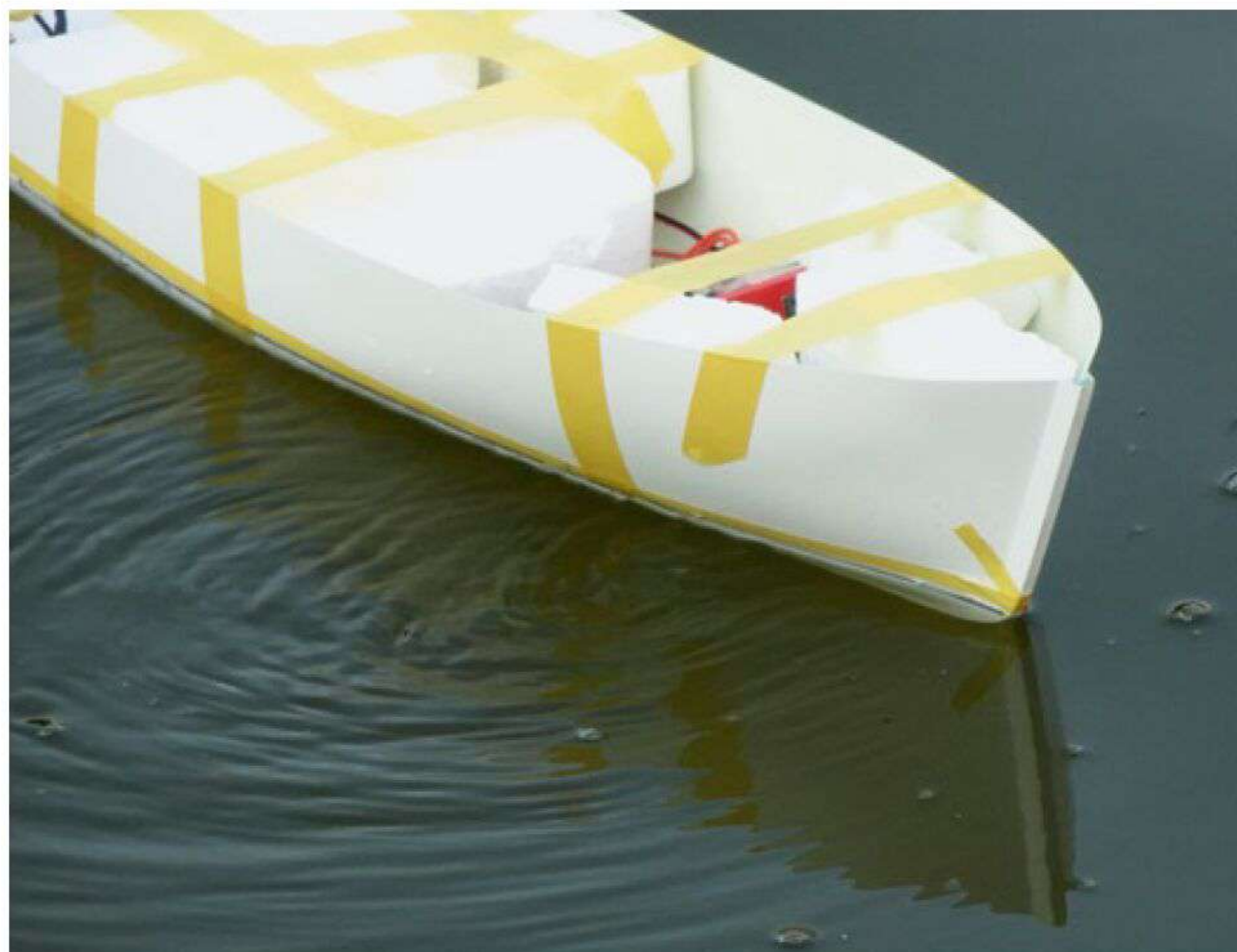
Bei nur zwei Zellen erzeugt der kleine Bugstrahler zu wenig Druck, um das Boot mit Aufbauten bei Wind zu drehen
