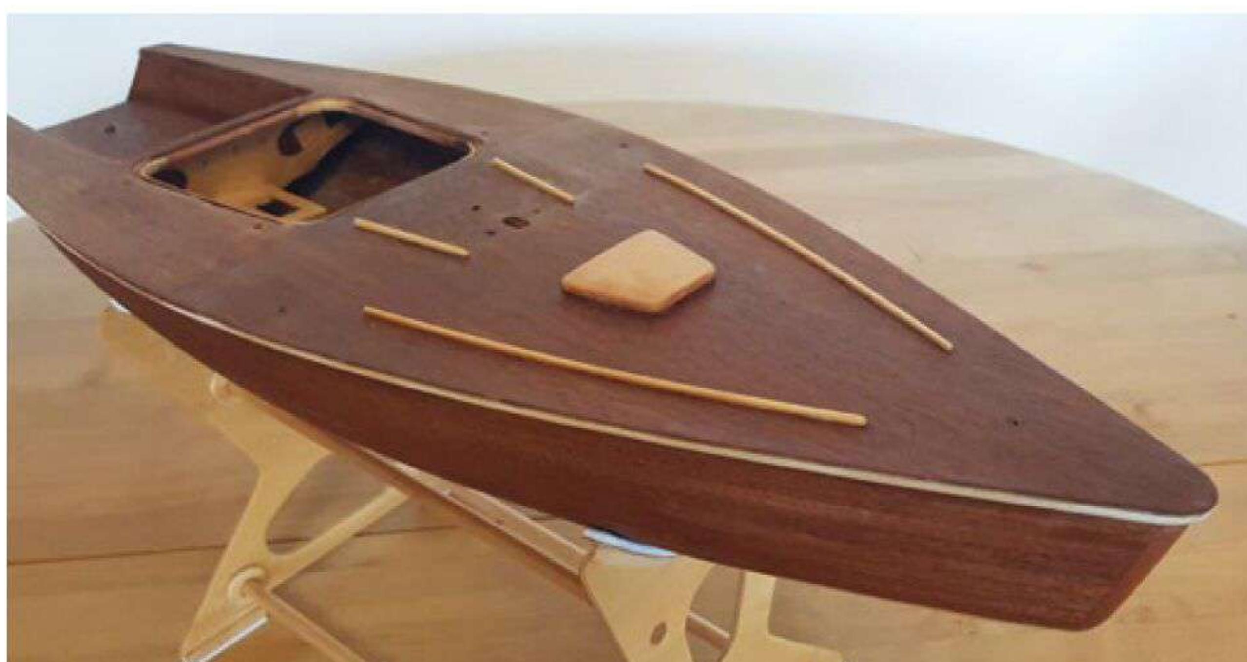
Zum Abschluss des Rumpfbaus wird das Deck aufgeklebt
