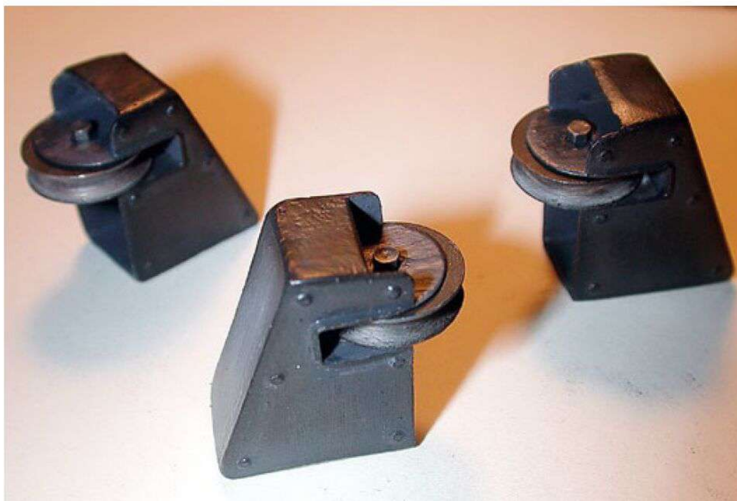
Die Umlenkrollen wurden aus Polystyrol und Metall selbst gebaut
