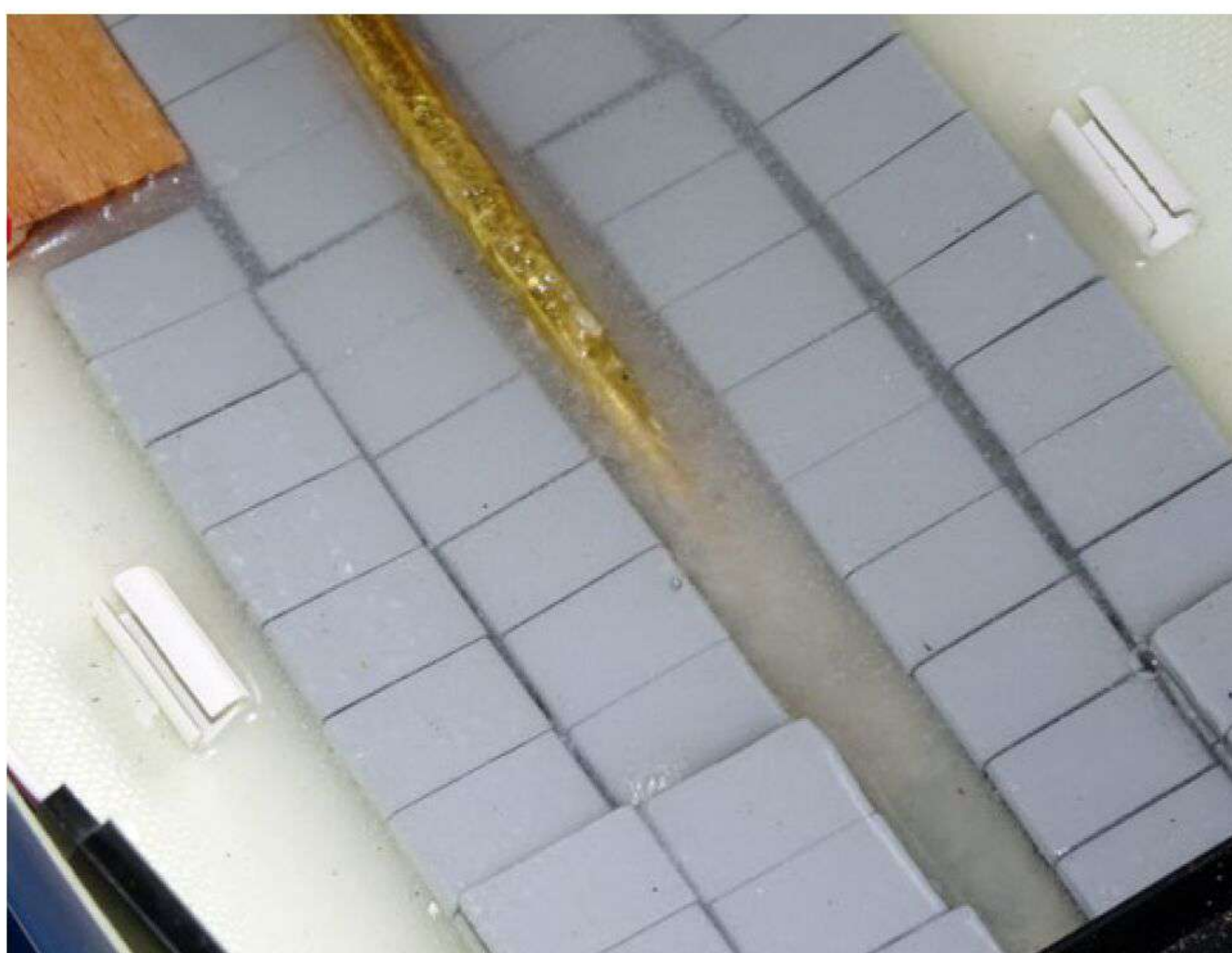
Felgengewichte aus der KFZ-Werkstatt sind die idealen Trimmgewichte für den Schiffsmodellbau
