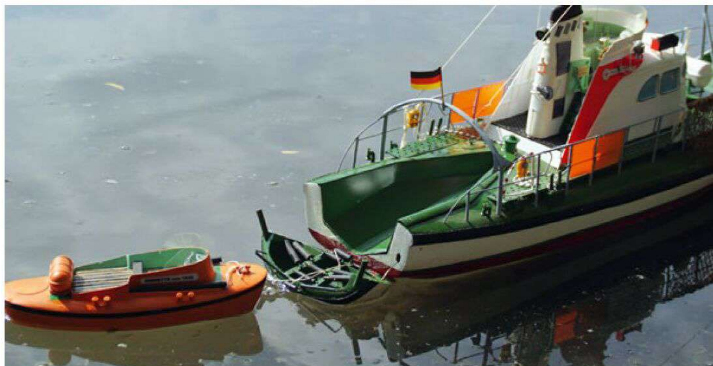
Wenn die Heckklappe geöffnet wird, gleitet das Tochterboot ins Wasser
