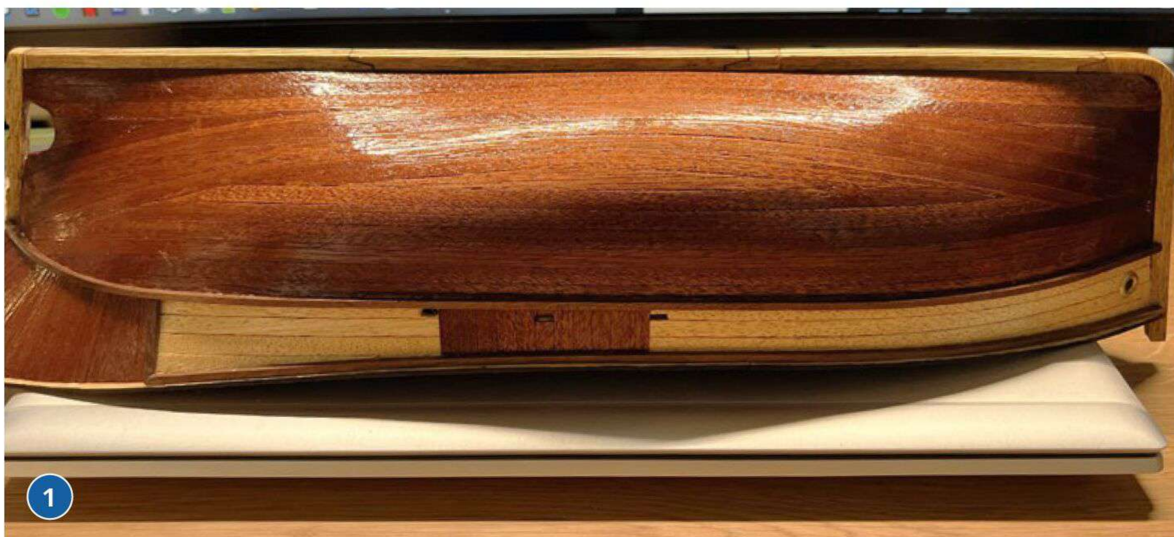
1) Die Versiegelung des Rumpfs mit Bootslack von Clou sieht gut aus und hält dicht. 2) Die Ausstattung mit den beiliegenden Beschlagteilen hat Spaß gemacht
