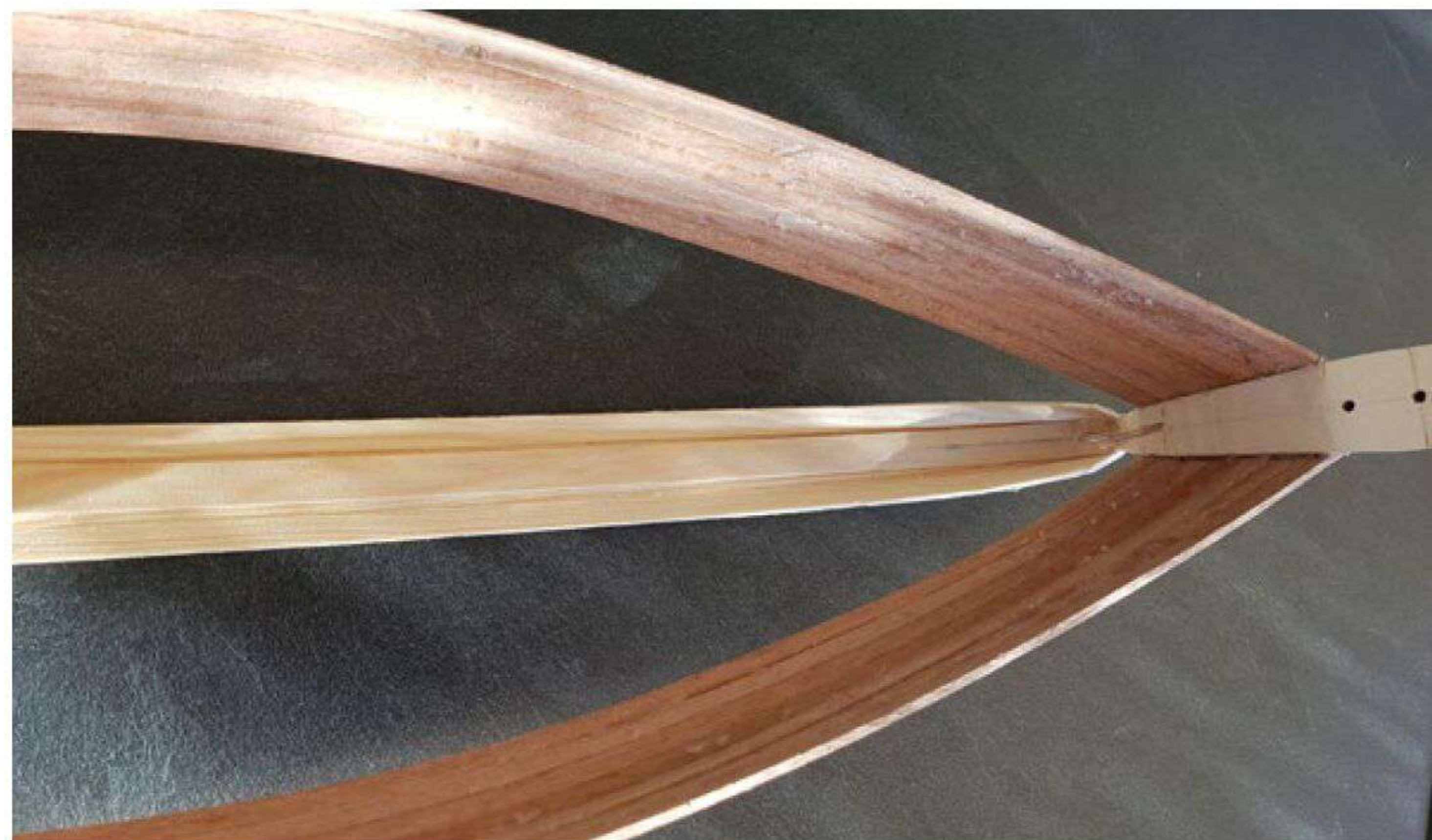
Wenn der Stevenklotz abgeschraubt wird, kann der Rumpf vorsichtig abgenommen werden
