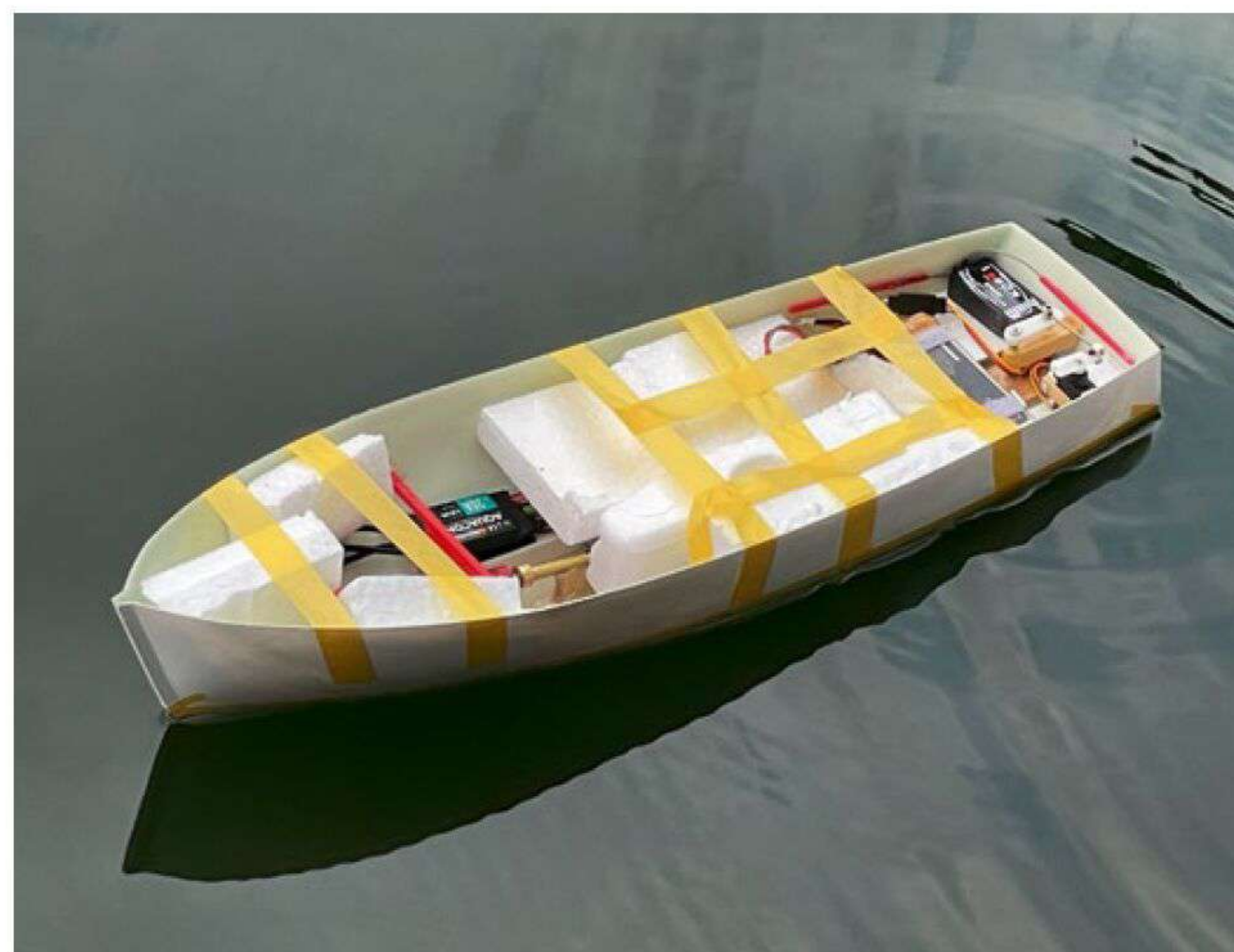
Optisch eine Katastrophe, aber sicher ist sicher. Ohne das Deck hat die Barkasse einige Styroporklötze bekommen, die dafür sorgen sollen, dass es unsinkbar bleibt
