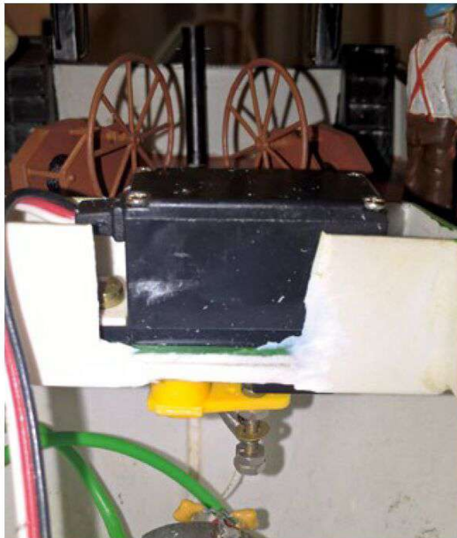
Mit einem Servo können die Koppelseile federnd auf Spannung gehalten werden. Die Fotos zeigen die beiden Endstellungen
