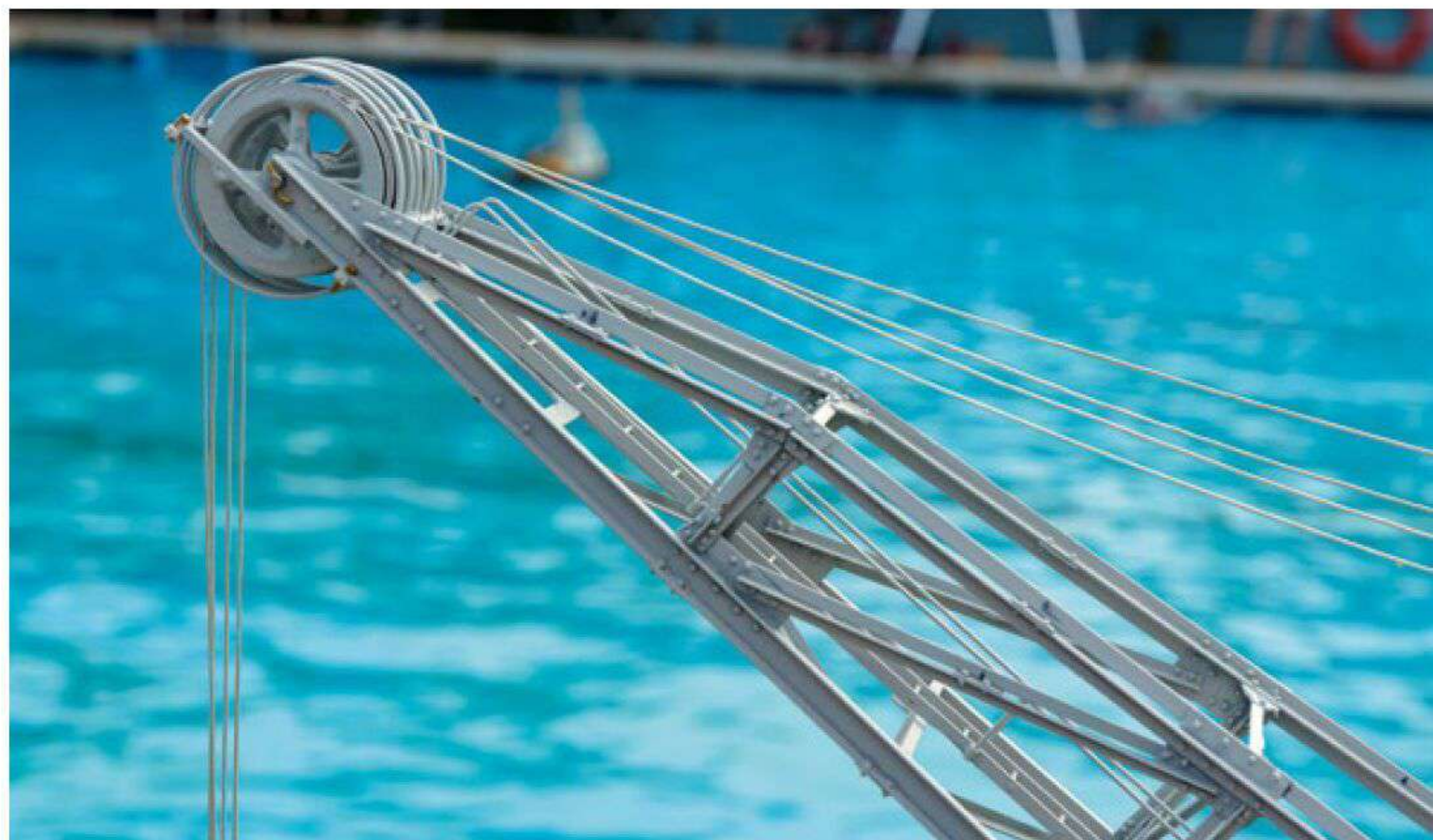
Viele Verbindungen am Ausleger sind nicht gelötet, sondern wirklich genietet
