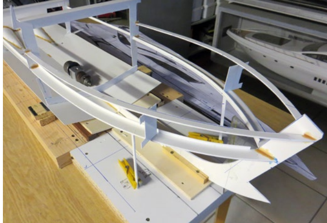
Ausgehend von der Grundplatte wird ein Gerüst von Längsspannen aufgebaut
