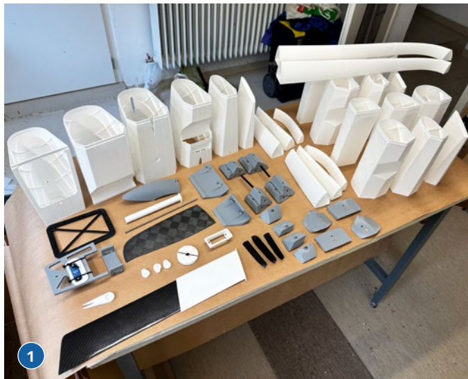
1) Der gesamte Teilesatz hat eine Druckzeit von 4 bis 5 Tagen. Ruder und Schwert werden konventionell gebaut, in diesem Beispiel aus Carbon. 2) Das fertige Boot mit der Baunummer 2 und der Segelnummer GER 26
