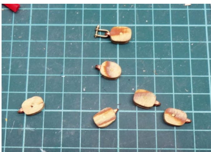
Die Blöcke wurden ebenfalls aus Holz, Kupferstreifen und Messingrollen selbst gebaut
