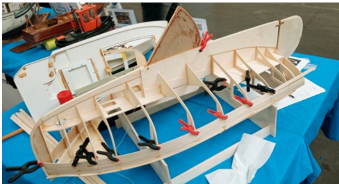
Auf der Messe in Erfurt wurde begonnen, das Boot zu beplanken
