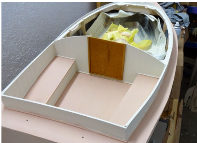
Im Gegensatz zum Bausatz wurde der Zugang zur Kajüte aus gebeizten Lindenholz gefertigt
