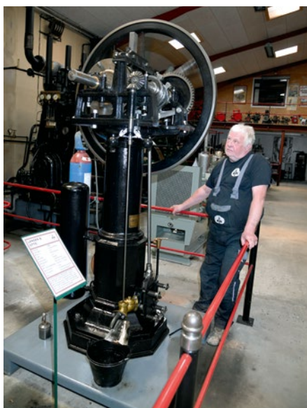
Der atmosphärische Gasmotor von Otto und Langer, den Gründern von Deutz
