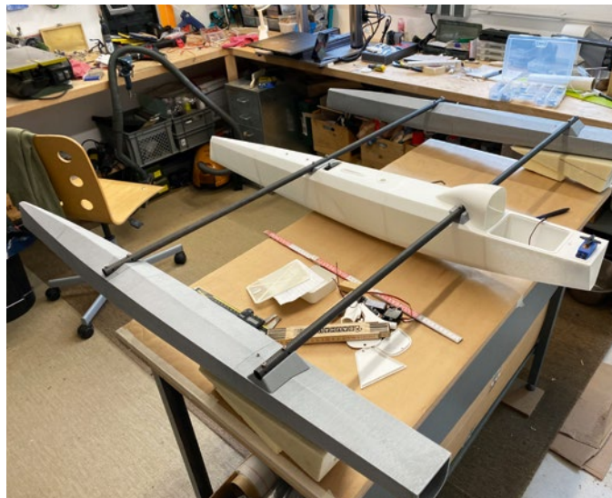
Die Rumpfe wurden mit 16-mm-Karbonrohren als Beams verbunden
