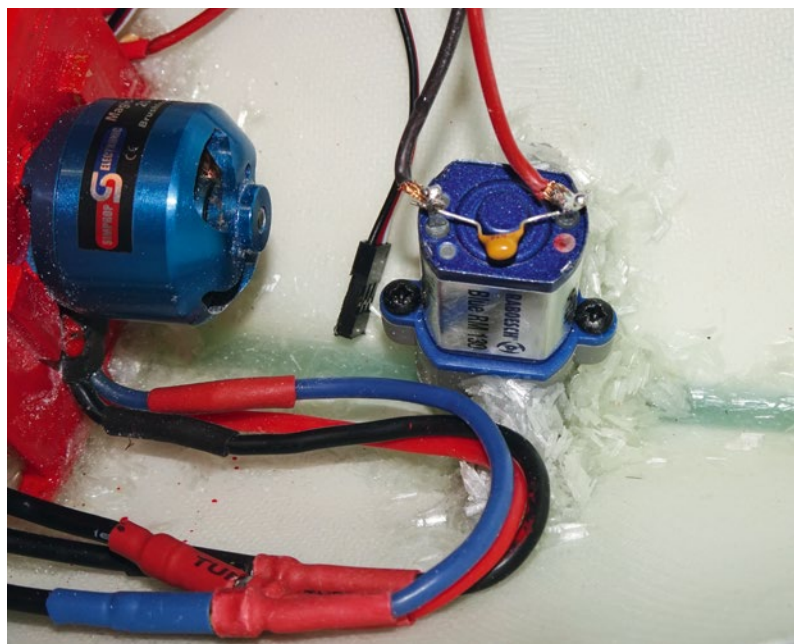
Vor dem Antriebsmotor und im recht engen Bug hätte ein größeres Strahlruder keinen Platz gehabt
