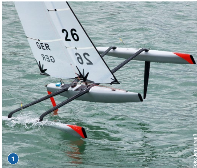
1) Ein Mini40-Trimaran, eine SHINOBI hoch am Wind. Das blaue GPS auf dem Mittelrumpf maß eine Höchstgeschwindigkeit von 11,3 kn. 2) Ein Vollkarbon-Boot MOD40, der vielfach gebaute Entwurf des Autors
