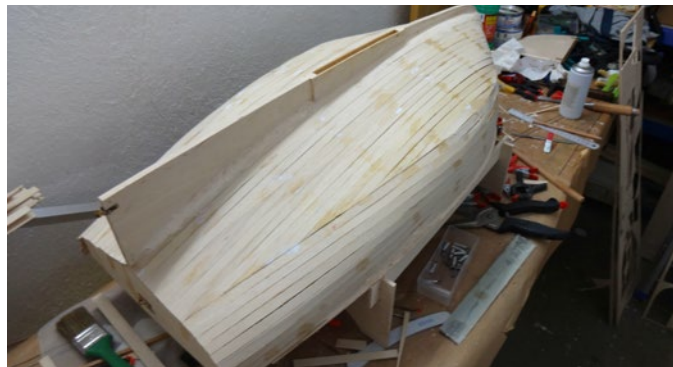
Da der Rumpf noch mit GFK überzogen wird, spielen die Spalten keine Rolle
