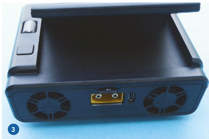
3) Auf der Rückseite wird die Spannungsquelle über einen XT-90-Stecker angeschlossen, außerdem befindet sich dort der USB-Port und der SD-Karten-Slot sowie zwei Lüfter. 4) Sämtliche Akkuanschlüsse befinden sich auf der Frontseite
