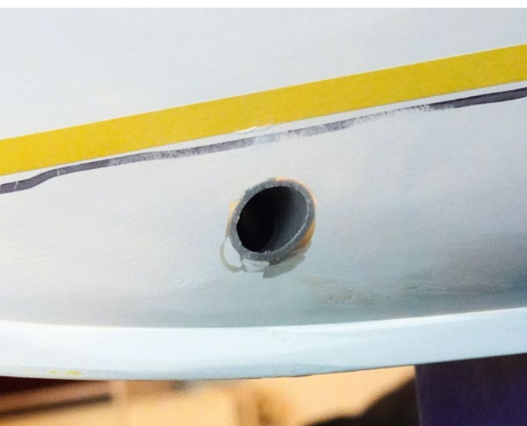
Nach dem Verschleifen und Spachteln der Rohre fügt sich das Bugstrahlruder harmonisch in die Rumpflinie ein
