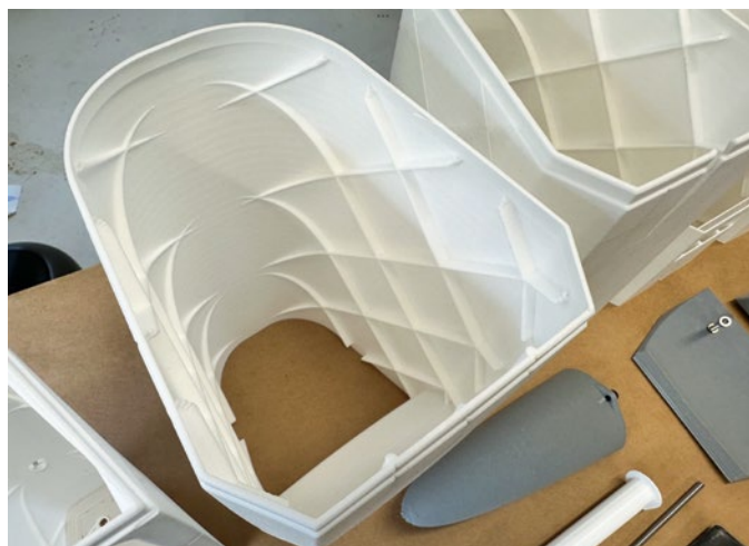
Die kreuzweisen Stringer versteifen die Rumpfschale und sind konstruktiv einfache Schnitte in den Volumenkörper des Rumpfsegmentes
