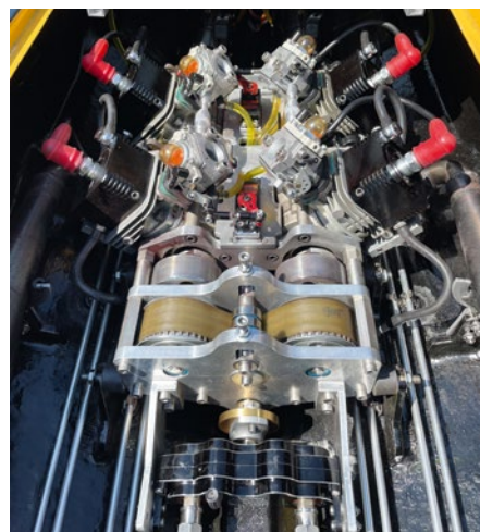
Im Inneren der MUSCLE arbeitet ein Vierzylindermotor
