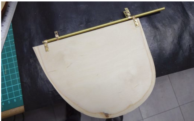
Das riesige Ruder wird mit Messigbeschlägen am Rumpf befestigt
