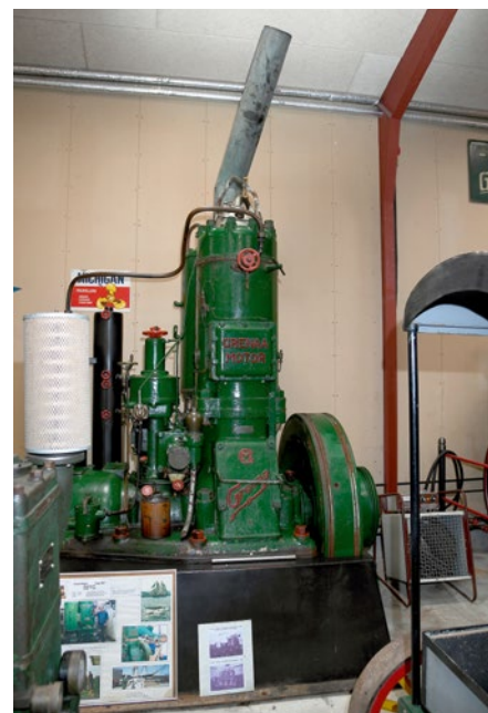
Ein Grenaa-Einzylinder, einst typisch für Fischerei- und kleine Frachtschiffe
