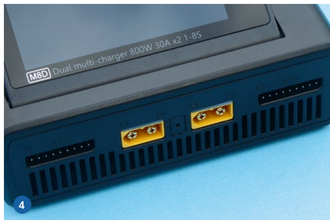
3) Auf der Rückseite wird die Spannungsquelle über einen XT-90-Stecker angeschlossen, außerdem befindet sich dort der USB-Port und der SD-Karten-Slot sowie zwei Lüfter. 4) Sämtliche Akkuanschlüsse befinden sich auf der Frontseite
