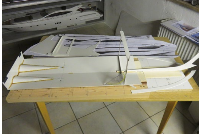
Der Bau beginnt auf einer V-Platte aus Holz als Grundform des Rumpfs
