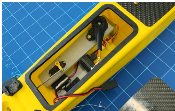
Auch die RC-Technik ist beim TRI65 simpel gehalten. Einfache Servos reichen aus
