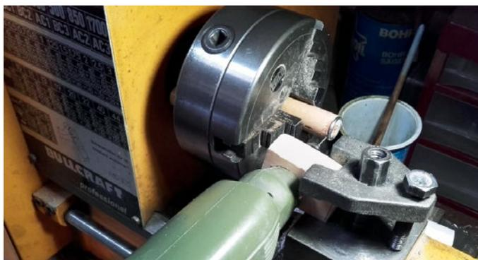
Der Reifen für das Steuerrad wurde in der Drehbank selbst angefertigt
