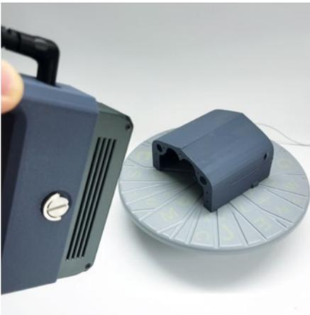
**Das Rumpsegment wird aus der Hand heraus im Easy-Mode gescannt. So kann aus unterschiedlichen Winkeln in einem Arbeitsgang gescannt werden. Das erfordert etwas Übung, um den richtigen Abstand zum Objekt einzuhalten**
