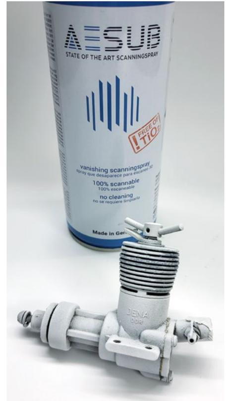
Mit dem Spezialspray wurde die glänzende Oberfläche des O.S.-Motors beschichtet. Nach gut vier Stunden löst sich diese Beschichtung rückstandsfrei von selbst auf
