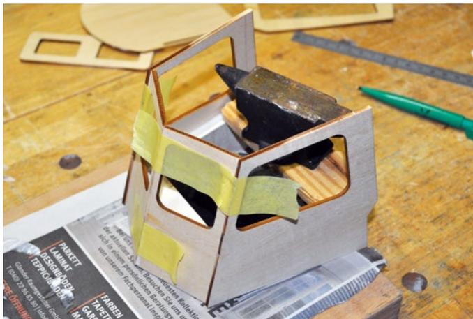
Wenn der Innenausbau des Steuerhauses gekürzt ist, passen die Außenwände perfekt zusammen
