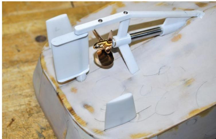
Das Stevenrohrlager und das Ruder sind Druckteile
