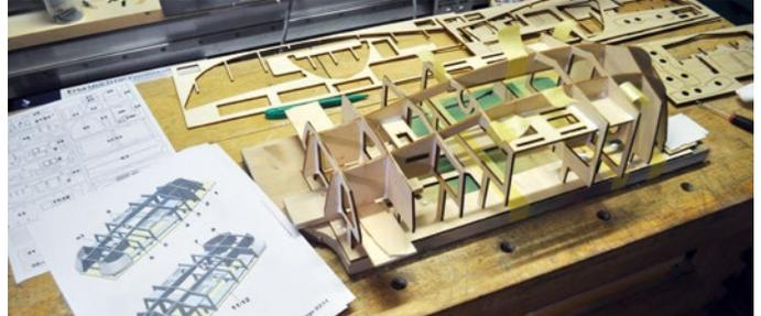
Das Spantengerüst ist aufgestellt und darf jetzt trocknen
