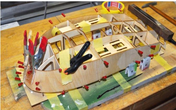
Die gebogenen Seitenteile werden aufgeklebt und zum Trocknen fixiert
