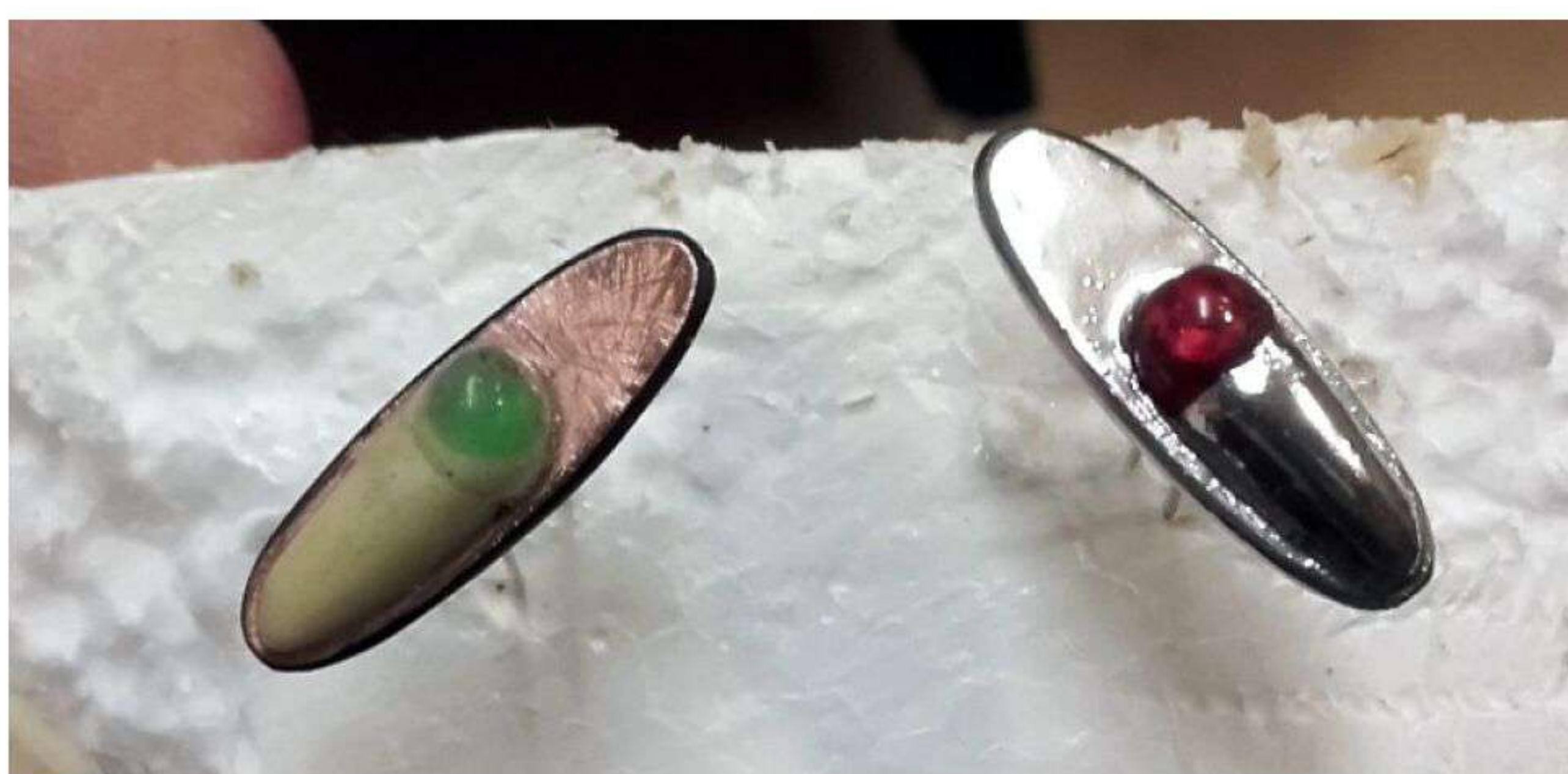
Die stromlinienförmigen Positionslampen wurden mit Liquid Chrome vom Molotow verchromt
