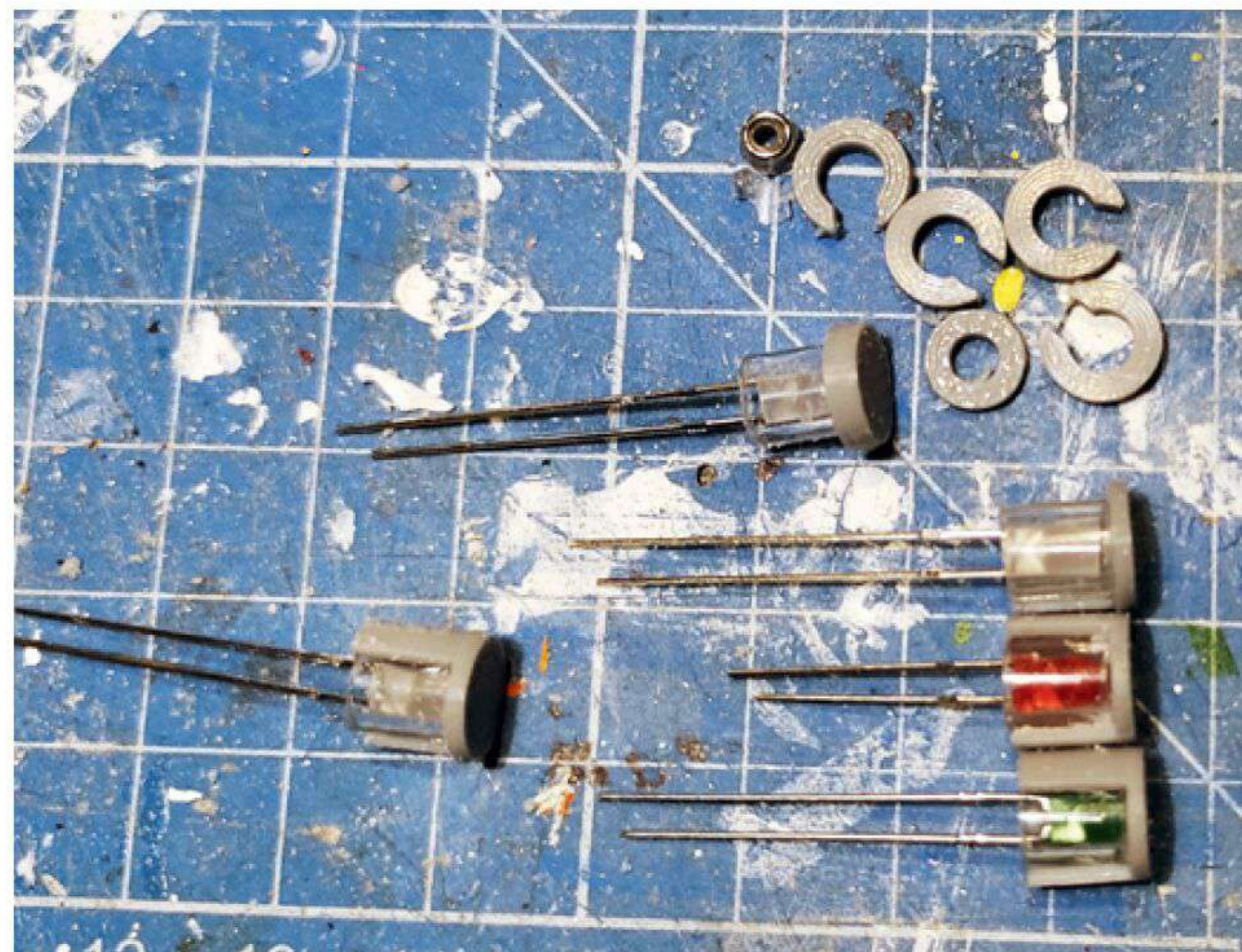
Die gedruckten Lampengehäuse werden auf die LEDs gesteckt
