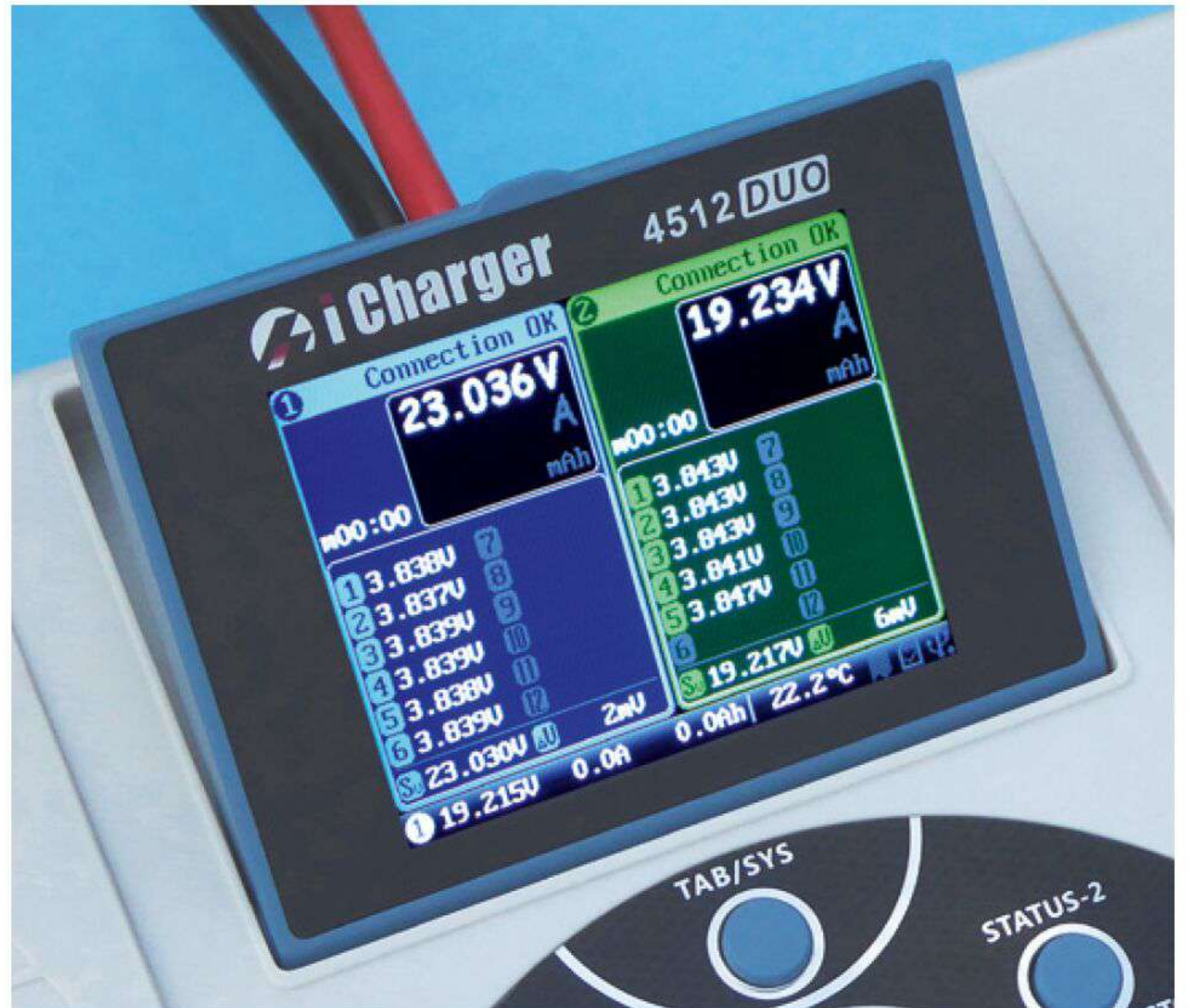
Das angewinkelte Display liegt gut im Blickfeld und lässt sich optimal ablesen, sämtliche Akkuanlüsse erfolgen auf der Frontseite
