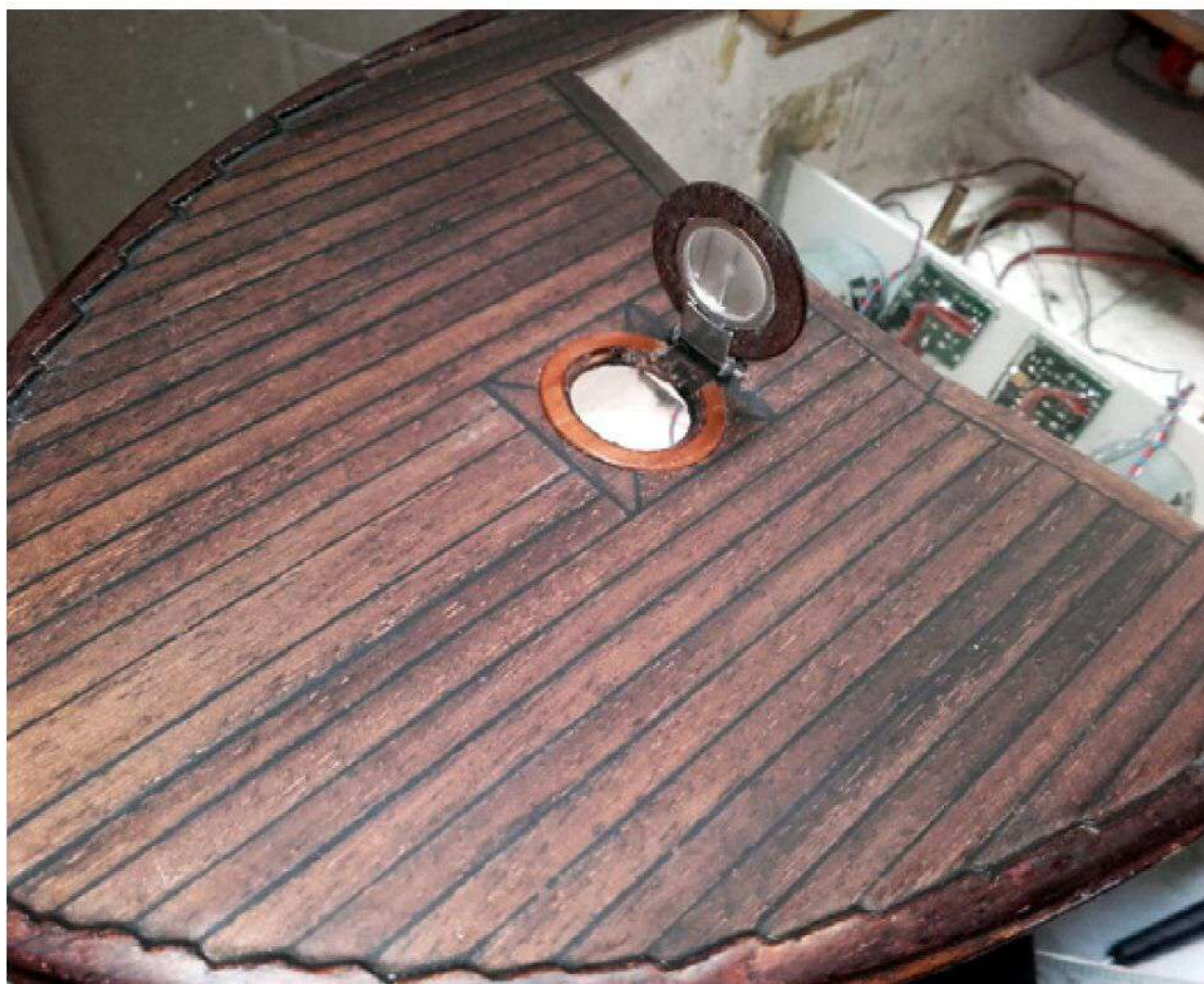
Unter der aufklappbaren Luke sitzt der Lautsprecher des Soundmoduls
