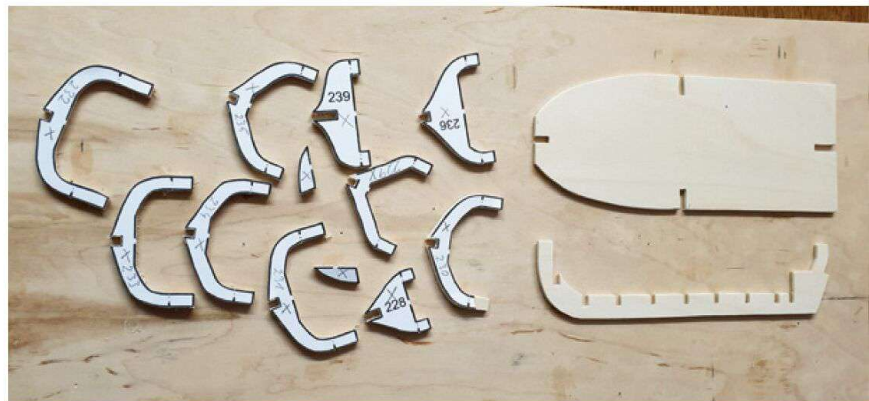
Ein vergrößerter Bauplan lieferte den Spantensatz für das Beiboot
