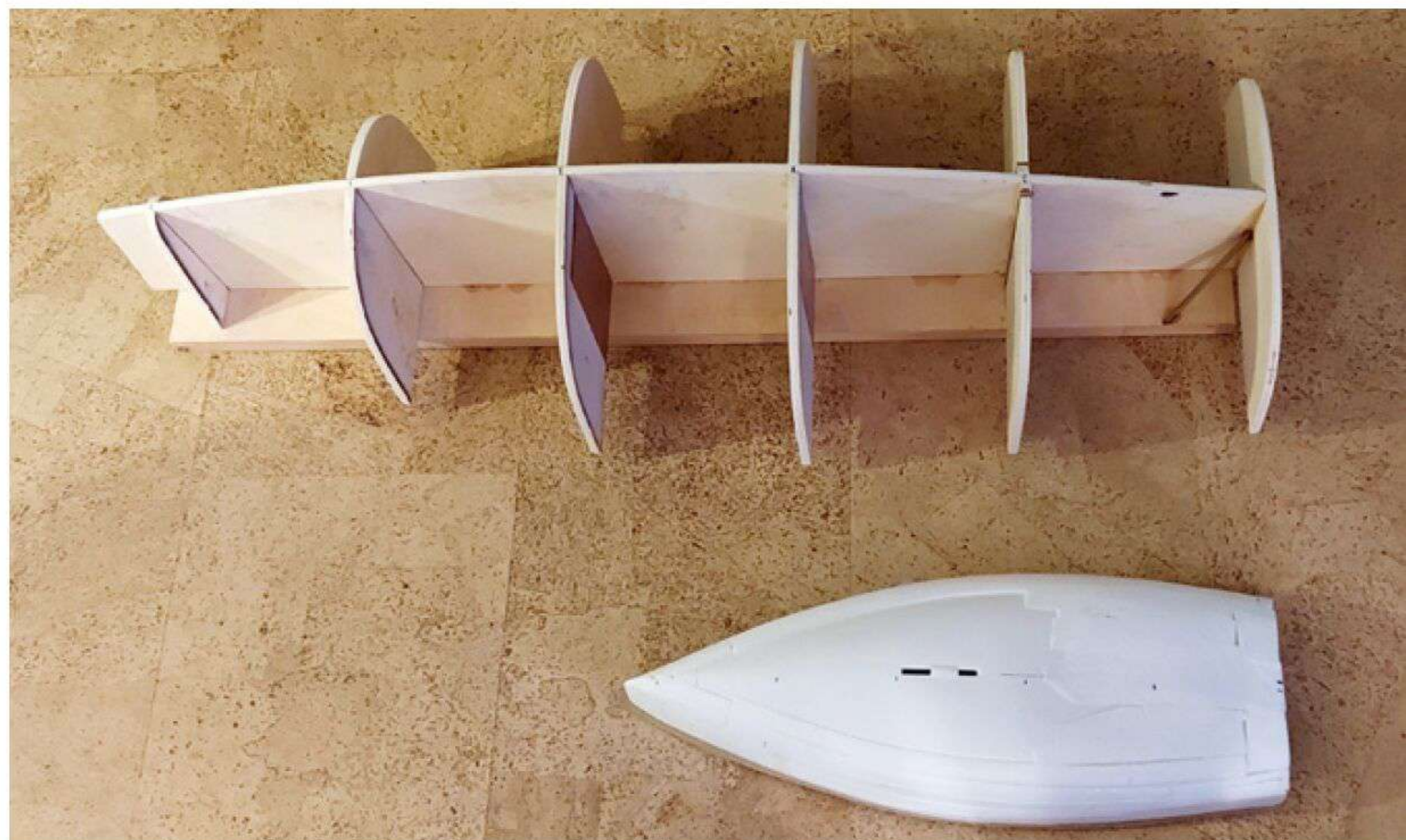
Die vergrößerten Spanten ergaben das Spantengerüst für den Prototypen
