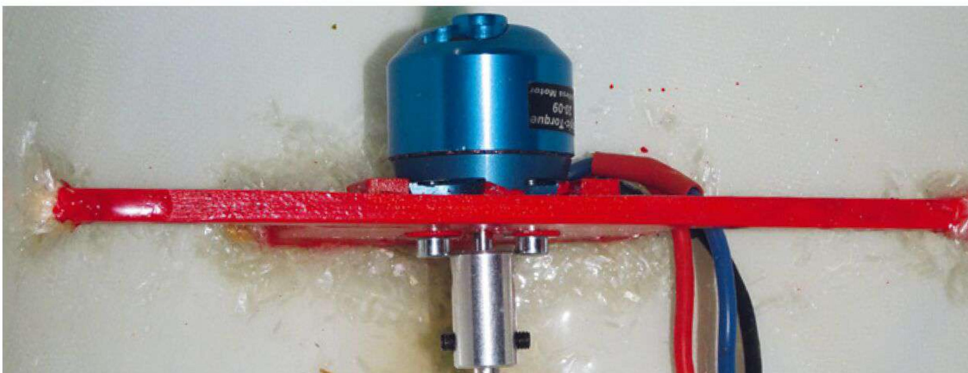
Der Motorspant ist zum Schutz gegen Wasser einmal grundiert und anschließend rot lackiert, um sicherzustellen, dass alle Stellen geschützt sind
