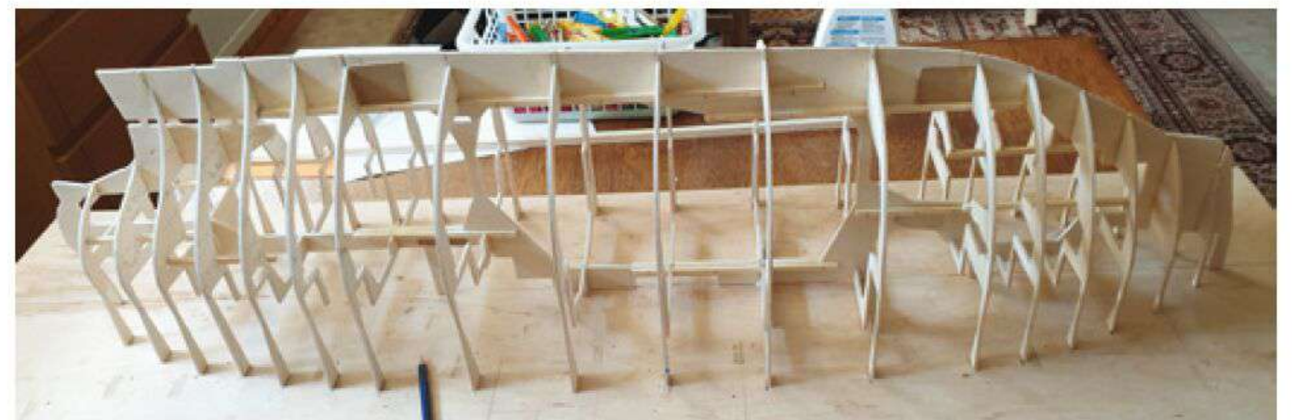
Das Spantengerüst steht auf Hellingfüßen, die hinterher gekürzt werden
