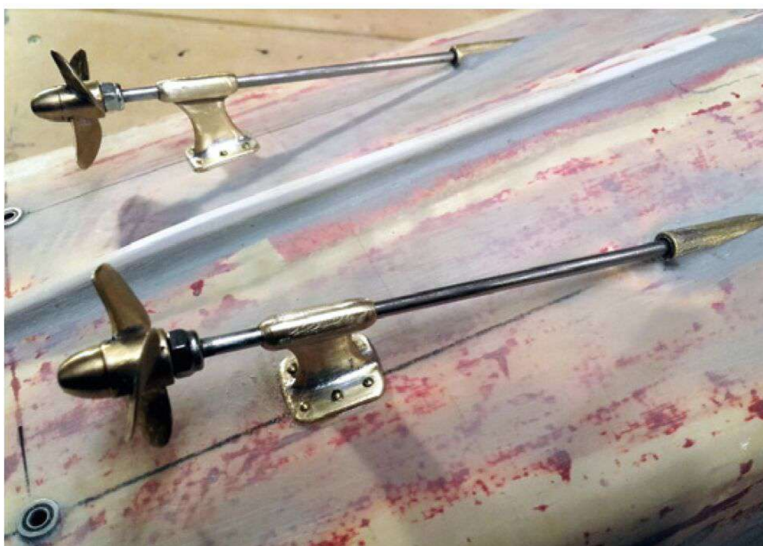
Die FOUR CSONS wird jetzt von zwei freilaufenden Wellen angetrieben
