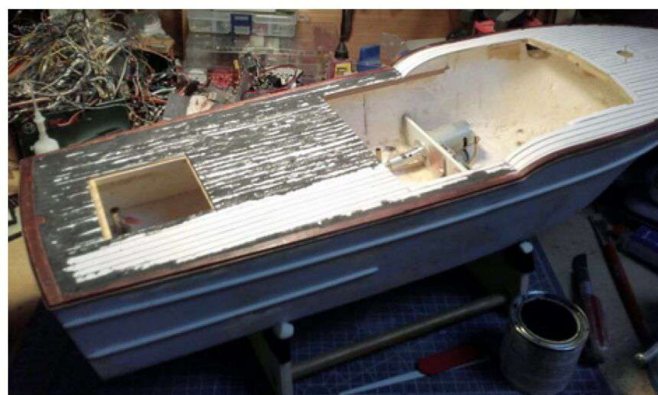
Als Kalfaterung wurde schwarzer Holzkitt auf das mit Papier beklebte Deck aufgetragen
