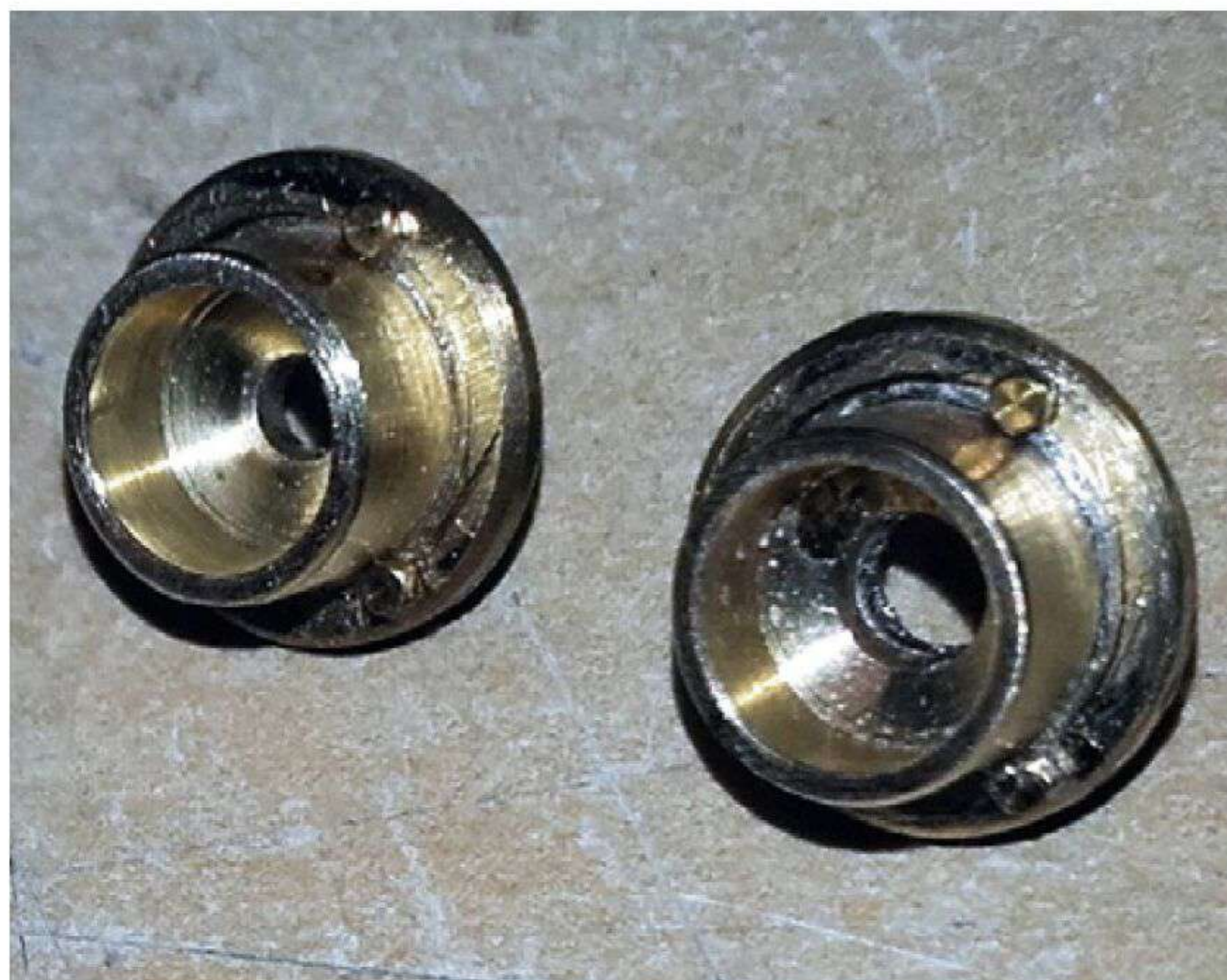
Die aus Messing gefertigten Abgasauslässe werden noch verchromt
