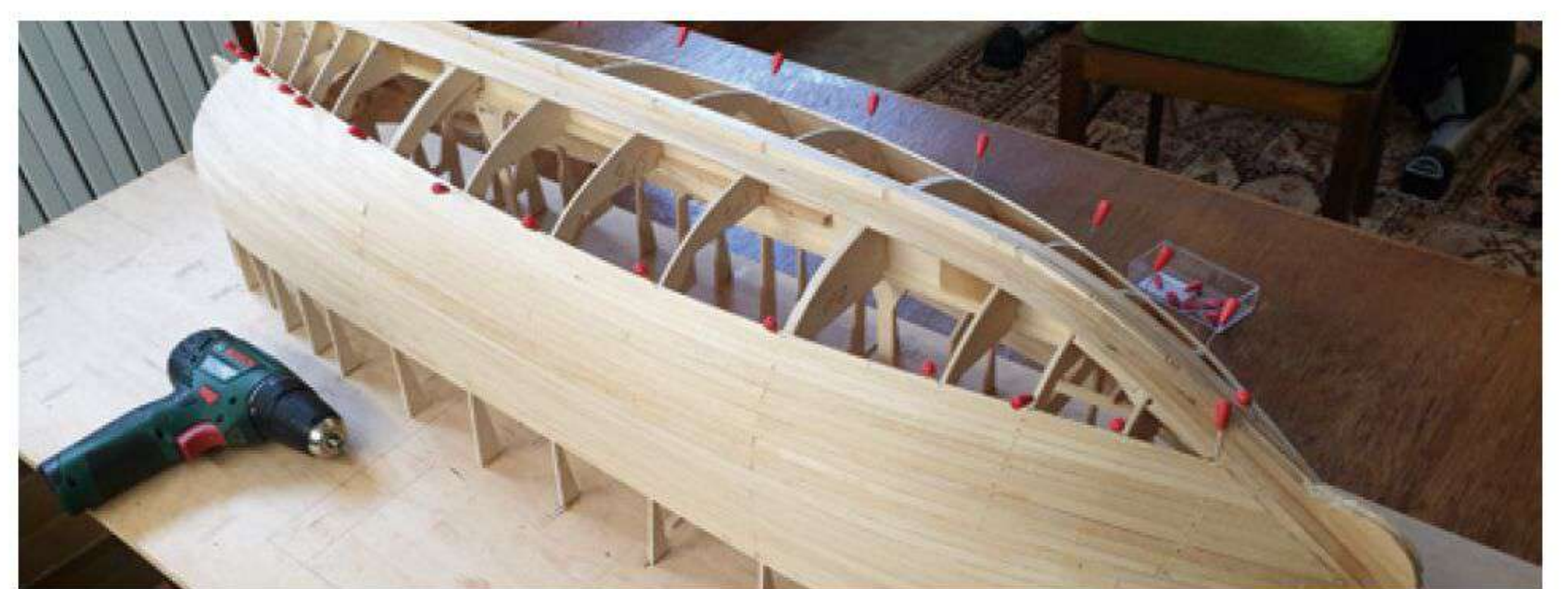
Wechselseitig werden die Spanten mit Lindenleisten beplankt
