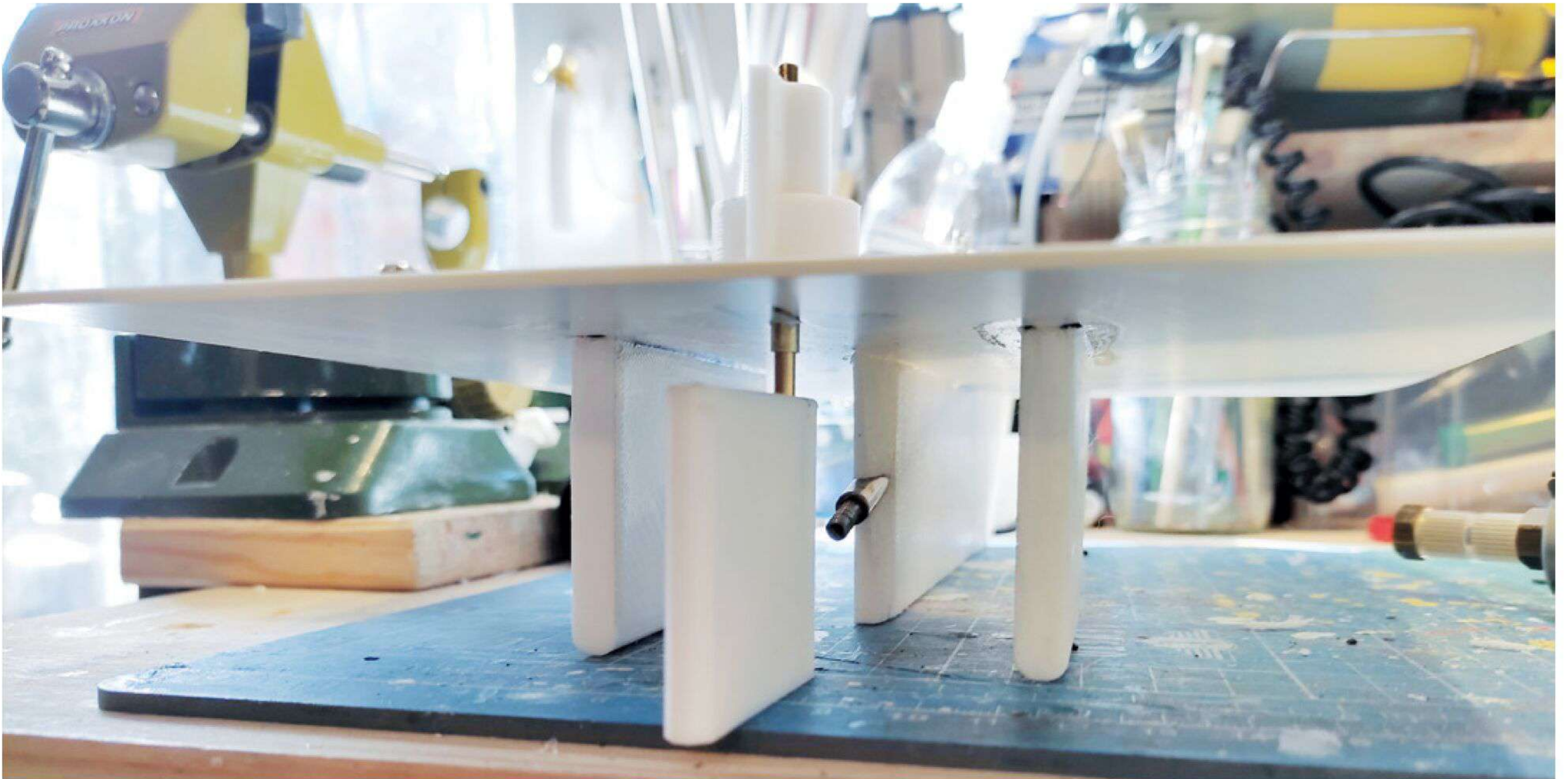
Durch die beiden Seitenkiele braucht das Boot keinen Ständer
