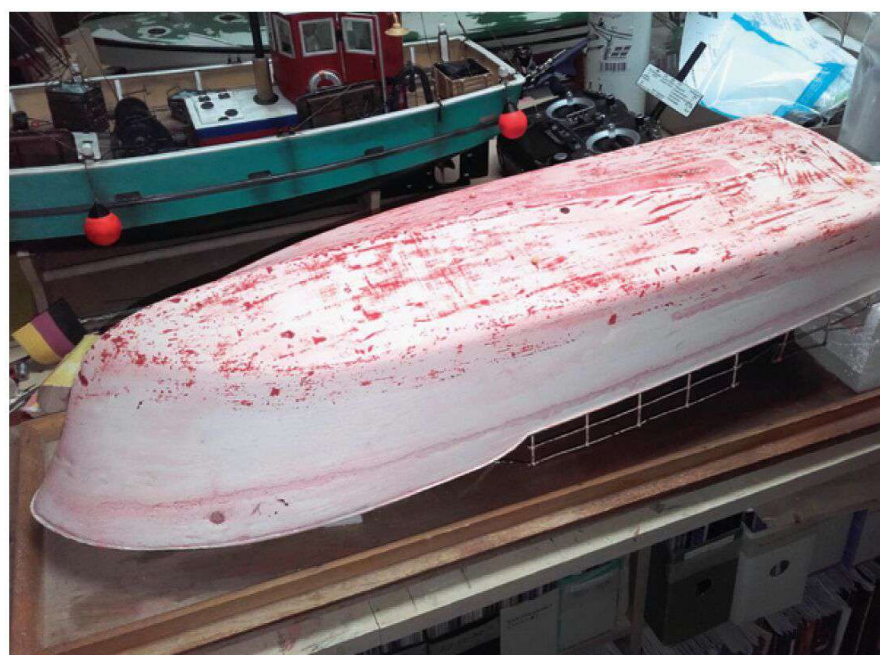
Der Styroporrumpf war beim Schleifen sehr druckempfindlich
