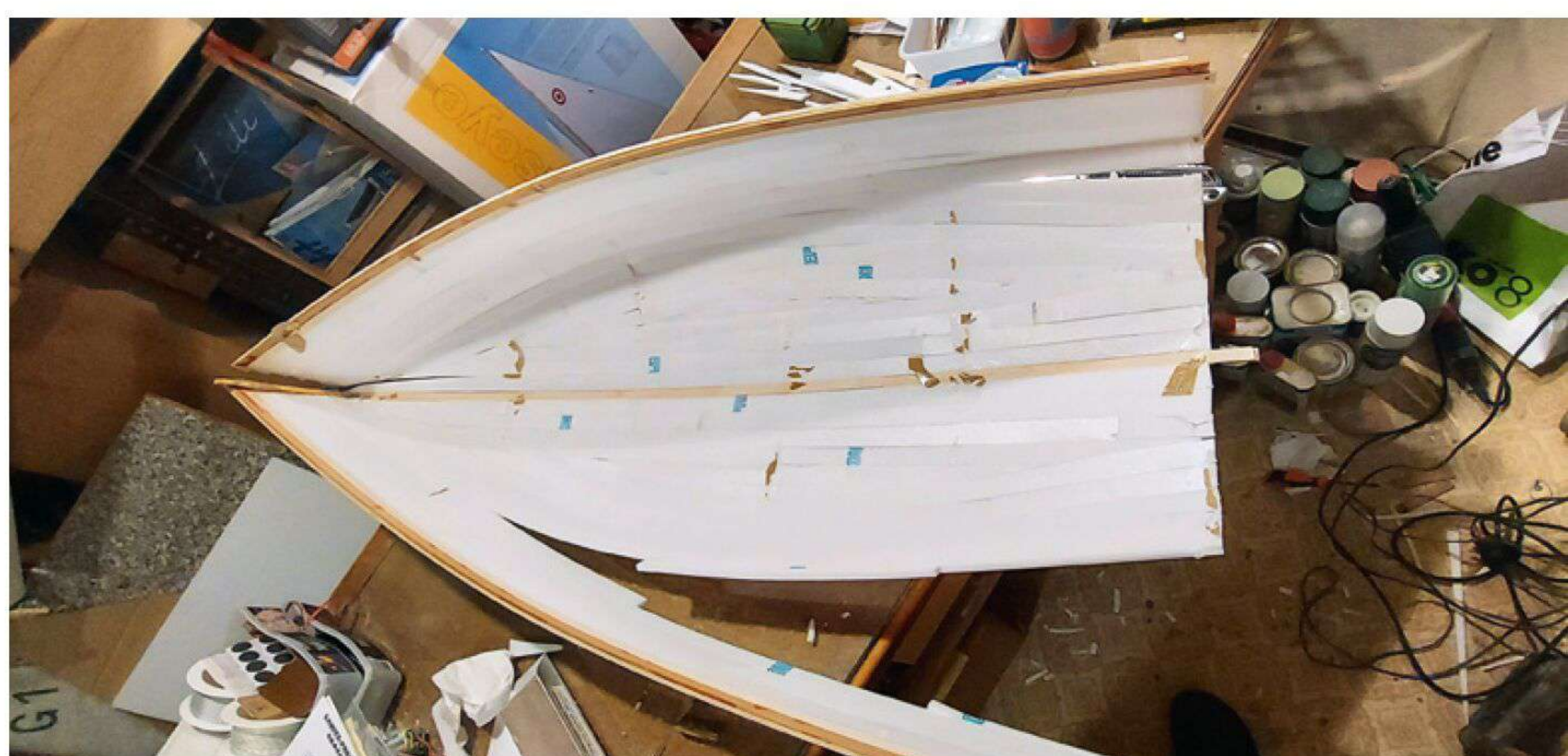
Man hätte es ahnen können: Die Spanten sind raus, aber der Rumpf ist kaputt
