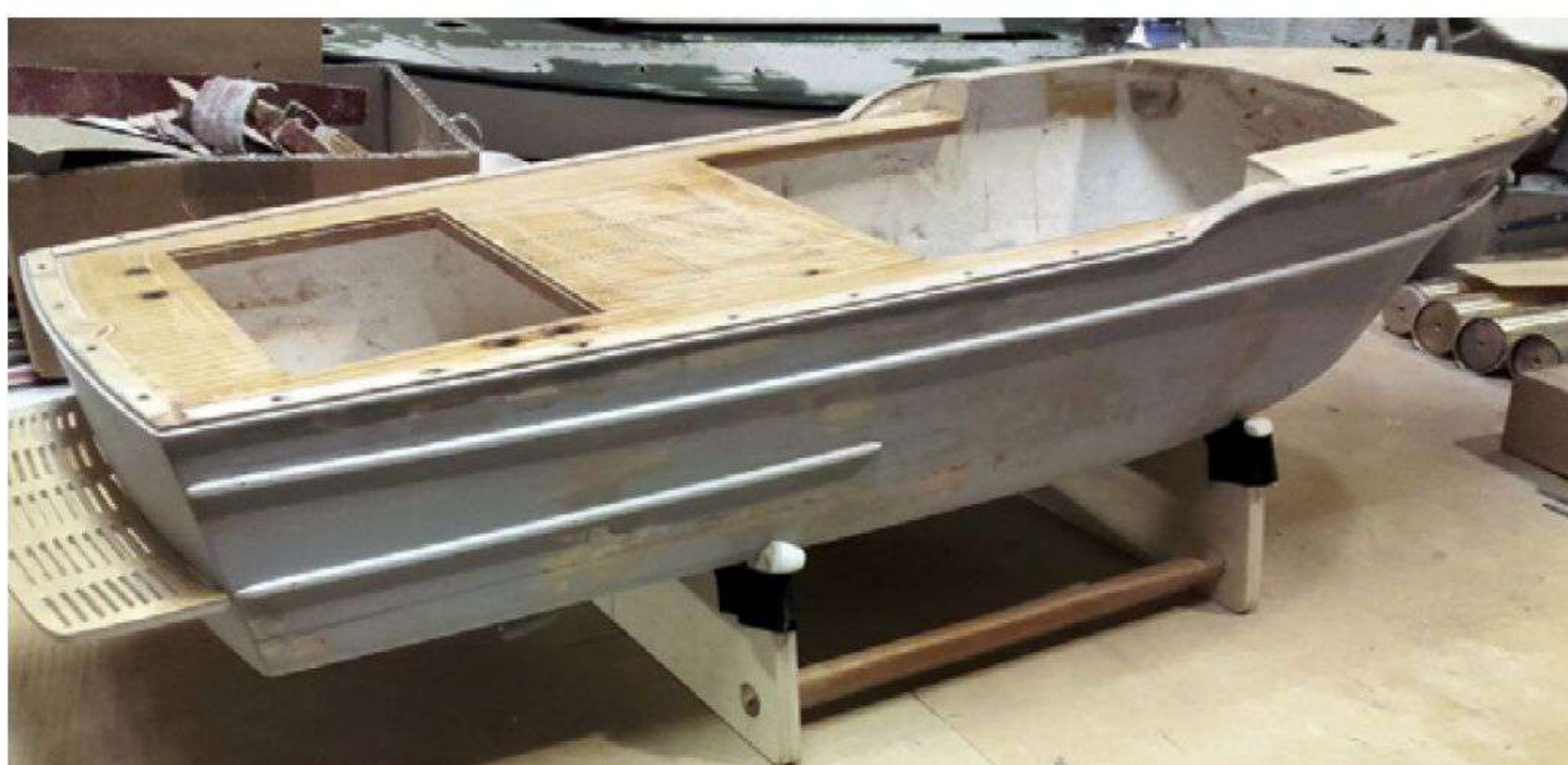
Die Badeplattform aus Polystyrol wurde anschließend mit gebeiztem Abachi verkleidet
