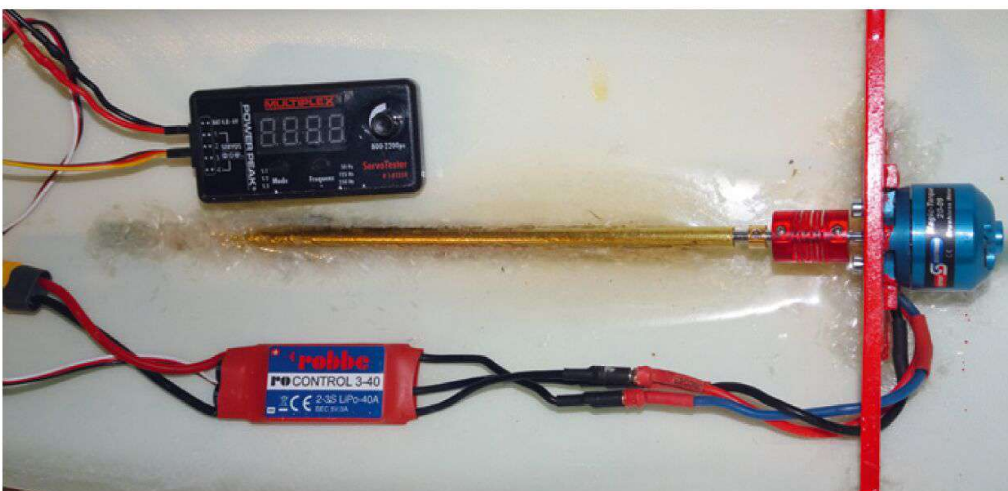
Der erste Probelauf erfolgt im Trockenen mit einem Servotester und einem einfachen Regler
