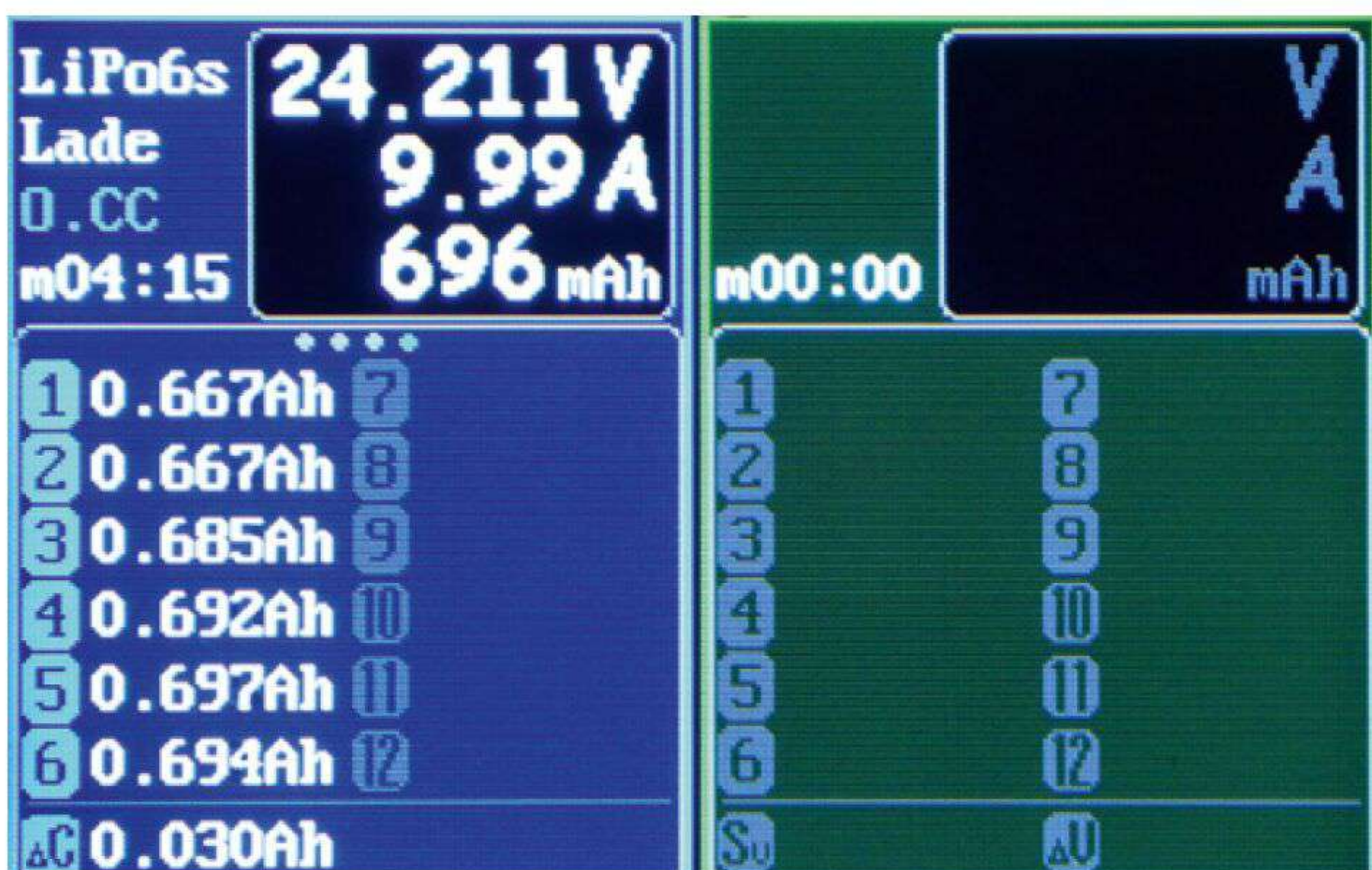
Beim Laden werden die wichtigsten Parameter übersichtlich visualisiert, dazu gehört die Anzeige der Innenwiderstände, aber auch die ge- oder entladene Kapazität der einzelnen Zellen
