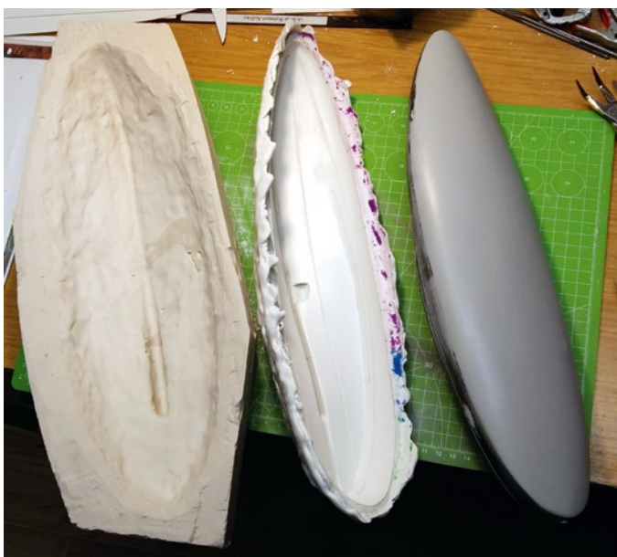
Von rechts nach links: Die Urform des Rumpfs, die Silikonform und das Gipskorsett
