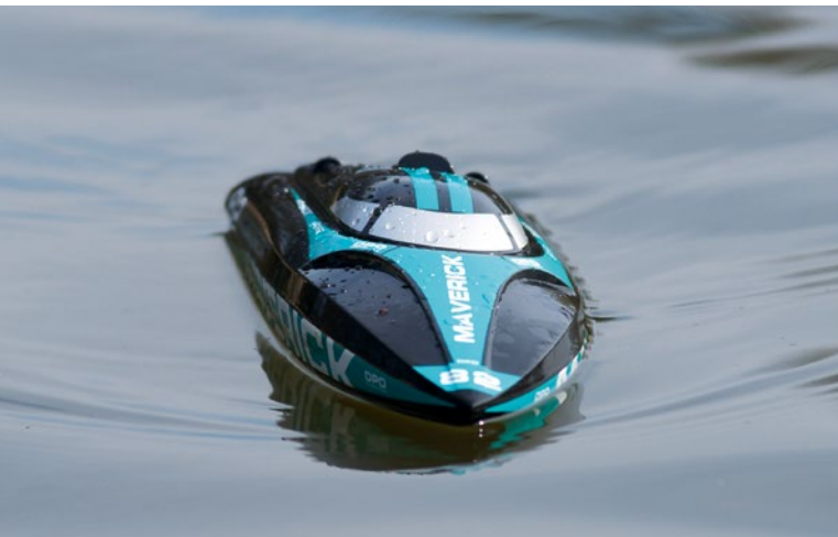
Die leichte Schlagseite ist gewollt und wird durch das Motordrehmoment ausgeglichen
