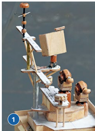
1) Der Rohbau des vorderen Masts besteht überwiegend aus Holz. 2) Die SAM-Anlage im Rohbau. Links unten der Starter, dann die vier Beleuchter SPG-55 und seitlich des obersten Geräts das SLQ-32. 3) Die Mitte des Modells mit ASROC-Boxstarter, Kamin, Feuerleitgeräten und 12,7/L38-Kanonen
