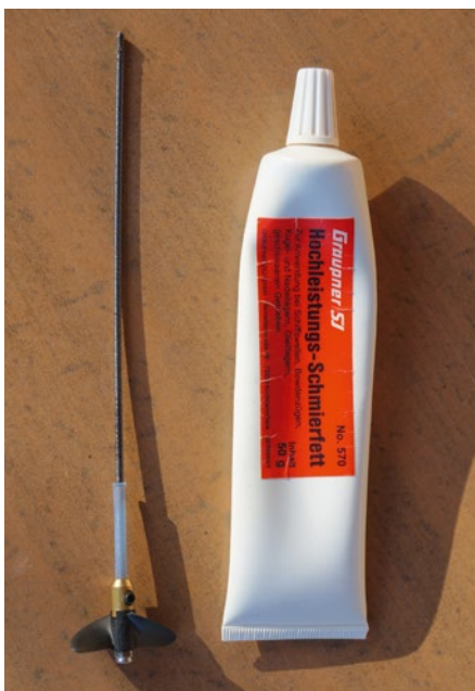
Die ausgebaute Flexwelle habe ich mit reichlich Fett gegen Korrosion und Wassereintrich geschützt
