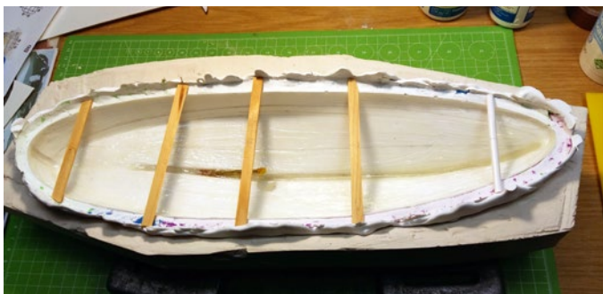
Vor dem Laminieren wurde die Form mit Gelcoat ausgepinselt
