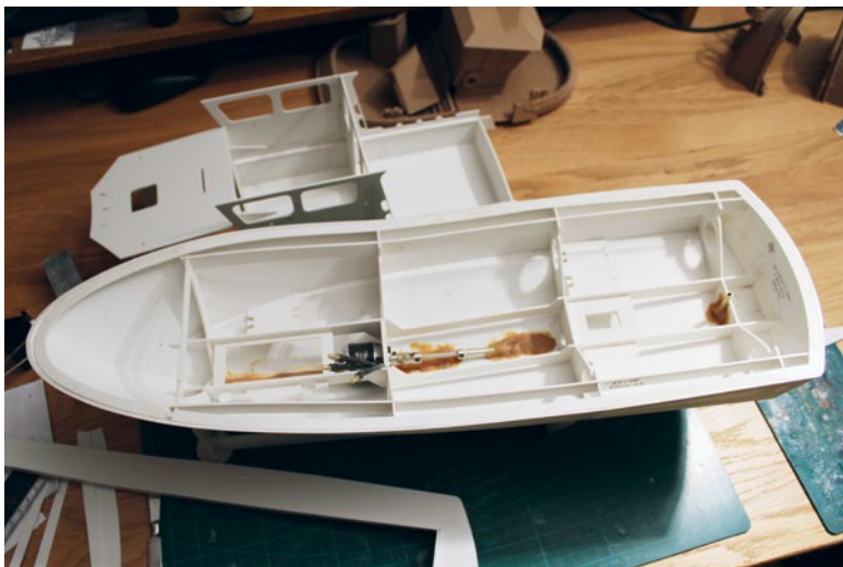
Der Motor, das Stevenrohr und der Ruderkoer werden ausgerichtet und eingeharzt
