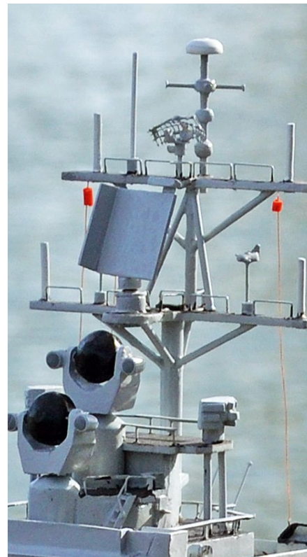
Der lackierte vordere Mast mit dem SPS-48 Radar, dem Störgerät SLQ-32 und den oberen Zielbeleuchtern
