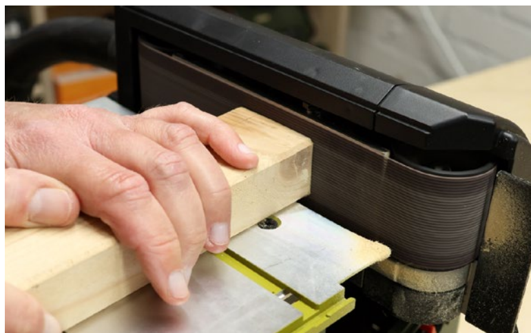
50 mm ist das Schleifband breit, sodass auch größere Holzstücke gut zu bearbeiten sind
