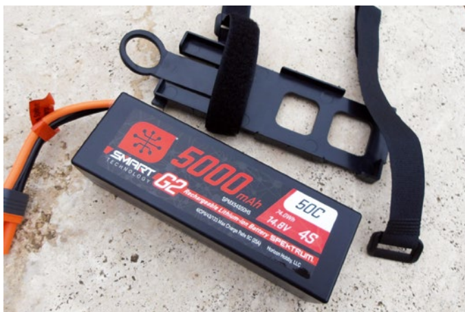
Der extra gekaufte Fahrakku wird mittels Klettschlaufen auf der Akkurutsche fixiert
