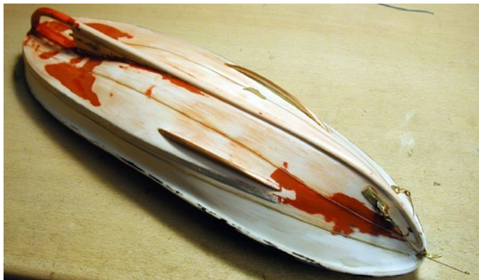
Am Rumpf wurden Schlingerkeile und Schweißnahtimitate angebracht
