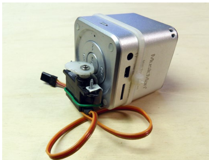
Der MP3-Player mit aufgesetztem Ein/Aus-Servo
