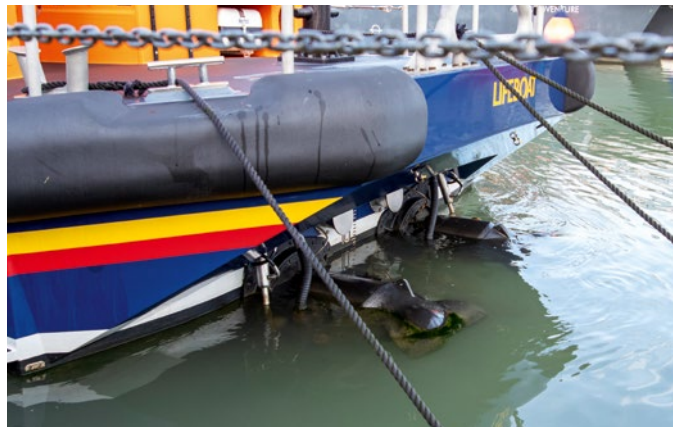
Am Heck sind die beiden Hamilton-Jets montiert
