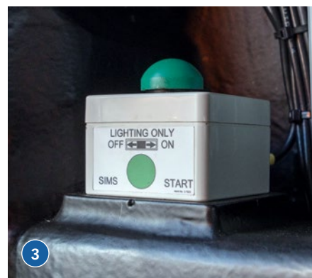
1) Die schockabsorbierenden Fahrersitze sind mit Rallye-Gurten ausgestattet. 2) Der Lenkhebel und die Jet-Kontrollen sind an den Armlehnen des Steuermanns befestigt. 3) Mit diesem grünen Buzzer wird das Boot hochgefahren
