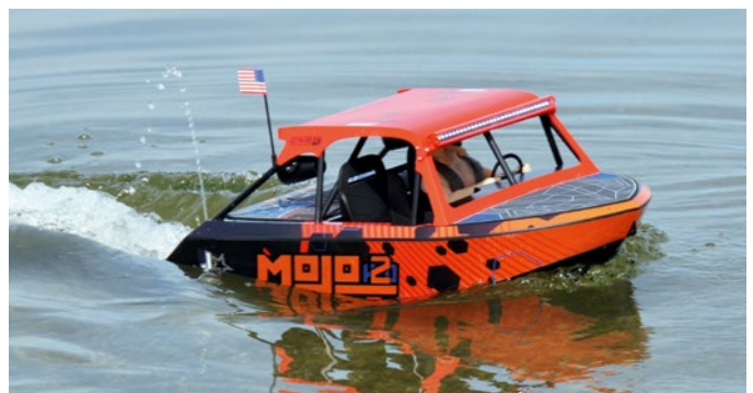
Die kleine Fontäne rechts hinten zeigt an, dass die Wasserkühlung funktioniert
