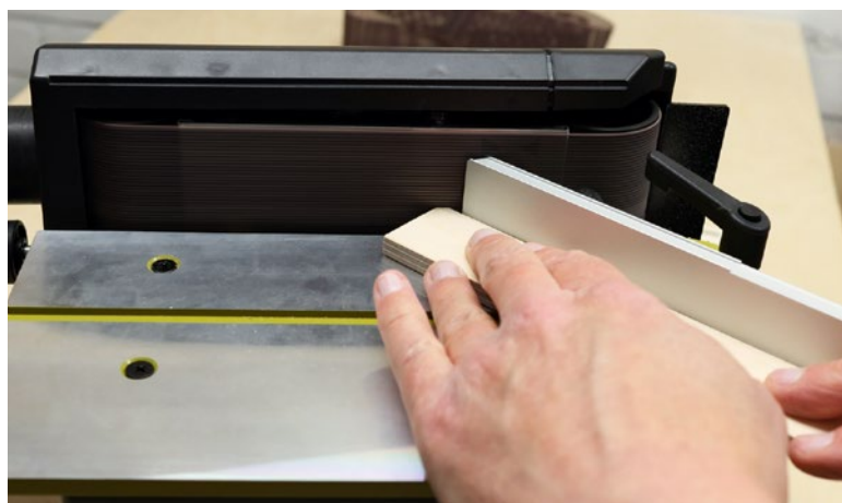
Mit dem Winkelanschlag lassen sich Gehrungen schleifen. Allerdings sollte man den eingestellten Wert ergänzend kontrollieren
