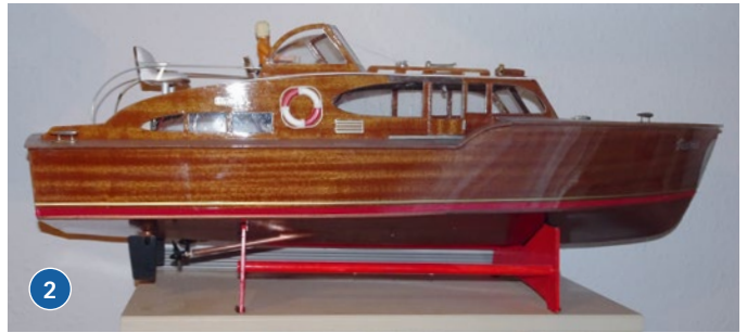
1) Die CAPRI von aero-naut hat ab Werk einen sehr sicheren Ständer. 2) Der Ständer der VICTORIA ist sicher nicht sehr dekorativ, erfüllt aber alle Anforderungen an die Standsicherheit sowohl im Regal als auch im Auto
