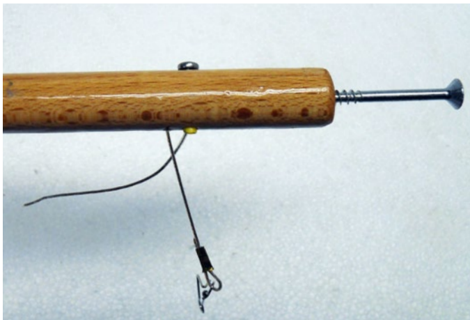
So wird die Hebeseilbefestigung am Ruder angeschlagen
