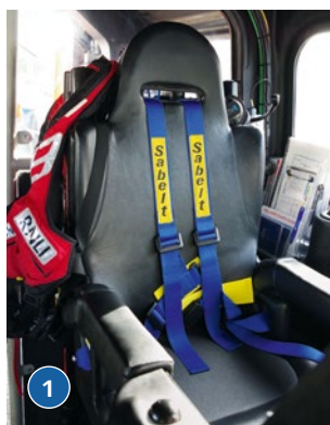
1) Die schockabsorbierenden Fahrersitze sind mit Rallye-Gurten ausgestattet. 2) Der Lenkhebel und die Jet-Kontrollen sind an den Armlehnen des Steuermanns befestigt. 3) Mit diesem grünen Buzzer wird das Boot hochgefahren
