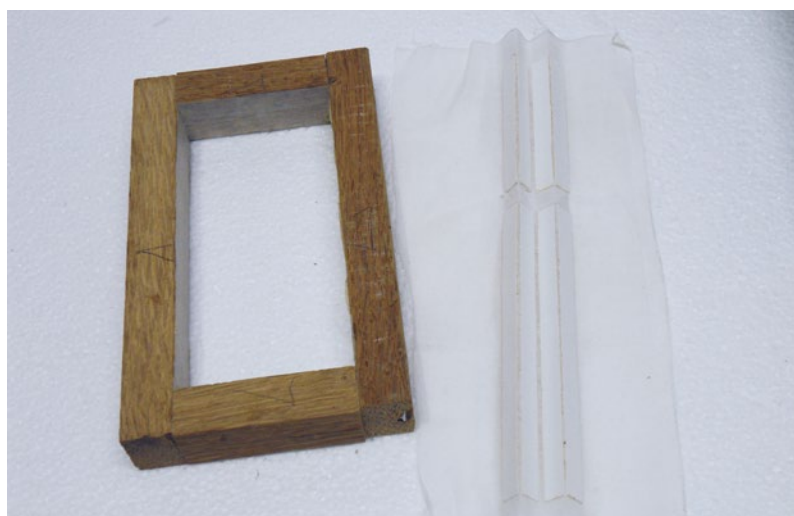
Holzrahmen und Stoff mit aufgebügelten Verstärkungen
