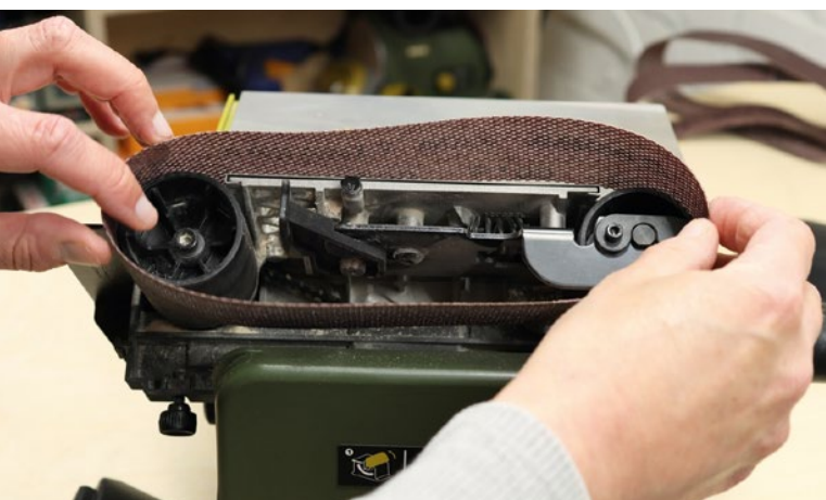
Zum einfachen Schleifbandwechsel sind zwei Kunststoffschwämme zu demontieren und ein Spannhebel zu lösen. In welche Richtung man das Band einspannt, spielt keine Rolle
