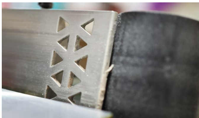
Um Schleifstaub durch das Netzschleifband zu saugen, sind im massiven Rollentisch Löcher eingelassen
