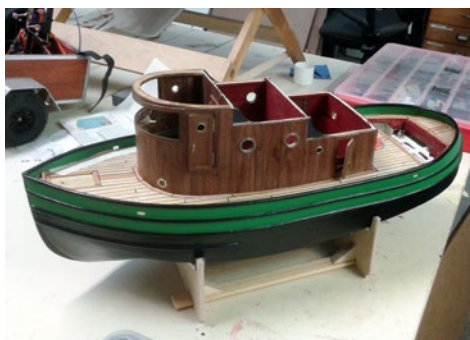
Das Sperrholzgerüst des Deckshauses wurde mit Kaffee-Rührstäbchen beklebt und lasiert
