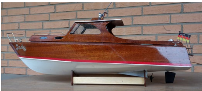
Dieser Ständer der Diva von Aeronaut ist leider zu klein, um einen sicheren Transport des Modells zu gewährleisten
