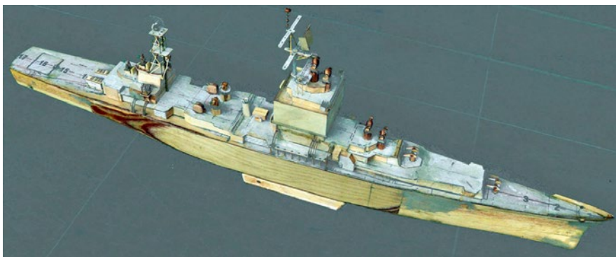
Der Rohbau des Modells mit der Sperrholzbeplankung im Rumpfmittelteil
