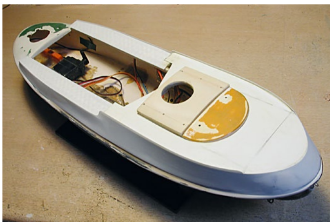
Das neue Vorschiff wurde aus Polystyrol-Formteilen erstellt
