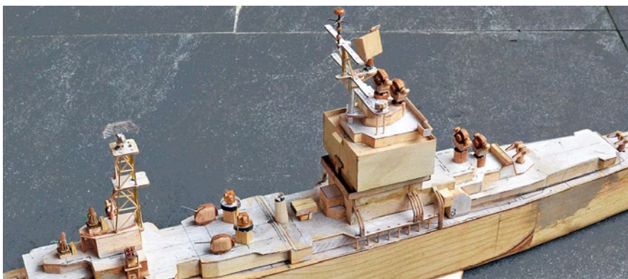
Das Deckshaus ist im Rohbau schon mit den meisten Ausrüstungsteilen bestückt, aber ohne Relings, Türen und Niedergänge
