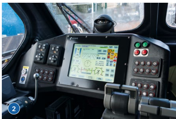
1) Die schockabsorbierenden Fahrersitze sind mit Rallye-Gurten ausgestattet. 2) Der Lenkhebel und die Jet-Kontrollen sind an den Armlehnen des Steuermanns befestigt. 3) Mit diesem grünen Buzzer wird das Boot hochgefahren
