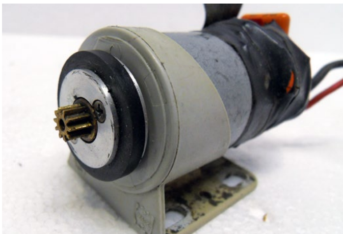
Einer der Motoren mit Ritzel und Alu-Drehteil mit aufgeklebtem Gummiring
