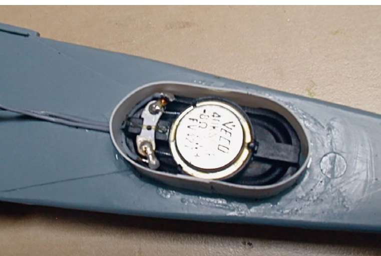
Der Lautsprecher ist in einer Lautsprecherkapsel im Deck eingebaut
