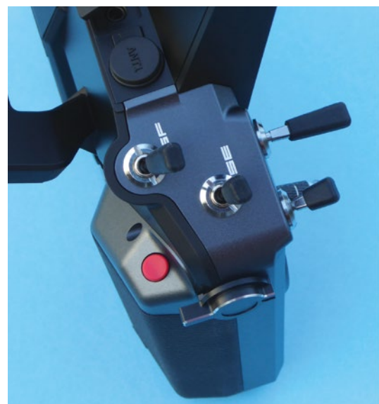
Für die Bedienung stehen beidseitig jeweils zusätzlich vier Schalter und ein Slider sowie ein roter Tastschalter bereit
