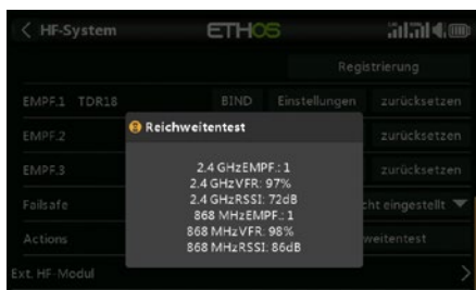
Beim Reichweitentest wurden im TD-Modus für beide Frequenzbänder ausreichende Werte ermittelt
