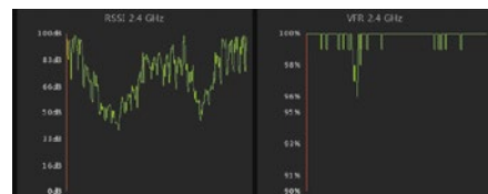
Zur Überprüfung der Funkstrecken lassen sich Liniendiagramme der Kennwerte generieren
