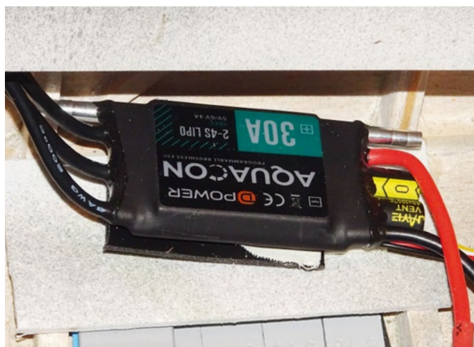
Der 30-A-Fahrtregler kann zwar an eine Wasserkühlung angeschlossen werden, aber bei der WESER ist das nicht nötig
