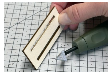
Ein Beispiel von vielen wäre das Entfernen von Laserabbrand an schwer zugänglichen Stellen
