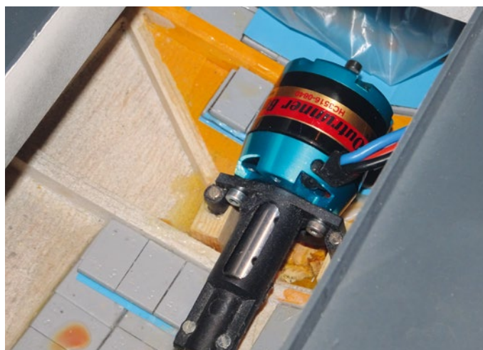
Der Hitec-Außenläufer hat nur eine Drehzahl von 840 U/min/V, was bei einen 3s-LiPo vollkommen ausreicht, um dem Modell eine vorbildgetreue Geschwindigkeit zu ermöglichen
