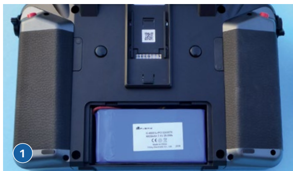
1) Rückseitig sind das Akkufach und ein Schacht für ein externes HF-Modul untergebracht, gut erkennbar sind die beiden rückseitigen Tasten. 2) Sämtliche Ports einschließlich eines SD-Karten-Slots sind durch eine Abdeckung geschützt und gut zugänglich
