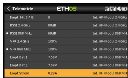
Die Spannungen beider Akkus des Empfängers sowie dessen Stromaufnahme lassen sich per Telemetrie überwachen
