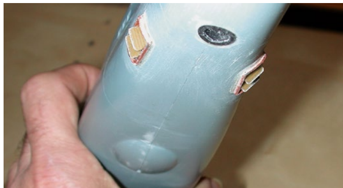
Die „Kiemen“ für das Bugstrahlruder, davor der Wassereinfluss für Rückwärts
