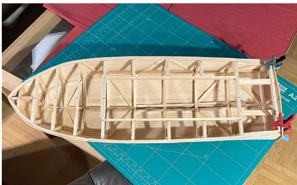
Die Rumpfschale vor dem Aufziehen des Decks. Jetzt sollte man den Motor mit der Welle und die Ruderanlage einbauen
