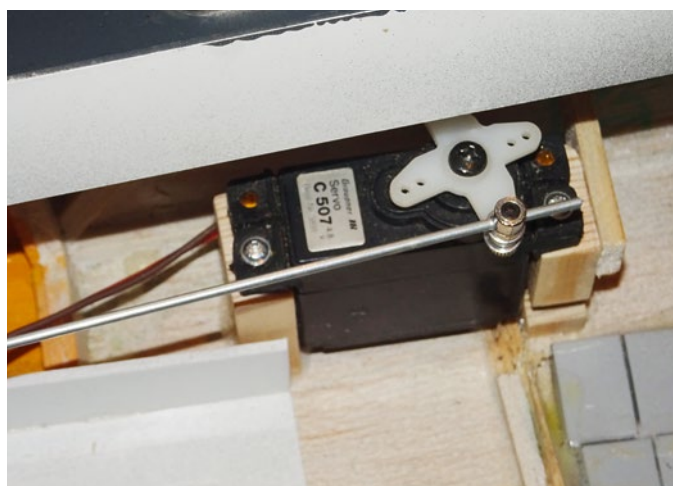
Das Lenkservo sitzt seitlich im Rumpf und betätigt das Ruder mit einer langen Drahtanlenkung
