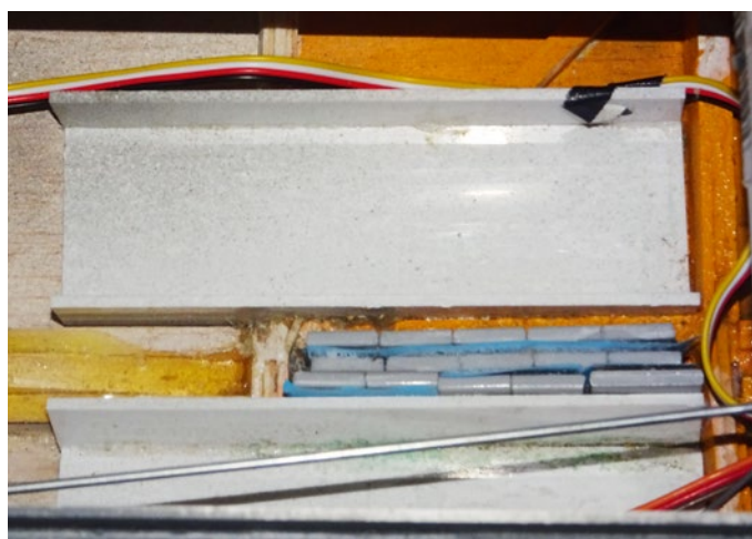
Die beiden Akkuauflagen sind aus 2-mm-ABS-Plattenmaterial
