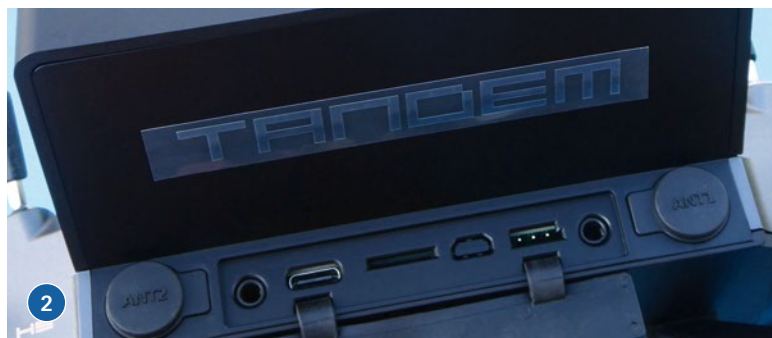
1) Rückseitig sind das Akkufach und ein Schacht für ein externes HF-Modul untergebracht, gut erkennbar sind die beiden rückseitigen Tasten. 2) Sämtliche Ports einschließlich eines SD-Karten-Slots sind durch eine Abdeckung geschützt und gut zugänglich
