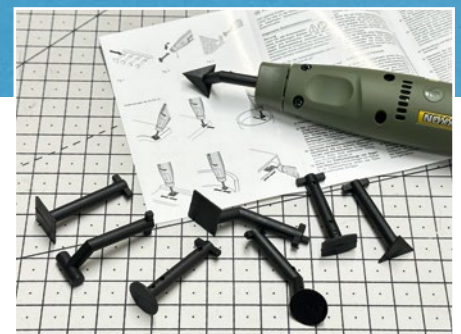
Je vier gerade und abgewinkelte Schleifaufsätze aus Polycarbonat lassen sich montieren
