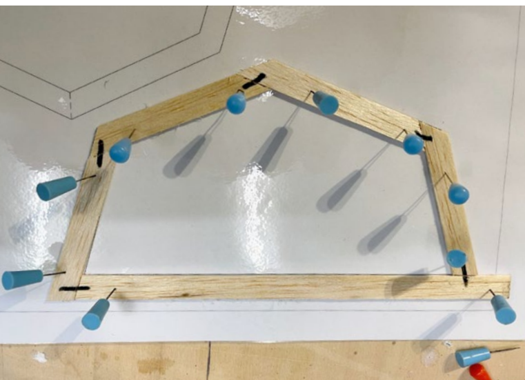
Die Spanten werden aus Balsaleisten auf dem laminierten Bauplan verklebt
