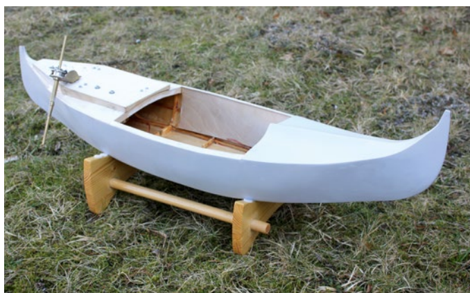
Der Rumpf wurde mehrfach gespachtelt und geschliffen
