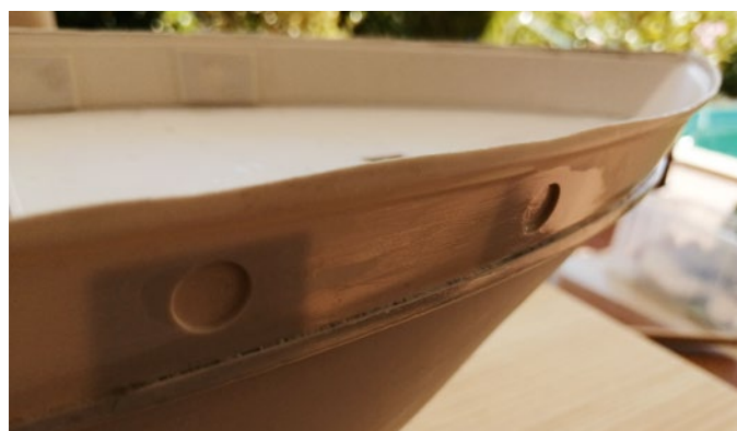
Die vorgebohrten Bullaugen werden großflächig wasserdicht verschlossen
