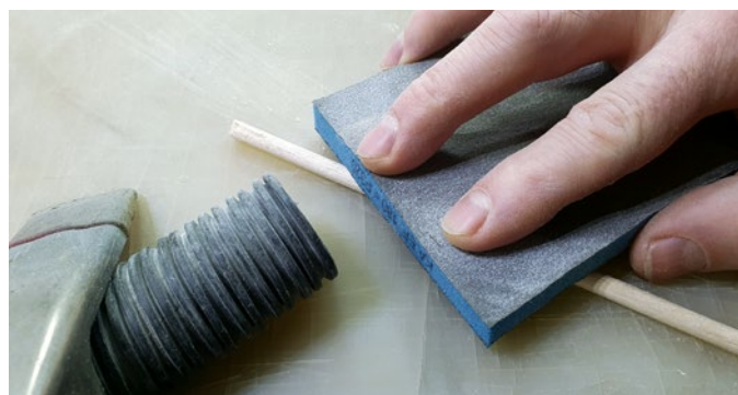
Beim Schleifen immer eine Absaugung des feinen Staubs vornehmen
