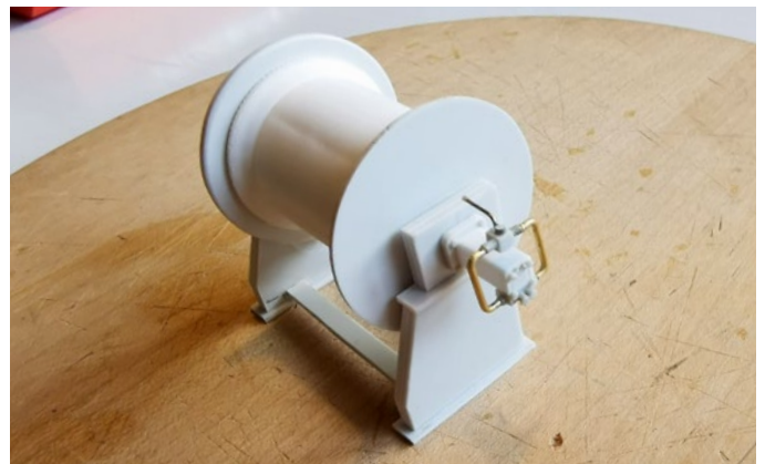
Die Netzwinde besteht aus PS, einer Garnspule und etwas Draht
