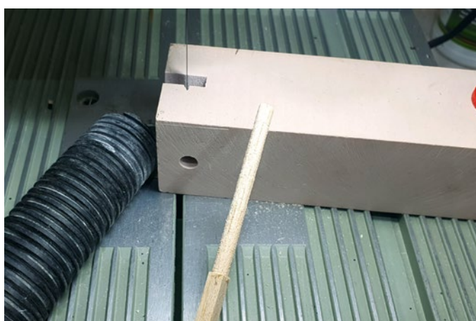
Ein seitlicher Einschnitt ermöglicht das Platzieren des Bandsägeblatts
