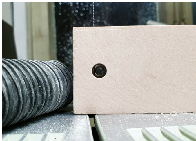
Aus Balsaleisten lassen sich mit einem Hilfswerkzeug Rundstäbe machen
