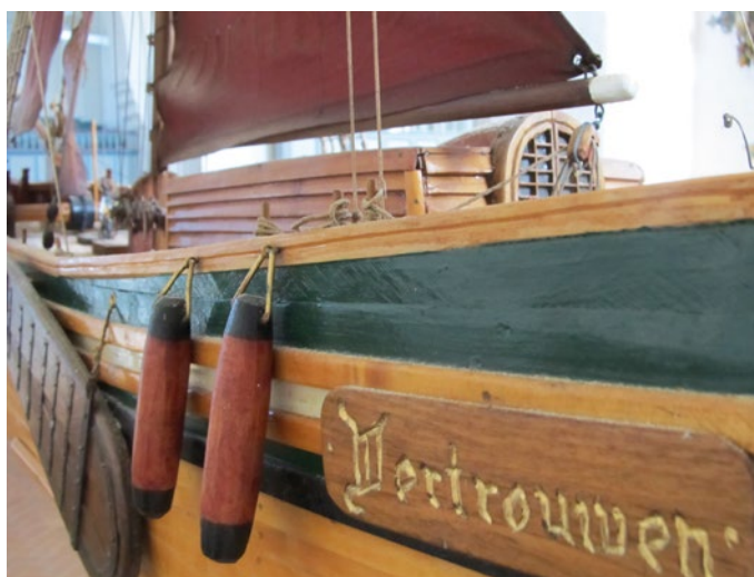
Das Plattbodenschiff hat typische Seitenschwerter zur Stabilisierung des Schiffs
