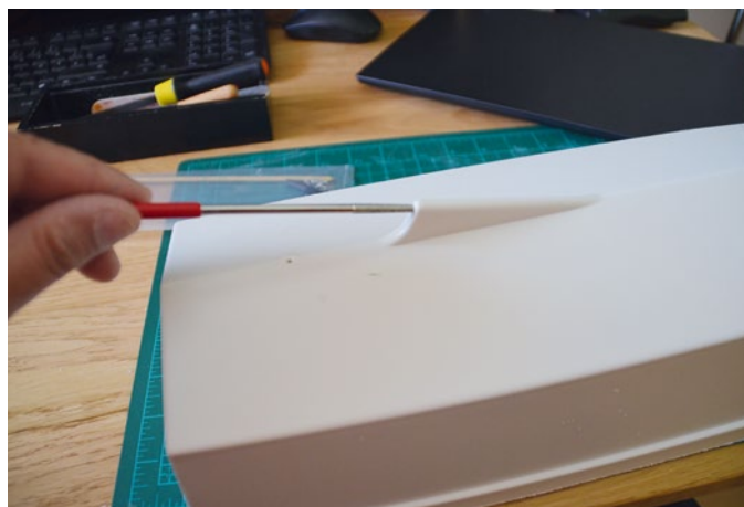
Der Durchbruch für das Stevenrohr wird vorsichtig aufgefeilt
