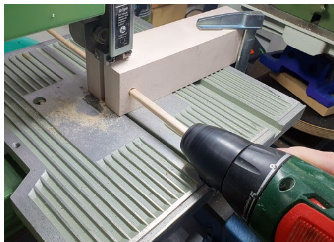
Grundlage des Hilfswerkzeugs ist ein PUR-Hartschaum-Kunststoffblock
