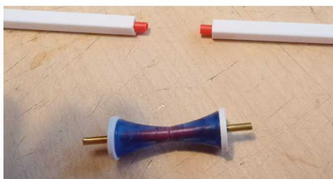
Für die Rolle des Heckauslegers sind zwei Spitzen von Kugelschreibern zusammengeklebt
