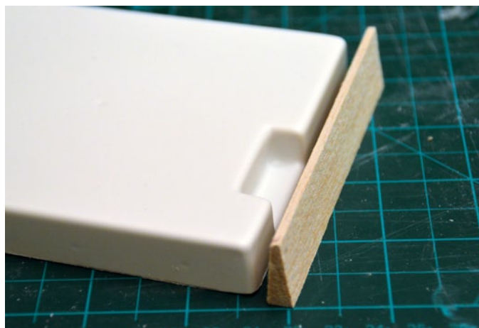
Eine Dreikant-Balsaleiste gibt dem Aufbau achtern eine neue Form
