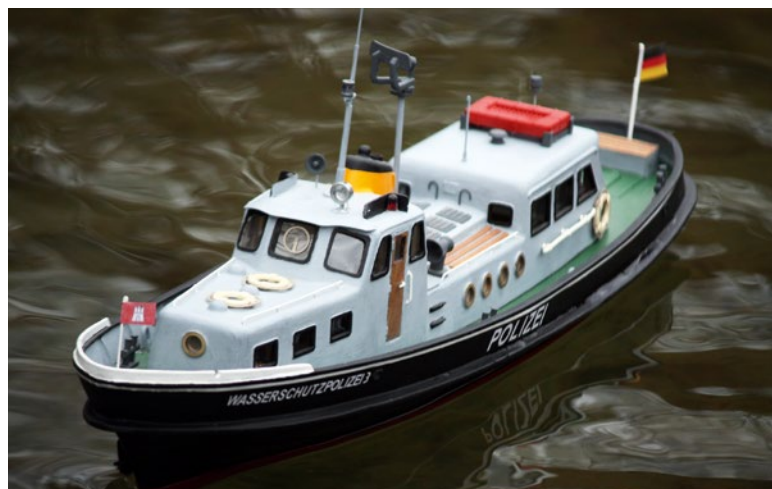
Die Schriftzüge bestehen aus Selbstklebebuchstaben und sind mit Klarlack überlackiert
