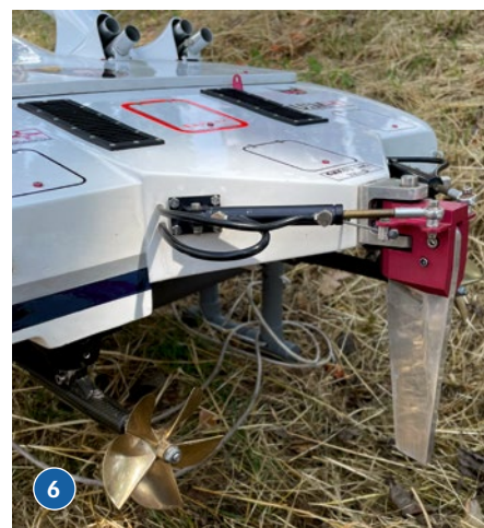
5) Das 25. Powerboattreffen am Neckar war wieder eine gelungene Veranstaltung. 6) Propeller und hydraulische Ruderanlage am Heck einer HPR 233
