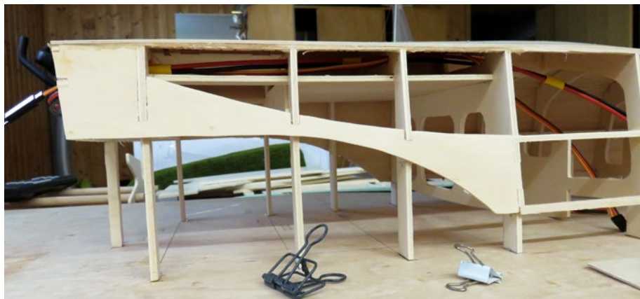
Vor der Beplankung des Rumpfs sollten die Kabel eingezogen werden
