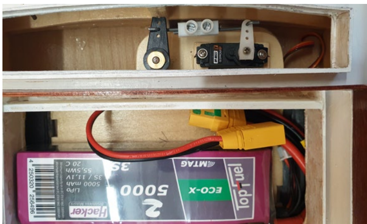
Im Heck befinden sich das vergrößerte Akkufach und das verstellbare Rudergestänge
