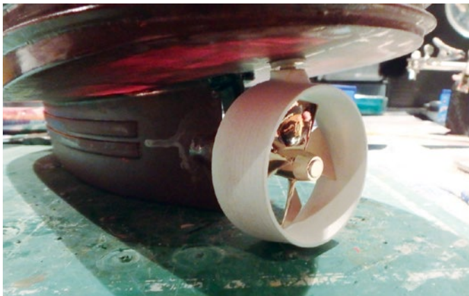
Als Ruder dient eine 45 mm große Kortdüse mit einem 40er-Kortpropeller
