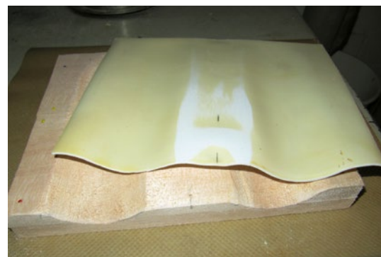
Die Hecksektion mit den Wellentunneln wurde im Backofen geformt
