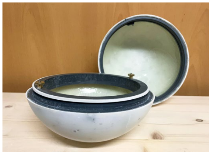
Die beide GFK-Halbkugeln wurden mit einer Plexiglashalbkugel als Form laminiert
