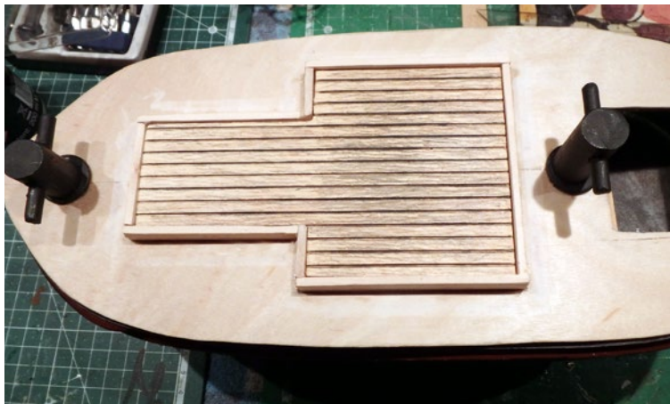
Der Fußboden des Deckshauses dient gleichzeitig als Dichtung
