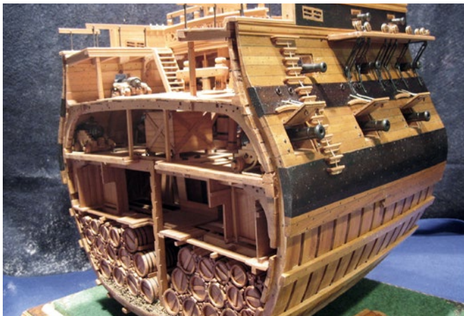
Mittschiffssektion eines französischen 74-Kanonen-Schiffs aus der Zeit um 1780
