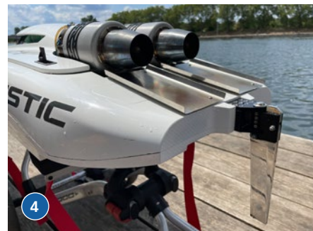
3) Die MYSTIC von Matthias Gneuß wird von zwei Schubturbinen angetrieben. 4) Die Turbinen am Heck haben einen unglaublichen Schallpegel
