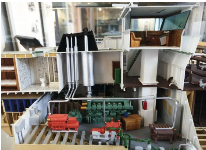
Das Schnittmodell des Heckes eines Binnenschiffs mit Maschine und Wohnung
