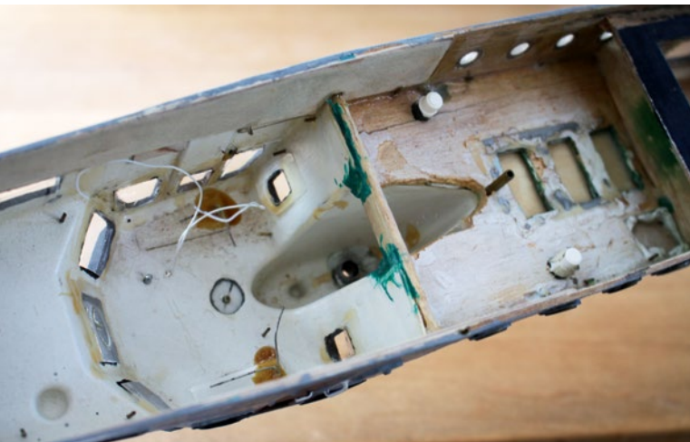
Der vordere Teil des Aufbaus besteht aus Kunststoff, der hintere aus Balsaholz
