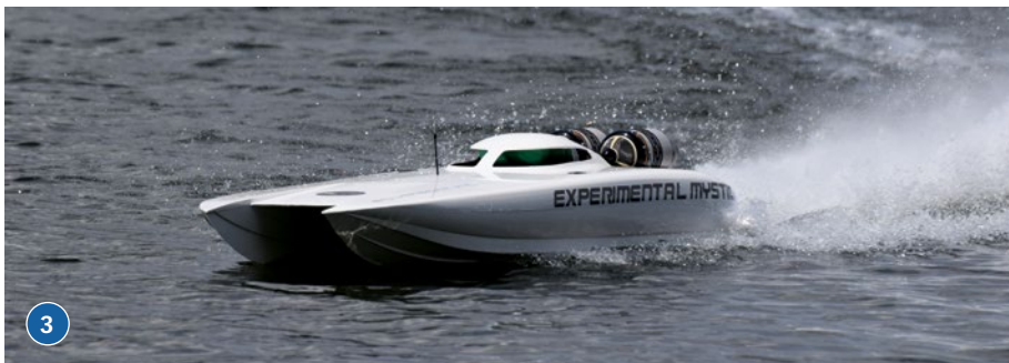
3) Die MYSTIC von Matthias Gneuß wird von zwei Schubturbinen angetrieben. 4) Die Turbinen am Heck haben einen unglaublichen Schallpegel
