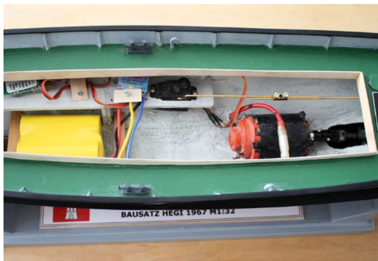
Der fest eingeklebte Motor läuft noch und wird weiterverwendet
