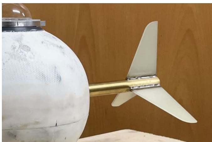
Das Leitwerk besteht aus einem Messingrohr und drei GFK-Flügeln
