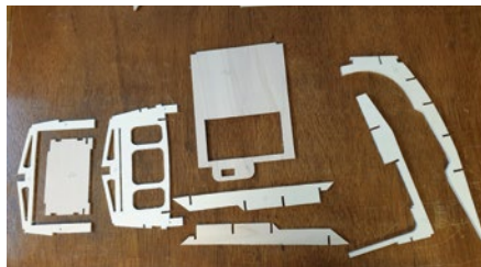
Beim Aussägen der Spanten muss man auf die Größe der Ausschnitte achten
