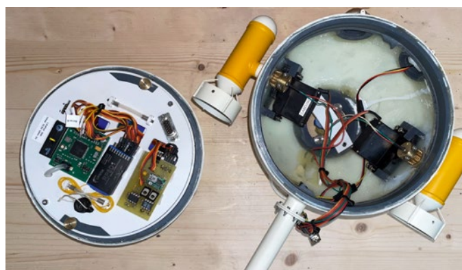
Die Elektronik des U-Boots sitzt auf einer Dichtungsplatte zwischen den Halbkugeln
