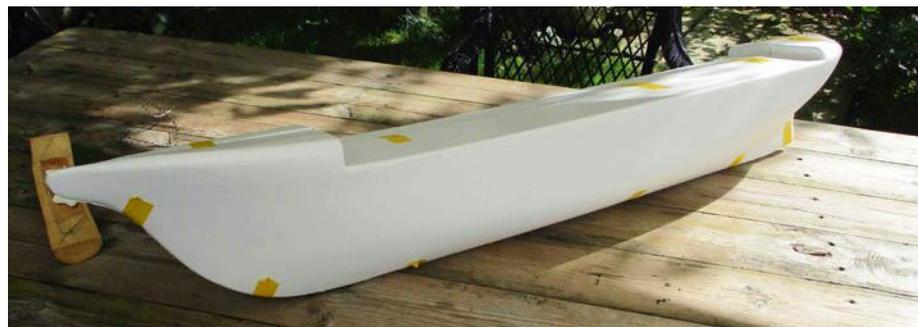
Eigenbauten auf Basis eines tiefgezogenen Rumpfs sind selten, aber das bot sich bei diesem Modell an
