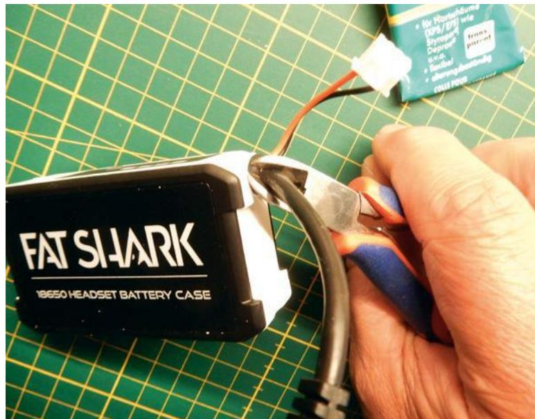
Zuerst wird das dicke Kabel der Fat Shark-Akkubox direkt an der Gummitülle abgezwickelt. Wichtig: Einen scharfen Seitenschneider benutzen, damit die Adern sauber durchtrennt werden und keinen Kurzschluss bilden
