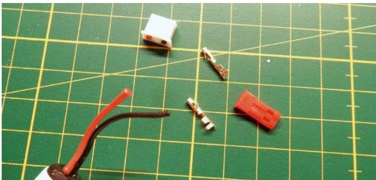
Die roten BEC-Buchsen kann man einzeln im Fachhandel kaufen. Empfehlenswert sind vergoldete Buchsen, die per Crimpzange an das Ende der abisolierten Drähte gecrimpt werden
