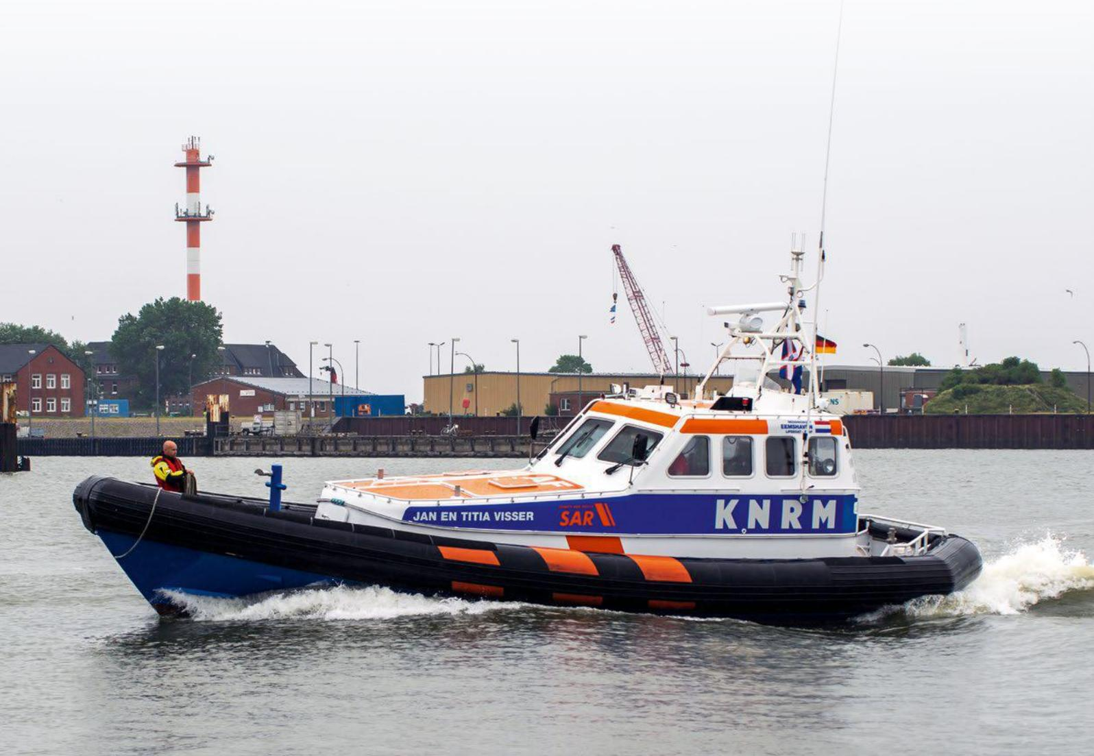
im Wasser stehend die Verunglückten an Bord ziehen können. Die Rettung nach Achtern ist nur möglich, weil das RIB von zwei Jets angetrieben wird und so weder eine gefährliche Schraube noch ein Sog dem Verunglückten zu nahe kommen kann.
