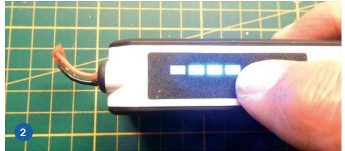
1) Noch die Lilon-Akkus rein und fertig ist die Box. 2) Betätigt man den Drucktaster an der Seite, leuchten die Balken entsprechend der Spannungslage der Akkus. Drei Balken bedeuten eine Spannungslage von 7,8 V. Bei vier Balken ist der Akku voll und hat 8,2 V Ausgangsspannung
