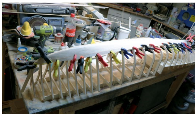
Schritt für Schritt kommt Planke an Planke auf den Rumpf. Um Verzug zu vermeiden, wird immer wechselseitig gearbeitet
