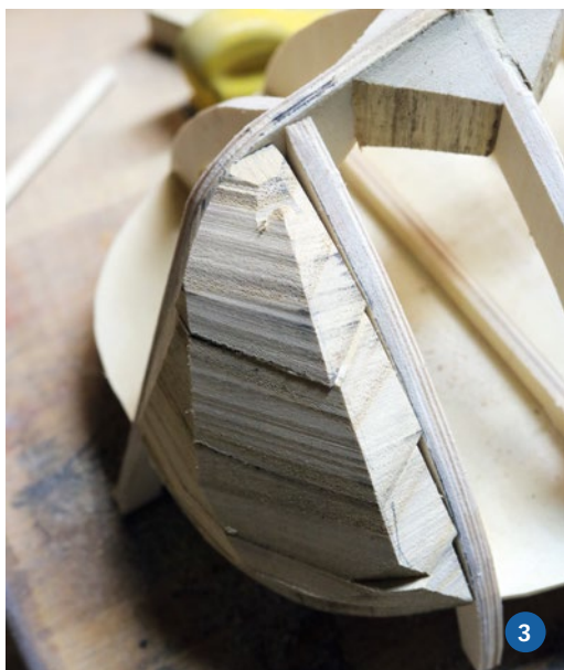
3) Beim Abtragen des Holzes und Herausbilden der Form muss man sich vorsichtig herantasten. Lücken lassen sich mit Spachtelmasse füllen. 4) Fein verschliffen ergibt sich die Heckkontur. Erkennbar ist auch, dass der Bereich rund um die Aufnahme des Ruderkokers mit Formklötzen verstärkt ist
