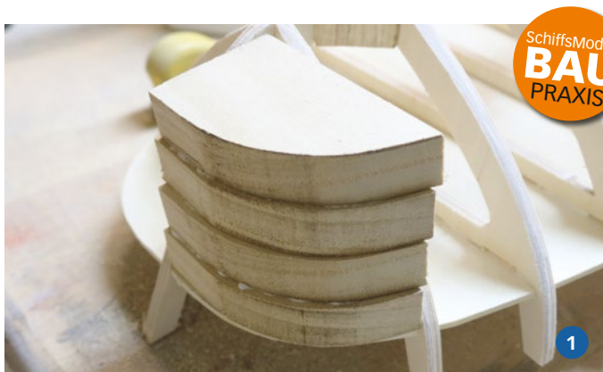
1) Da sich der hintere Teil zwischen letztem Spant und Steven nicht beplanken lässt, kommen vorgesägte Formklötze in Schichtbauweise zum Einsatz. 2) Anhand des Spants lässt sich gut ablesen, welcher Kontur der Heckbereich folgen muss
