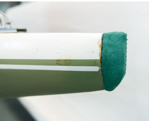
Bugfender aus Schaumgummi von einem Knieschutzkissen
