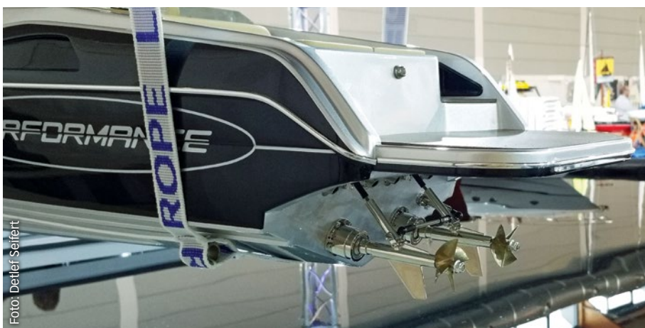
Spezielle Antriebe: Voll funktionsfähige Oberflächen-Antriebe vom Typ ARNESON-Drive am Modell einer PERFORMANCE 1107 im Maßstab 1:10
