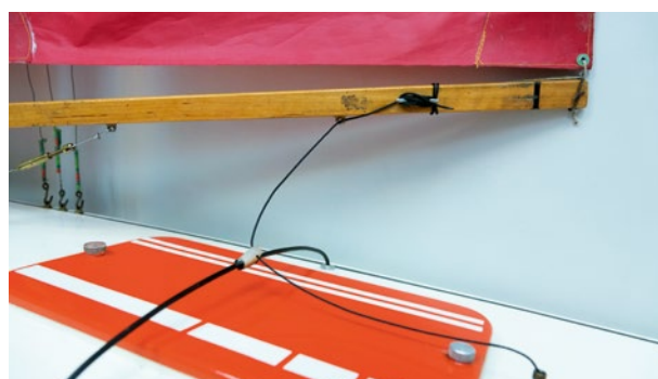
Schotführung zum Großbaum. Den Bauch am Segel verstellt man einfach durch die Klemme
