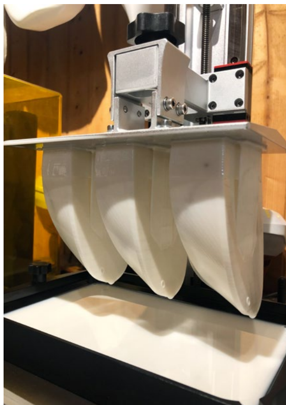
Heck und Bug des Rumpfs entstanden im 3D-Druck-Verfahren, und zwar in einem Resin-Drucker
