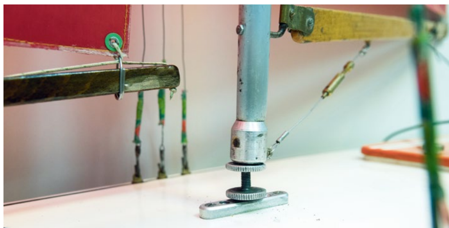
Die Wanten werden durch Hochdrehen des Mastes gespannt
