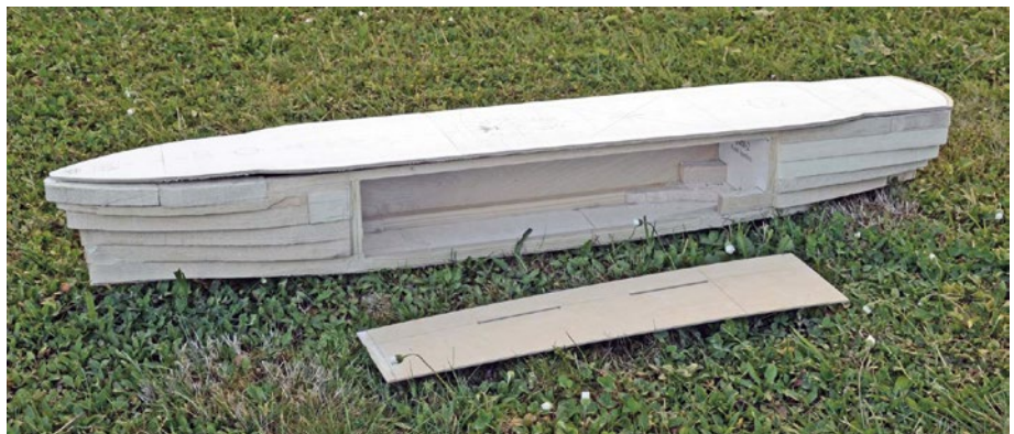
Das Rohmodell vor der Abdeckung der Backbordseite, die auf der Deckplatte liegt. In deren beiden Schlitze wird das Seitenwulstdeck eingesetzt
