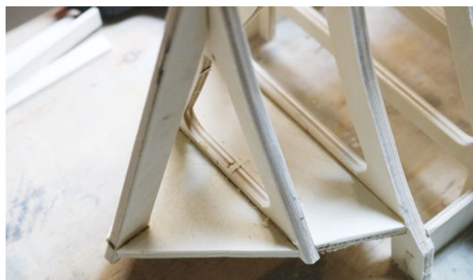
Auch der Bugbereich muss – identisch zum Heck – mit einem Formklotz gestaltet werden
