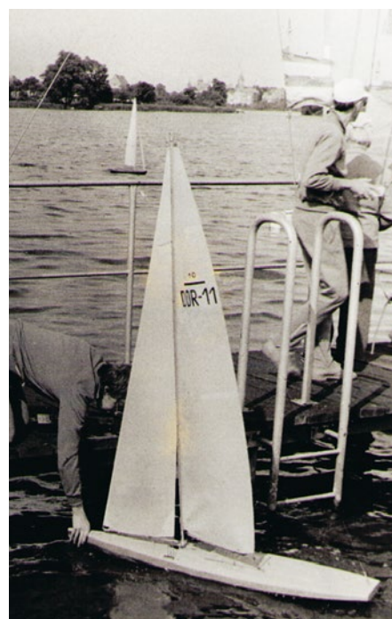
Das Urmodell von 1974 noch als Knickspanter mit Balsa beplankt, gewann beim Internationalen Wettkampf in Schwerin den Pokal
