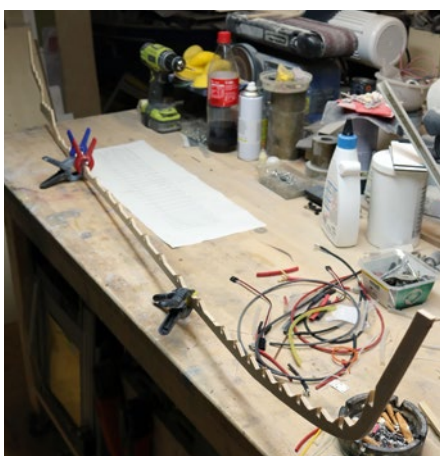
Kiel und Steven sind aus mehreren Teilen gefräst und müssen zunächst exakt sowie gerade verleimt werden
