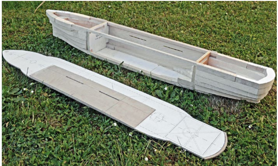
Das Rohmodell vor der Abdeckung der Backbordseite, die auf der Deckplatte liegt. In deren beiden Schlitze wird das Seitenwulstdeck eingesetzt
