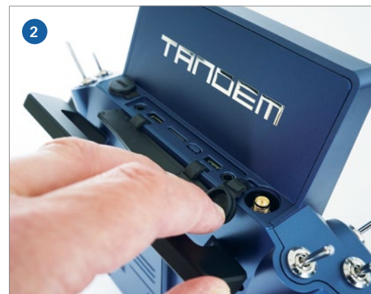
1) Zahlreiche Schalter, Drehgeber und Taster machen die X20S zu einem Multifunktionssender. 2) Rückseitig befinden sich ein SD-Mikro-Karten-Slot, USB-Anschluss und Anschlüsse für externe Module
