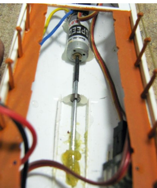
Heißkleber fixiert Motor, Antriebsstrang und Ruderservo – das reicht absolut aus
