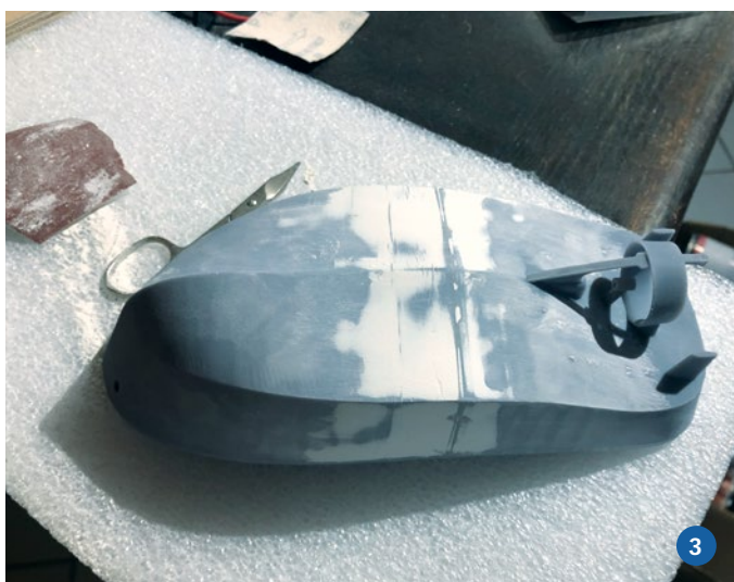
1/2/3) Die Stan Tug 1004 hat einen ausgeprägten Kielsprung, der sich durch die beiden Rumpfhälften gut erzielen lässt. Dazu sind der vordere und der hintere Rumpfteil zu verkleben, spachteln und schleifen. So ist der Übergang nahezu unsichtbar. 4) Der erste Schwimmtest in einem etwas größeren Waschbecken verlief zur vollsten Zufriedenheit
