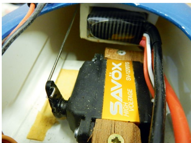
Der Akku kommt möglichst weit nach hinten, um den Bug zu entlasten, ...
