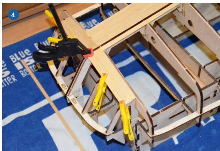
1) Ein ordentlich aufgeräumter Baukasten – ohne Fertiggrumpf. 2) Anbauteile für Deckshaus, Rettungsringhalter, Scheinwerfer, Klimaanlage und ein hohler Radarmast. 3) Rumpfbauweise längs und quer geben dem Ganzen Stabilität. 4) Beplankt wird ganz klassisch mit einzelnen Leisten
