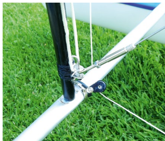
... die am Mastfuß über einen weiteren Block zum Fockbaum geführt wird
