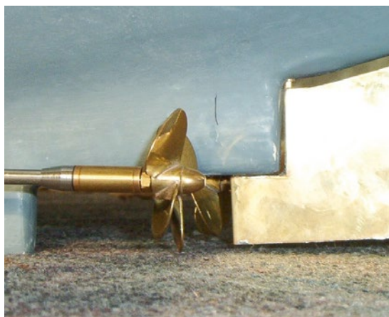
Zwei gegenläufig drehende Messingpropeller treiben die ALTMARK an
