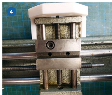
3) Das erste Prototypen-Modell entsteht im 3D-Drucker. 4) Blick von oben auf die gedruckte Motorhalterung für die X-Achse bei der ersten „Anprobe“
