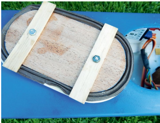
Wasserdichte Deckel sind ein Muss für Katamaranmodelle
