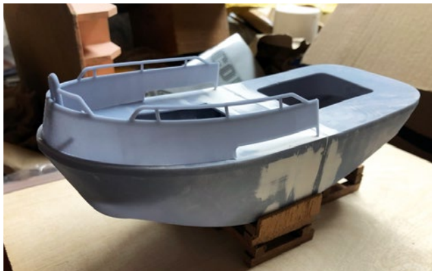
Der zweiteilige, 3D-gedruckte Rumpf sowie das 3D-Druck-Schanzkleid sind montiert
