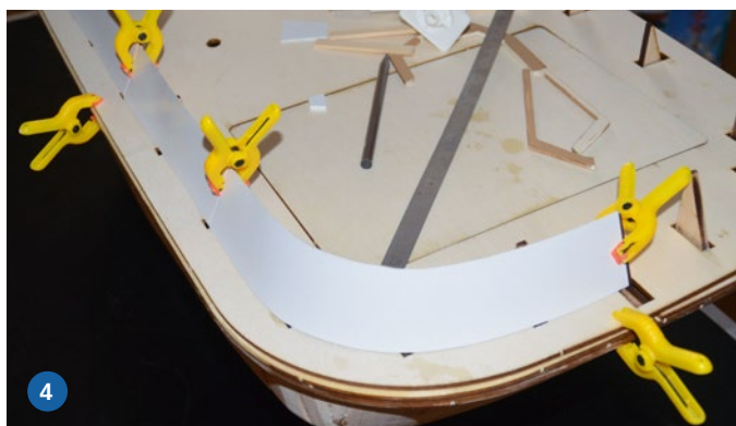
3) Bei der Verkabelung des Masts wurden mehrere Hände gebraucht. 4) Statt aus Holz entsteht das Schanzkleid aus Polystyrol. Hier werden die Papierschablonen angepasst
