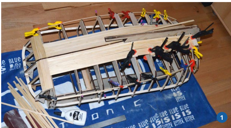
1) Zwingen und Klammern kann man nie genug haben. 2) Die Rumpfecken werden dachziegelartig mit Balsastücken ausgefüllt und in Form gebracht. 3) Damit die Zugkräfte von der Schlepptrasse beim echten Schleppen besser in das gesamte Modell übertragen werden können, wurden zusätzlich Kupferrohre eingebaut. 4) Mit Klammern werden die vorgebogenen Beplankungsleisten in Form gehalten
