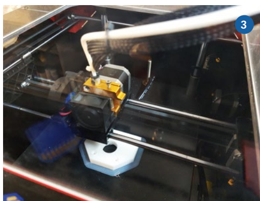
3) Das erste Prototypen-Modell entsteht im 3D-Drucker. 4) Blick von oben auf die gedruckte Motorhalterung für die X-Achse bei der ersten „Anprobe“
