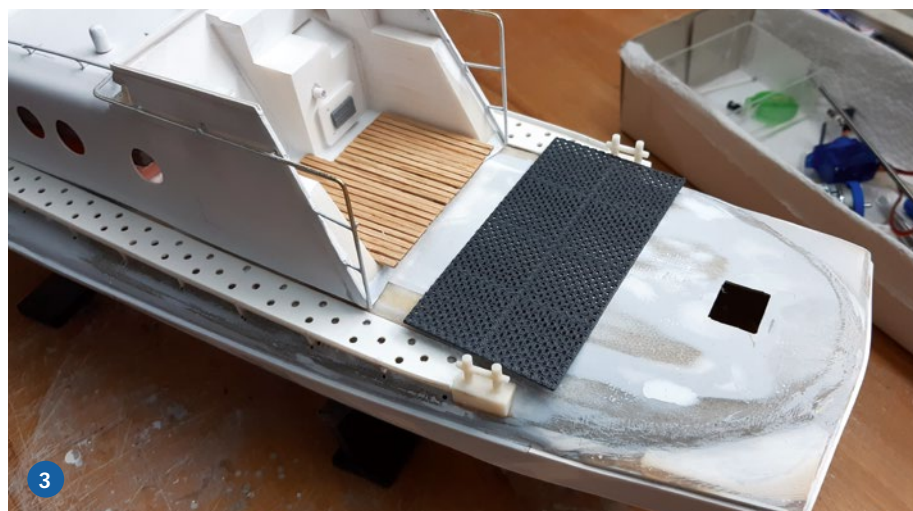
3) Einpassen der Antirutschmatte. Herausfordernder war zuvor das Erstellen der Laufbleche mit den vielen Bohrungen und der Anbau der Stützbleche. 4) Im hohlen Mast lassen sich problemlos eine Menge Kabel für die Beleuchtung verlegen
