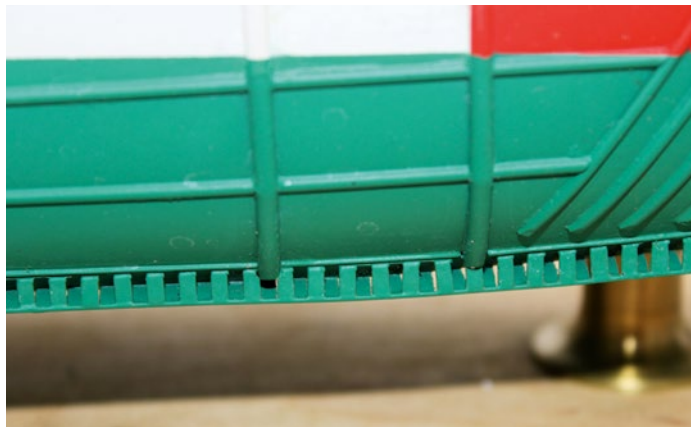
Diesen abgesetzten Schlingerkiel mit seiner Kammstruktur nachzubauen, war keine triviale Angelegenheit
