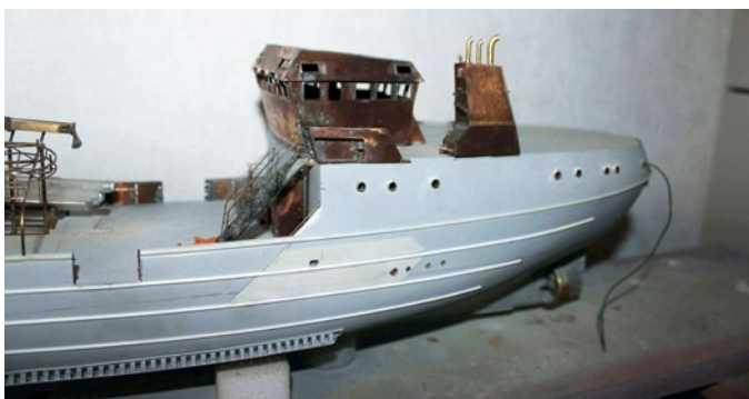
Bronzeblech prägt den Bau von Aufbau, Niedergängen, Kästen, Schornstein, Sockel, Kränen und mehr
