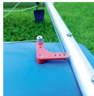
... und steuert das Ruder über eine Schubstange sehr direkt und spielfrei an
