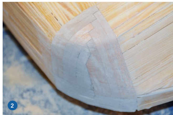
1) Zwingen und Klammern kann man nie genug haben. 2) Die Rumpfecken werden dachziegelartig mit Balsastücken ausgefüllt und in Form gebracht. 3) Damit die Zugkräfte von der Schlepptrasse beim echten Schleppen besser in das gesamte Modell übertragen werden können, wurden zusätzlich Kupferrohre eingebaut. 4) Mit Klammern werden die vorgebogenen Beplankungsleisten in Form gehalten
