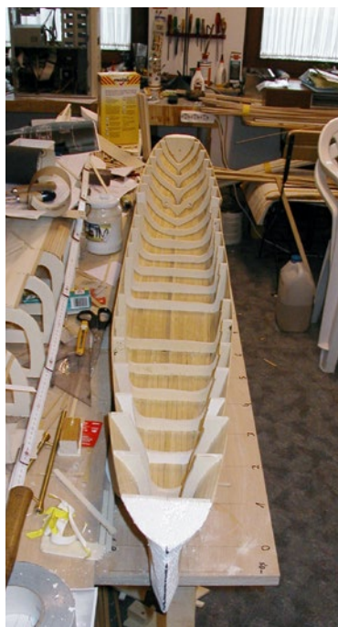
Der Rumpf entstand klassisch in Spantenbauweise aus Holz
