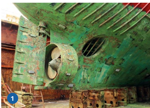
1) Zwei Besonderheiten der DELTA finden sich im Heckbereich: Einmal der Hauptpropeller in der Kortdüse und dann der Querstrahler. 2) Bei diesem Anblick sollte man nie vergessen, dass das Ganze im Maßstab 1:75 wesentlich kleiner ausfällt als hier im Bild zu erahnen. 3) Linke und rechter Unterwasserbereich unterscheiden sich auch in den angebrachten Scheuerleisten
