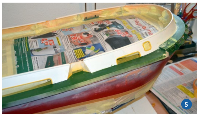
5) Die Schanz wurde vor dem Einbau innen lackiert und dann für das äußere Schwarz zusammen mit dem gesamten Deck gut abgeklebt. 6) Auch die Winden entstehen aus einem Mix aus Holz und 3D-Druck-Teilen
