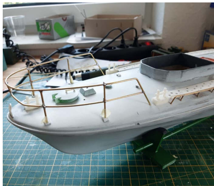
Der hohe Süllrand hilft gegen Eindringen von überschwappendem Wasser. Die Reling ist massiv ausgeführt und hält einiges aus
