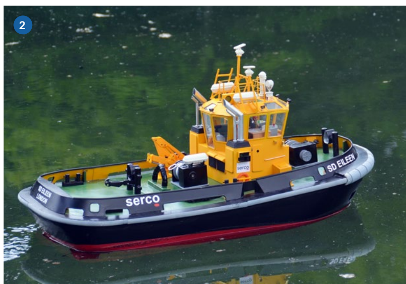
1) Das große Vorbild der SD EILEEN ist seit 2010 im Einsatz. 2) Obwohl sich die Schottelantriebe nur um rund 240° drehen lassen, kann die SD EILEEN auf dem sprichwörtlichen Teller gewendet werden – alle hier gezeigten Fahrfotos entstanden vor der endgültigen Fertigstellung des Modells
