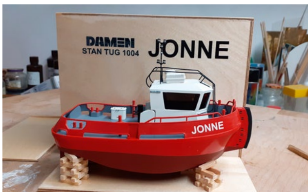
Ein Modell aus dem 3D-Drucker? Nein! Ein aus 3D-Druck-Teilen zusammengebautes, lackiertes Modell
