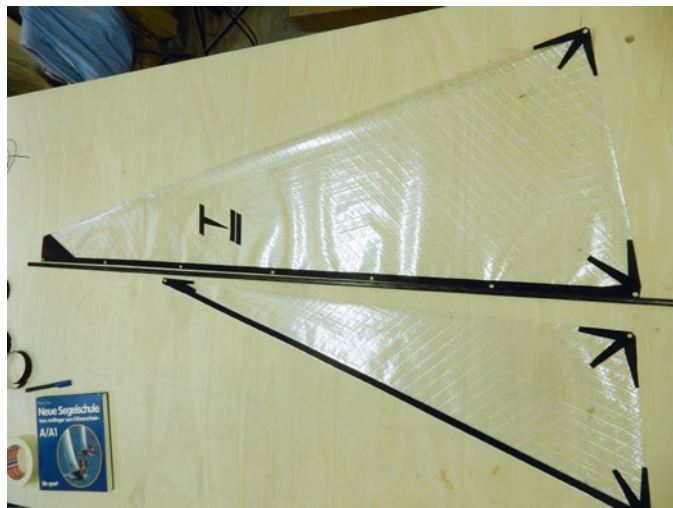
Der Carbon-Mast und die Mylar-Segel sparen 130 g Gewicht in der Takelage
