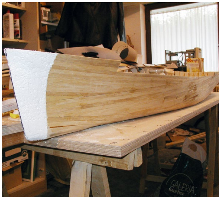
Um die Bugspitze in die richtige Form zu bringen, wurde ein Styropor-Klotz zurechtgeschliffen
