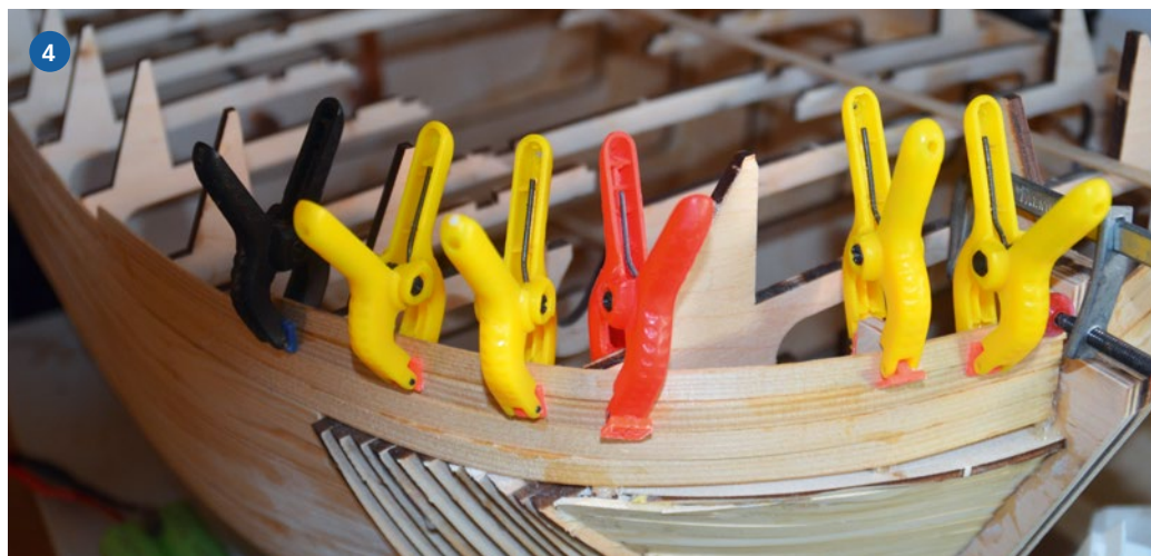
1) Zwingen und Klammern kann man nie genug haben. 2) Die Rumpfecken werden dachziegelartig mit Balsastücken ausgefüllt und in Form gebracht. 3) Damit die Zugkräfte von der Schlepptrasse beim echten Schleppen besser in das gesamte Modell übertragen werden können, wurden zusätzlich Kupferrohre eingebaut. 4) Mit Klammern werden die vorgebogenen Beplankungsleisten in Form gehalten
