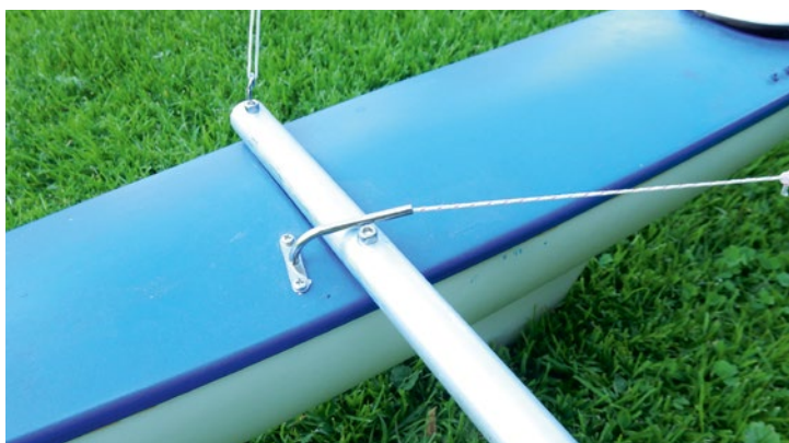
... tritt über eine U-förmige Schotführung vor dem vorderen Beam aus und wird wieder nach hinten geführt
