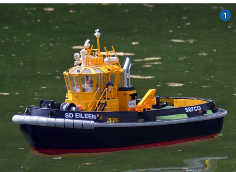
1) Das große Vorbild der SD EILEEN ist seit 2010 im Einsatz. 2) Obwohl sich die Schottelantriebe nur um rund 240° drehen lassen, kann die SD EILEEN auf dem sprichwörtlichen Teller gewendet werden – alle hier gezeigten Fahrfotos entstanden vor der endgültigen Fertigstellung des Modells
