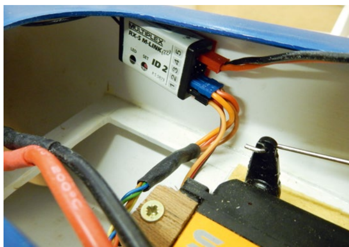
... während der Empfänger sich an der Innenwand des Rumpfs befindet. Da kommt auch im gekenterten Zustand kein Wasser hin
