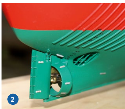
1) Zwei Besonderheiten der DELTA finden sich im Heckbereich: Einmal der Hauptpropeller in der Kortdüse und dann der Querstrahler. 2) Bei diesem Anblick sollte man nie vergessen, dass das Ganze im Maßstab 1:75 wesentlich kleiner ausfällt als hier im Bild zu erahnen. 3) Linke und rechter Unterwasserbereich unterscheiden sich auch in den angebrachten Scheuerleisten
