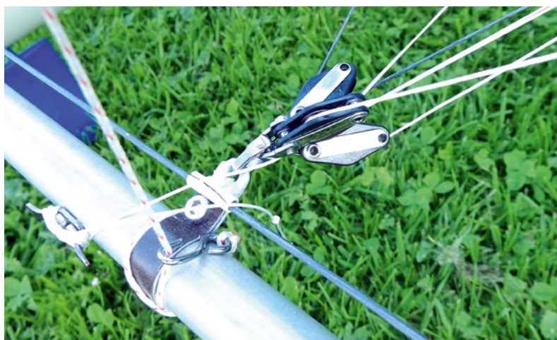
Am hinteren Beam befinden sich drei Blöcke, einer für den Gummi, der die Hauptschot spannt, einer für die Großschot und einer für die Fockschot, ...
