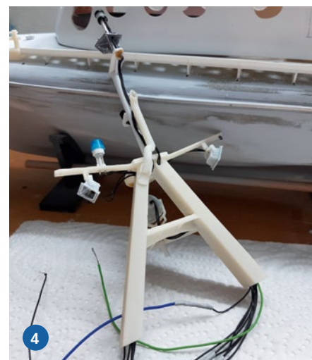
3) Einpassen der Antirutschmatte. Herausfordernder war zuvor das Erstellen der Laufbleche mit den vielen Bohrungen und der Anbau der Stützbleche. 4) Im hohlen Mast lassen sich problemlos eine Menge Kabel für die Beleuchtung verlegen
