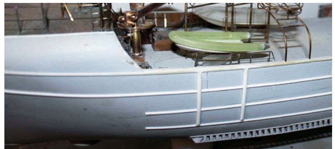
Der GFK-Rumpf entstand in klassischer Positiv-Negativ-Positiv-Bauweise. Die Polystyrol-Profile stammen aus dem Programm von Evergreen
