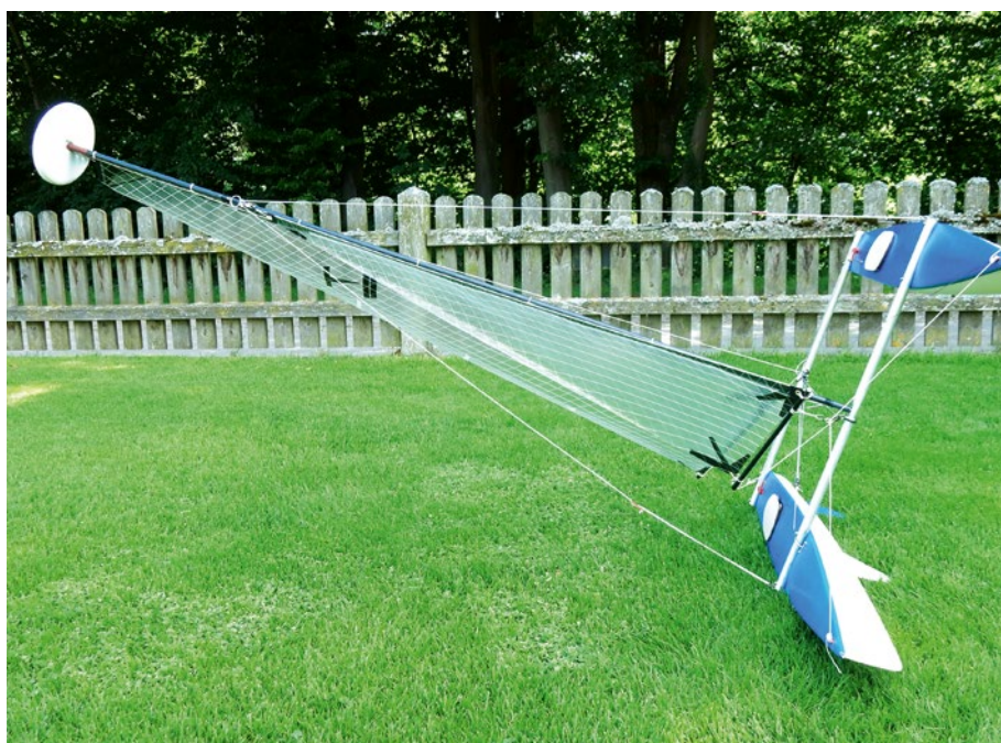
Jetzt richtet sich das Modell auch bei diesem Winkel noch von selbst wieder auf
