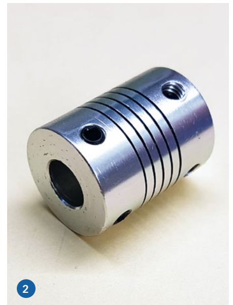
1) Neben verschiedenen Versionen der Motorhalterung mussten auch die Halterungen für die Endschalter über eine Versuchsreihe (vorne) ermittelt werden. 2) Um die Drehbankspindeln mit den Schrittmotoren zu verbinden, kommen passende Wellenkupplungen zum Einsatz
