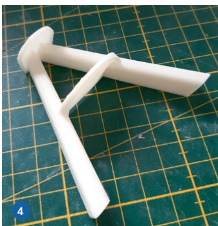
3) Wesentlicher Unterschied zwischen der Bauzeit von NEBELTHAU und BOYSEN war die Nutzung von 3D-Zeichnungen und Komponenten. 4) Der Mast auf der jüngeren SIEGFRIED BOYSEN wurde mit Hilfe eines 3D-Druckers gefertigt. 5) Zugeschnittene Holzleisten, zusammengeklebte Polystyrolplatten und 3D-gedruckte Resin-Teile bilden Hauptelemente des Aufbaus
