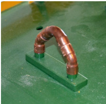
Der Schleppbogen besteht oberhalb des Decks aus verlöteten Kupferrohrfittingen
