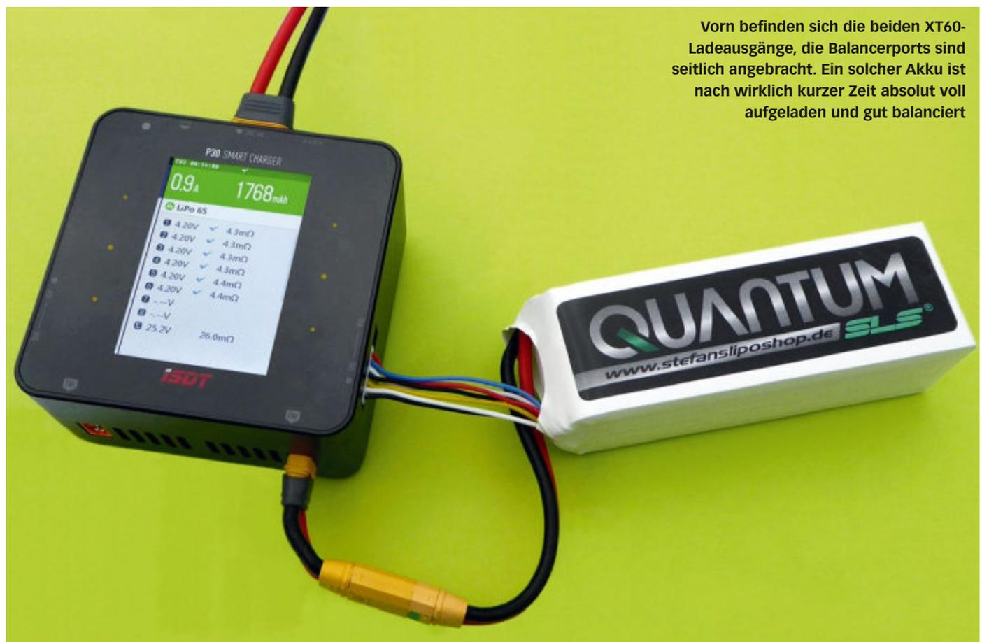
Vorn befinden sich die beiden XT60-Ladeausgänge, die Balancerports sind seitlich angebracht. Ein solcher Akku ist nach wirklich kurzer Zeit absolut voll aufgeladen und gut balanciert
