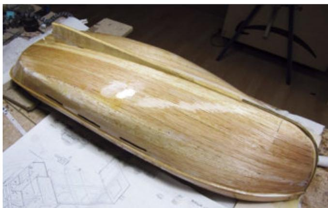
Das A und O ist die wasserdichte Versiegelung – hier darf nichts in Ritzen einsickern, was dann zum Aufquellen führen könnte
