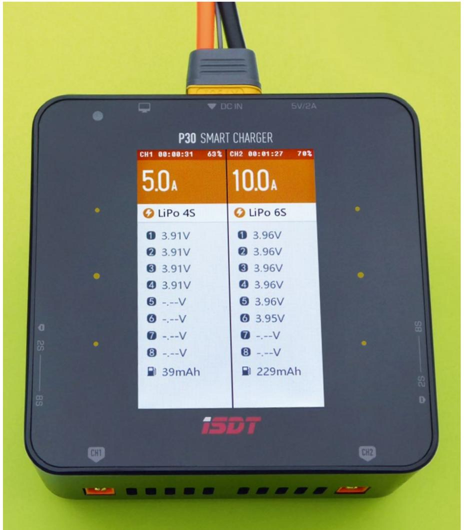
tung ausgestattet sind. Wenn der Balancerstecker angedockt wird, werden die Kondensatoren vorgeladen, sodass Funkenbildung beim Anschließen eines Akkus vermieden wird.
