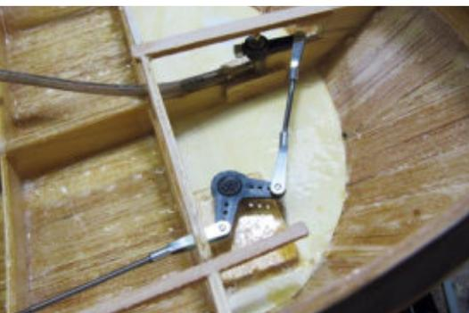
Über Umlenkung eingebaut, kann die Rudersteuerung gut unter dem Achterdeck verschwinden
