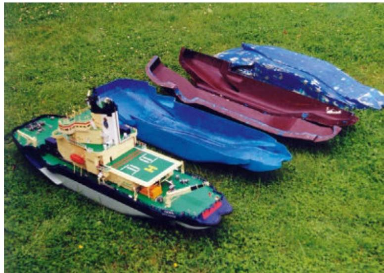
Ein grober Blick auf die Evolutionsstufen vom Rumpfnegativ bis zum fast fertigen Modell
