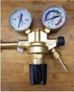
Ein passender Druckminderer ist gesondert zu kaufen. Über die beiden Manometer wird der Flaschen- und Schlauchdruck abgelesen
