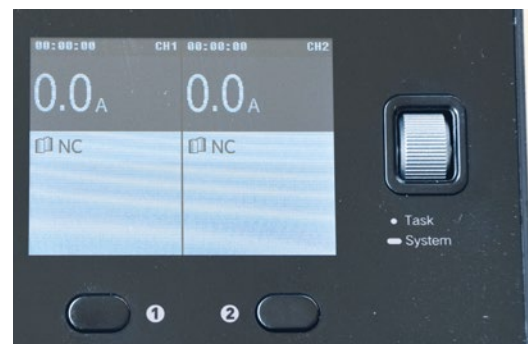
Zwei Taster und ein Drehrädchen, mehr Bedienelemente werden angesichts der gut strukturierten Menüs auch nicht benötigt
