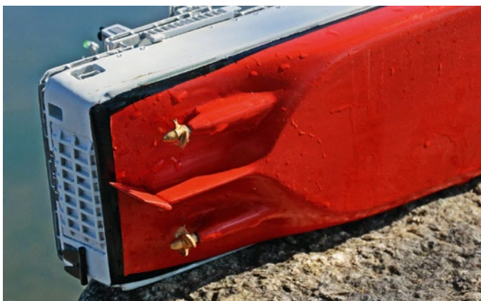
Zwei 25-mm-Propeller wurden auf 12 mm abgedreht
