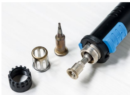
Nachdem man die schwarze Überwurfmutter aus Kunststoff gelöst hat, kann man die Lötspitze samt Haltekläfig abnehmen. So dauert das Wechseln der Spitze nur Sekunden
