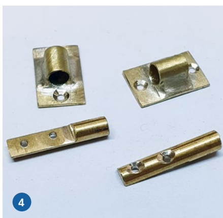
1) Gedrehte Messingbeschläge aus der Harzer Werkstatt – jeder versuchte, sich mit seinen Möglichkeiten einzubringen. 2) Ein montierter Großbaumbeschlag. So etwas umsetzen zu können, zeichnet das Projekt aus. 3) Hier ein Exemplar eines anderen Beschlags, und zwar gelötet. 4) Beschläge für die Ruderaufhängung – eine Variante. 5) Pläne aus dem Museum bilden die Vorlage für eine originalgetreue Umsetzung. 6) Die aus Krummholz geschnittene Gaffelklau von Walter ist ein weiteres gelungenes Beispiel, an dem sich andere orientieren konnten
