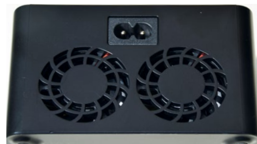
Die beiden Lüfter an der Stirnseite sind recht klein dimensioniert und limitieren das Gerät beim Entladen
