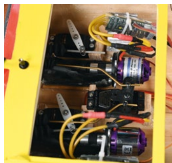
Die Impellergehäuse mit angeflanschem Motor und beiden Fahrreglern sowie der Anlageneinbau direkt unter der Kajüte, große servicefreundliche Öffnung
