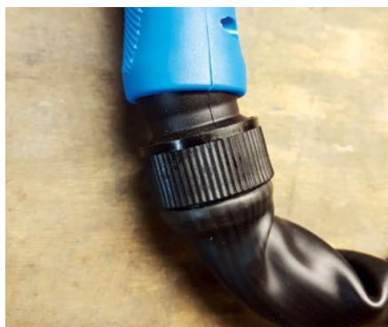
Das am Brenner vorhandene Drehgelenk ermöglicht eine gute Handhabung
