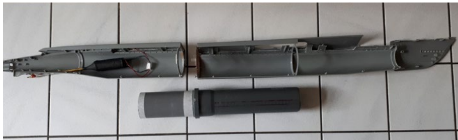
Die linke Rumpfhälfte mit Motoreinheit im Freiflutraum
