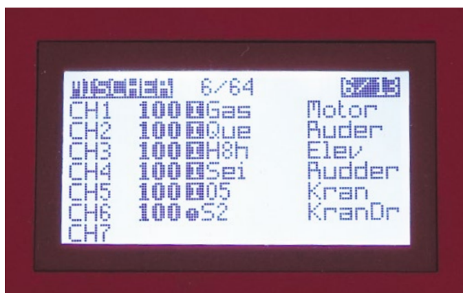
Geber und Kanäle können frei belegt und verschoben, umbenannt und kombiniert werden
