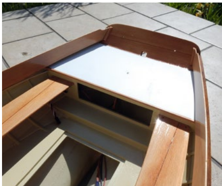
Auch das Achterdeck entsteht aus Selitron
