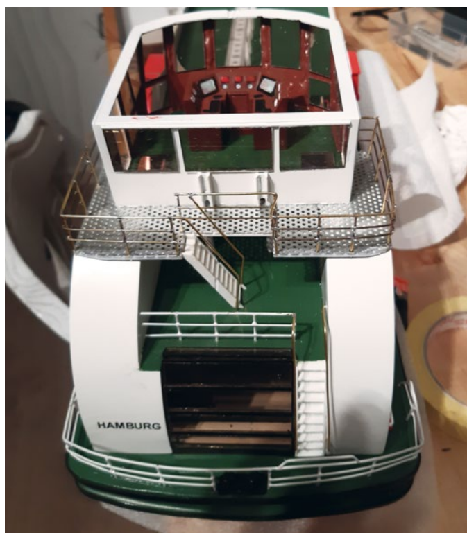
Die Treppen selbst entstanden aus selbstgezeichneten Wangen und Trittböden, die ein schönes, aber wackeliges Ergebnis hervorbrachte. Die Montage der Treppen in den vorgesehenen Bereichen stabilisierte diese aber zusehends
