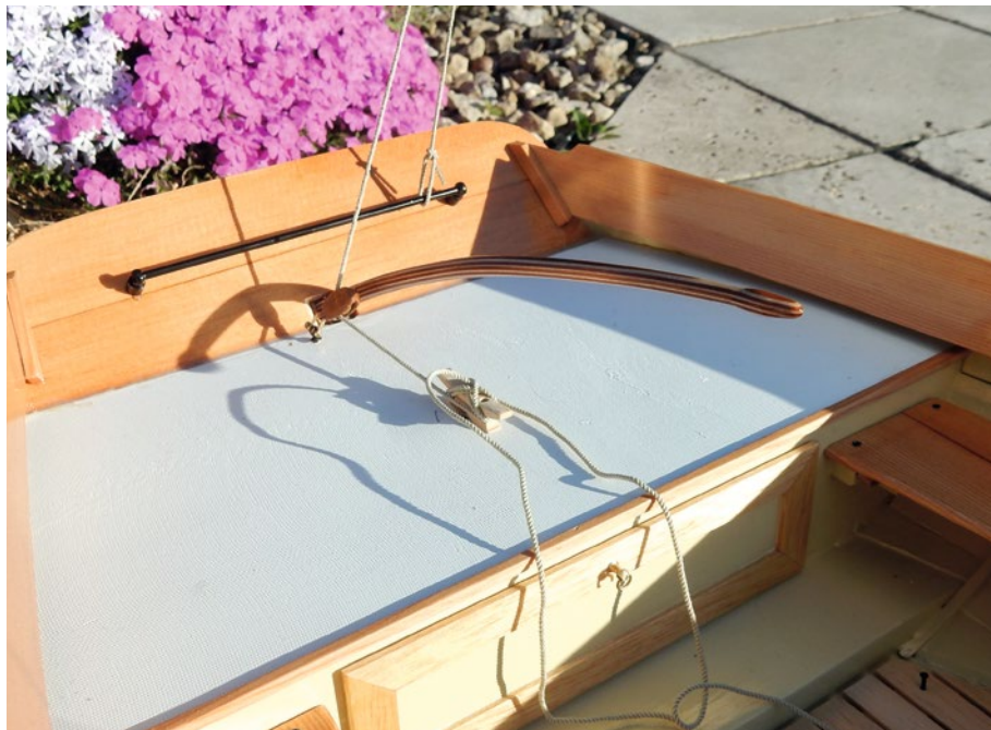
Eine zweifarbig laminierte Pinne ist ein Muss auf so einem Boot
