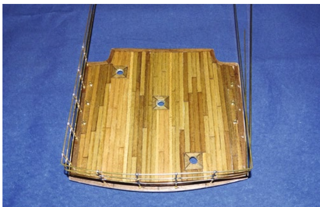
Die Relingstützen sind zusätzlich gekaufte Fertigteile, um die Durchzüge leichter erstellen zu können
