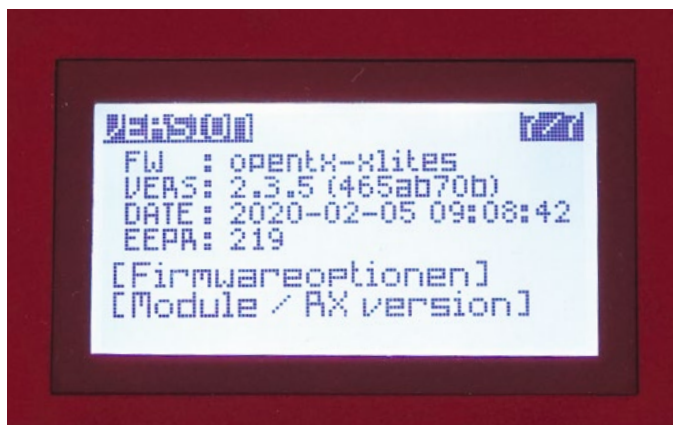
Wichtig bei FrSky-Produkten ist, dass die gewählten Versionen von Sender und Empfänger kompatibel sind
