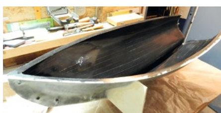
Die Urform wird komplettiert, sodass die Form daraus entsteht, aus der dann die Rümpfe abgezogen werden können
