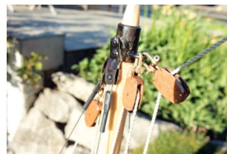
... wie auch der Toppbeschlag. Alle Beschläge sind brüniert
