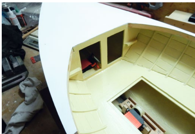
Der Akku ist durch eine Luke im vorderen Schott erreichbar. Hier ist das Deck schon aufgeklebt
