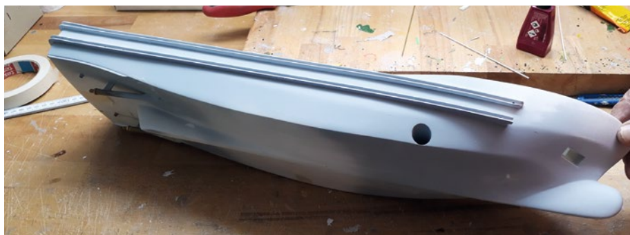
Die Fenderleisten schützen das Modell bei Zusammenstößen
