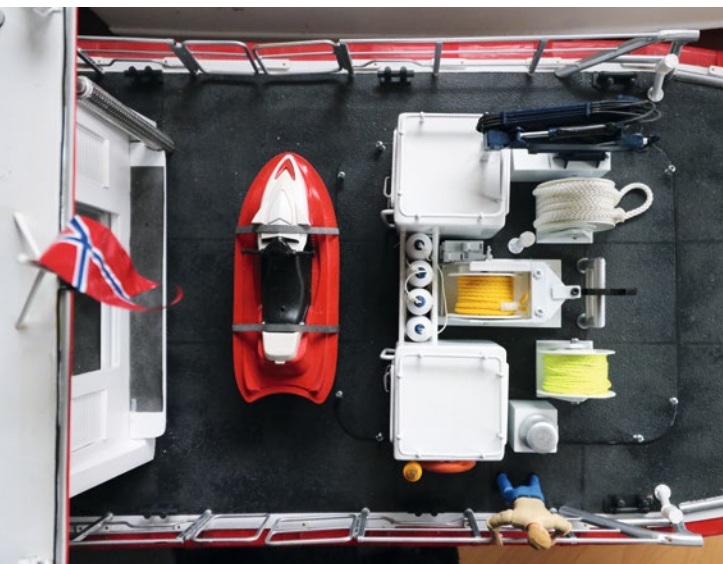
Die gesamte Hecksektion mit Seiltrommeln, Fendern, Spill und Abschlepphaken. Diese Einheit ermöglicht den Zugang zum Schiffsinneren
