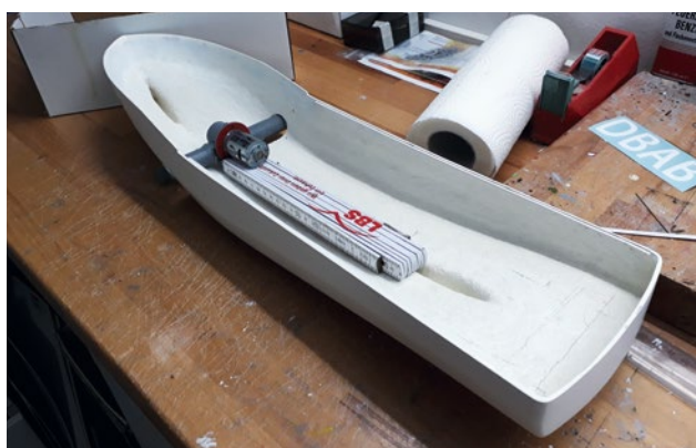
Einpassen des Bugstrahlruders. Wie man erkennen kann, ist der kleine Rumpf recht massiv gebaut worden
