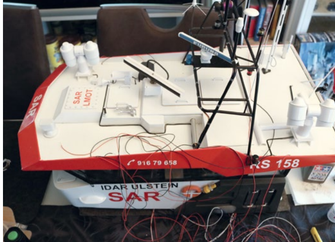
Alle Kabel werden, wie im Original, auf dem Dach verlegt und im Bündel unter Deck gezogen
