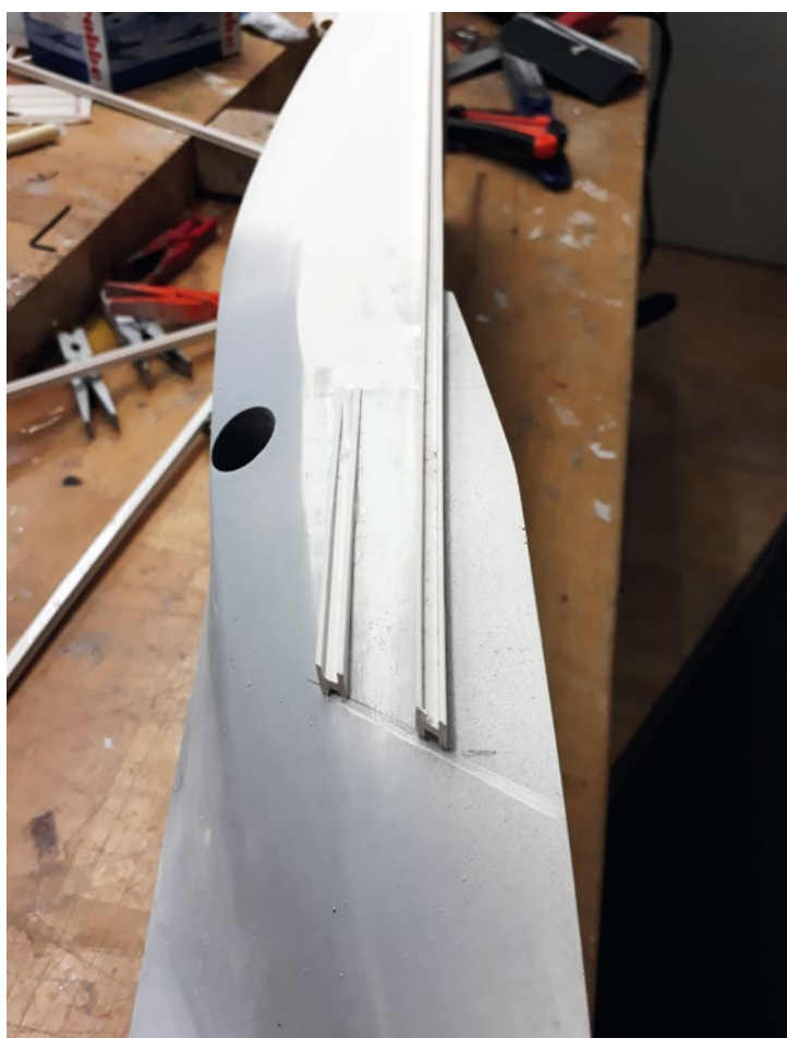
Um die am Rumpf befindlichen Scheuerleisten nachzubilden, wurde ein H-Profil aus Polystyrol angeklebt
