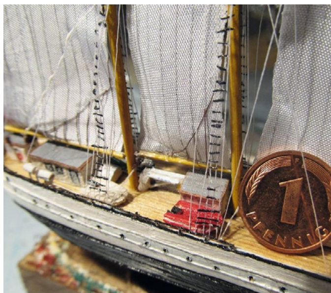
Detail des Decks mit Beiboot. Die Reling wurde aus Besenborsten und Sekundenkleber-gestärktem Nähgarn gefertigt
