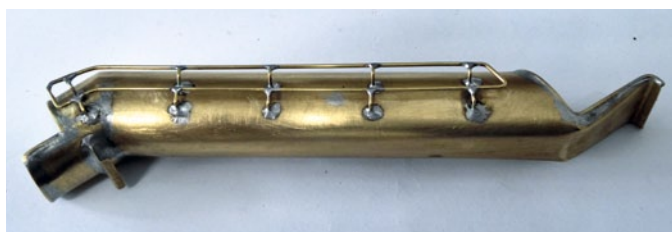
Um ein Rohr gewickeltes Messing bildete die Grundlage für das Rutschenrohr. Auf dem Original ist diese Gimmick sehr beliebt
