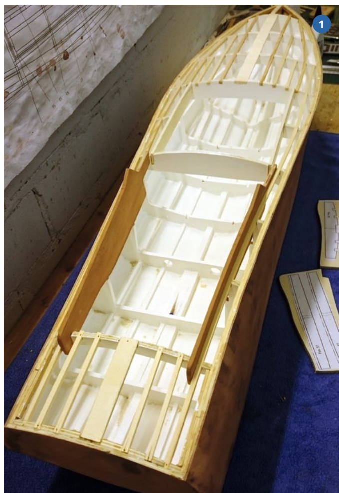
1) Bei dieser Ansicht sieht man das in Weiß gestrichene Innere und die Deckstringer. Gut zu sehen sind auch die Aussparungen für Luke und Cockpit. 2) Zieht man die Pins nach Aushärten des Ponal-Klebers heraus, lassen sich die entstandenen Löcher mit etwas Wasser behandeln und so gezielt zum Aufquellen bringen. 3) Der fertig mit Sperrholz beplankte Rumpf vor dem Schleifen
