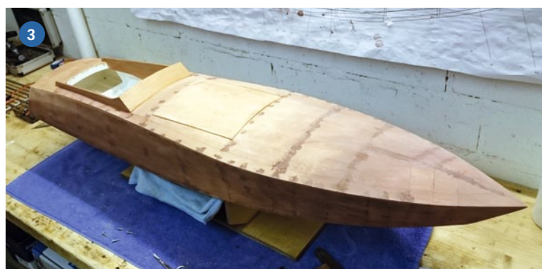
1) Bei dieser Ansicht sieht man das in Weiß gestrichene Innere und die Deckstringer. Gut zu sehen sind auch die Aussparungen für Luke und Cockpit. 2) Zieht man die Pins nach Aushärten des Ponal-Klebers heraus, lassen sich die entstandenen Löcher mit etwas Wasser behandeln und so gezielt zum Aufquellen bringen. 3) Der fertig mit Sperrholz beplankte Rumpf vor dem Schleifen
