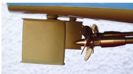
Von Raboesch stammen die sehr guten Propeller und die Wellenanlagen
