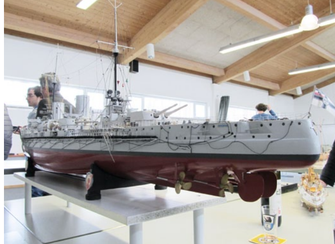
Unteransicht des Schiffs von Backbord achtern. So sehr gut zu erkennen: zwei der vier Schiffsschrauben und die Doppellruderanlage
