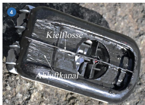
1) Einbau der Reely-Komponenten in das LCAC-Rohmodell; die Luftschraubenmotoren befinden sich in den Kartonröhren. 2) Rohmodell von oben: Der Elektronikraum ist abgedeckt. Man erkennt den Antennenstummel. 3) Modell der LCAC-101 von backbord hinten. Aus dünnem Material lassen sich auch filigrane Antriebskomponenten bauen. 4) Blick in den bereits modifizierten Luftkissenraum, also mit Kiel und mehr Platz fürs Luftpolster
