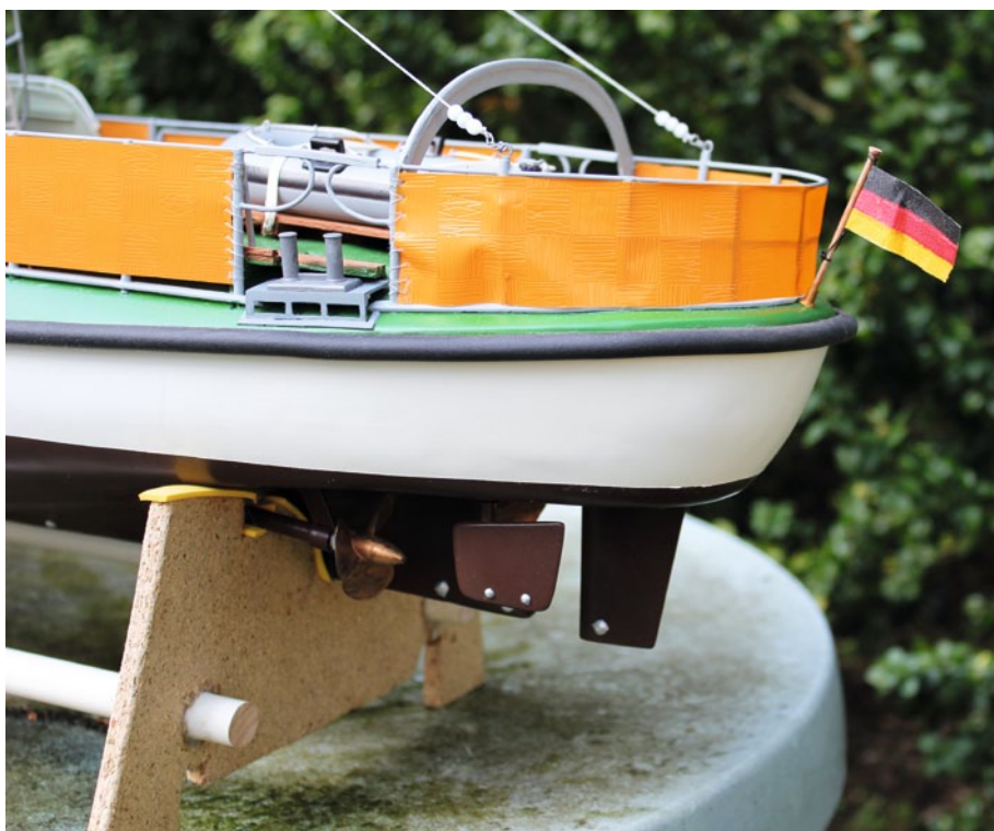
Die Relingstützen sind aus Kunststoff-Rundstäben gefertigt und die Durchzüge aus 1,5-Millimeter-Messingdraht. Für die Relingstützen wurde eine Konstruktionshilfe angefertigt, indem in ein etwas dickeres Messingröhrchen zwei Löcher im Abstand der Durchzüge gebohrt wurden. Nun konnten die etwas dünneren Kunststoffrohre in das Messingröhrchen geschoben werden – die mittels Akkuschrauber gebohrten Löcher für die Durchzüge sitzen auf diese Weise immer an der richtigen Stelle. Die Herstellung der Reling selbst war dann relativ simpel, zumal sich auch hier am Bauplan der HEUSS orientiert wurde. Bei dem hinteren Trossenabweiser und Schutzbügel handelt es sich ebenfalls um ein leicht gekürztes Bauteil aus dem Baukasten
