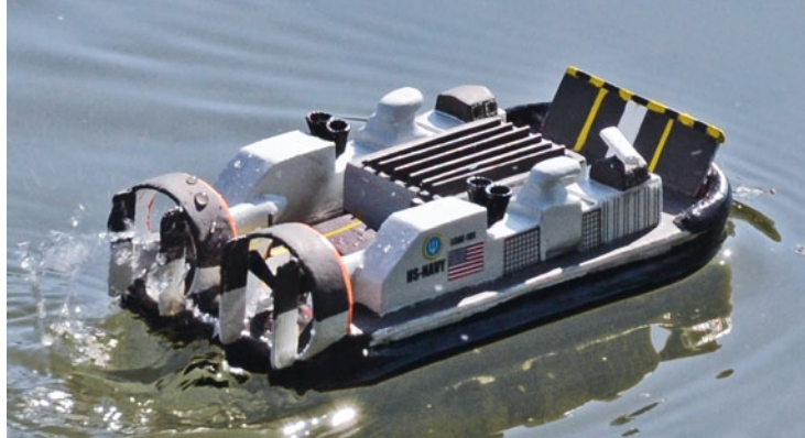
Hier gut zu erkennen ist der andere Aufbau des Containers, der mehr Luftzufuhr gestattet. Man findet diesen auch im Bauplan wieder
