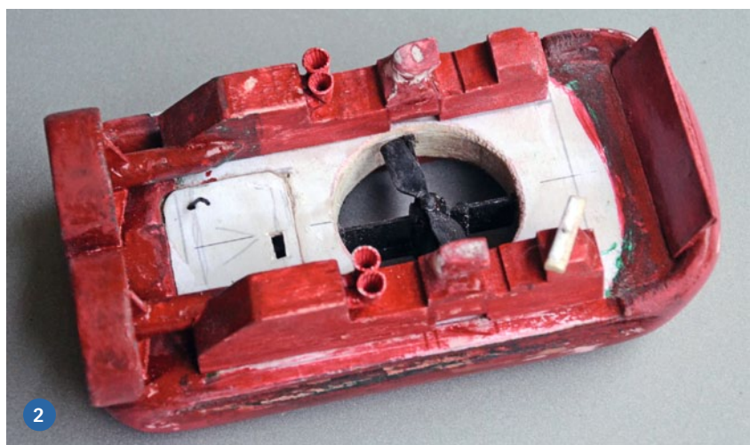
1) Einbau der Reely-Komponenten in das LCAC-Rohmodell; die Luftschraubenmotoren befinden sich in den Kartonröhren. 2) Rohmodell von oben: Der Elektronikraum ist abgedeckt. Man erkennt den Antennenstummel. 3) Modell der LCAC-101 von backbord hinten. Aus dünnem Material lassen sich auch filigrane Antriebskomponenten bauen. 4) Blick in den bereits modifizierten Luftkissenraum, also mit Kiel und mehr Platz fürs Luftpolster
