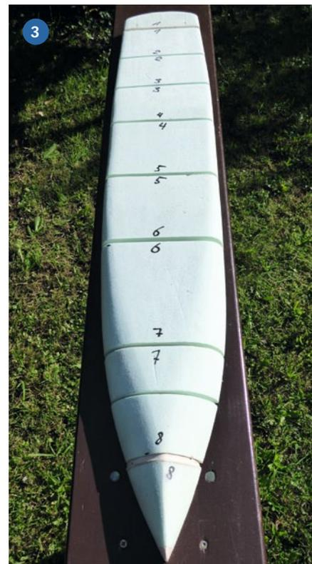
1) Die vielen Räder des Laders zeugen vom zu tragenden Gewicht – einen solchen Koloss sicher über die Straßen zu bewegen, ist dann eine Meisterleistung. 2) Ausfahrt der MS UTTING im frühen Abendlicht und bei eingeschalteter Beleuchtung im Modell. 3) Um sich dem Spantenriss zu nähern, entstand zunächst ein Rumpf aus Styrodur-Klötzen, aus dem dann die Spanten herauszuarbeiten waren. Im Styrodur eingelassene Schlitzte ermöglichten die Abnahme und das korrekte Einsetzen der ermittelten Spanten
