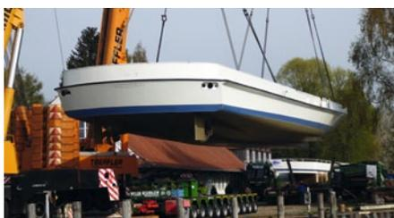
Gebaut wurde die MS UTTING von der Lux Werft. Die musste das lange, große Binnenschiff in Segmenten vormontieren und anliefern, was logistisch für alle Beteiligten eine Herausforderung darstellte
