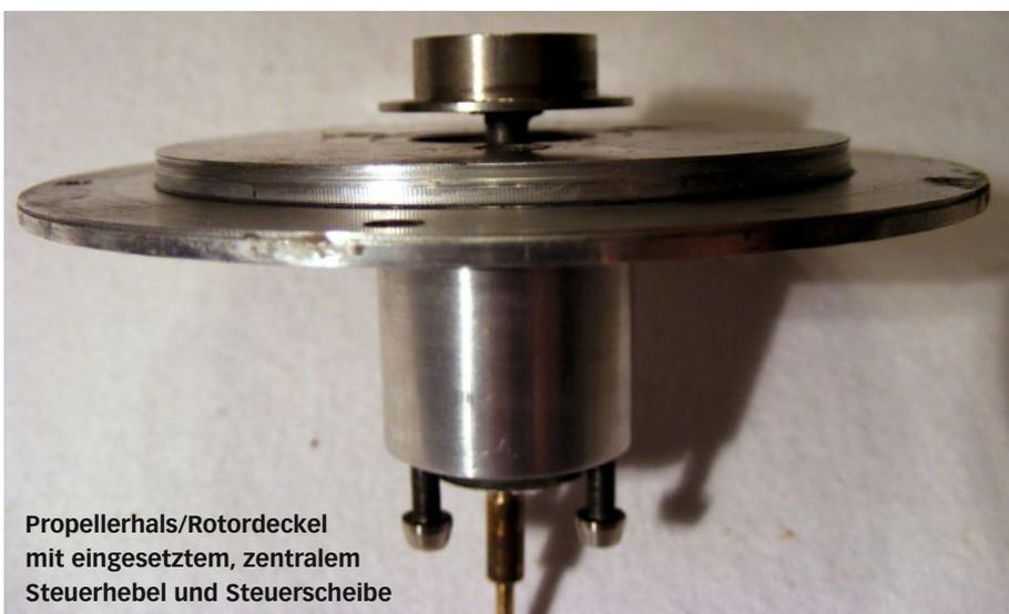
**Propellerhals/Rotordeckel mit eingesetztem, zentralem Steuerhebel und Steuerscheibe**
