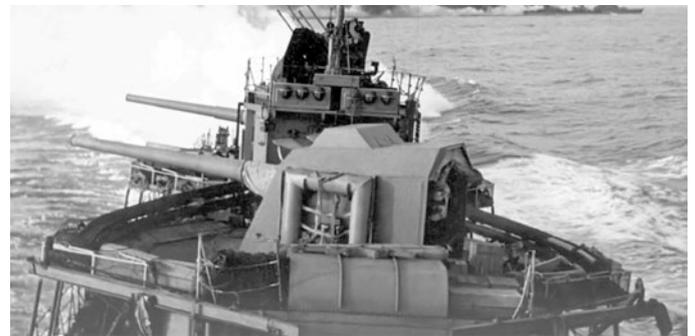
Ringförmig um das Geschütz aufgebaut sieht man die Munitionsrutschen zur Zuführung der Granaten und Ladungen an die Ladenummern. An der Seite vom Splitterschutz viereckige Blech-Rettungsflöße
