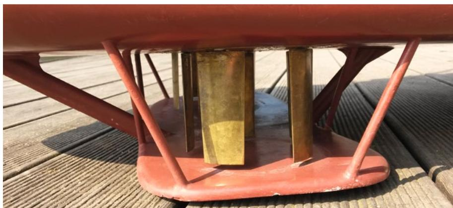
Propellerflügel unter dem Modell mit Unterfahrerschutz
