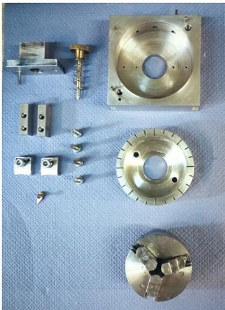
Alle angefertigten Teile und das Dreieckenfutter
