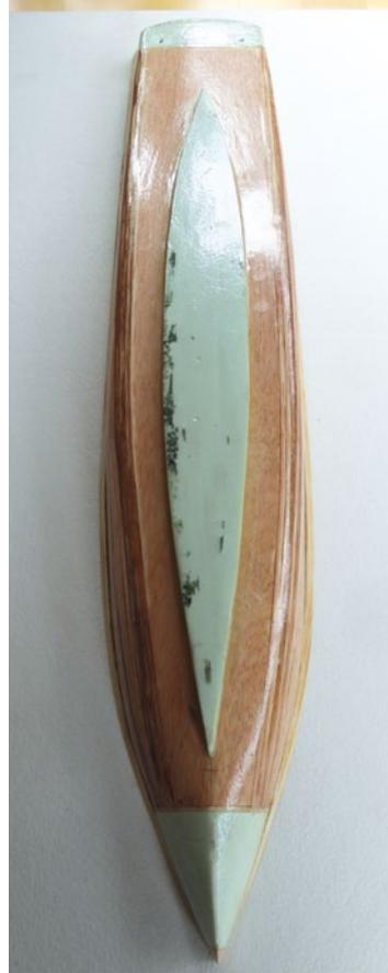
Markant am Rumpfboden ist die kantige, bauchige Ausformung. Sie ließ sich beim Original dokumentieren, konnte also auch im Modell realisiert werden
